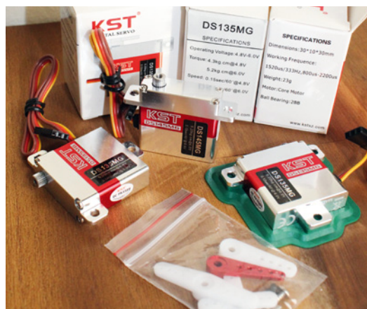
Die Servos der Firma KST sind leicht, robust und kräftig genug, um die Ruder zu bewegen
