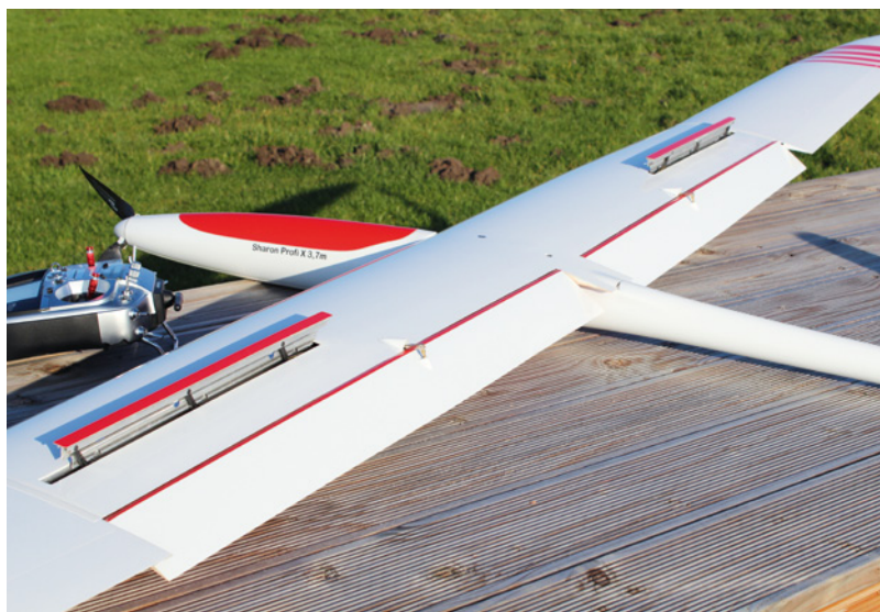
Der Sharon kann wahlweise mit Landeklappen und Wölbklappen gefertigt werden. Die Wirkung ist sehr gut
