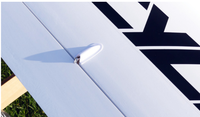
In der Grundeinstellung der Wölbklappen ist ein kleiner Spalt zwischen Klappe und Flügel erforderlich, damit die Speed-Einstellung mit +3 Millimeter möglich ist
