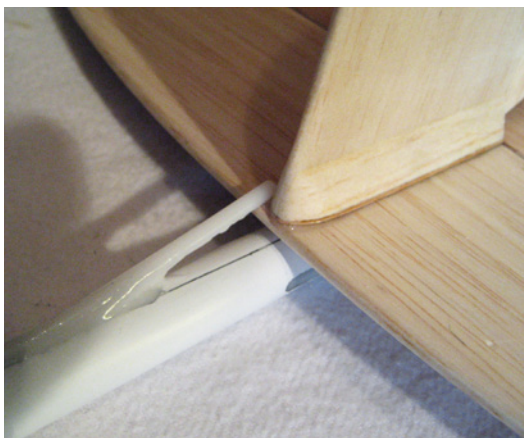
Das komplette Ruder wird mit dem Rumpf verklebt
