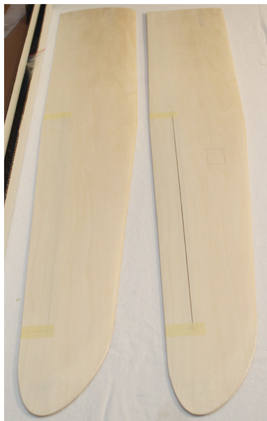
Die Tragflächen sind mit größter Sorgfalt und sehr sauber erstellt worden. Darüber hinaus sind sie mit Kohle- und Glasfasereinlagen verstärkt
