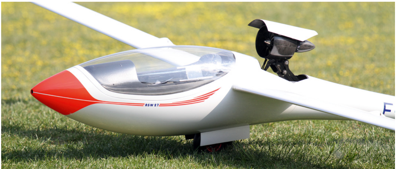
Klappimpeller eignen sich sehr gut für dynamisch geflogene Modelle
