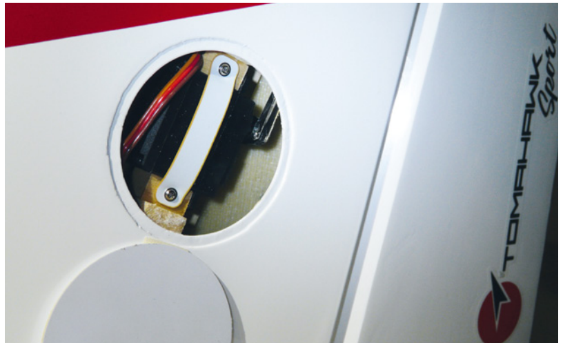
Das Höhenruder-Servo ist ab Werk in der Seitenfinne montiert. Der runde, versenkte Schachtdeckel in der Finne kann glattflächig mit Tesafilm gesichert werden
