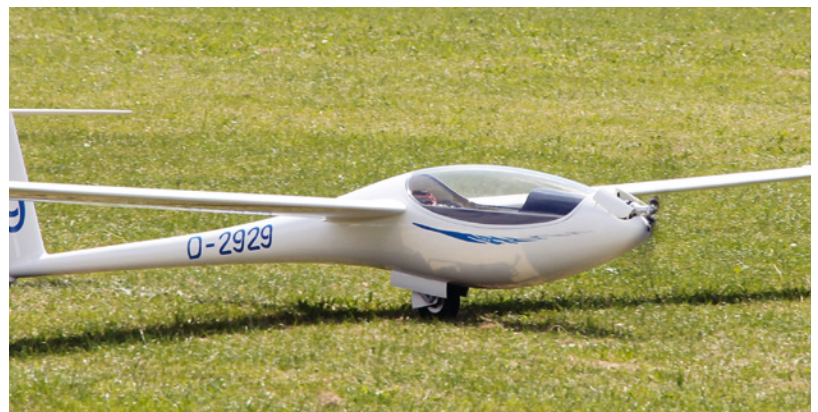
Hier eine Spezialform, ein ausfahrbarer FES-Antrieb, der zudem die Motorwelle oberhalb der Rumpfschnauze ausfährt, um größere Luftschauben nutzen zu können
