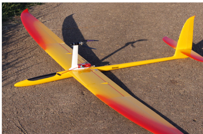
Am Zweckmodell ESO wurde ein elektrischer Motoraufsatz (EMA Power) auf den Rumpfrücken montiert, um auch ohne Hang oder Winde fliegen zu können. Auch für Großsegler gibt es feststehende Motoraufsätze, hier an einer ASW 24 im Maßstab 1:3 (rechts)
