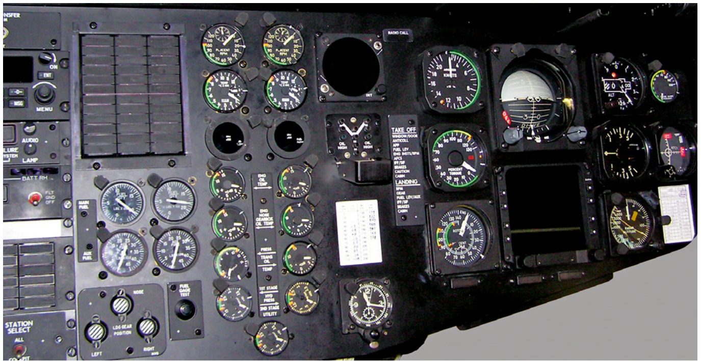
Anhand des betagten Instrumentenpanels eines Großhubschraubers kann man sehr gut die Grundzüge jeder Flugzeuginstrumentierung sehen. Auf der rechten Hälfte, im direkten Blickfeld des Piloten, sind die primären Instrumente mit künstlichem Horizont, Fahrt-, Höhenmesser und Variometer sowie Drehmoment- und Drehzahlanzeigen zu erkennen. In der Mitte sind die sekundären Anzeigen angeordnet
