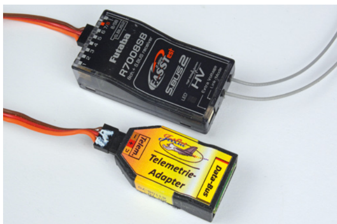
Der kleine Telemetrieadapter übermittelt sämtliche relevanten Turbinendaten, inklusive Airspeed, an den Empfänger
