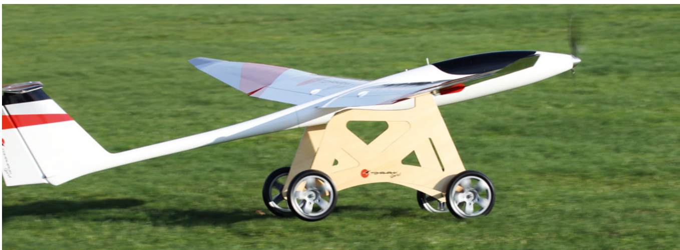
Bei entsprechendem Höhenruderausschlag und der nötigen Fahrt hebt sich der Segler nach 30 bis 35 Meter Rollstrecke zügig aus dem Startwagen
