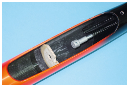
Im Rumpf sitzen bereits der Motorspant und die Fernwelle mitsamt ihrer CFK-Abdeckung
