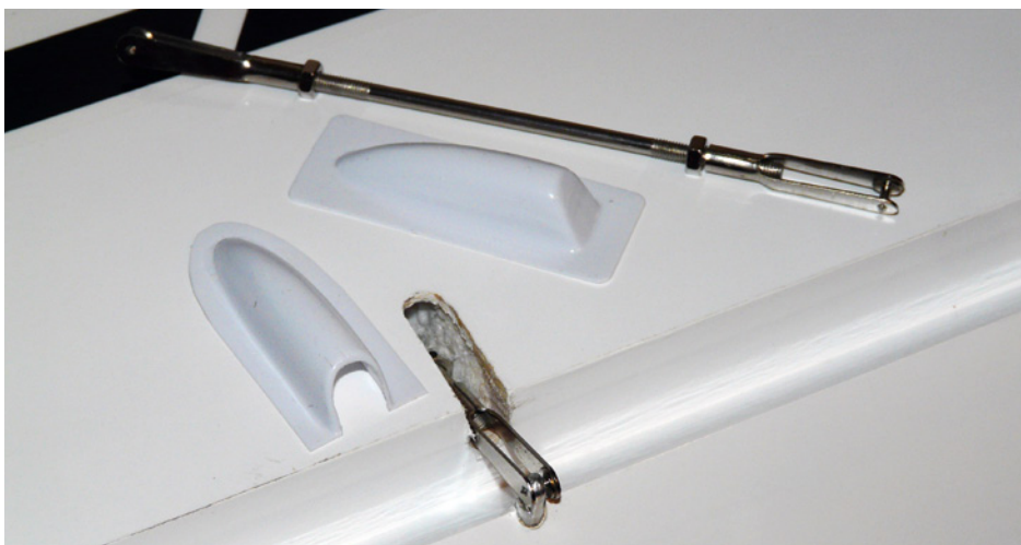
Die Gestängedurchführungen im Bereich der Wölbklappen sind ab Werk eingearbeitet. Allerdings mussten sie um 5 Millimeter in der Tiefe erweitert werden
