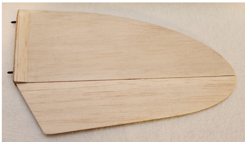
Das Seitenleitwerk passt genau in die Bohrungen des Höhenruders und ist sehr sauber vorgefertigt
