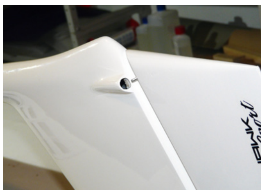
Das Seitenruder wird über Fliesscharniere mit der Finne verbunden und diese mit dünnflüssigem Sekundenkleber fixiert
