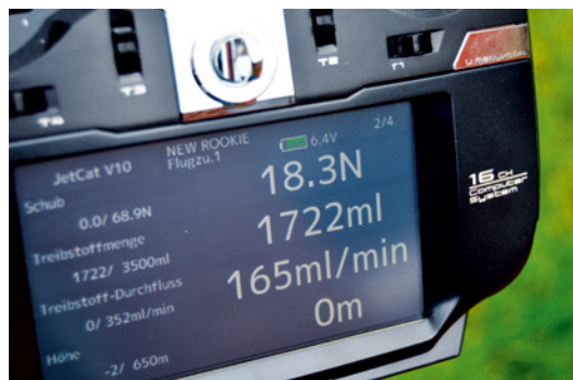
Interessante Daten aus dem Flugzeug während die Turbine läuft
