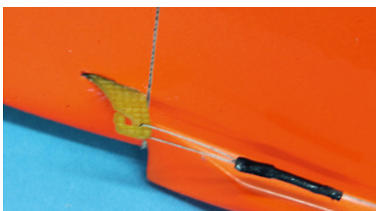
Hier die fertiggestellte Anlenkung des Dachleitwerks
