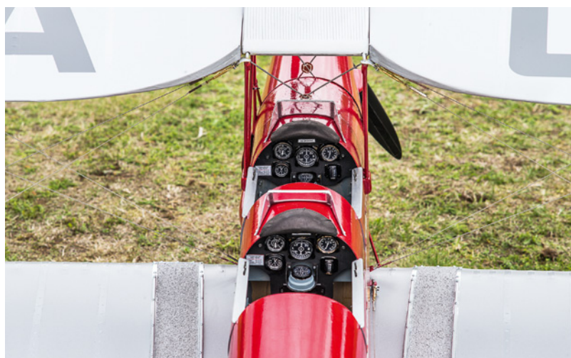
Die Instrumente sind im Bausatz von Toni Clark practical scale als glasklare Tiefziehteile enthalten. Nach dem Ausschneiden wurden die Zifferblätter eingeklebt und die Gehäuse innen messingfarben und außen mattschwarz lackiert. Der getrocknete schwarze Lack wurde dann teilweise wieder abgekratzt um ein „gebrauchtes“ Aussehen zu erzeugen
