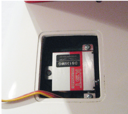
Auch der Einbau des Servos für das Höhenruder ist gut vorbereitet und macht kein Problem. Die Rudermaschine selbst findet ihren Platz in der Seitenrudersflosse
