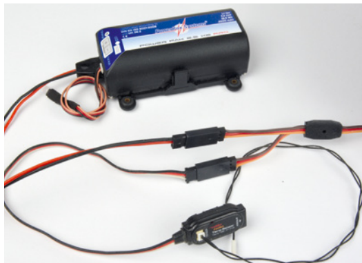
Zum Anmelden der Sensoren an den Sender T16SZ ist ein Akku parallel zu schalten
