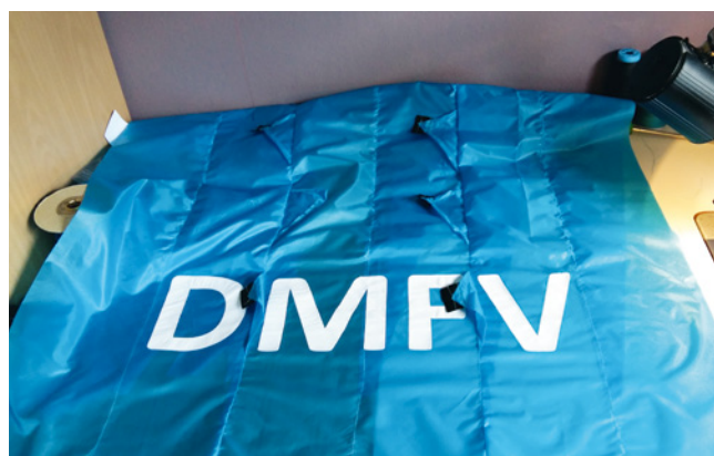
Der rechte Teil des RC-Fallschirmes (in Flugrichtung) nimmt Form an. Auf dem Bild zu erkennen sind schon teilweise die angenähten Flores für die Längsstabilität, an denen später die Leinen befestigt werden
