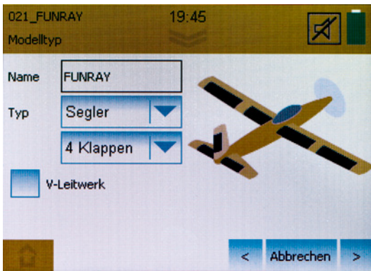
Wer Modelltyp, Anzahl der Klappen und Leitwerksform nicht selbst auswählen will, kann Vorlagen für Einsteiermodelle, Segler, Motormodelle, Deltas, Hubschrauber und Multikopter nutzen
