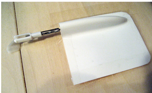
Die mitgelieferten Querruderabdeckungen werden zurechtgeschnitten und mit Tesafilm befestigt
