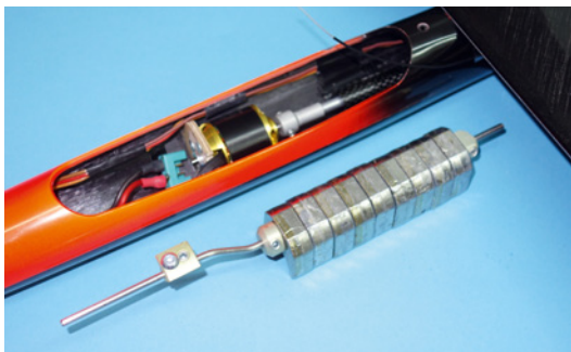
Das Ballast-Set ist speziell geformt und wird oberhalb der Fernwelle in den Rumpf eingeschoben und per Schraube gesichert
