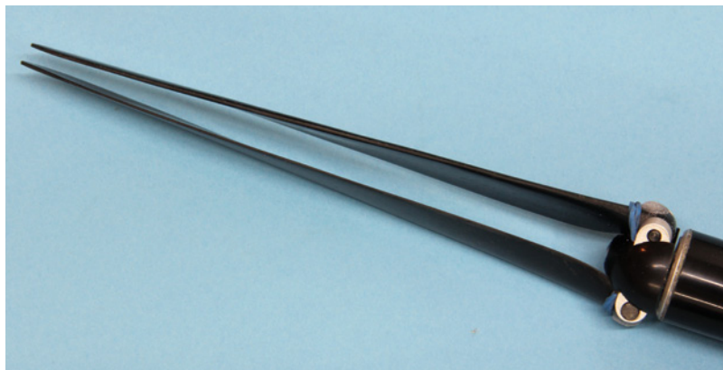
Die Luftschaubenblätter werden mittels Gummiring zusammen gezogen. Zwei aufgebrachte Klebepunkte an der Blattwurzel verhindern, dass die Luftschaube nach vorne schlagen kann
