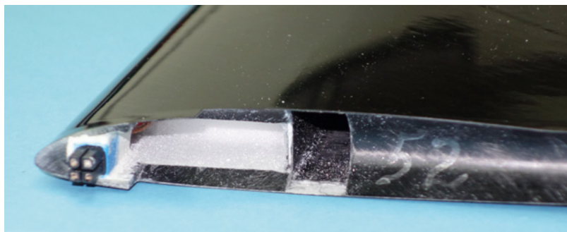
Die Servostecker vom Mittelstück zum Außenohr sind fertig eingebaut. Ebenfalls zu sehen ist die Vertiefung für das Leitwerksservo
