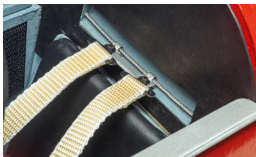
Die obere Befestigung der Gurte ist wie beim Original seitlich verschiebbar, um dem Piloten das seitliche Hinauslehnen aus dem Cockpit zu erleichtern
