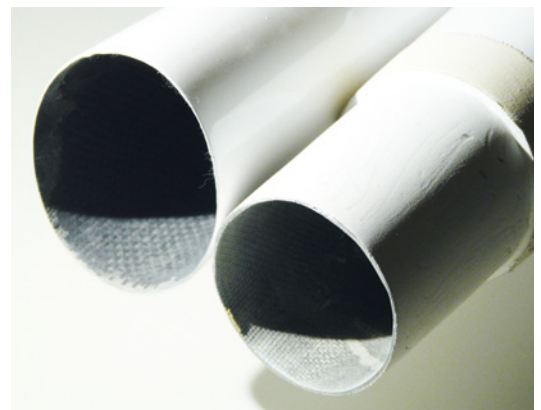
Der relativ üppige Lackauftrag im Bereich der Klebefläche im hinteren Rumpfsegment muss vor dem Kleber-Einsatz (zum Beispiel mit UHU Endfest 300) kräftig angeschliffen werden
