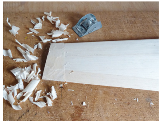
Der Randbogen wird mit dem Balsaobel grob in Form gebracht
