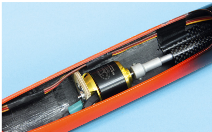
Um den Motor einzubauen, muss man dessen Welle lösen und nach hinten schieben, das Reglerkabel wird mit Tape an der Rumpfsseitenwand befestigt, damit es nicht mit der rotierenden Glocke oder der Fernwelle in Kontakt kommt
