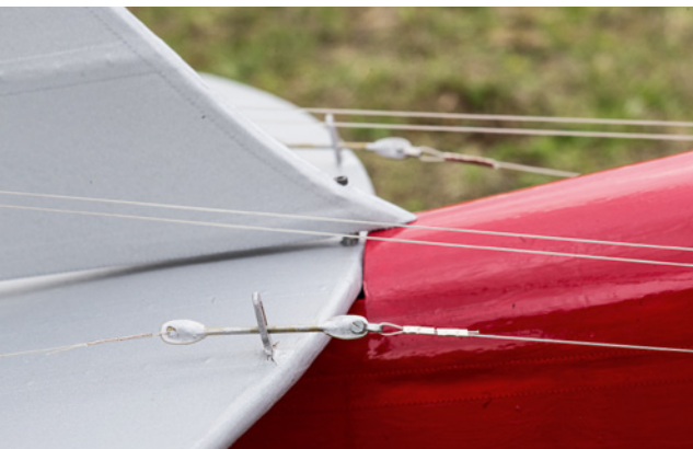
Die Führung der oberen Höhenruderzüge auf der Höhenflosse, aus Stahlstab und Messingblech hartgelötet, rostgeschützt und lackiert
