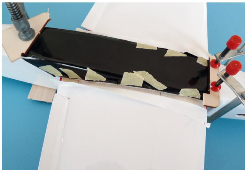
Die Haube wird angeleimt, dafür wurde die Folie in der Mitte der Tragfläche zu den Seiten gezogen
