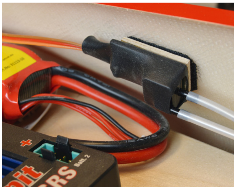
Der Differenzdrucksensor des Fluggeschwindigkeitsmessers mit den beiden Verbindungsschläuchen zu dem Pitot-Rohr für Staudruck und statischem Druck
