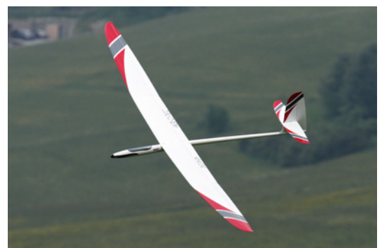
Zweckmodelle werden sehr oft mit einem Nasenantrieb ausgestattet
