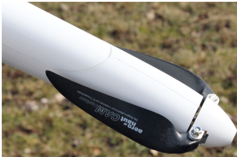
Turbospinner, Klapppropeller und Haube passen perfekt an die Rumpfnase
