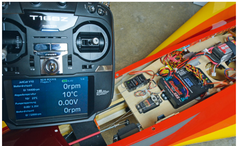
Nachdem im New Rookie alles fertig verkabelt ist, stehen unter anderem Informationen über Turbinendrehzahl, Abgastemperatur und Pumpenspannung zur Verfügung
