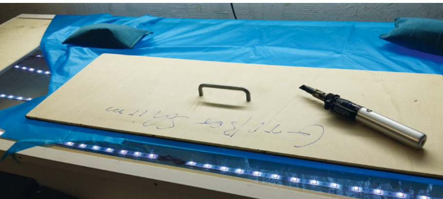
Die Einzelteile des Schirms werden mit einem LötKolben aus dem Stoff herausgeschnitten
