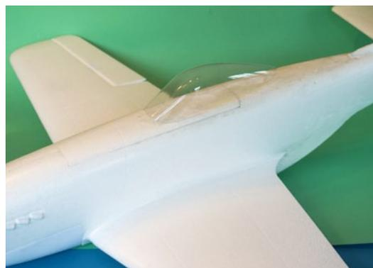
*Die neue Kabinenhaube geht genau über die Nachtstelle des Rumpfdeckels – daher wird sie nur im vorderen Bereich verklebt*
