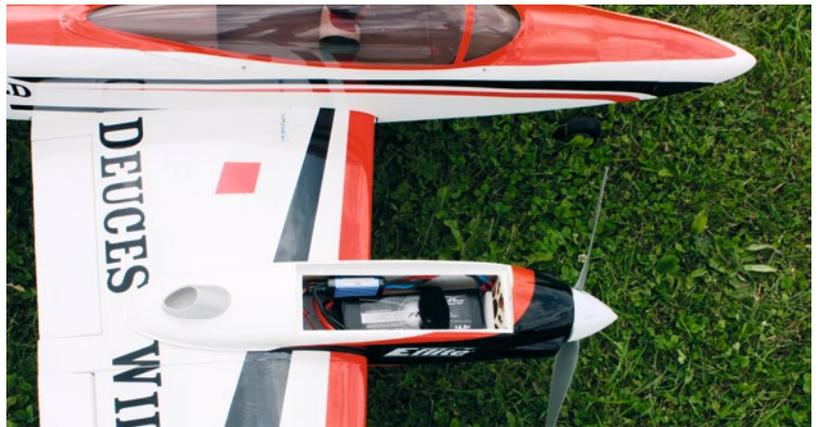
Bei dieser Dueces Wild findet der ganze Antrieb samt Akku in den Motorgondeln Platz. Kein Problem also mit langer Leitung. Man bezahlt die bauliche Vereinfachung aber mit weit vom Rumpffzentrum entfernten Massen, was ein hohes Trägheitsmoment um die Längsachse mit sich bringt
