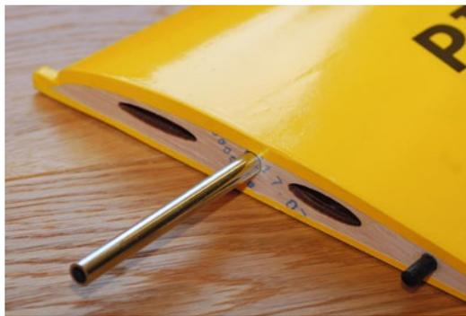
Die Flächensteckung mittels eines dickwandigen 8-Millimeter-Alurohrs und eines 6-Millimeter-Kunststoff-Dübels aus dem 3D-Drucker wirkt leicht unterdimensioniert für das versprochene, atemberaubende High-Speed-Erlebnis
