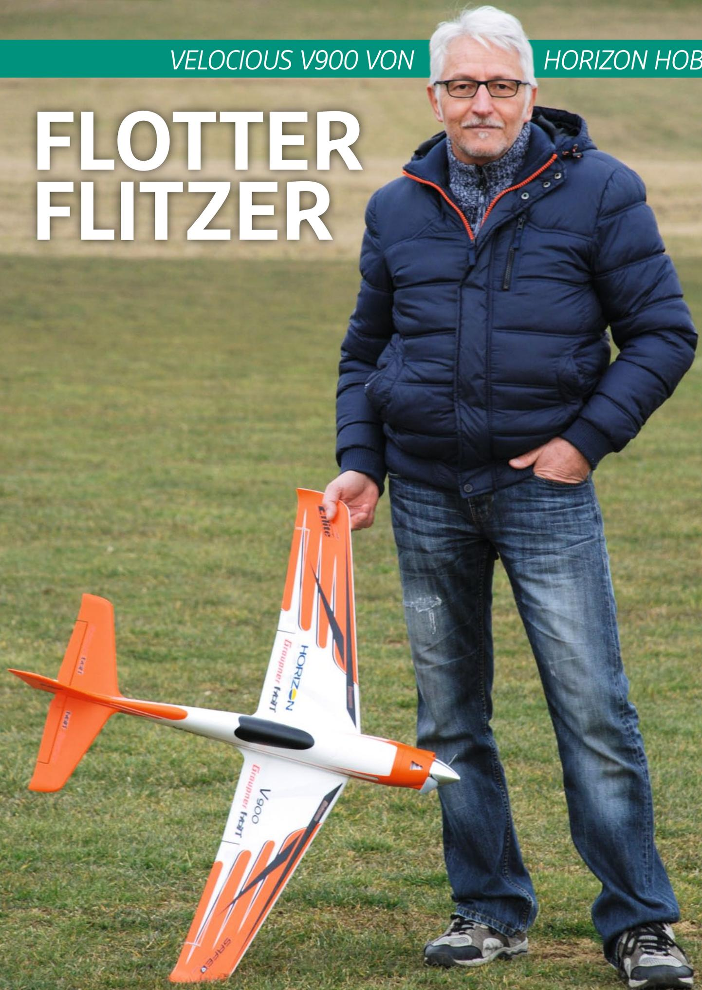
In diesem Testbericht geht es um eine Modell mit äußerst eleganter Linienführung und sehr ansprechendem Design. Das schnellste E-Flite-Flugzeug heißt Velocious V900 und soll aus der Schachtel heraus mit einem 3s-LiPo-Akku 160 Kilometer pro Stunde erreichen. Mit 4s sogar satte 192 Kilometer pro Stunde. Werte, die neugierig machen. Und so ist die Bestellung der PNP-Version – also das fertige Modell ohne Empfänger – schnell abgeschlossen.
