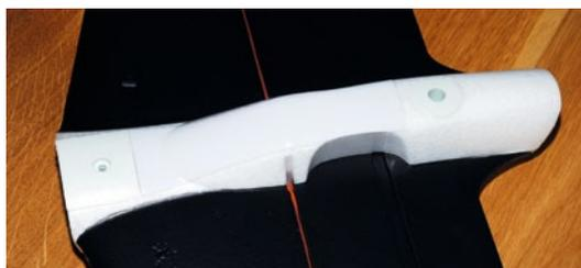
Eine Griffmulde für den Handstart sowie ein Kunststoff-Schutzschild, beide nach Montage der Fläche an der Rumpfunterseite befindlich, sind im Flugbetrieb sehr sinnvoll
