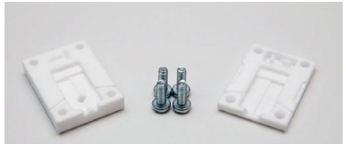
Bei den **ISO-Steckerformen** von D-Power werden die Steckverbindungen zusammen mit den Kabeln in die ISO-Steckerform gelegt und verschraubt. Anschließend wird Heißkleber in die Form gespritzt. Überstehende Klebereste werden mit einem Messer entfernt. Sie sind für XT-60, XT-90, MPX- und T-Stecker erhältlich. Hergestellt werden sie aus PTFE-Material und Aluminium. Der Lieferumfang umfasst außerdem vier Schrauben. Preis ab 29,90 Euro.
