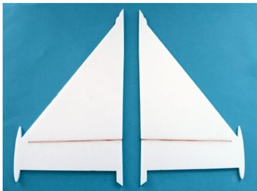
In die Tragflächenhälften werden Kiefernleisten zur Verstärkung eingeklebt
