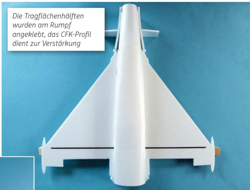
Die Tragflächenhälften wurden am Rumpf angeklebt, das CFK-Profil dient zur Verstärkung
