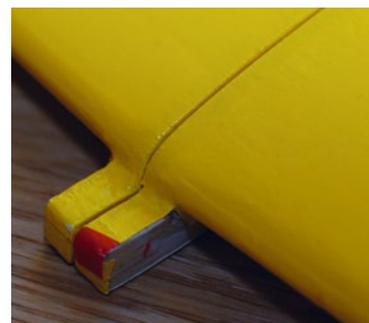
Die Wurzelrippen sind mit Hörnern versehen, die in eine entsprechende Öffnung eines Rumpfspants greifen
