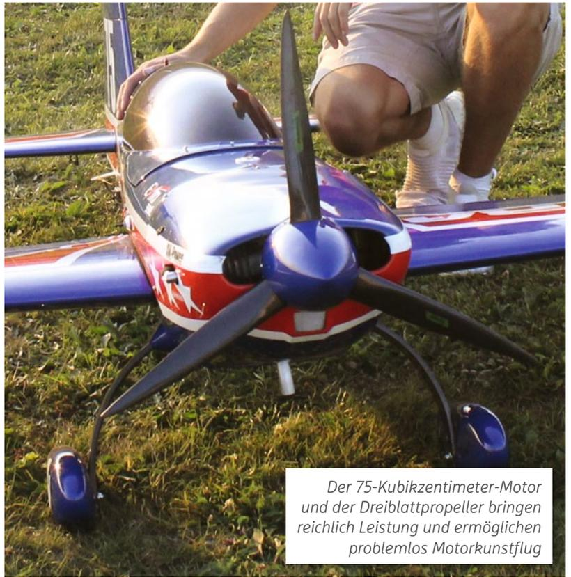
*Der 75-Kubikzentimeter-Motor und der Dreiblattpropeller bringen reichlich Leistung und ermöglichen problemlos Motorkunstflug*
