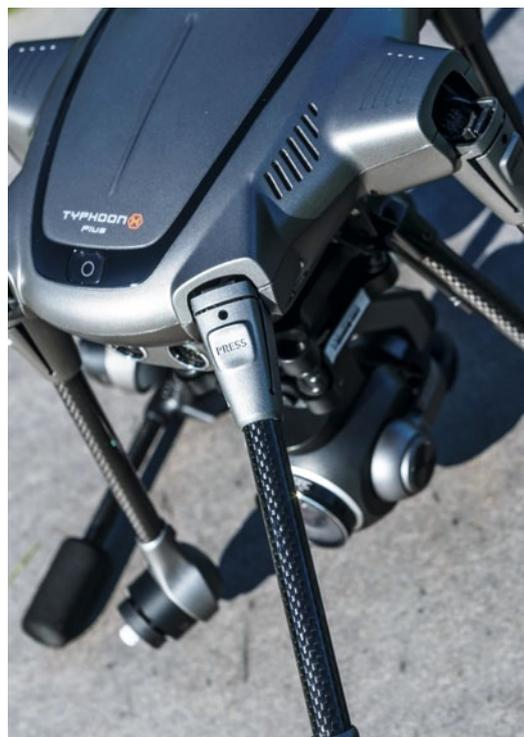
Die Ausleger werden nur hochgeklappt und rasten automatisch ein
