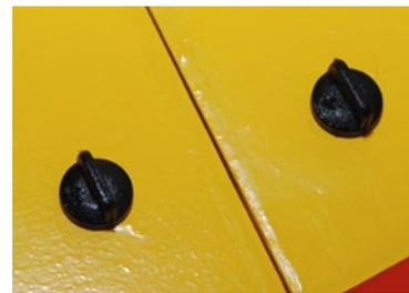
Eigentlich eine gute Idee für den Aufbau des Modells ohne Werkzeug. In der praktischen Anwendung bewähren sich die Flächenbefestigungsschrauben jedoch nicht, die Flügel sind zu klein geraten
