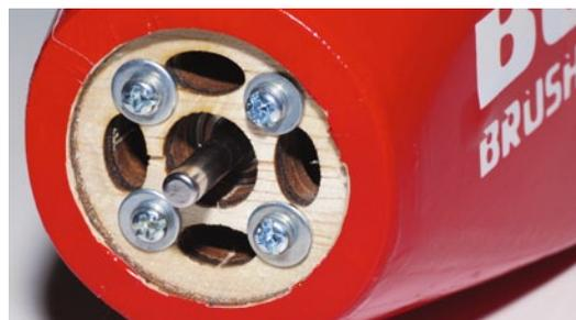
*Mit vier Schrauben wird der Außenläufer am ausreichend dimensionierten Motorspant befestigt*
