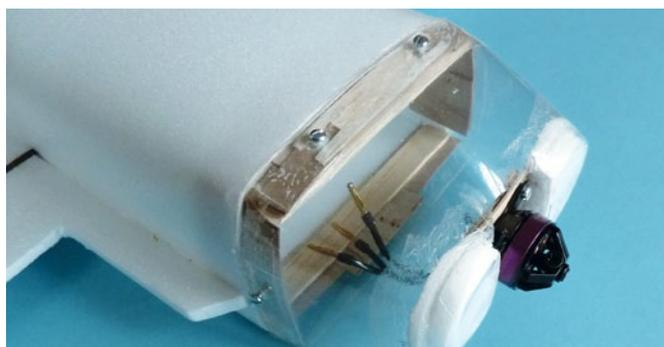
Die Motorträger-Düse wird mit fünf kleinen Blechschrauben befestigt
