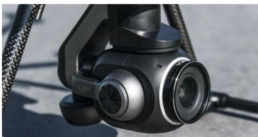
Die um drei Achsen schwenkbare Kamera verfügt über einen 1-Zoll-Sensor
