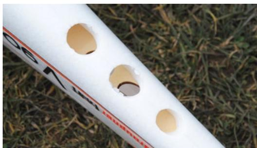
Öffnungen auf der Rumpfunterseite lassen die Kühlluft entweichen
