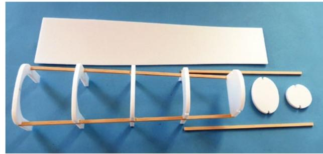
Die ersten Spanten wurden mittels Kiefernleisten zusammengeklebt, weitere Teile und der Rumpfboden liegen schon bereit
