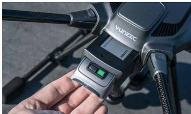
Der Akku wird von hinten eingeschoben und über eine Klappe entriegelt
