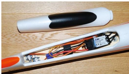
Ein bereits eingeklebter Sperrholzspant verläuft nahezu über die gesamte Länge des Rumpfs und verleiht die nötige Steifigkeit
