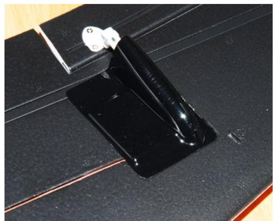
Die Querruderservos sind optimal untergebracht und komplett betriebsfertig verbaut
