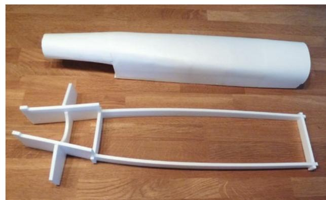
Eine Lehre aus 6-Millimeter-Depron, in die der Rumpf für das Anpassen der Tragfläche eingelegt wird, erleichtert den Zusammenbau
