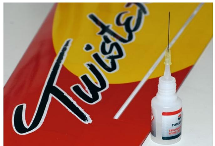
Nur mit Hilfe einer aufgesetzten Injektionskanüle lassen sich die Vliesscharniere sauber in den bereits angebrachten Scharnierschlitzten verkleben
