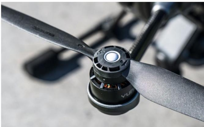
Dank farblicher (weiß oder schwarz) Kennzeichnung und der cleveren Schnellverschlüsse sind die Propeller schnell montiert
