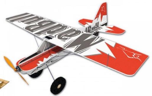
Der **Mad Bull** von Pichler Modellbau ist ein Flachschaummodell, das für den Kunstflug geeignet ist. Das EPP-Modell hat eine Spannweite von 925 Millimeter, ist 810 Millimeter lang und wiegt ab 195 Gramm. Geliefert wird er als Fertigteilesatz. Ohne Elektronik ist er ab 69,- Euro erhältlich, mit kompletter Ausstattung (Antrieb, Regler und Servos) kostet er 149,- Euro.
