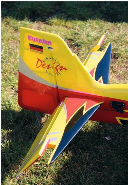
Die maximalen Ruderausschläge wird ein Umsteiger sicherlich nicht gleich voll ausreizen, doch sie erlauben ein „Mitwachsen“ des Modells mit dem Können des Piloten
