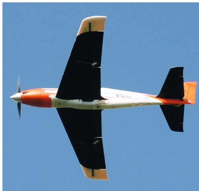
Die dunkle Unterseite ermöglicht eine gute Erkennung der Fluglage
