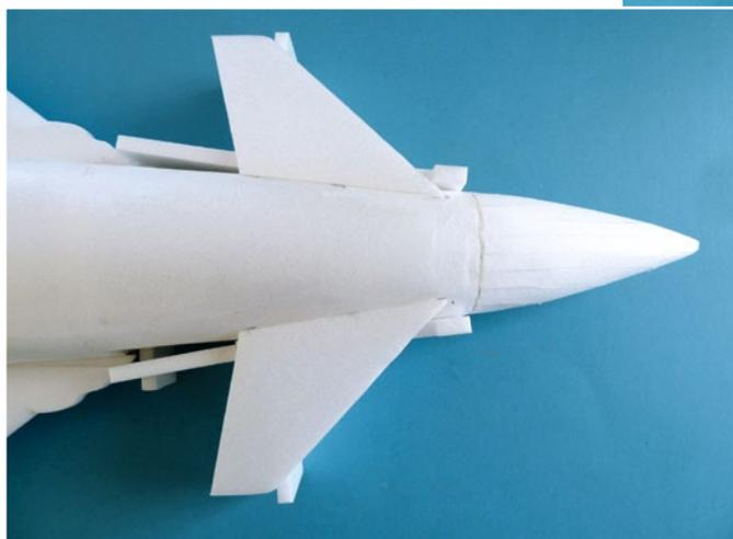
Mit Hilfe der Baulehre werden die Canards an passender Stelle angeklebt
