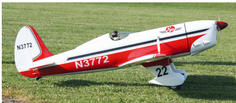
Beim ersten Start kam es zu einem Kopfstand, weshalb es beim zweiten Versuch mit größerem Höhenruderausschlag auf die Piste ging
