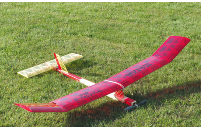
Der Witch Hawk von Jim Clem ist ein Motormodell aus den 1970er-Jahren. US-Klasse bis 500 Quadrat Zoll und Motoren 3,5 bis 5 Kubikzentimeter. Der RC-Motorsegler hat Flügel, Höhenleitwerk und Rumpf in Originalgröße. Spannweite 1.520 Millimeter, Profil Aquila 10 Prozent
