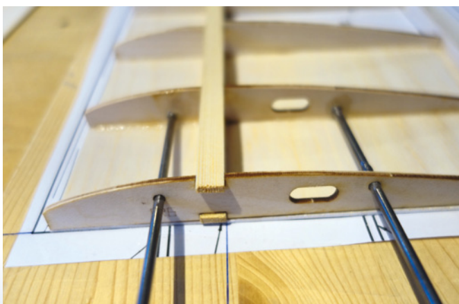
Die Position und der Winkel der 3-Millimeter-Stahldrähte für die Flächenverbindung ist von den Sperrholzrippen vorgegeben und passt auf Anhieb
