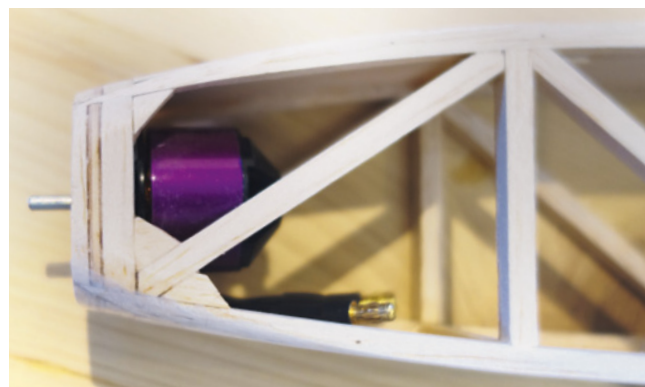
Die Rumpfnase muss vor dem Verschleifen noch aufgedoppelt werden, um die Krafteinleitung der Rumpfgurte zu gewährleisten
