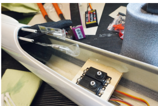
Die beiden Servos für das Leitwerk sitzen auf einem kleinen Servobrettchen, das mit Epoxy verklebt wurde
