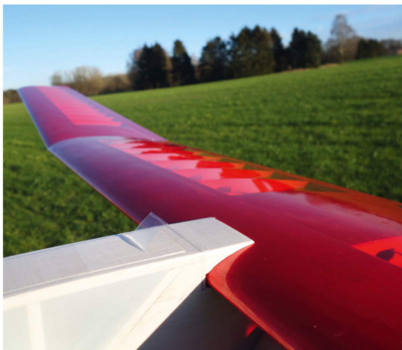
Der selbstgefertigte Übergang von Rumpf zu Tragfläche ist einfach und schnell zu erstellen und wertet das Modell ungemein auf
