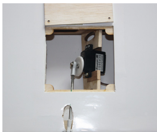
Der Einbau der Querruderservos ist einfach, da gut vorbereitet. Selbst dann, wenn man Kompaktservos unterhalb der Normalgröße wählt
