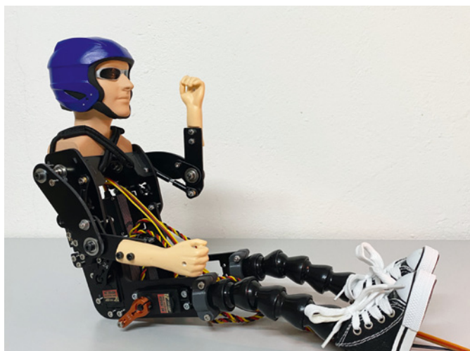
Von Minimum zu Maximum haben Mikes Arme einen Weg von rund 240 Millimeter
