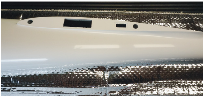
Der Tragflächenübergang am Rumpf ist bereits für die Montage eines grünen Multiplex-Steckers vorgesehen
