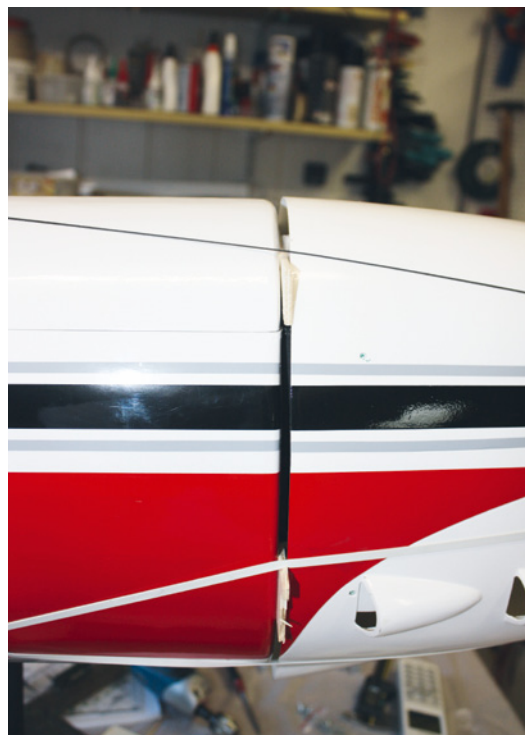
Passgenaues Anbauen der GFK-Motorhaube unter Zuhilfenahme der vorhandenen Dekorlinien. Man achte auf den vorbildgetreuen Luftschlitz zwischen Rumpf und Nase
