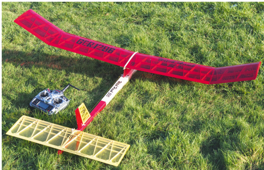
Der Witch Hawk von Jim Clem ist ein Motormodell aus den 1970er-Jahren. US-Klasse bis 500 Quadrat Zoll und Motoren 3,5 bis 5 Kubikzentimeter. Der RC-Motorsegler hat Flügel, Höhenleitwerk und Rumpf in Originalgröße. Spannweite 1.520 Millimeter, Profil Aquila 10 Prozent
