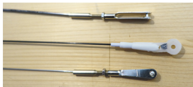
Der Wechsel von Metall- und Kunststoff-Rudergestänge trägt unter anderem zum Gewichtsunterschied von 170 g bei
