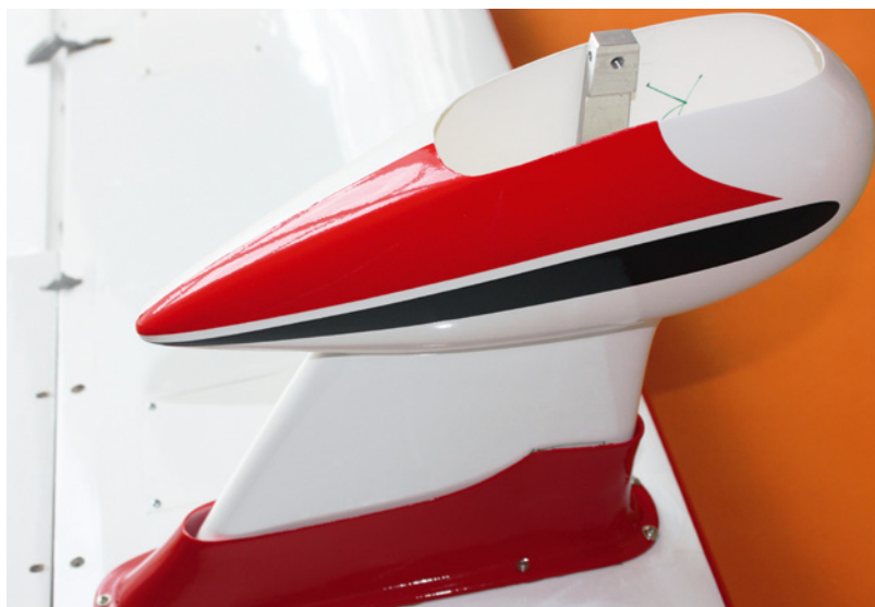
Starres Fahrwerksbein mit eigentlich flexibler, weil zweiteilig ausgeführter Verkleidung. Da ließe sich noch was machen
