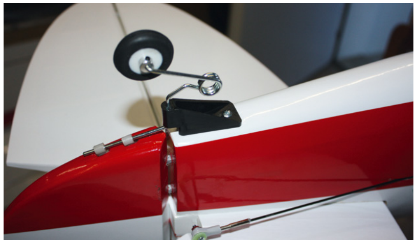
Drahtgefedertes Spornrad – nicht scale, aber funktional
