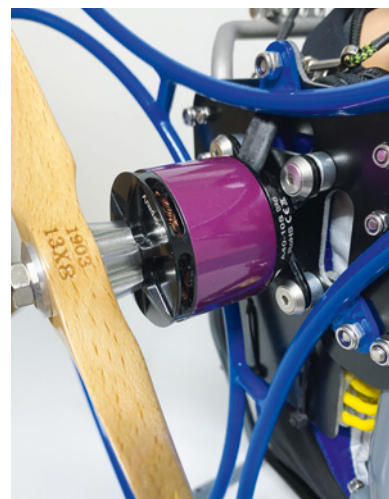
Ein Hacker-Motor vom Typ A40-10S sorgt für Vortrieb
