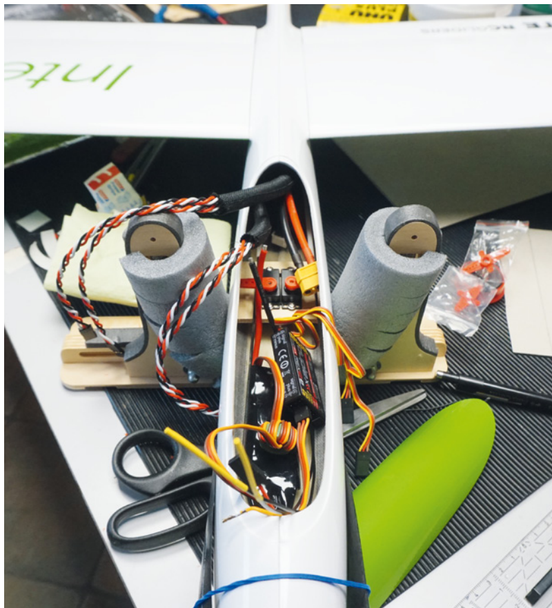
Vor dem finalen Einbau der Komponenten wurde getestet, ob der Schwerpunkt passt
