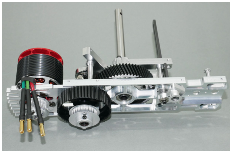
Mehrstufige Getriebe bauen deutlich schmaler als die zum Beispiel bei Mikado-Hubschraubern verbauten, einstufigen Varianten
