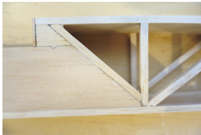
Der Bereich des Tragflächen-Aufnahmespanns sollte unbedingt mit einer zusätzlichen Leiste stabilisiert werden, sonst kann es schnell passieren, dass die Rumpfsseitenwand längs der Maserung reißt
