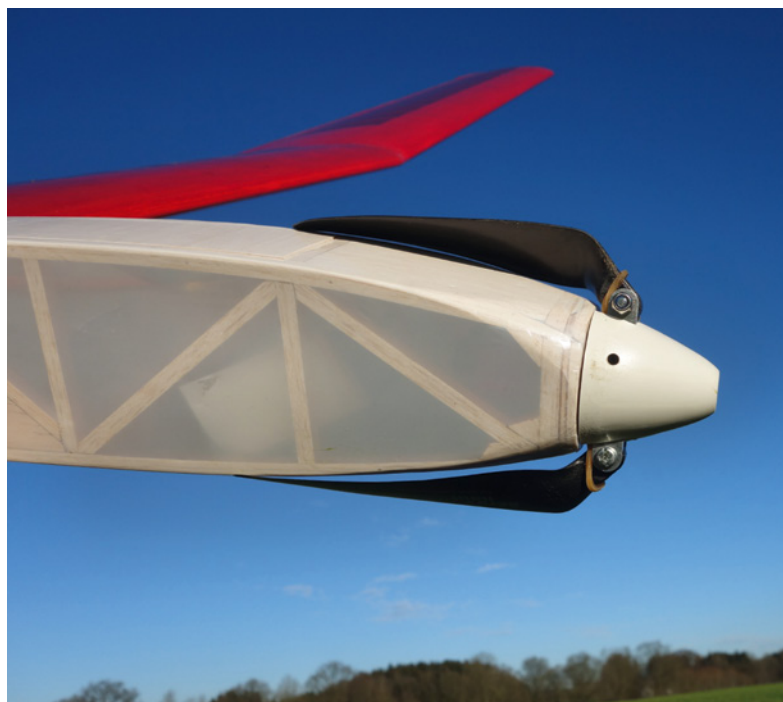
Ein Gummi um die Propellerblätter zieht diese im Gleitflug eng an den Rumpf. Der Fahrtwind allein ist hierzu nicht ausreichend
