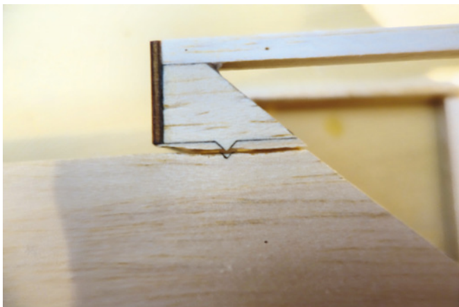
Der Bereich des Tragflächen-Aufnahmespanns sollte unbedingt mit einer zusätzlichen Leiste stabilisiert werden, sonst kann es schnell passieren, dass die Rumpfsseitenwand längs der Maserung reißt
