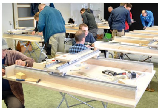
Unter fachkundiger Anleitung baut jeder Kursteilnehmer eine eigene Fräse
