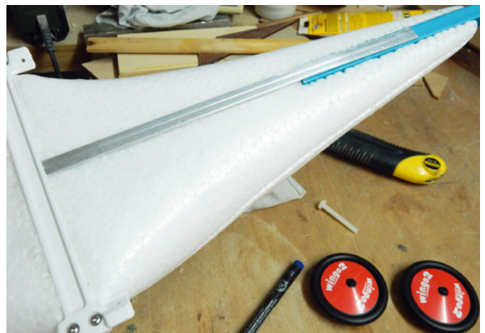
Der Leitwerksträger bildet mit dem Fahrwerksträger und einem Alu-Holm eine sehr stabile Einheit
