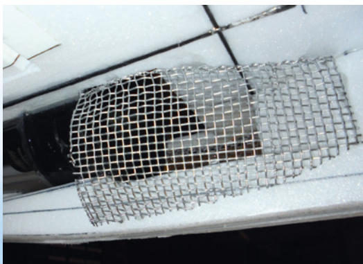
Feine Drahtgitter vor dem unteren Einlaufbereich des Impellers halten Fremdkörper fern
