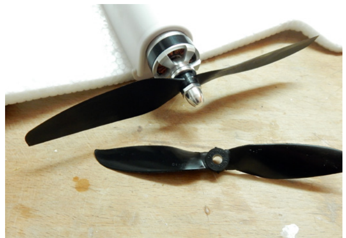
Der Motor darf an einem eleganten Kunststoffträger Platz nehmen und je nach Leistungsbedarf mit unterschiedlichen Luftschaublen bestückt werden
