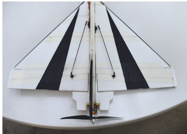
Der Jet besteht hauptsächlich aus 6-Millimeter-Depron, CFK-Profilen und Klebeband. So sind Reparaturen kein Problem
