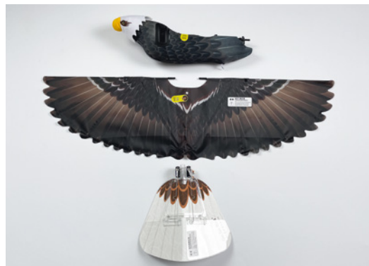
Der Vogel wird aus drei Hauptbaugruppen zusammengesetzt
