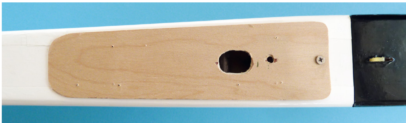
Nachdem die Einschlagmutter von innen angeklebt wurde, kann die neue Impellerklappe vorne mit einer Schraube befestigt werden. Das große Loch in der Klappe dient der Durchführung der Motorkabel in den Rumpf
