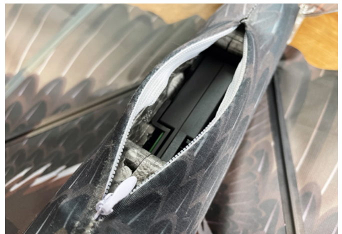
Im Bauch des Eagle wird der Akku platziert. Ein Reißverschluss erlaubt einen einfachen Wechsel des Stromspenders
