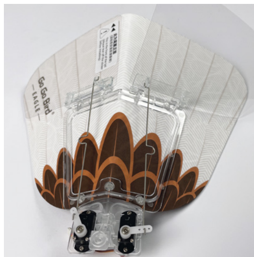
Zwei Ruderkappen am Schwanz des Adlers dienen zur Steuerung
