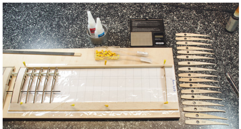
Die Balsarippen werden einzeln gewogen und nach Gewicht von innen nach außen eingesetzt
