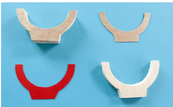
Nach einem Muster aus Pappe werden aus Sperrholz und Balsa einzelne Bauteile gefertigt, die zu einer Auflage im Sandwich-Verfahren zusammengeleimt werden
