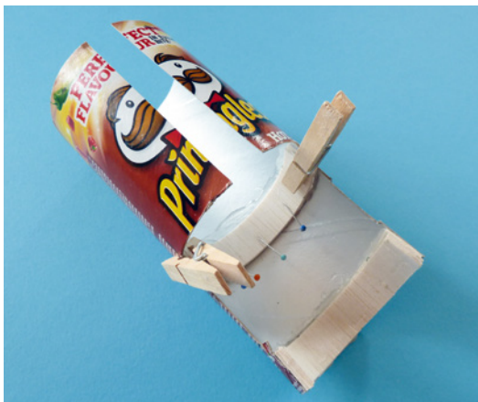
Die Impellerverkleidung wird von innen mit mehreren Schichten aus 1,5-Millimeter-Balsa verstärkt
