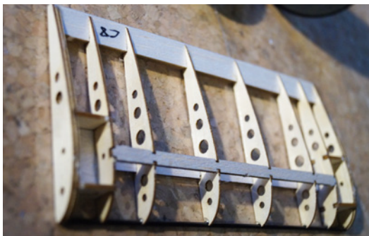
Selbst die kleine Tragfläche zwischen den Rädern entsteht aus filigranen Holzteilen
