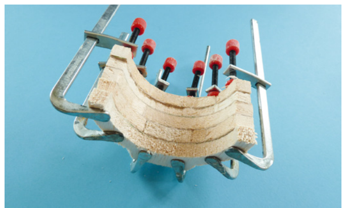
Damit der Befestigungsfuß eine möglichst hohe Festigkeit erreicht, werden die einzelnen Holzschichten verpresst, während der Leim trocknet
