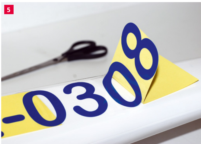
5 Das Trägermaterial langsam nach außen wegarbeiten. Dabei vorsichtig und gleichmäßig arbeiten, so entstehen keine Blasen oder Falten
