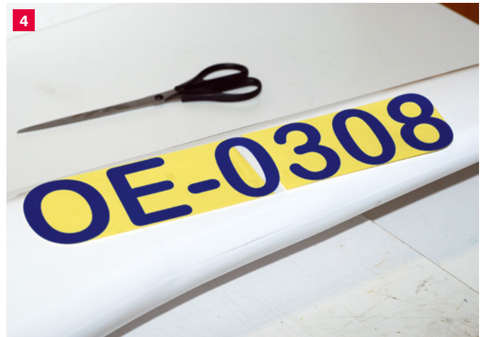
4 Jetzt kann der Aufkleber auf dem Trägermaterial verschoben und exakt positioniert werden. Dann den offenen Streifen andrücken
