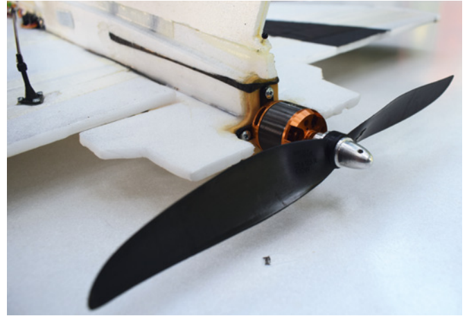
Der Pusher-Antrieb ist mit leichtem Sturz eingebaut
