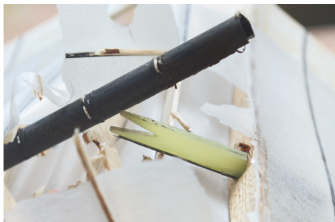
Die Knickverstärkung steckte im Außenflügel und kann weiterhin genutzt werden
