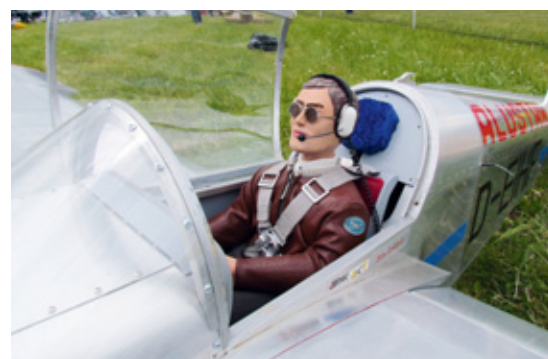
Eine Yakovlev Yak 112 beim Seilabwurf. Das Modell ist der Nachbau eines leichten, russischen Mehrzweckflugzeugs. Das Original benötigt eine Startstrecke von nur knapp 300 Meter. Der 140-Kubikzentimeter-King-Boxermotor verleiht dem Modell vergleichbare Eigenschaften. Die Spannweite beträgt 3.500 Millimeter
