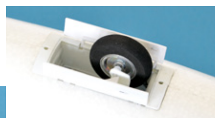
Das Rad fährt nicht nur auf Knopfdruck ein, die Mechanik wird auch von Klappen verdeckt. Wie beim Original
