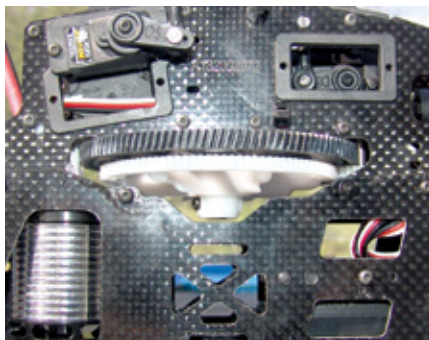
Das schrägverzahnte Hauptgetriebe sorgt für leises Betriebsgeräusch
