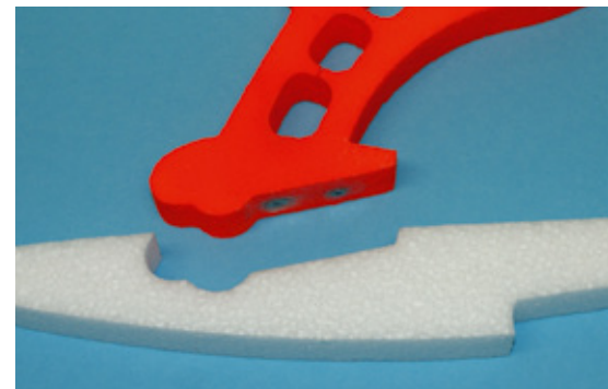
Das Fahrwerk passt saugend in die Schwimmer, die zusätzlich durch je zwei Magnetpaare gesichert werden
