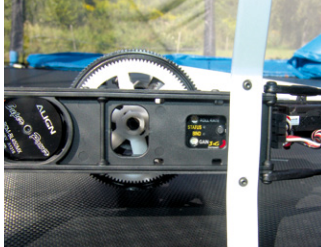
Durch eine entsprechende Aussparung in der Lagerleiste können Empfindlichkeitsregler und Bind-Taste des 3GX gut erreicht werden
