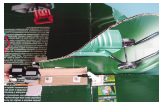
Servos, Schubstangen, Ruderhorn und Seitenleitwerk – eine kompakte Einheit
