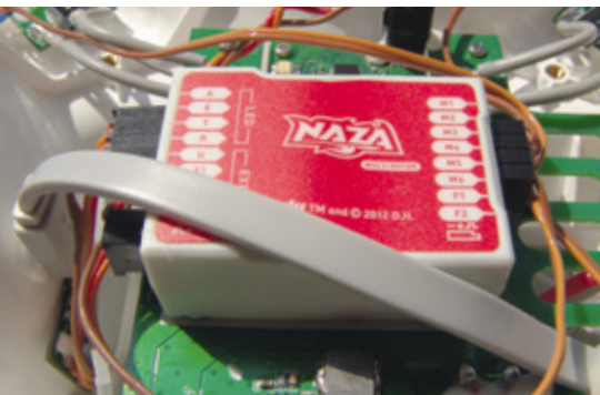
Das Herzstück des Kopters ist die Naza-M-Flight-Control, die zentral im Rahmen platziert ist
