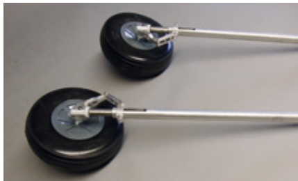
Beim Fahrwerk war es das Ziel, das Fahrwerk am fertigen Modell so schnell wie möglich wechseln zu können
