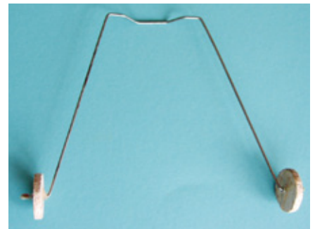
Entstanden ist das Fahrwerk aus einem Federstahldraht und zwei Balsa-Scheiben
