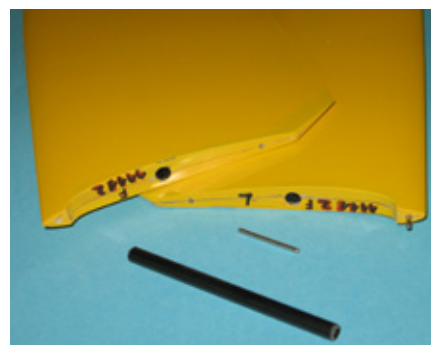
Das Höhenleitwerk wird über ein CFK-Rohr am Rumpf gelagert, die Kraftübertragung übernimmt ein 2-Millimeter-Stahldraht
