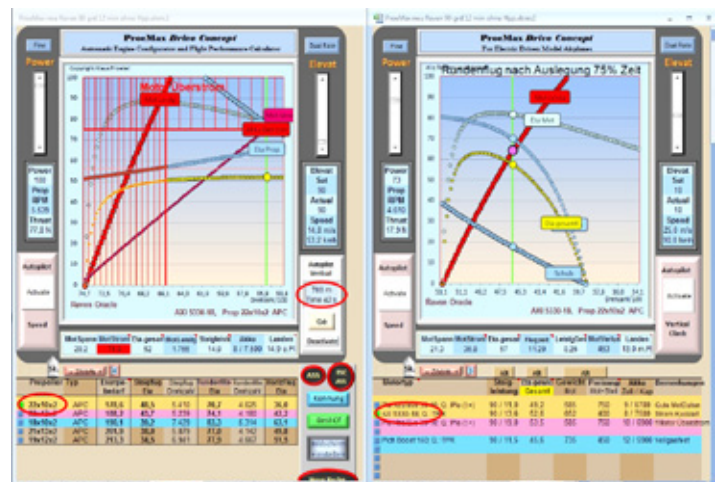
Bild 7: Noch mehr Steigleistung gegenüber Bild 6, nämlich 13,6 Meter pro Sekunde, schafft der AXI 5330-18 an acht Zellen mit 7.500 Milliamperestunden Kapazität in Verbindung mit einer 22 x 10-Zoll-Luftschaube. Allerdings muss er dazu im Grenzstrombereich von 75 Ampere arbeiten. Das kann er nach Spezifikation 60 Sekunden lang. Dann ist die Raven aber schon oben, sie benötigt nur 42 Sekunden
