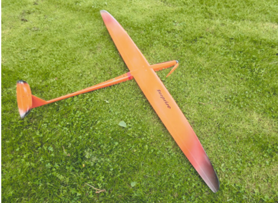
Bild 1: Surprise XVII, ein F5B-Modell von Freudenthaler. Ein Modell dieser Art wird mit einem Antrieb für straffen Vertikalflug bei gleichzeitig langer Motorlaufzeit ausgestattet. Etwas mehr Platz für Akkupakete wird jedoch benötigt
