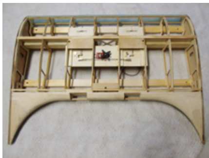
Alle notwendigen Servos wurden eingebaut sowie die Ausklüngen für den Standmann
