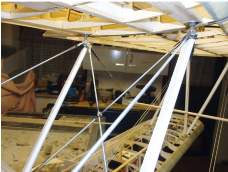
Die Seilverspannung sorgt für eine starke Festigkeit
