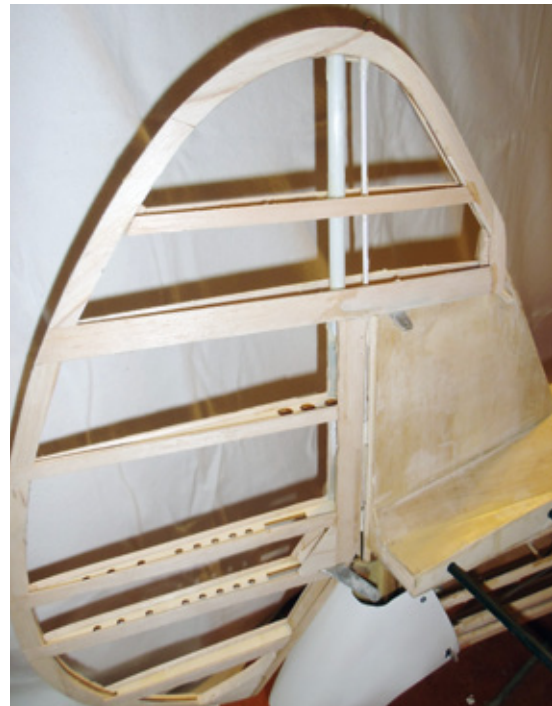
Die Dämpfungsflosse des Seitenleitwerks wird beplankt. Es folgt die Aufnahme für die Höhenleitwerksverspannung
