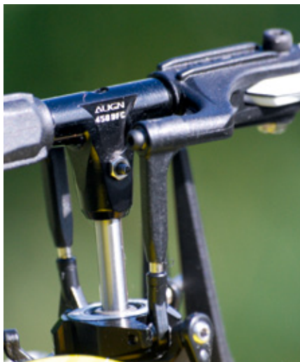
Das Heckservo ist elegant in einem gesonderten Halter unter der Heckrohr-Befestigung untergebracht
