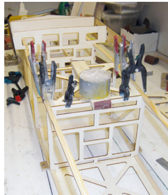
Der Kastenrumpf entstand durch das Einarbeiten von flächenhaften Verbindungen zwischen die einzelnen Leisten
