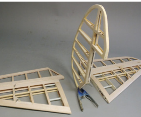
Das Leitwerk in seine Teile zerlegt
