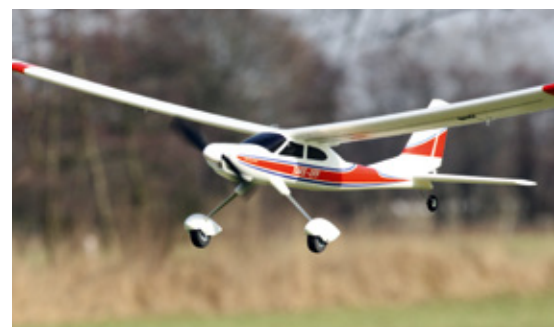
Auf den ersten Blick wird klar: Das ist ein Einsteigermodell. Die große V-Form, das geringe Gewicht und die damit verbundene, niedrige Fluggeschwindigkeit sorgen für ein gutmütiges Verhalten in der Luft
