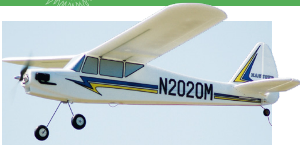
Ein klassischer Motortrainer für Einsteiger: 1.200 Millimeter Spannweite, über Höhen- und Seitenruder gesteuert, mit Elektroantrieb und aus Hartschaum gefertigt. Nur viel Wind mag so ein Modell nicht
