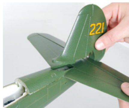
Zur Fertigstellung ist bei beiden Modellen das Seitenleitwerk am Rumpf anzukleben. Wie hier am Beispiel der P-39 zu sehen ist
