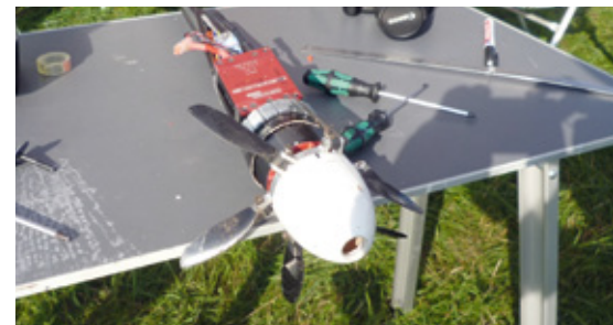
Alles ist erlaubt – wie zum Beispiel diese eigens angefertigte Sechsstab-Klappflugschraube der Aka Modell der TU München, geflogen von Jakob Karpfinger. Der Sound gleicht dem eines Turbinenantriebs
