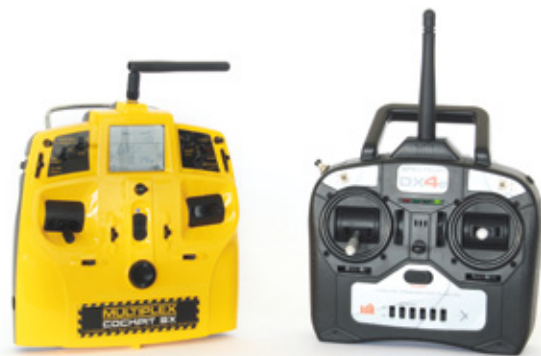
In Ready-to-Fly-Komplettsätzen liegen meist nur einfache Fernsteuerungen bei (rechts), die lediglich die wichtigsten Einstellmöglichkeiten bieten. Wer längerfristig Spaß am Hobby haben will, sollte sich zumindest eine einfache Computer-Fernsteuerung (links) zulegen
