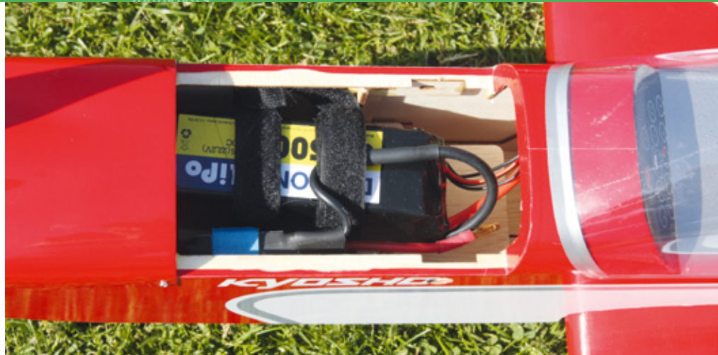
Der 6s-LiPo findet gut Platz – genauso wie der 80-Ampere-Smart-Regler direkt daneben
