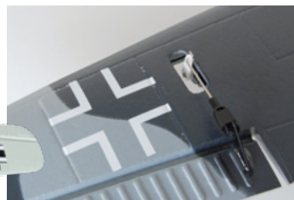
Die Anlenkung der Querruder erfolgt auf der Oberseite der Tragfläche. Auf diese Weise sind Servo und Gestänge bei der Landung geschützt
