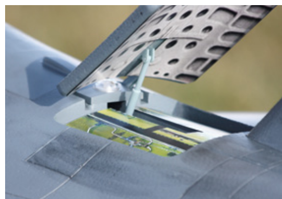
Für die Innenseiten der Airbrake wurden Bilder eines Originals verkleinert, ausgedruckt und eingeklebt
