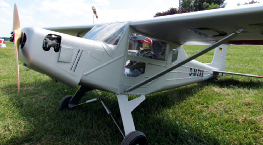
Eine interessante Eigenkonstruktion ist die Wild Thing von Lothar Wendt. Der Nachbau eines Ultra-Leichtflugzeugs hat eine Spannweite von 3.050 Millimeter und wird von einem 100-Kubikzentimeter-Moki-Viertakter angetrieben
