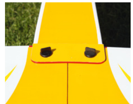
Die Tragfläche wird ohne Werkzeug einfach mit zwei Schrauben fixiert
