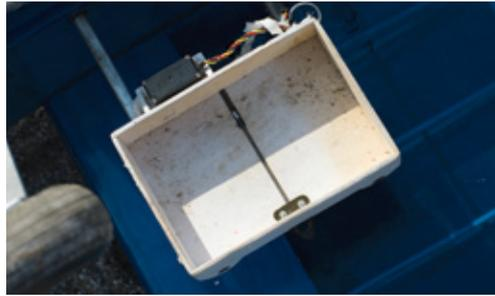
Die Abwurfschächte sind in der Regel aus einfachem Sperrholz gebaut, wobei es bei den Ausklinkmechanismen deutliche Unterschiede gibt
