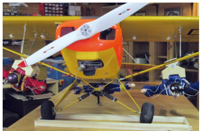
*Diese Piper PA-18 ist ein Eigenbau mit einer Spannweite von 3.000 Millimeter und einem Gewicht von 14 Kilogramm*
