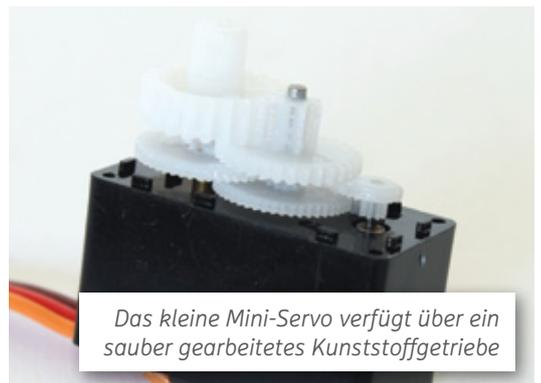
Das kleine Mini-Servo verfügt über ein sauber gearbeitetes Kunststoffgetriebe
