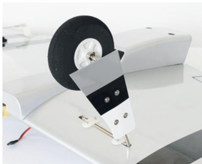
Die Fahrwerke sind zwar nicht einziehbar, aber die Attrappen der Fahrwerksschachtabdeckungen erhöhen den Scalefaktor
