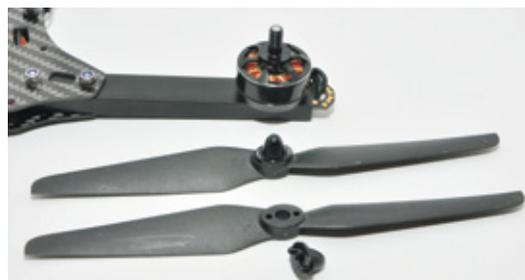
Die Propellermontage ist laufrichtungsspezifisch mit einem CW-/CCW-Gewinde auf der Welle (silber/schwarz, hier silber), analog dazu die speziellen Kunststoffmutter an den Propellern, sodass die Props ohne Werkzeug einfach von Hand befestigt/gelöst werden können
