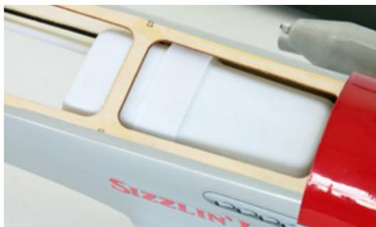
Der Tank passt exakt an die für ihn vorgesehene Stelle und wird mit einem Klettstreifen befestigt
