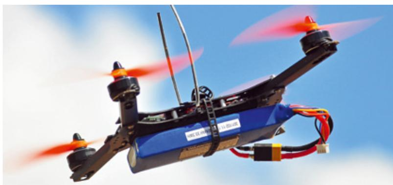
Mit einem großen 3.000-Milliamperestunden-3s-LiPo sind mit den 6-Zoll-Propellern Flugzeiten von bis zu 25 Minuten möglich. Dafür ist das Akku-Mehrgewicht spürbar und der Kopter damit weniger „spritzig“
