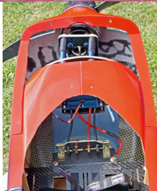
Wo beim Verbrenner der Tank sitzt, werden beim Elektromodell die Akkus platziert
