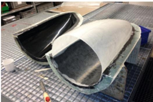
Auf Basis eines Urmodells, hier der Rumpfbug, entstanden Negativformen, um daraus GFK-Positive zu erstellen
