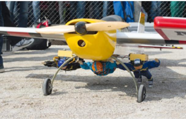
Auch Kunstflugmaschinen wie diese Extra 300 sind zum Absetzen von Fallschirmspringern geeignet. Angetrieben von einem ZDZ-70-Kubikzentimeter-Motor befördert das Modell bis zu drei Springer gleichzeitig in die Luft
