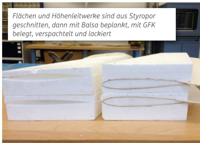
Flächen und Höhenleitwerke sind aus Styropor geschnitten, dann mit Balsa beplankt, mit GFK belegt, verspachtelt und lackiert
