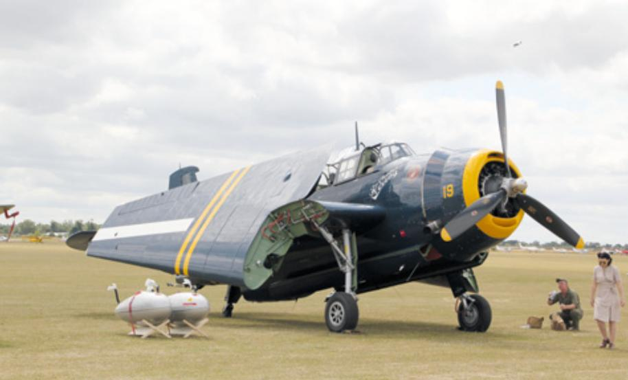
Die Grumman TBM Avenger mit angeklappten Tragflächen
