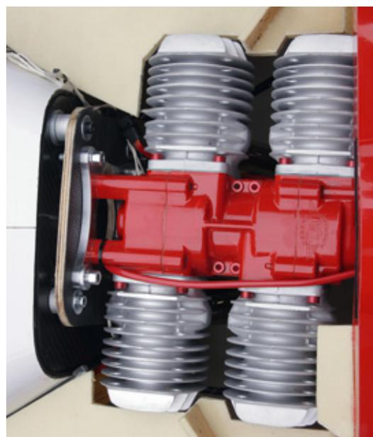
Hier ein sehr edler DA 200 mit Magnesium-Gehäuse sowie der entsprechenden Luftführung
