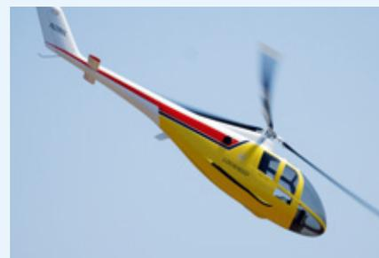
Die elektrisch betriebene Lockheed 286 von Stefan Witte im Maßstab 1:5,3. Das Modell hat serienmäßig Einziehkufen. Der Rotordurchmesser beträgt zwei Metern, das Abfluggewicht etwa 10.500 Gramm
