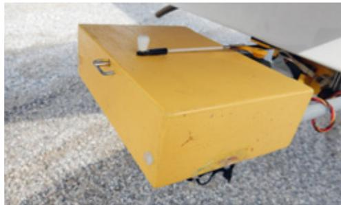
Hier wird das Halteband ähnlich wie bei einer Schleppkupplung einfach über einen Splint fixiert, der über ein Servo bewegt wird
