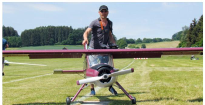
Thomas Höchsmann und seine PZL Wilga im Maßstab 1:3. Das Modell hat eine Spannweite von 3.700 Millimeter und ist ausgerüstet mit einem Fünfzylinder-Viertakt-Sternmotor
