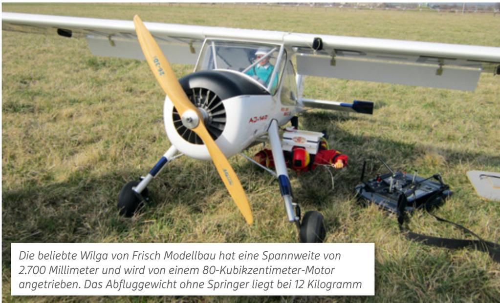
Die beliebte Wilga von Frisch Modellbau hat eine Spannweite von 2.700 Millimeter und wird von einem 80-Kubikzentimeter-Motor angetrieben. Das Abfluggewicht ohne Springer liegt bei 12 Kilogramm
