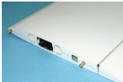
In den Tragflächen befinden sich Ballastkammern, durch die sich das Abfluggewicht des Tracer nochmal erhöhen lässt
