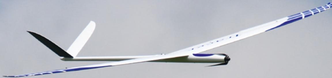
Eine Elektrifizierung von F3B-Segelflugmodellen ist wegen der geringen Rumpfquerschnitte oft nur mit sehr speziellen Komponenten möglich. Vielen Modellpiloten ist aber gerade das wichtig, um jederzeit und überall ohne großen Aufwand starten zu können. Für diejenigen bietet Cumulus Modellbau das F3B-/F3F-Modell Tracer auch in einer Elektroversion an.
