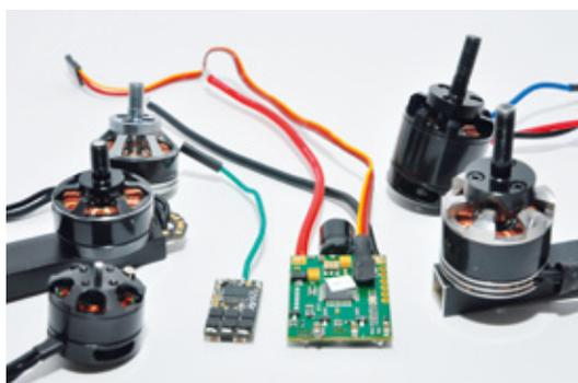
Race-Kopter-Antriebe „gestern“ und heute: rechts 2208/2212-Motoren mit 980 bis 1.100 kv und 20-Ampere-SimonK-Afro-Regler. Links die neuen 1806/2205/2206-Motoren mit 2.000 bis 2.300 kv und Kiss 18-Ampere-Regler (30 Ampere Peak)
