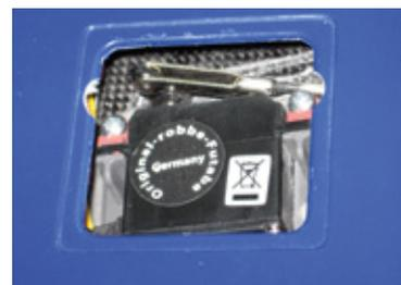
Die Flächenservos werden in Servorahmen geschraubt und mit der Flügeloberschale verklebt. Mit dem beiliegenden Anlenkungsmaterial werden dann die Überkreuzanlenkungen realisiert
