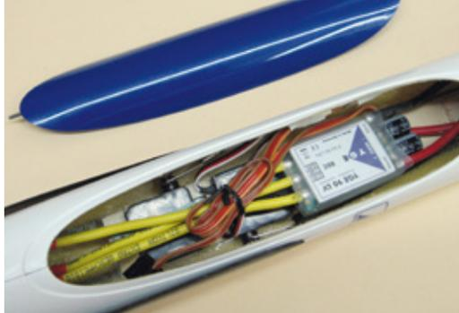
Der Regler liegt oberhalb der beiden Rumpfservos. Um den Antriebsakku zu entnehmen, wird er etwas nach vorne geschoben
