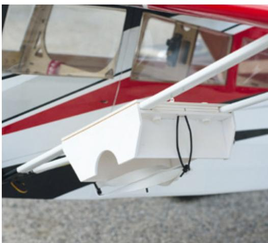
Diese Abwurfvorrichtung ist ein Eigenbau und an den Flächenstreben einer Maule befestigt
