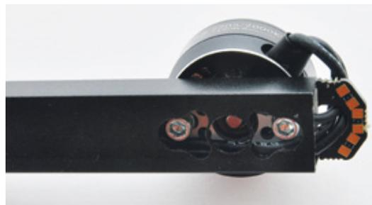
Motor und Kabelschutz zusammen im Arm verschraubt (hier sollte immer Schraubensicherung verwendet werden), der Regler ist jetzt eingeschrumpft links im Arm
