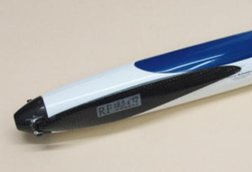
Der Elektrorumpf wurde speziell für einen 38-Millimeter-Spinner ausgelegt. Benutzt man einen Spinner mit versetztem Mittelstück, liegt die Luftschaube bestmöglich am Rumpf an
