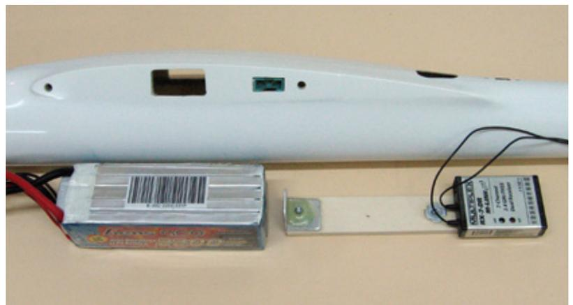
Der Empfänger sitzt weiter hinten im Rumpf auf einem Sperrholzbrett. Dies dient gleichzeitig als Anschlag für den Antriebsakku und wird von unten mit dem Rumpf verschraubt
