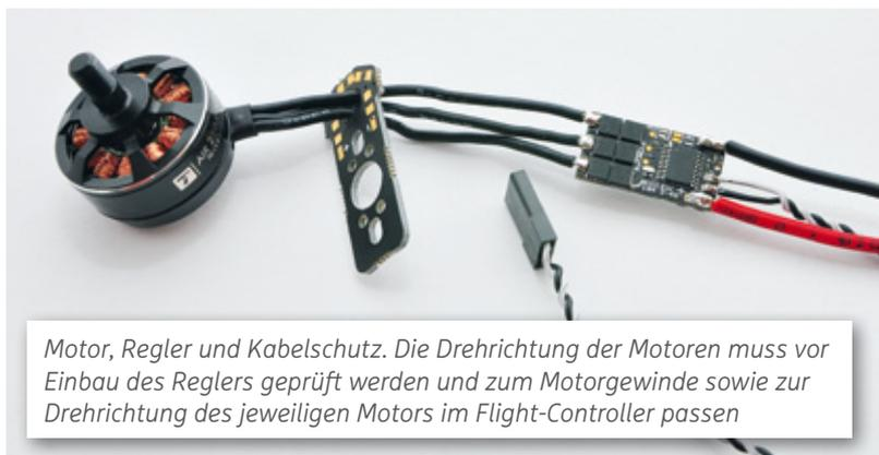
Motor, Regler und Kabelschutz. Die Drehrichtung der Motoren muss vor Einbau des Reglers geprüft werden und zum Motorgewinde sowie zur Drehrichtung des jeweiligen Motors im Flight-Controller passen
