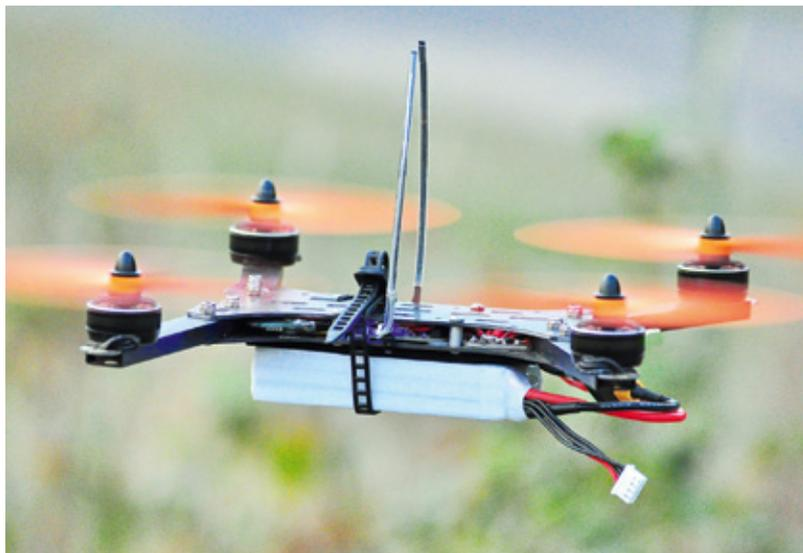
Mit einem kleinen 3s-LiPo ist der Kopter nachher besonders leicht und „spritzig“ bei gleichzeitig guten Flugzeiten. Mit 4s wird er richtig „wild“ und eignet sich auch für die schnellsten Rennen
