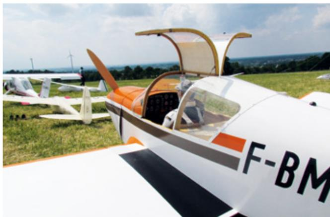
Fritz Eickhoff hatte seine wunderschöne Jodel D112 mit zur DM nach Schlangen gebracht. Das Modell ist ein absoluter Eigenbau im Maßstab 1:2,5. Bei einer Spannweite von 3.300 Millimeter hat das Modell ein Abfluggewicht von 24,7 Kilogramm. Angetrieben wird die Jodel von einem 140-Kubikzentimeter-Vallach-Viertakt-Boxermotor
