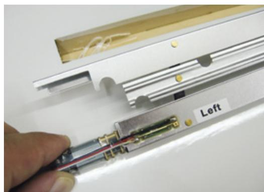
Auch der Einbau der Störklappen wurde von Hangar 9 vorbildlich vorbereitet, hier ist der Schacht für die Klappen schon freigelegt und die Folie umgebügelt. Nun werden die Klappen mit kleinen Schrauben in der Tragfläche fixiert
