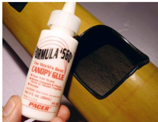
Die Cockpit-Umrandung kann für den „Scale-Look“ mit aufgeschnittenem Kunststoff- oder Gummischlauch ummantelt und mit flexiblen Spezialkleber verklebt werden
