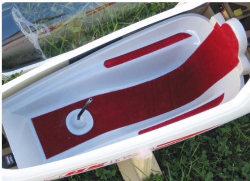
Mit den beiliegenden ABS-Teilen und dem roten Samtstoff lässt sich mit wenig Aufwand ein schönes Cockpit realisieren
