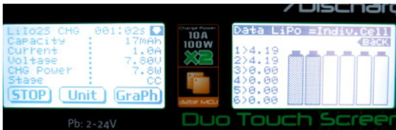
Links einen Lilon-Akku für den Sender und rechts ein LiPo-Akkupack für das Modell nachladen stellt mit dem Gerät kein Problem dar
