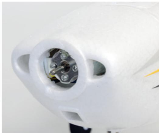
Der Brushlessmotor hat eine spezifische Drehzahl von 1.350 Umdrehungen pro Minute und Volt
