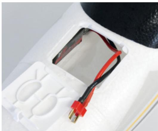
Praktisch: Über diese Klappe lässt sich der Akku schnell und einfach wechseln
