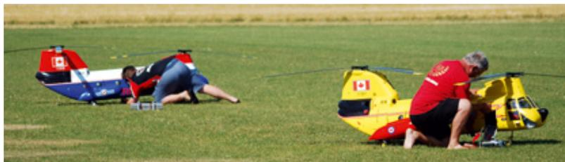
Startvorbereitungen an den mit Elektroantrieben ausgerüsteten „Bananas“, die 2.200 Millimeter Rotordurchmesser haben. Zum Einsatz kommen Dreiblatt-Hauptrotoren sowie ein Bordcomputer/Mischer inklusive Flybarless-Einheit von BavarianDemon (3SX)
