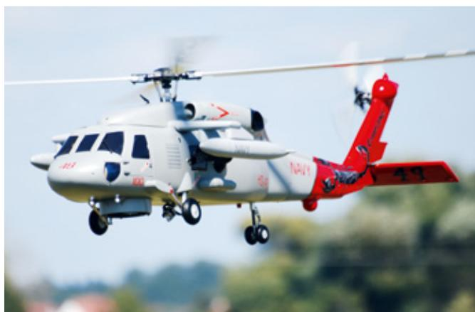
Die hervorragend gebaute und tadellos vorgeflogene Seahawk von Peter Konrad. Das 9 Kilogramm schwere Modell ist mit einer T-Rex 700-Mechanik und SK-Vierblatt-Hauptrotorsystem ausgerüstet
