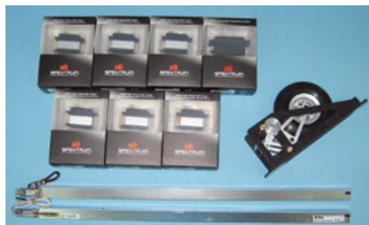
Wer auf das von Hangar 9 empfohlene Zubehör zurückgreift, braucht sich keine Sorgen zu machen, das Modell ist optimal darauf abgestimmt. Das Servo für die Schleppkupplung ist jedoch ein wenig zu schwach dimensioniert
