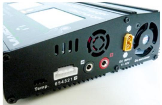
Das für den Anschluss an 12 Volt via XT60 Stecker benötigte Kabel liegt dem CTC Duo Touch ebenso bei wie ein Plastikstift für die Bedienung der Touchscreens. Die Balanceranschlüsse für maximal sechs Zellen sind im weitverbreiteten JST-Standard gehalten
