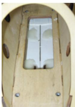
Die Fahrwerksklappen werden außen am Rumpf ausgerichtet und mit Klebeband fixiert, danach kann man von innen in aller Ruhe die Scharniere ankleben
