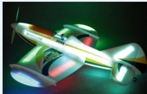
Die **Firefly** von Staufenbiel bringt Licht ins Dunkel. Als Spaß-Kunstflugmodell mit über 300 integrierten LED, die in verschiedenen Farben durch Rumpf und Tragflächen hindurch leuchten, ist die Firefly besonders in der Dämmerung ein Hingucker. Über den Sender können die LED ein- und ausgeschaltet sowie die Farben gewechselt werden. Die
