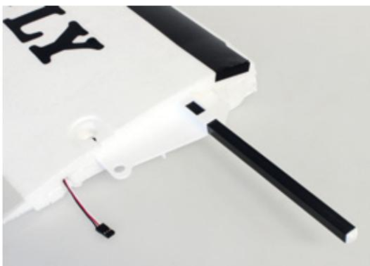
Der Tragflächenverbinder besteht aus einem CFK-Vierkanrohr und einem Kunststoffformteil – das ergibt eine solide Einheit
