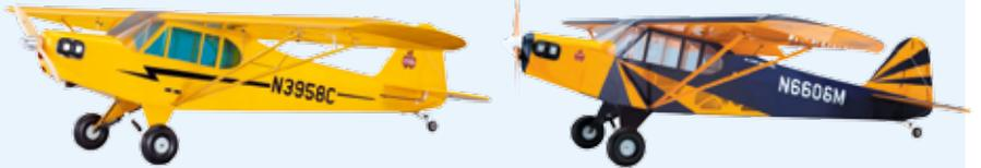
Gleich vier Piper-Neuheiten im Maßstab 1:4 bringt Ripmax auf den Markt. Und zwar zwei **Piper Super Cup** und zwei **Piper Cup**. Letztere unterscheiden sich von der ersten durch eine von 2.547 auf 2.330 Millimeter eingekürzte Fläche. Die Länge beträgt bei allen Modellen 1.676 Millimeter. Die in Holzbauweise erstellten ARF-Hochdecker sind bereits mit Folie bespannt, verfügen über eine GFK-Motorhaube, Räder und Alu-Fahrwerke. Die Modelle kosten je nach Version zwischen 379,- und 419,- Euro.
