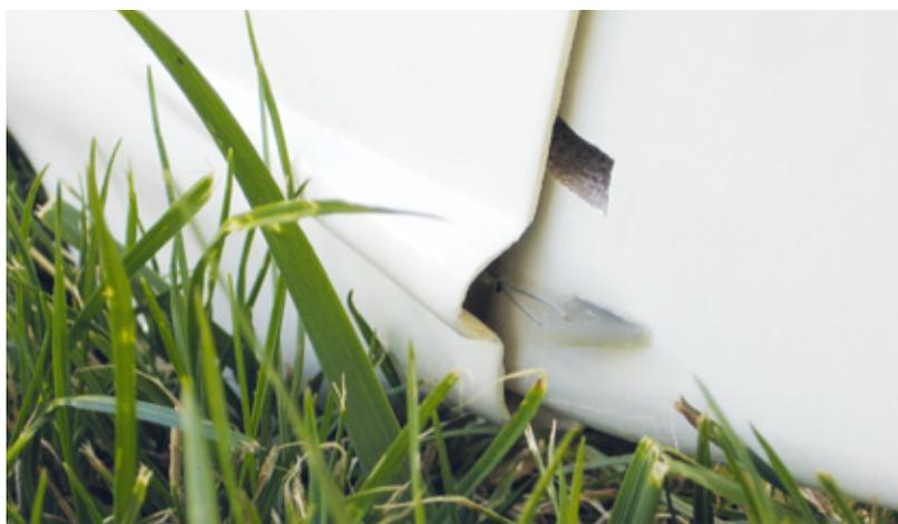
Für die Seitenrudernanlenkung besitzt der GFK-Rumpf beidseitig angeformte Hutzen
