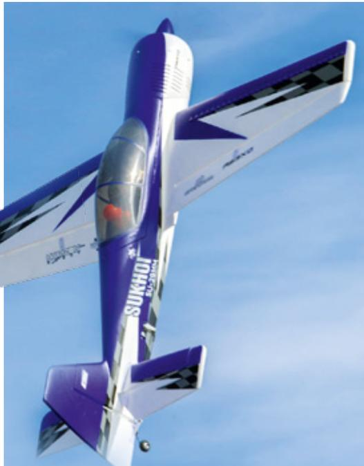
Mit 1.120 Millimeter Spannweite gehört die aus dem Hartschaum Z-Foam erstellte **Sukhoi Su-29MM Gen.2** zu den handlichen Aerobatik-Modellen. Ausgerüstet mit einem 3s-LiPo wiegt sie 1.150 Gramm. Zum Lieferumfang des 259,99 Euro kostenden BNF-Modells gehören ein Brushless-Antrieb, installierte Servos und ein AS3X-Empfänger mit implementierter Kreiseltechnologie.
