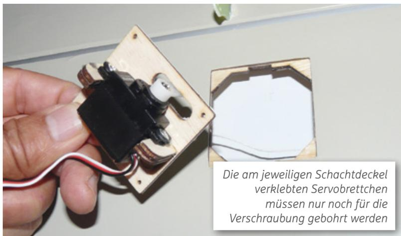
Die am jeweiligen Schachtdeckel verklebten Servobrettchen müssen nur noch für die Verschraubung gebohrt werden
