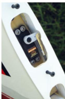
Das Höhenruderservo sitzt direkt im Seitenleitwerk, dadurch wird eine kräftige, spielfreie Anlenkung garantiert
