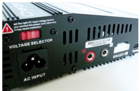
Der Strombereichsschalter mit 110 oder 230 Volt AC ist vor dem ersten Anschließen unbedingt zu kontrollieren. Auf beiden Seiten finden sich dieselben Anschlüsse für die bis zu sechszelligen Lithium-Akkus
