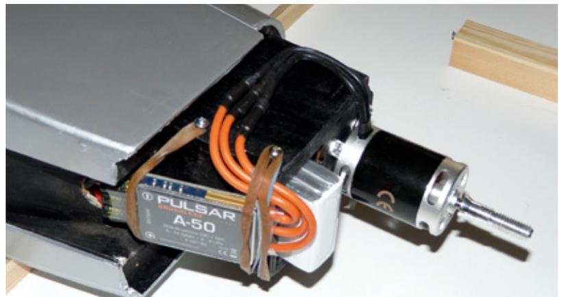
Der Regler ist direkt im Luftstrom der Motorraum-Entlüftung platziert. Die Fixierung erfolgt dort mittels Klettband
