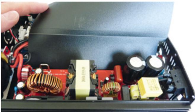
Erfreulicherweise kommt auch beim großen Bruder kein zweckentfremdetes Notebook-Netzteil als Stromversorgung zum Einsatz. Das ermöglicht nicht nur eine bessere Ladeleistung, sondern sorgt auch für eine geringere Wärmeentwicklung
