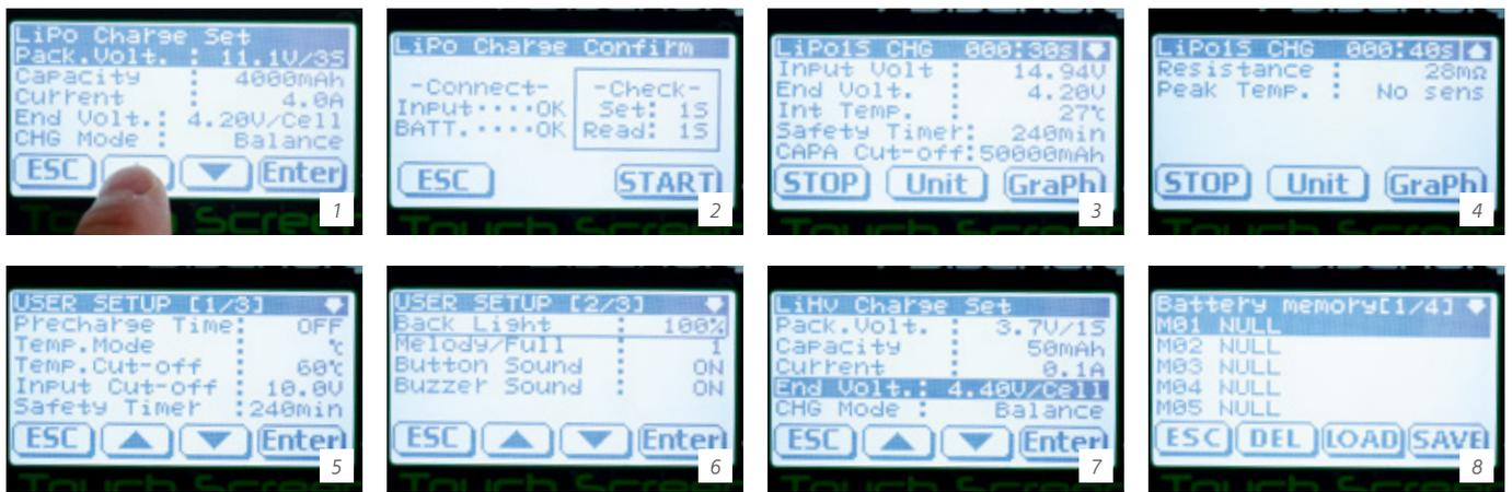
1. Die einstellbaren Werte lassen sich direkt in der Liste anklicken und dann über die Hoch-Runter-Taste rasch verstellen
