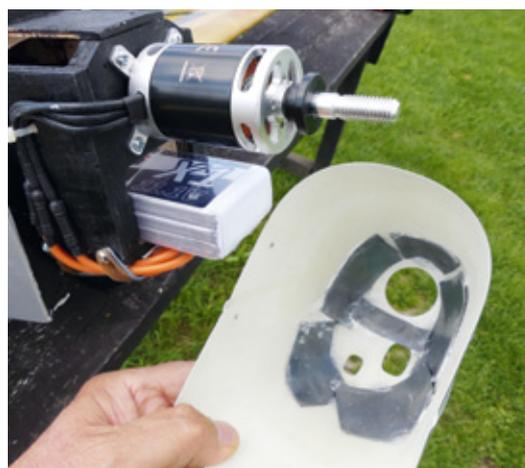
Die Motormontage ist schnell erledigt. Der 3s-LiPo mit 4.500 Milliamperestunden Kapazität passt leicht klemmend durch den Ausschnitt im Motorträger
