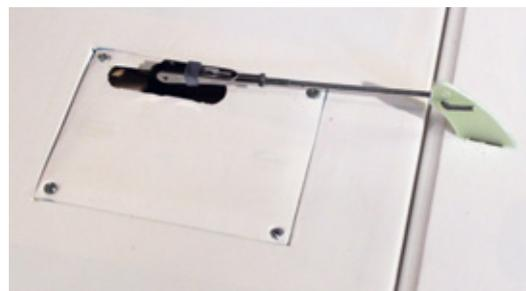
Die fertige Anlenkung mit Z-Anschluss am Ruderhorn
