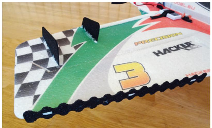
Die Airbrakes und Side Force Generators tragen maßgeblich zu den guten Langsamflug-Eigenschaften bei
