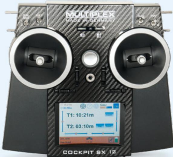
Der neue Multiplex 12-Kanal-Sender **Cockpit SX 12** verfügt über die Touch- und Fly-Technik und lässt sich somit bedienen wie ein Smartphone. Die Bewegungssensoren sorgen dafür, dass sich Funktionen wie Kamera, Telemetrie oder Schalter durch Drehen und Neigen des Senders steuern lassen. Die Safe-Link-Technologie schützt vor falscher Modellspeicher-Auswahl. Der Sender hat außerdem einen sechs-Klappen-Mischer und kommt in einer edlen Karbon-Optik daher. Der Preis: 499,90 Euro.
