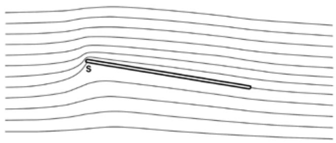
Bild 7: Bei einer leicht angestellten ebenen Platte bilden sich Strömungen, vergleichbar einem klassischen Tragflächenprofil. Allerdings tritt eine Einengung des Luftstroms nur an der Vorderkante der Platte auf, nicht jedoch auf der Rückenstrecke. Dies erklärt den geringen Auftrieb eines derartigen Profils
