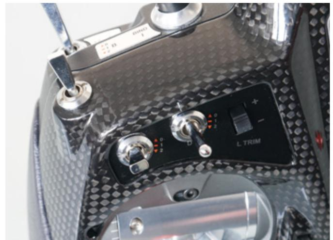
*Mit dem Taster L.Trim ist die ProTrim-Funktion verknüpft, um beispielsweise die Querruderdifferenzierung im Flugbetrieb exakt einzustellen*
