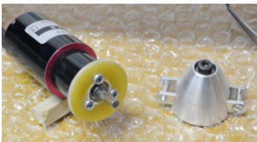
Der Motorspant besteht aus 2 Millimeter starkem GFK. Es fehlen noch die Kühlschlitze
