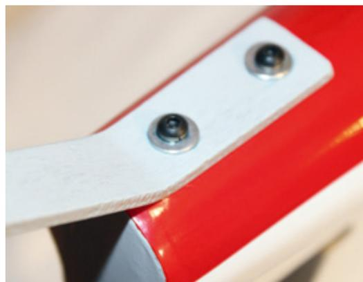
... mit zwei Schrauben unter das Rumpfeingefedert geschraubt
