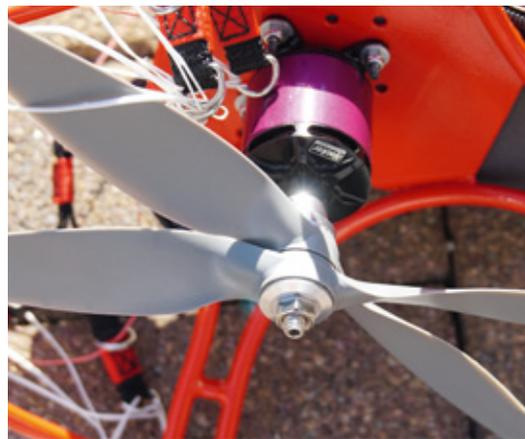
So werden die beiden Druckluftschrauben optimal auf dem Außenläufermotor montiert
