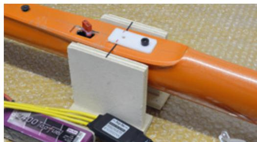
Ohne Tragfläche und Leitwerk wird der Schwerpunkt der Ursprungs-Ausführung ermittelt
