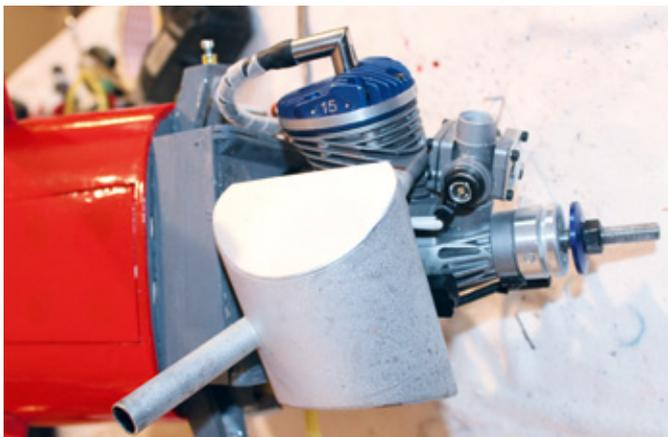
Der kompakte Schalldämpfer verschwindet später unter der Motorhaube
