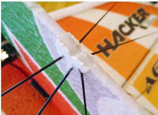
Die genaue Position der Spritzgussverstärkung ist durch eine Kerbe im EPP bereits eindeutig ab Werk markiert
