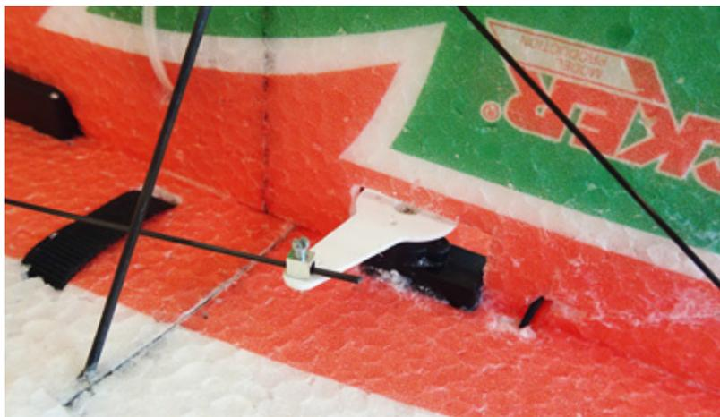
Die dem Bausatz beiliegenden Spritzguss-Servoarme sind Garant für extreme 3D-Ausschläge
