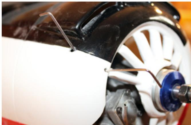
Um die Düsenadel später gefahrlos einstellen zu können, wurde diese mit Federstahldraht verlängert
