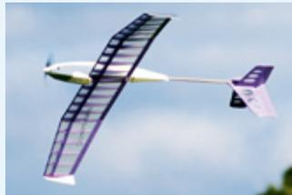
Der 1:1-Bauplan und die deutsche Bauanleitung sind mit dabei. Durch das modifizierte S7037 Tragflächenprofil kommt das 230 Gramm leichte Modell (Segler-Version) laut Hersteller gut gegen den Wind an. Durch den verkasteten Kiefernholm ist auch für ausreichende Stabilität der Tragfläche gesorgt. Den Segler-Bausatz gibt es ab sofort für 49,- Euro, die Elektro-Variante für 55,- Euro.
