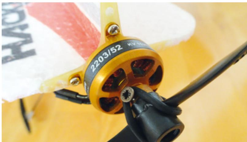
Der GFK-Motorspant passt ab Werk auch für den AXI-Motor perfekt
