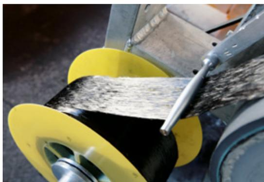
**Carboline** ist eine ultradünne doppel- oder mehrlagige Carbon-Faser, die nicht gewoben, sondern in sich unidirektional in verschiedenen Lagen verarbeitet ist. Diese Machart ermöglicht laut Hersteller extrem leichte und enorm stabile Konstruktionen, die vor allem auch bei hohen Temperaturunterschieden sehr formstabil sind. In der Produktion kann die Verarbeitung von Carboline einfach angepasst werden,
