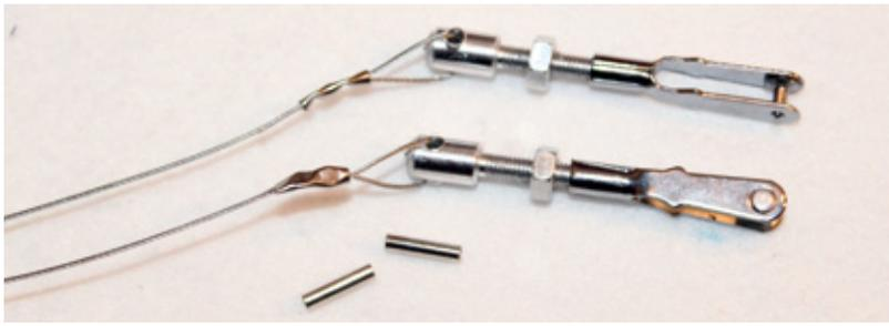
Die Spornrad-Anlenkung erfolgt über das Seitenruderservo mit Drahtlitzen
