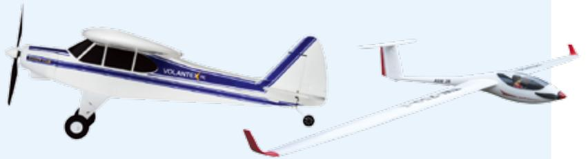
Der Elektrosegler **ASW28** von Arkai hat eine Spannweite von 2.800 Millimeter, verfügt über Querruder und ein T-Leitwerk und ist mit einer Pilotenpuppe ausgestattet. Das PNP-Modell wird mit bereits fertig installierten Servos ausgeliefert und kann als Elektro-Version, aber auch als reiner Segler geflogen werden. Klapppropeller und Seglernase liegen gleichermaßen bei. Das Modell ist 1.050 Gramm schwer und kostet 159,90 Euro.
