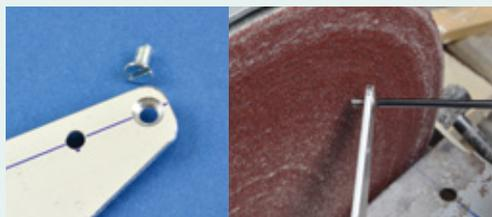
Müssen die Motor-Befestigungsschrauben gekürzt werden, kommt man um ein anschließendes Anfasen der Gewindgänge nicht umhin. Damit die Fingerkuppen heil bleiben, ist eine einfache Vorrichtung hilfreich
