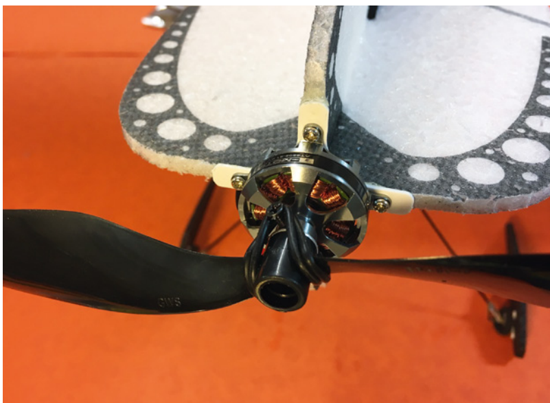
Eine CFK-Luftschraube ist leichter und robuster als ein Kunststoff-Pendant
