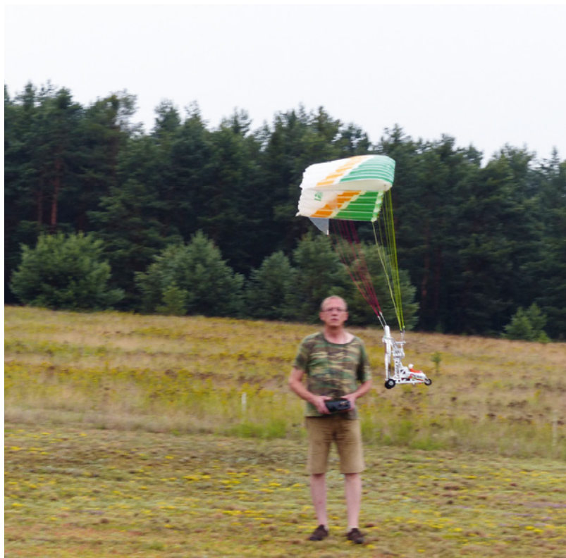
Flugfotos mit dem umgebauten Sky Surfer. Hier ein Variante mit Brushless-Innenläufer samt Original-Getriebe (Fotos: Detlef Witte)
