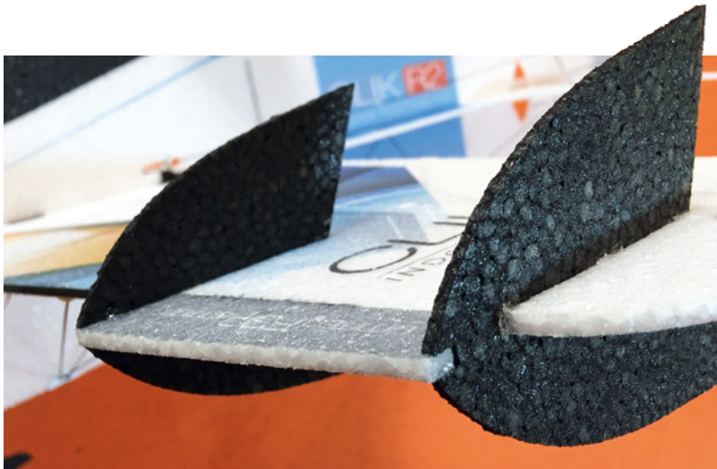
Die guten Messerflugeigenschaften verdankt der CLIK R2 seiner Rumpfform und diesen Side-Force-Generators
