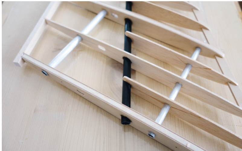
Der Kraftschluss der beiden Tragflächenhälften erfolgt über die in Sperrholzrippen gelagerten Aluminiumrohre, in denen auch der Holm aus Kohlefaser steckt
