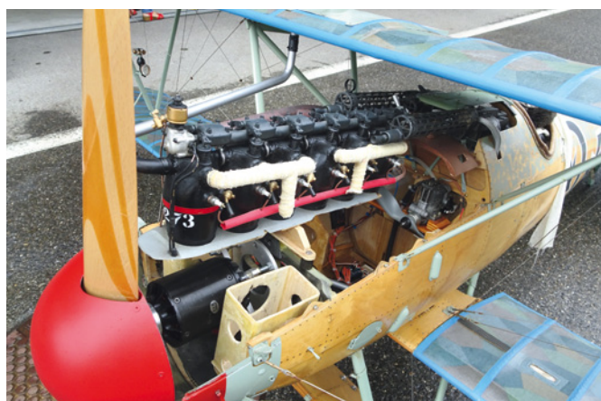
Die Albatros DVA von Yannick Bueb ist elektrisch motorisiert, man sieht links vorne die Taschen für die Akkus. Im hinteren Teil des Motorraums arbeitet ein 6,5 Kubikzentimeter-Viertakt-Motor, der den Sound erzeugt
