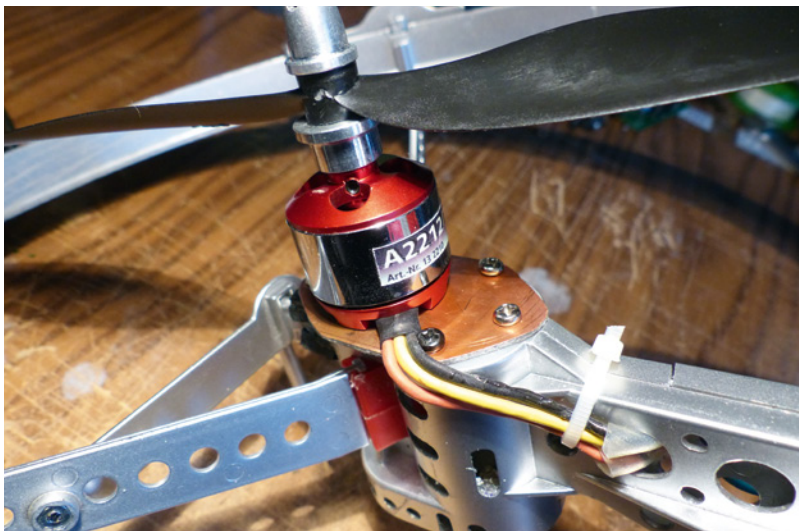
Der stärkere Motor vom Typ A 2212 ist mit dem gleichen Zwischenstück am Chassis befestigt wie der Compact 260
