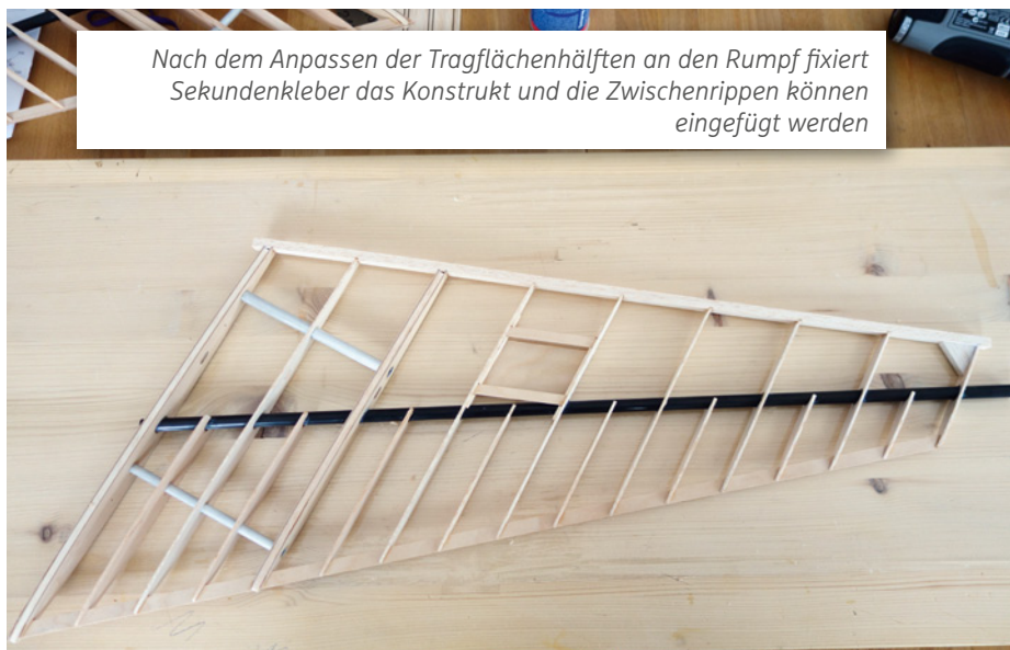
Der Rohbau der Tragflächenhälfte ist zu Beginn nur gesteckt und von Gummi-O-Ringen gehalten
