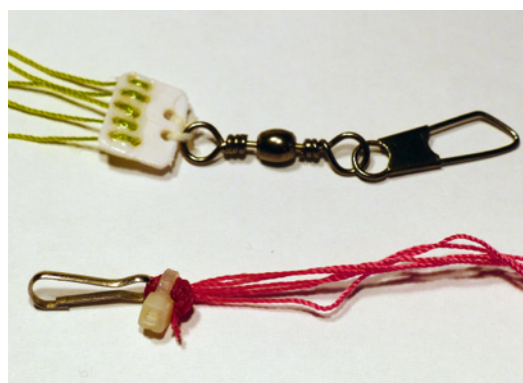
Bei der originalen Aufhängung verdrehen sich die Leinen gern und verheddern sich schnell. Nach dem Anbau der neuen Karabinerhaken aus dem Angelbedarf gehören solche Probleme der Vergangenheit an
