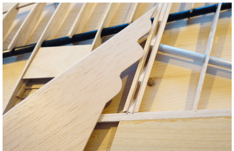
Die Winglets besitzen Verzapfungen an der Unterseite, so ist die Position klar definiert
