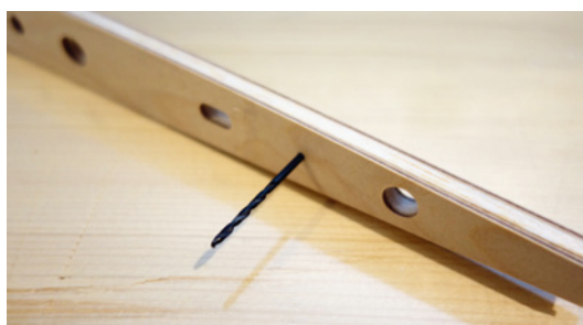
Der erste Schritt beim Bau der Tragfläche, die Wurzelrippe
