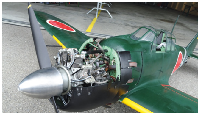
Details des Motoreinbaus der Zero von Takashi Hanawa aus Japan - 90 Kubikzentimeter Saito 3-Zylinder, davor die perfekte Motorattrappe
