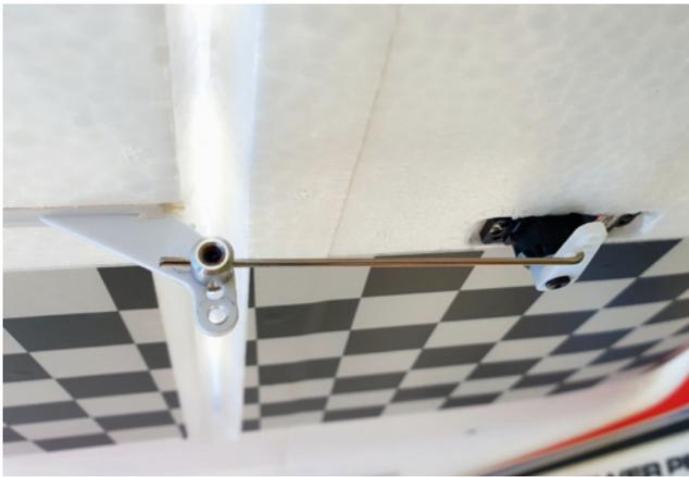
Alle Servos sind bereits montiert und exakt auf null eingestellt. Die in die Ruder-Anschlüsse eingesteckten Steuer-Drähte werden mittels Madenschraube geklemmt – halten aber sicher
