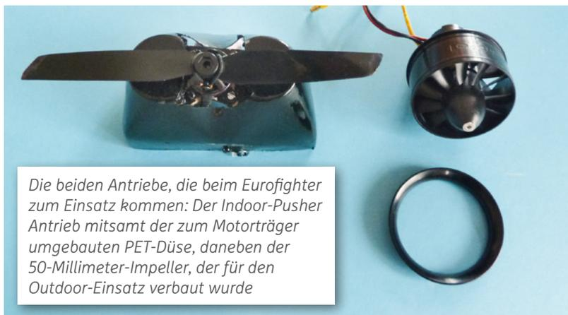
Die beiden Antriebe, die beim Eurofighter zum Einsatz kommen: Der Indoor-Pusher Antrieb mitsamt der zum Motorträger umgebauten PET-Düse, daneben der 50-Millimeter-Impeller, der für den Outdoor-Einsatz verbaut wurde
