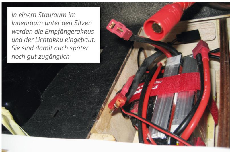
In einem Stauraum im Innenraum unter den Sitzen werden die Empfängerakkus und der Lichtakku eingebaut. Sie sind damit auch später noch gut zugänglich
