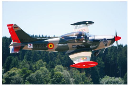
Hier sind die Querruder nach rechts ausgeschlagen, das Seitenruder nach links. Dadurch provoziert der Pilot einen seitlichen Schiebeflug, der bei Seitenwind im Landeanflug genutzt wird oder um Geschwindigkeit abzubauen. In diesem Fall sieht es einfach nur spektakulär aus
