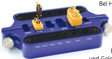
Bei Hepf gibt es eine **Löthilfe** von Hekotec zu kaufen. Sie kann zum Lötten von diversen Steckern genutzt werden, die man einfach einspannt. Die Löthilfe ist passend für: XT-60 sowie XT-90 Stecker und Buchse, Deans/T-Stecker, Mini-T-Stecker und Goldkontakt von 2 bis 10 Millimeter. Die Maße: 110 x 60 x 15 Millimeter. Sie kostet 19,90 Euro.
