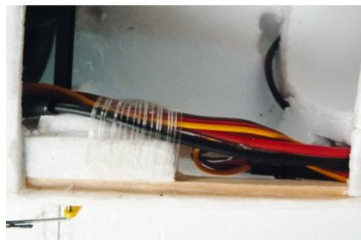
*Die Kabel im Bereich vor dem Impeller sowie der Empfänger wurden gebündelt und sorgfältig an der Seite fixiert*
