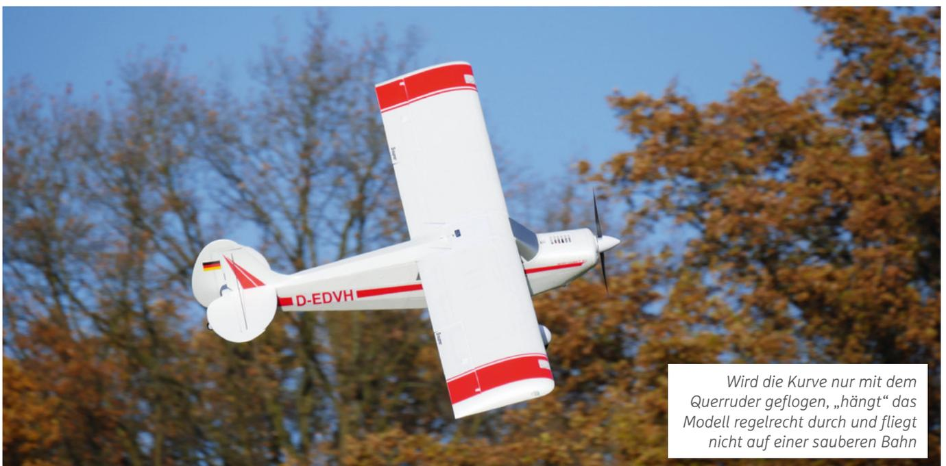
Wird die Kurve nur mit dem Querruder geflogen, „hängt“ das Modell regelrecht durch und fliegt nicht auf einer sauberen Bahn
