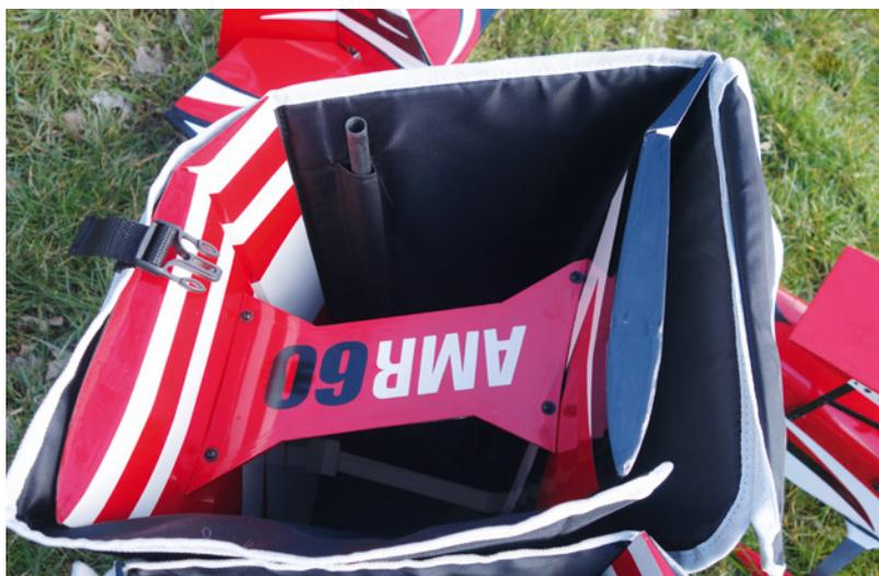
In den Flächentaschen befindet sich auch ein Fach für die leichte und empfindliche Flächensteckung aus CFK-Rohr
