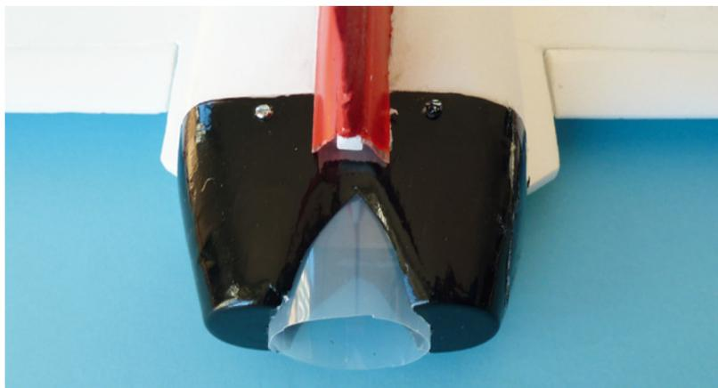
*Das Schubrohr wird mittig durch die PET-Düse nach hinten geführt*
