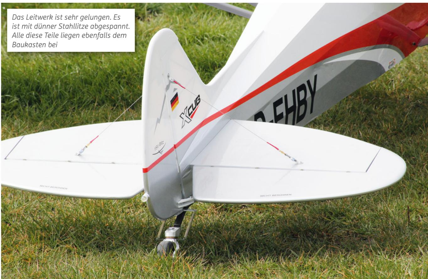
Das Leitwerk ist sehr gelungen. Es ist mit dünner Stahlhitze abgespannt. Alle diese Teile liegen ebenfalls dem Baukasten bei
