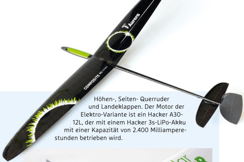
Höhen-, Seiten- Querruder und Landeklappen. Der Motor der Elektro-Variante ist ein Hacker A30-12L, der mit einem Hacker 3s-LiPo-Akku mit einer Kapazität von 2.400 Milliamperestunden betrieben wird.
