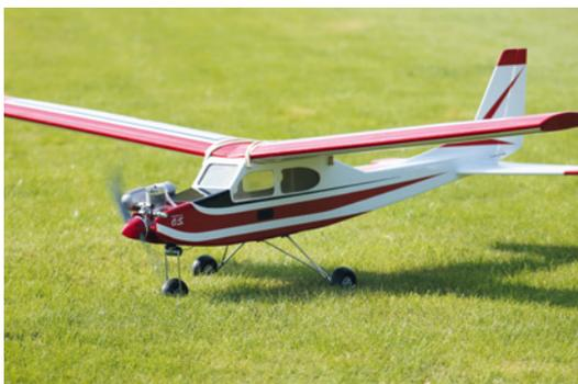
Modelle ohne Querruder kommen auch um die Kurve, da das Seitenruder beim Steuern eine Tragfläche beschleunigt (mehr Auftrieb) und eine verlangsamt (weniger Auftrieb), wodurch eine Rollbewegung stattfindet. Die charakteristische V-Form verleiht Stabilität
