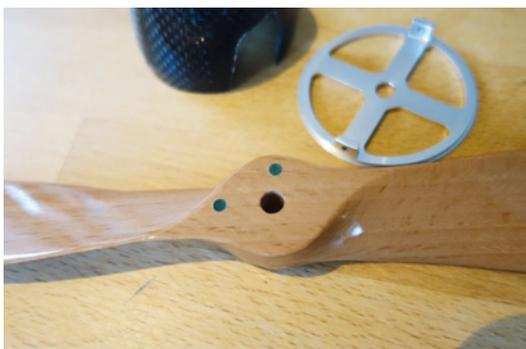
Die Vox-Luftschraube mit 16 x 8 Zoll kommt bereits fertig gewuchtet
