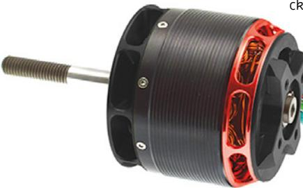
Der **Spider-SL 08-33-Motor** ist speziell für UAV-Anwendungen entwickelt worden. Der Scheibenläufer hat eine Betriebsspannung von 10 bis 60 Volt und eine spezifische Drehzahl von 330 kv. Bei einem Durchmesser von 58,8 Millimeter und einer Länge von 26 Millimeter bringt der Motor 175 Gramm auf die Waage. Der Preis: 169,90 Euro.
