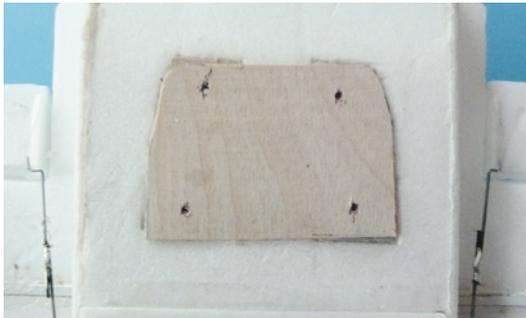
Unten erhält der Rumpf im Befestigungsbereich des Impellers eine Verstärkung aus dünnem Sperrholz
