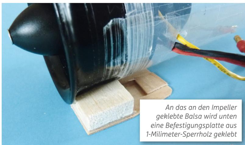
An das an den Impeller geklebte Balsa wird unten eine Befestigungsplatte aus 1-Millimeter-Sperrholz geklebt
