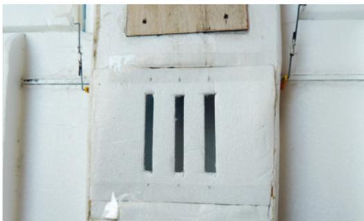
Die nachträglich angebrachten Schlitze, durch die der Impeller mehr Luft bekommt
