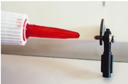
Schraubensicherungslack ist ein probates Mittel, um kleine und leichte Schraubverbindungen zu sichern. Bei der Ultimate AMR ist es Pflicht
