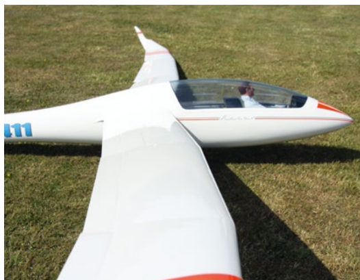
Sehr schön zu sehen sind die besonders geformten Tragflächen mit mehrfachen V-Knicks und Pfeilung
