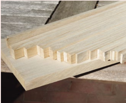
Der Sägeservice hat ein Brett zur Hälfte in Leisten geschnitten, die sich weiterverarbeiten lassen
