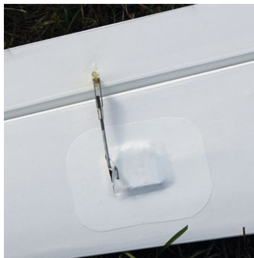
Die Querruderservos wurden mit Schrumpfschlauch überzogen und in den Flächen verklebt
