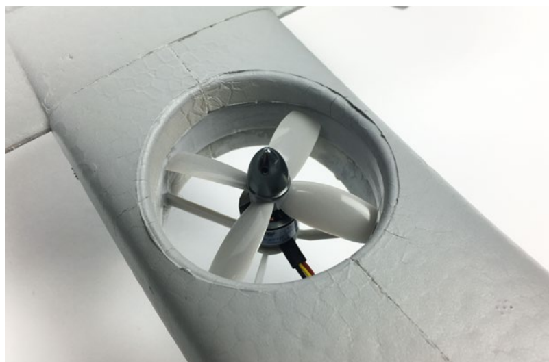
Ein kleiner, dritter Motor im Heck stabilisiert den Schwebeflug wie bei einem Trikotter
