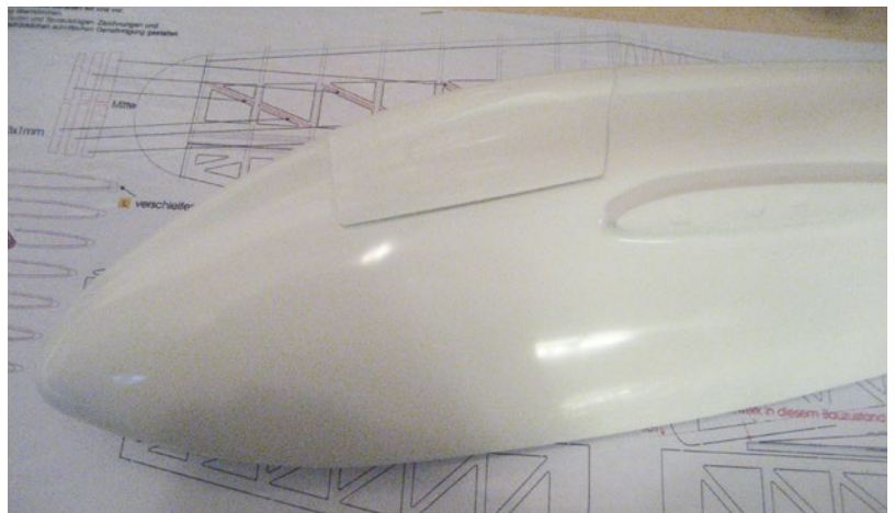
Der weiße GFK-Rumpf und die GFK-Haube zeigen nur eine feine Naht und gute Oberflächengüte
