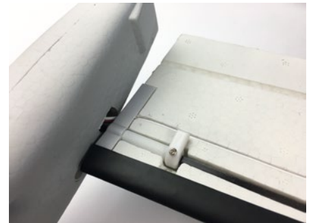
Die Motorgondeln an den Tragflächenenden werden um 90 Grad gekippt
