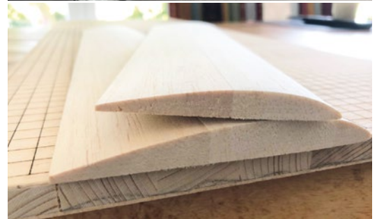
Bernhard Pach hat für seine Version des Modells aus weichem Balsa dicke Profilblöcke geleimt und zwischen Duralu-Formen geschliffen
