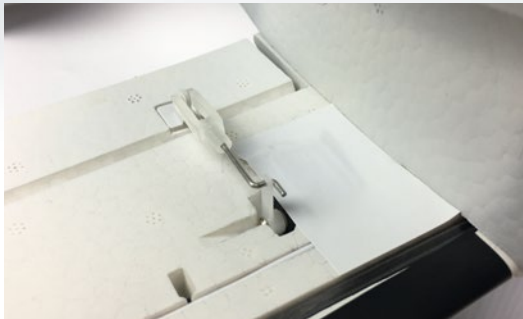
Sämtliche Ruder werden von 3,7-Gramm-Servos angelenkt
