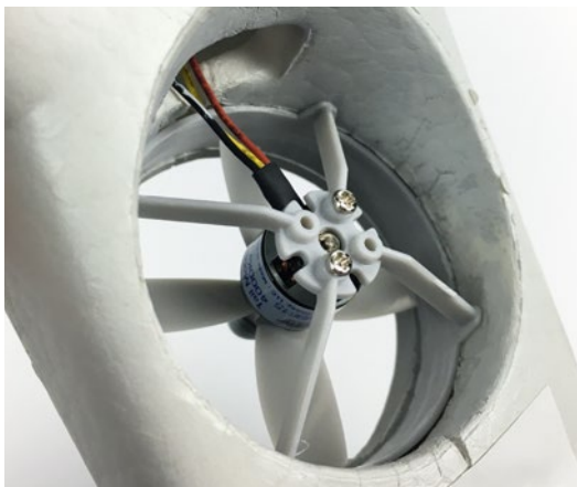
Der kleine Heckmotor hat eine spezifische Drehzahl von 4.000 kv und geht bei den Transitions automatisch an oder aus – je nach Anforderung
