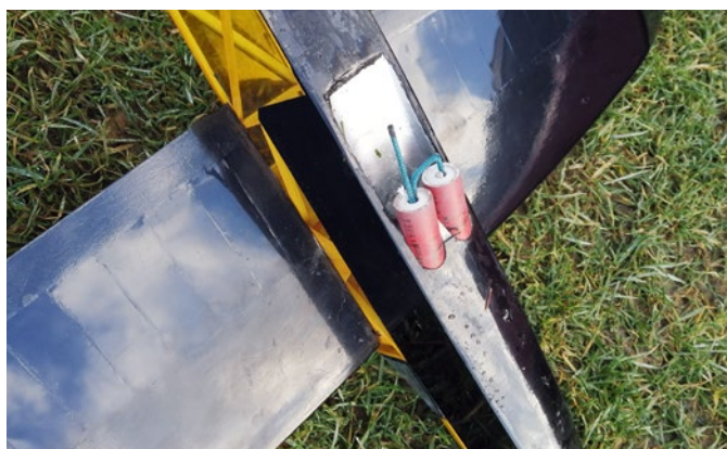
Auf der Unterseite ist das Versuchsmodell „Lunte“ mit zwei Treibsätzen ausgestattet. Die Zündschnur ist so verlegt, dass beide Motoren zeitversetzt starten
