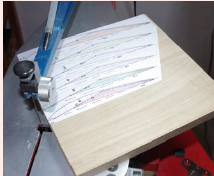
Außenrippen (farbig markiert) werden 18 Millimeter stark aus dem Brett gesägt
