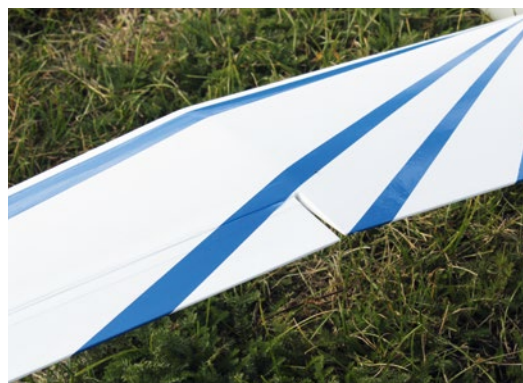
Sämtliche Ruder wurden direkt mit der Oratexfolie anscharniert
