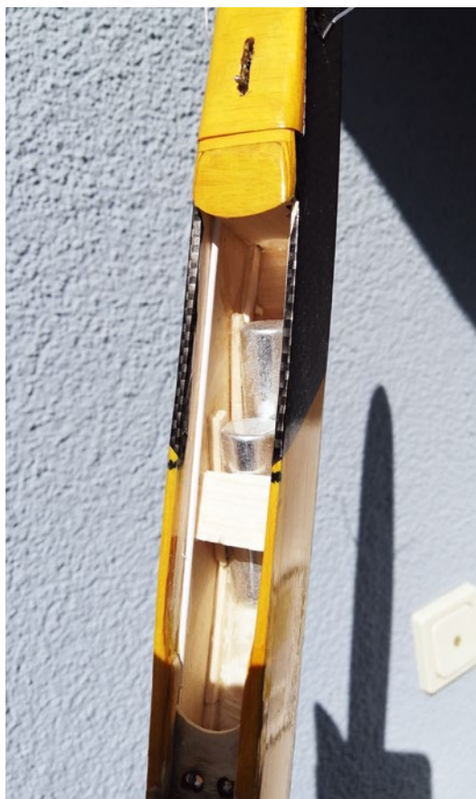
Die Motoren werden in genau passende Alugehäuse gesteckt, die im Rumpf sicher zu verkleben sind
