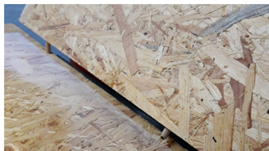
Die Seitenteile werden mittels Holzdübel auf die Grundplatte gestellt
