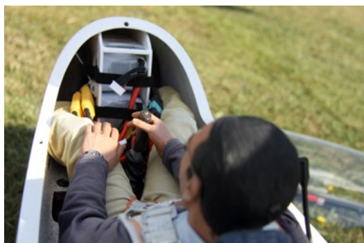
Direkt vor dem Piloten ist der Antriebsakku der Elektrovariante untergebracht
