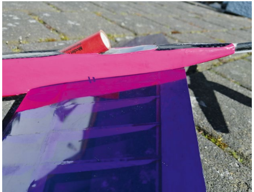
Die Raketentreibsätze werden in einem Winkel von ungefähr 20 Grad im Rumpf verbaut
