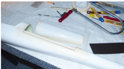
Das Heraustrennen des „Deckels“ ist Millimeterarbeit
