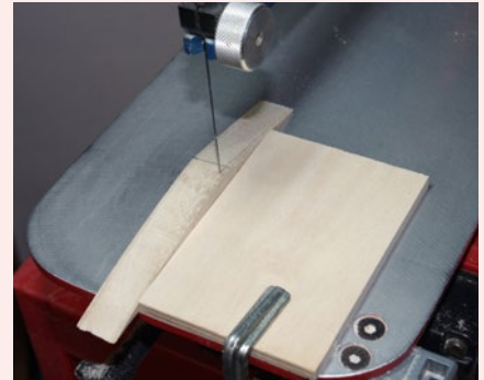
Aufsägen der Rippen an der Dekupiersäge mit einem einfachen Anschlag
