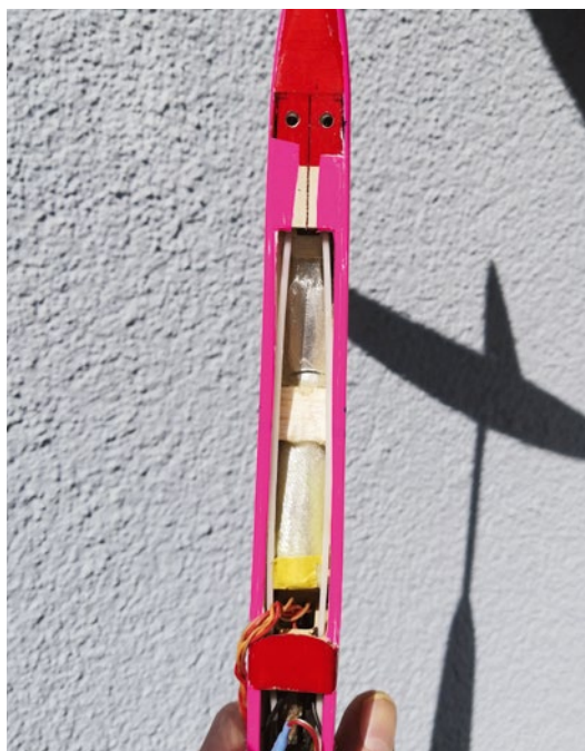
Der schmale Birdy-Rumpf bietet Platz für einen Raketenmotor
