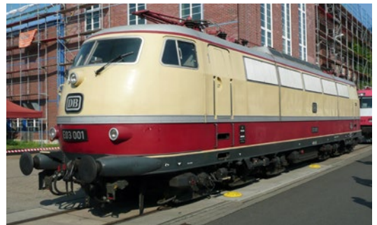
Bild 3: Die E03 der Bundesbahn. Zum Antrieb dienen sechs Motoren von je 1,25 Megawatt, insgesamt also 7,5 Megawatt. Die vier Brennstoffzellen für die elektrifizierte DC-7 müssen je 3,3 Megawatt liefern, insgesamt also 13,2 Megawatt, die Motoren je 2,7 Megawatt
