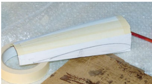
Nachdem das Profil auf die obere Rumpfschale übertragen war, konnte es ausgeschnitten werden
