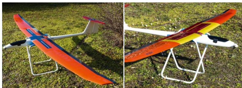
Das entstandene Modell wurde mit zwei anderen Flügelanordnungen verglichen – und wies die beste Performance in Sachen Flugstabilität und Kreisverhalten auf
