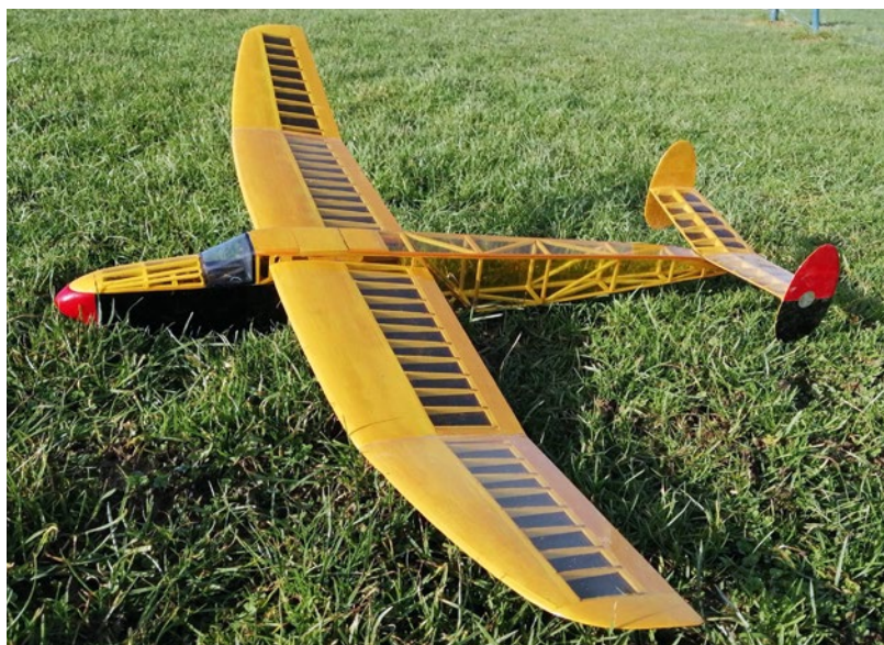
Das Modell „Lunte“ wurde speziell für Raketenmotoren konstruiert. Die Tragflächen entstanden aus einem Rippensatz des Birdy
