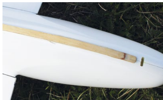
Hinter dem Schlitz an der Unterseite des Rumpfs befindet sich die Schleppkupplung
