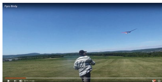
Die Ausgangshöhe sollte nach dem Handstart etwa 5 bis 10 Meter betragen. Nun hat man noch 1-2 Sekunden Zeit, das Modell gerade auszurichten und die Steigflugphase auszuwählen
