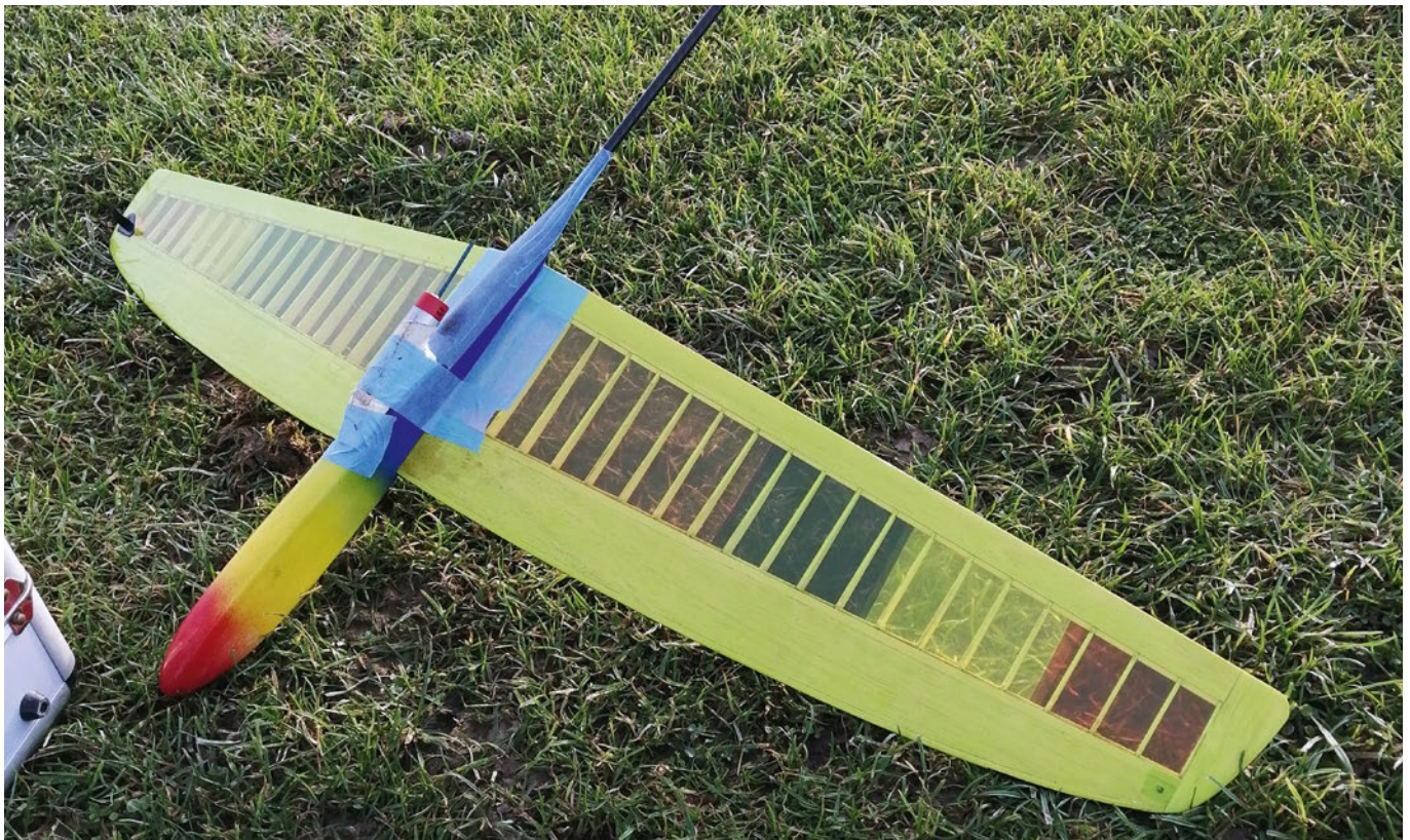
Um verschiedene Modelle auf ihre Raketentriebmotor-Tauglichkeit zu testen, wurden die Antriebe zunächst provisorisch befestigt
