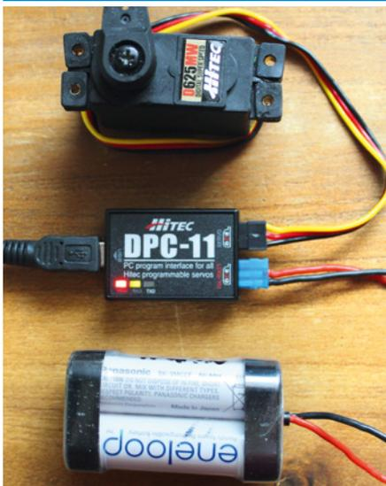
Das Servoprogrammiergerät DPC-11 von Hitec dient zum Programmieren, Einstellen und Testen von Digital-Servos am PC. Was das im Detail bedeutet, klärt sich im nächsten Heft.
