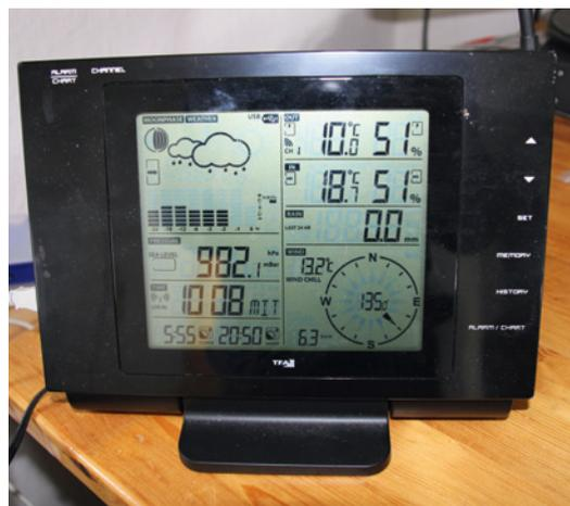
Die TFA Nexus eignet sich optimal für den Bau: Sie verfügt über Windsensor, Temperatursensor und einen Regenmesser
