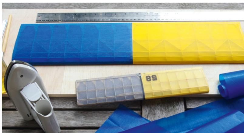
Die Bespannung wiegt jetzt ganze 4 Gramm für 7 Quadratdezimeter. Das Leitwerk ist für ein klassisches Freiflug-Parasol-Modell mit E-Motor, RC-gesteuert
