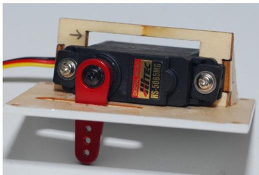
Am Befestigungsbrett der Querruderservos wurde der unten befindliche Rand entfernt. So liegt das Servo am Deckel auf und findet dadurch zusätzlichen Halt
