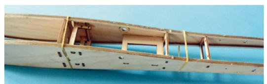
Die ersten Spanten wurden in den Rumpf eingelegt, die Seitenteile ausgerichtet und mit Gummiringen fixiert, dann wird mit Sekundenkleber geklebt
