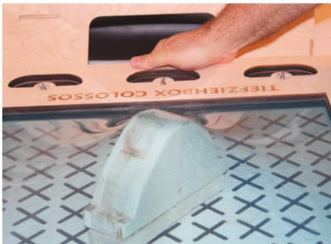
Tiefziehen ist eine bewährte Technik, um leichte Kunststoffteile von Positiven abzuformen. Mit der Tiefziehbox Colossos soll das nun jeder ganz einfach zuhause selbst machen können.
