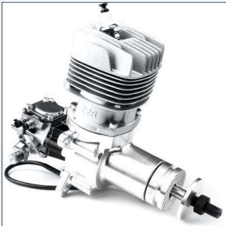
Der **GT22R** von Pichler Modellbau ist ein kleiner und kompakter Benzinmotor mit einem Gewicht von 680 Gramm. Der Motor mit einer Leistung von 2,8 PS bei 8.800 Umdrehungen pro Minute dreht Luftschrauben bis 17 x 8 Zoll. Damit ist er für Flugmodelle bis 2.000 Millimeter Spannweite oder auch Kunstflugmodelle bis etwa 1.800 Millimeter Spannweite geeignet. Im Lieferumfang enthalten sind eine Zündkerze, die elektronische Zündung sowie Befestigungsbolzen. Der GT22R kostet 249,- Euro.
