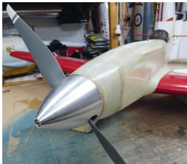
Der erste Eindruck mit der neuen Farbe vom Wastl an den bespannten Teilen. Gut zu sehen sind der eingebaute Motorspant und der Rumpfabschluss zum Spinner
