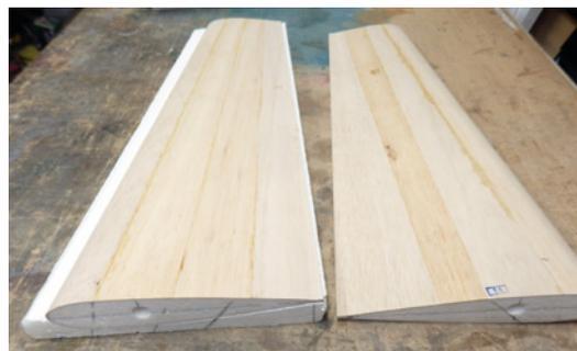
Die Tragflächenhälften sind mit 1,5-Millimeter-Balsaholz beplankt
