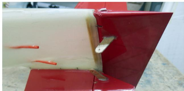
Die Bowdenzüge für die Anlenkungen der Leitwerksrunder wurden mit angedicktem Harz aerodynamisch verkleidet
