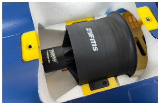
*Ein 80-Millimeter-Zwölfblatt-Impeller sorgt für guten Vortrieb und fast Turbinen-artigen Sound*
