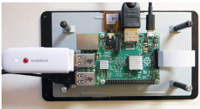
Herstellung der Internetanbindung über Computer und SIM-Karte (im USB-Stick)
