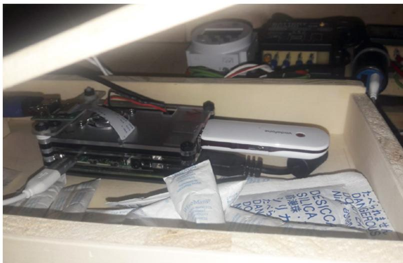
Die Elektronik der Wetterstation ist in einer Holzbox untergebracht
