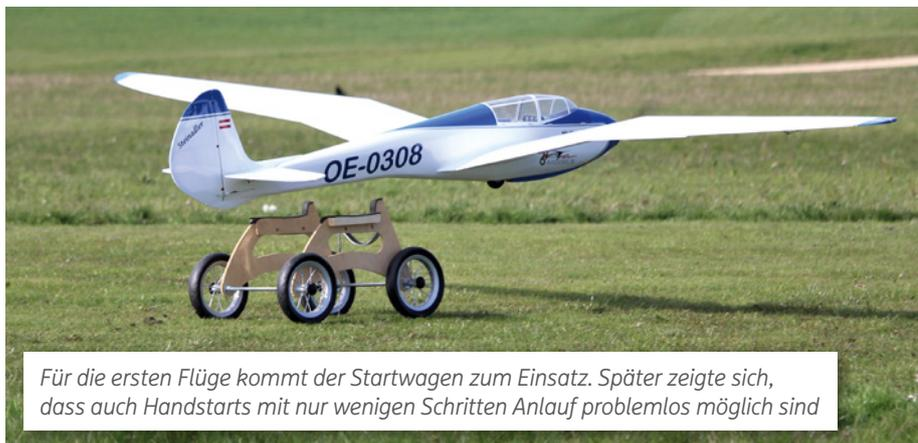
Für die ersten Flüge kommt der Startwagen zum Einsatz. Später zeigte sich, dass auch Handstarts mit nur wenigen Schritten Anlauf problemlos möglich sind
