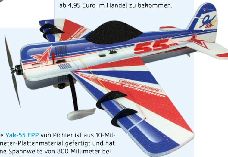
Die **Yak-55 EPP** von Pichler ist aus 10-Millimeter-Plattenmaterial gefertigt und hat eine Spannweite von 800 Millimeter bei einem Abfluggewicht von 220 Gramm. Das Modell besteht aus einem leichten und festen EPP-Werkstoff. Die Bauteile des Modells sind bereits lackiert. Einzelnen kostet das Flugmodell 65,- Euro und im Combo-Set mit Antrieb plus Servos liegt der Preis bei 159,- Euro.
