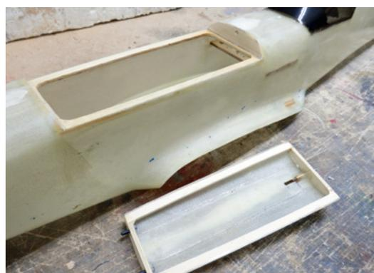
Der GFK-Rumpf mit der Öffnung für den Akku und Deckel
