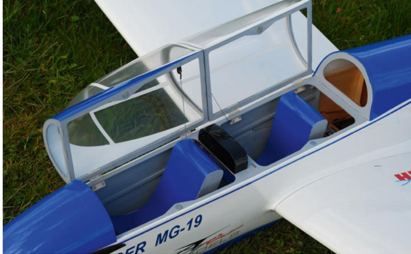
Kurze Stücke der Anlenkungslitze fixieren die Endposition der seitlich aufklappbaren Kabinenhauben. Im geschlossenen Zustand sorgen Magnete für festen Halt
