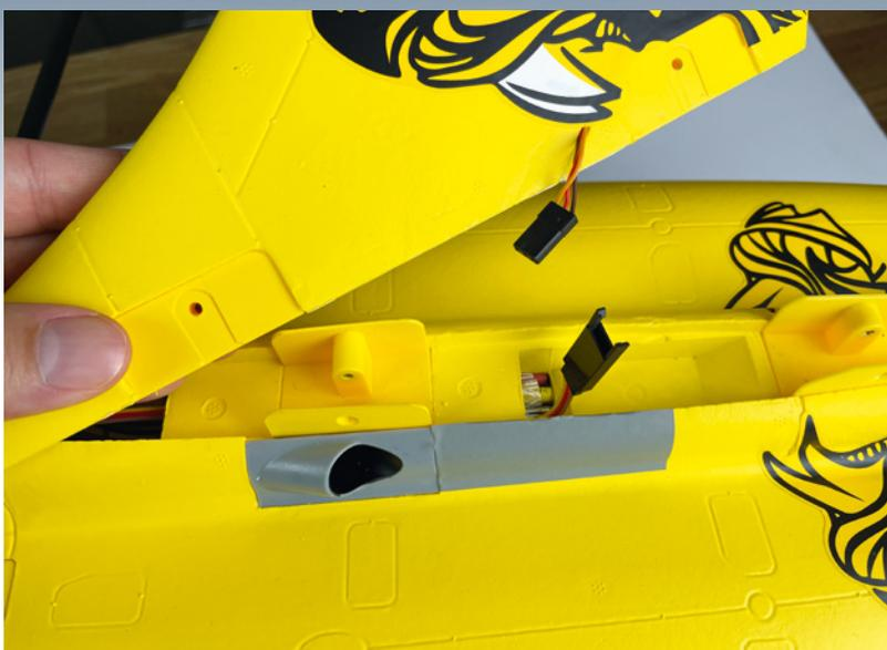
Das Seitenleitwerk wird angeschlossen und verschraubt – fertig
