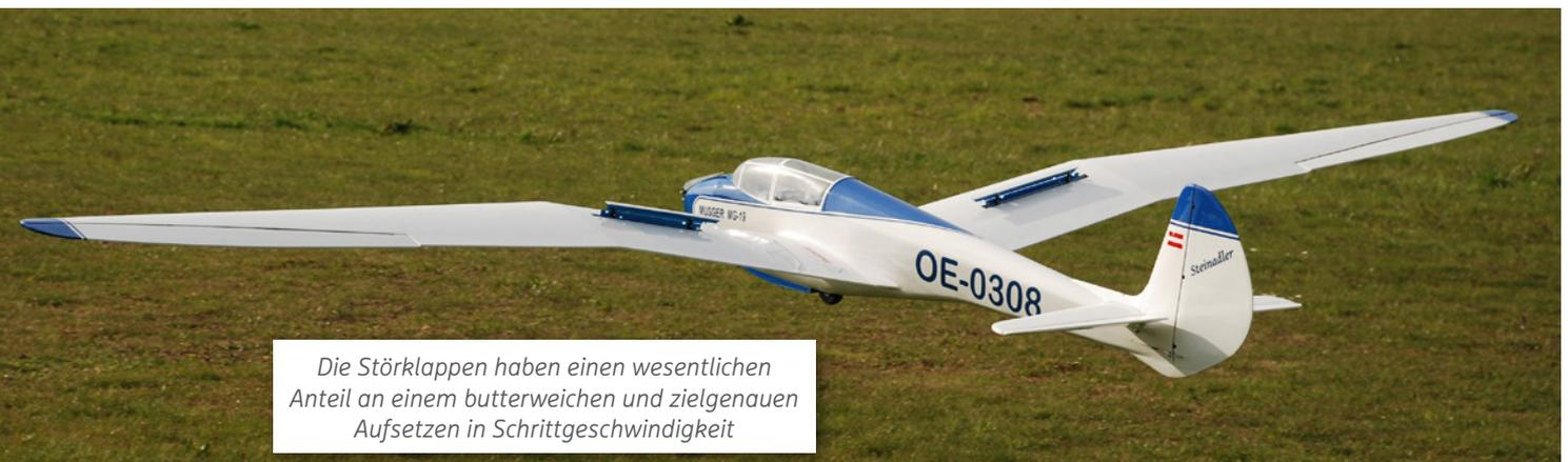
Die Störklappen haben einen wesentlichen Anteil an einem butterweichen und zielgenauen Aufsetzen in Schrittgeschwindigkeit
