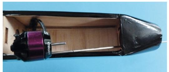
Als Montagehilfe für den Motor hat sich eine Gewindestange mit 2 mm Gewinde bewährt
