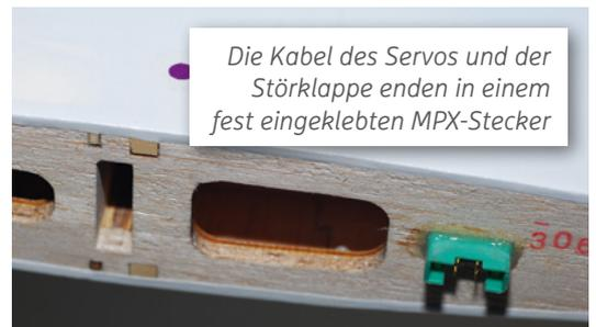
Die Kabel des Servos und der Störklappe enden in einem fest eingeklebten MPX-Stecker
