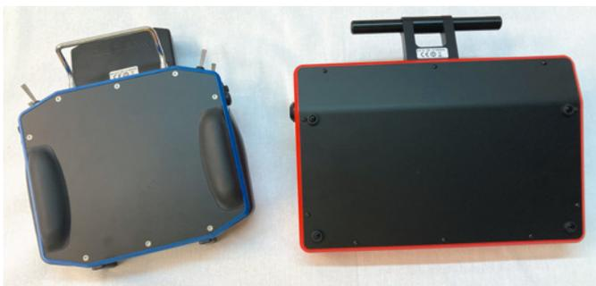
Rückseitig sind beide neuen Jeti-Sender von Aluminium-Platten verschlossen
