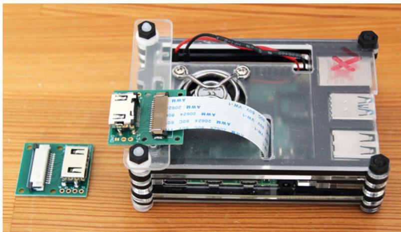
Der Computer: Raspberry Pi 4 mit Ubuntu, 16 Gigabyte Speicherkarte und 8 Gigabyte Arbeitsspeicher
