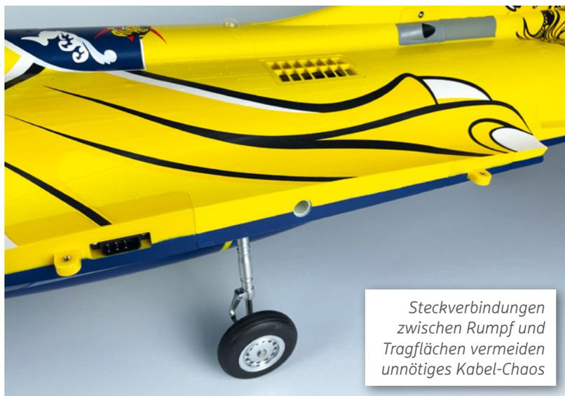
*Steckverbindungen zwischen Rumpf und Tragflächen vermeiden unnötiges Kabel-Chaos*
