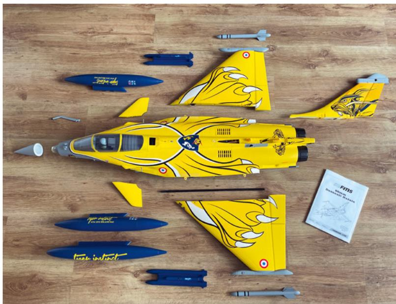
der Canards und des Seitenleitwerks mit Loctite zu sichern. Die Schrauben der Tragflächen kommen beim Testmodell ohne Sicherung aus, da diese zum Transport demontierbar sein sollen.
