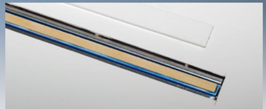
Die Störklappen mussten mit einem 1 Millimeter dicken Sperrholzstreifen versehen werden, damit die danach aufzuklebende Abdeckung sauber der Profilkontur folgt
