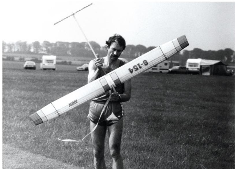
A2-Modell „ANDY“ für F1A-Wettbewerbe 1985. Bespannpapier machte den Flügel torsionssteif für die Startüberhöhung per Schleuderstart
