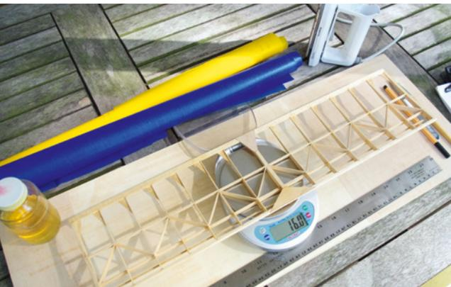
Das Höhenleitwerk wiegt ohne Bespannung 16 Gramm
