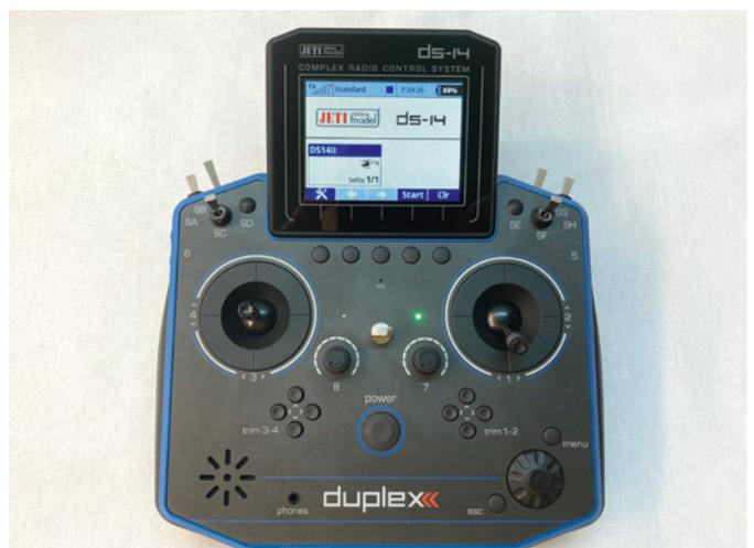
Beide Sender verfügen über das gleich, 320 x 240 Pixel große Farb-Display
