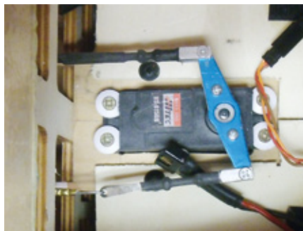
Zur Ansteuerung des Seitenruders kommt ein Jumbo-Servo mit 25 Kilogramm Stellkraft zum Einsatz
