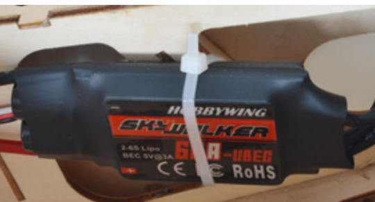
Die Super Decathlon wird inklusive Antrieb ausgeliefert. Ein Hobbywing-Regler mit 60 Ampere befindet sich schon im Rumpf
