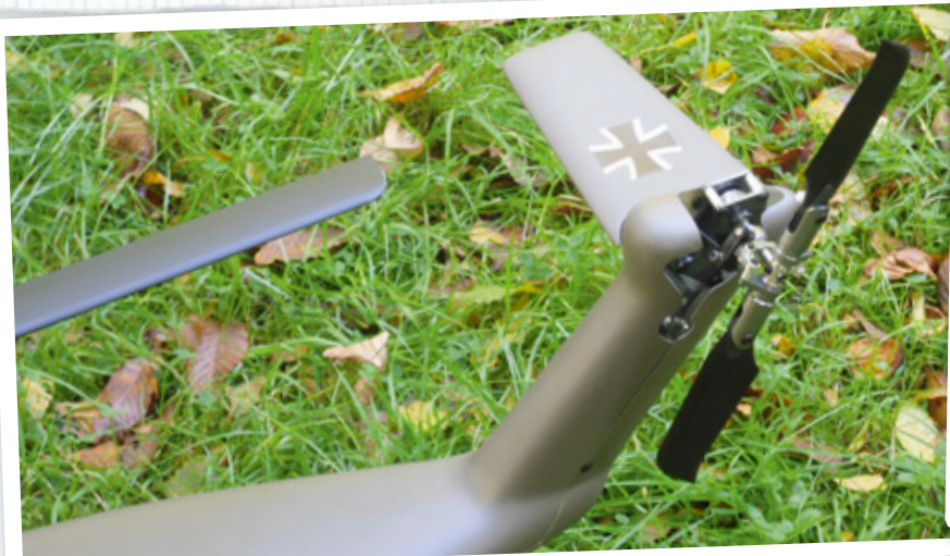
Durch Lösen von wenigen Schrauben ist das Winkelgetriebe des Heckrotors leicht zugänglich
