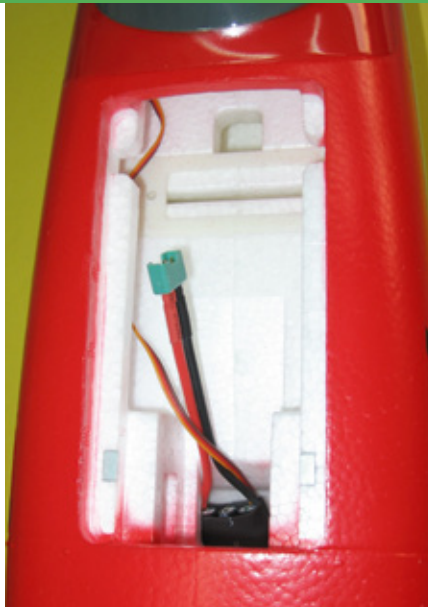
Vor der Kabinenhaube hat die Extra 300S eine große Zugangsklappe. Unter der Kabine kommt der Empfänger zu liegen, dafür ist ausreichend Platz für die Antriebsakkus in vielen unterschiedlichen Größen. Der Regler liegt unter dem Akkupack und wird von der Kühlluft umströmt
