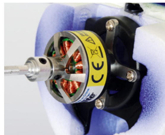
Der eingebaute Brushless-Außenläufer leistet ganze Arbeit und bringt die 235 Gramm Fluggewicht zügig in die Luft
