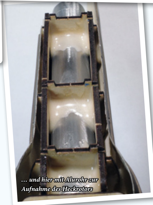
Die fertig eingebaute Umlenkeinheit. Hier ohne...
