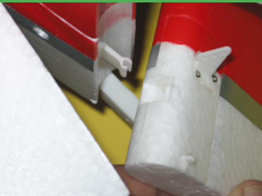
Das Seitenruder wird lediglich noch eingeklipst. In die Elapor-Teile eingelassene Hohlkehlscharniere sorgen an allen Ruder für eine optimale Aerodynamik
