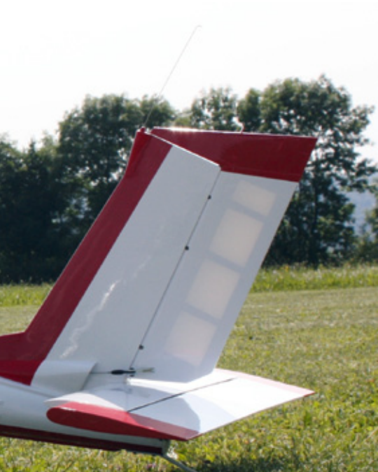
Praktisches Detail: Die Antennenatrappe verhindert, dass das Schleppseil im Seitenruderschlitz eingeklemmt werden kann
