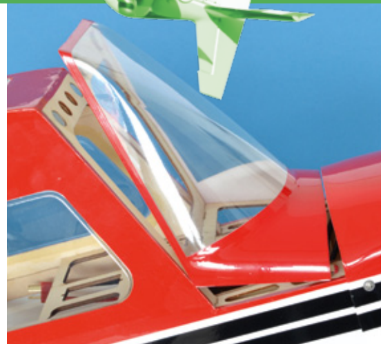
Der Zugang zum Rumpf erfolgt über die sehr gut sitzende Kabinenhaube
