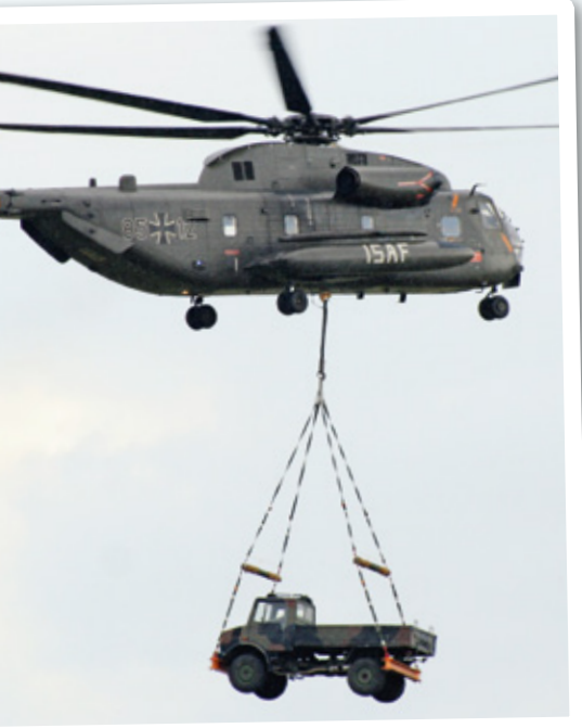
Hier wird als Außenlast ein Mercedes Benz Unimog transportiert. Am Außenlasthaken können Lasten bis zu maximal 9.000 Kilogramm transportiert werden (Foto: Mirko Krogemeier)
