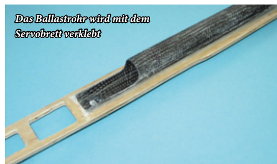
Fast geschafft, im letzten Schritt wird das Rumpfboot noch mit dem Servobrett und dem Rumpfhinterteil verklebt
