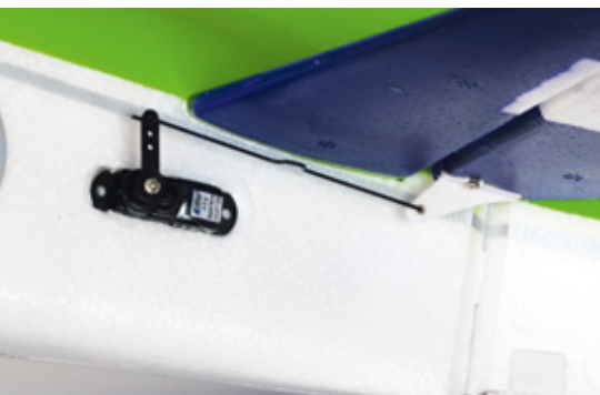
Die Servos sind mit langen Hebeln ausgestattet, um die 3D-flugtypischen Ruderausschläge zu erreichen
