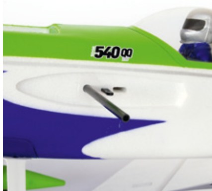
Die Tragflächenhälften lassen sich durch Lösen von lediglich zwei Schrauben abnehmen
