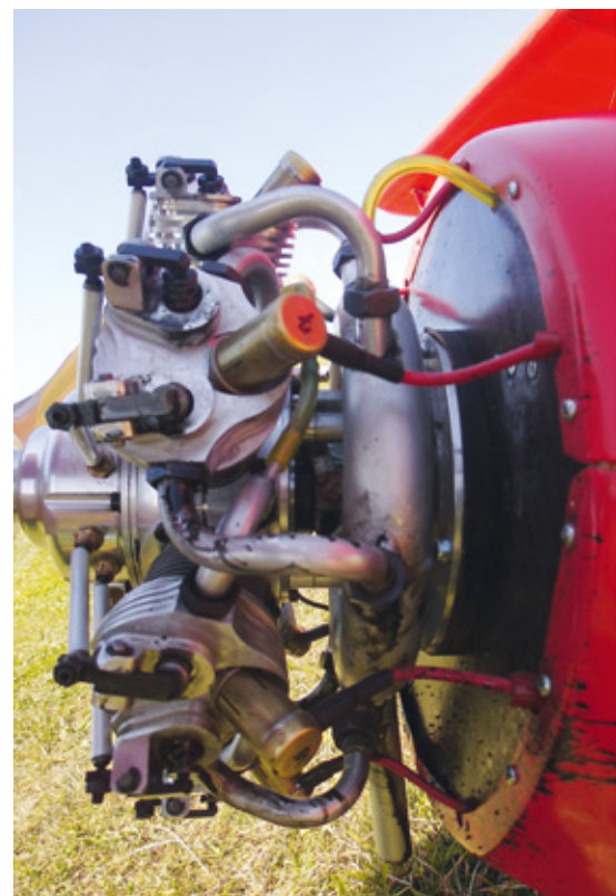
Die Auspuffanlage hat nicht ganz dicht gehalten, ansonsten verlief der Erstflug zur vollsten Zufriedenheit
