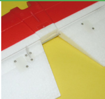
Die beiden Höhenruderblätter sind per Stahl Draht miteinander verbunden, das sorgt für eine exakte Ruderwirkung auch bei extremsten Figuren
