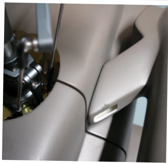
Um an die Schrauben zur Triebwerksbefestigung zu gelangen, wurde eine kleine Ausfräsung vorgenommen
