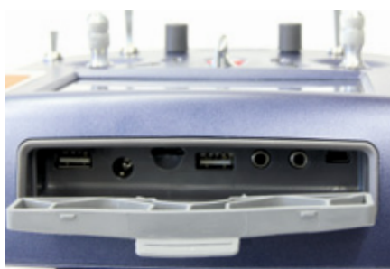
Zahlreiche Anschlüsse für externe Geräte sind in der BAT60 eingelassen
