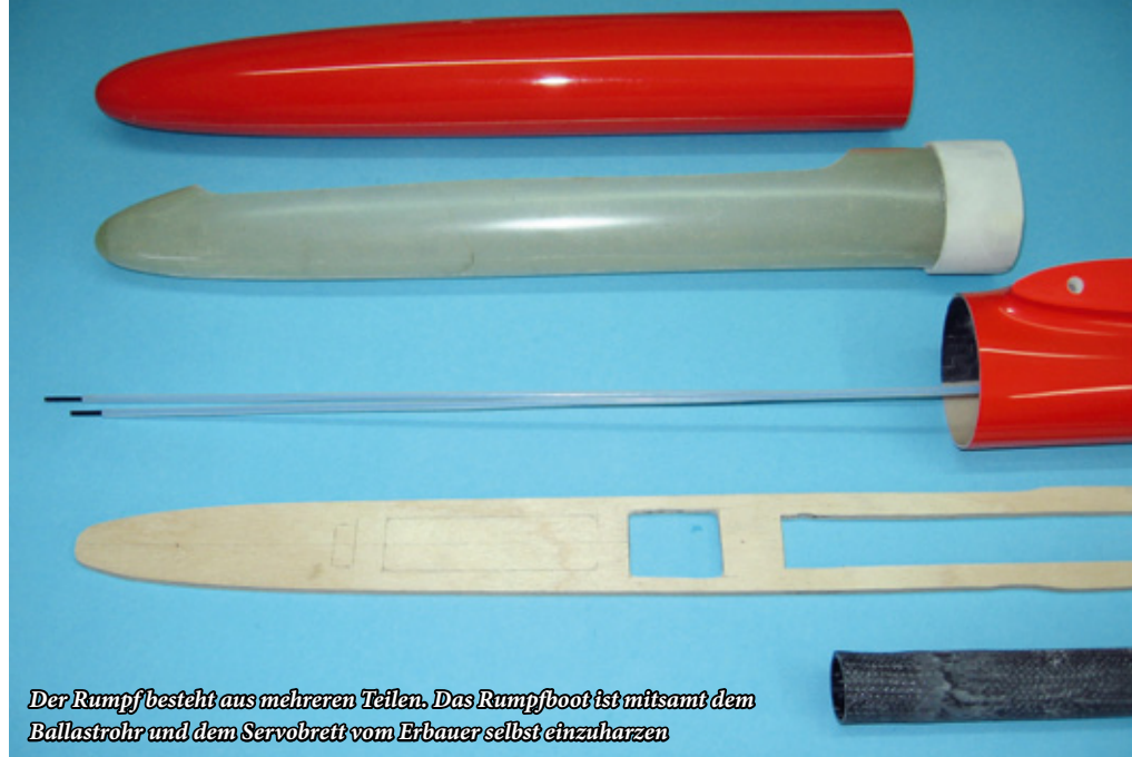
Das Ballastrohr wird mit dem Servobrett verklebt
