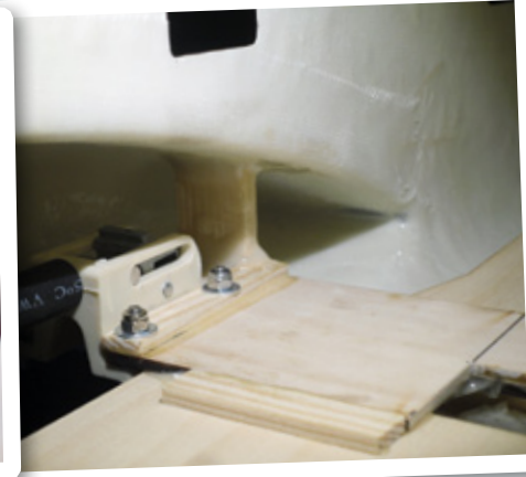
Die eingeklebte Unterstützung für das Fahrwerk leitet die Kräfte im Rumpf sauber ab
