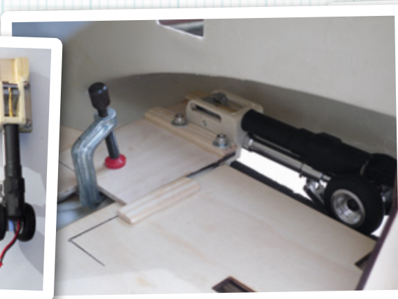
Der Einbau des Hauptfahrwerks in den Rumpf erfolgt mit UHU Endfest 300
