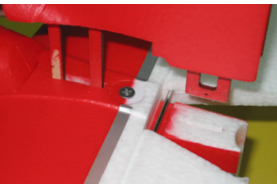
Das Seitenruder wird von oben durch das Höhenleitwerk in den Rumpf eingesteckt. Zwei quer eingedrehte Schrauben sorgen für einen festen Sitz am Rumpf
