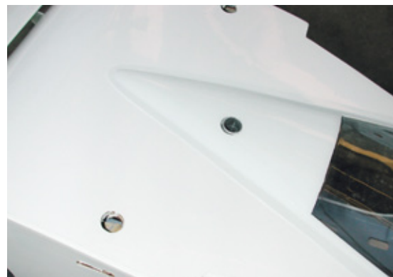
Die beiden äußeren Löcher dienen der Flächenbefestigung durch Klemmschrauben. Mittig die Öffnung der Schleppkupplung
