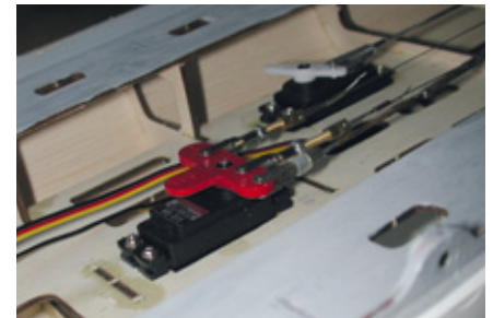
Blick ins Untergeschoss: Hier befinden sich die Servos für Seite und Höhe wie auch (nicht abgebildet) der Empfänger
