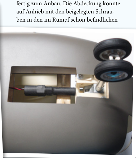
Das fertig eingebaute Bugfahrwerk
