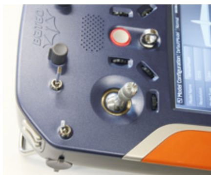
Die Drehgeber lassen sich feinfühlig bedienen, die Kipptaster kann man in verschiedenen Konfigurationen erhalten und die Trimmer haben zusätzlich eine Tastfunktion
