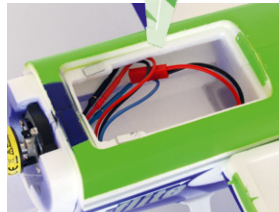
Das Akkufach ist großzügig bemessen, der Deckel mit Magneten gesichert. Das vereinfacht den Batteriewechsel enorm
