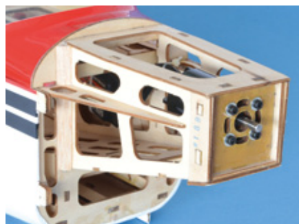
Der leichte aber sehr robuste Motorträger beherbergt einen Außenläufer mit 850 Umdrehungen pro Minute und Volt
