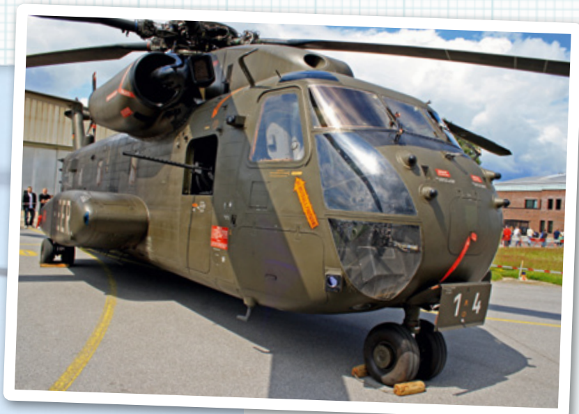
Der Rumpf mit seinem fast rechteckigen Querschnitt ist ohne aerodynamische Schnörkel auf reine Zweckmäßigkeit ausgelegt (Foto: Mirko Krogemeier)
