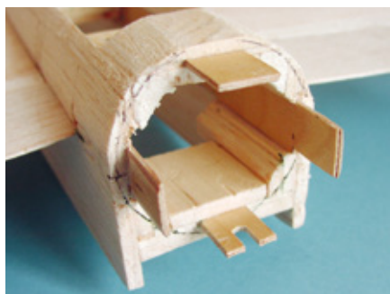
Die Befestigungslaschen des Motorträgers sind alle eingebaut
