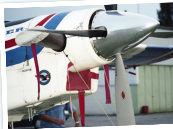
Links und rechts ragen die beiden Abgasrohre aus der Triebwerksverkleidung (Foto: Hans-Jürgen Fischer)
