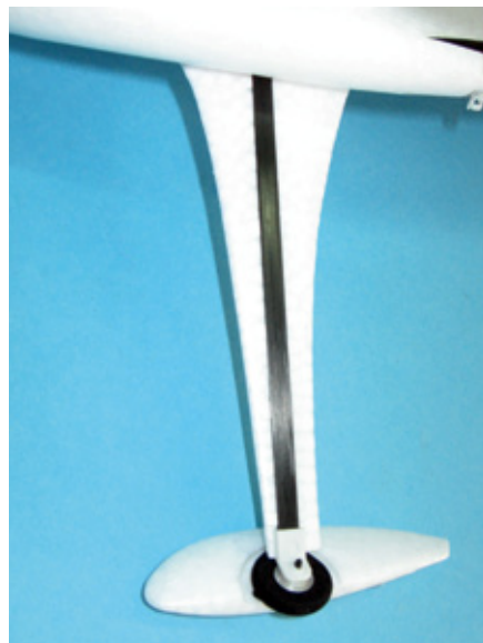
Als Basis für das Fahrwerk dient ein CFK-Flachmaterial, das mit einer formschönen Abdeckung aus Elapor versehen ist
