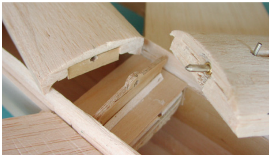
Zu sehen sind die Haubenklappe mit dem Schnellverschluss, das Sperrholzteil, durch das der Stift greift sowie die hintere Klappe, die im gleichen Zug mit verschlossen wird
