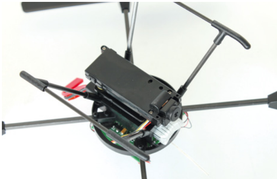
Damit die „Ladung“ beim Landen nicht gleich den Boden berührt, liegt dem Ares ein Landegestell bei, das die meisten Konkurrenz-Produkte nicht haben
