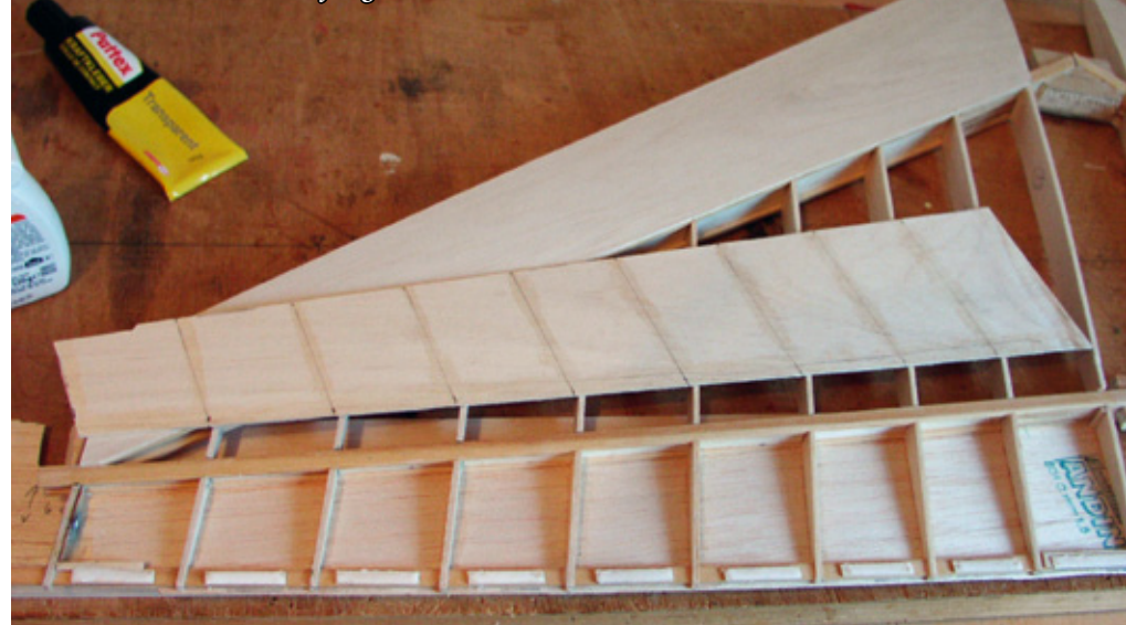
Die Beplankung wird teilweise mit Kontaktkleber und teilweise mit Holzleim befestigt
