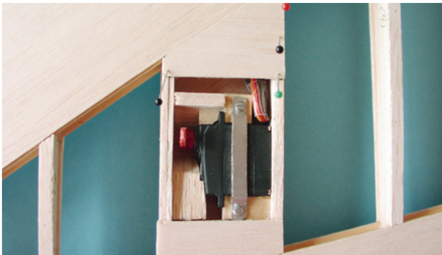
Sobald der Einbau des Servos abgeschlossen ist, wird die Beplankung bis auf einen Ausschnitt für einen Deckel fertig gestellt
