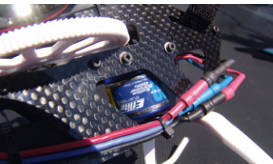
Der E-Flite-Außenläufer hat eine spezifische Drehzahl von 4.500 Umdrehungen pro Minute und Volt und sitzt beim CFX über Kopf im Chassis
