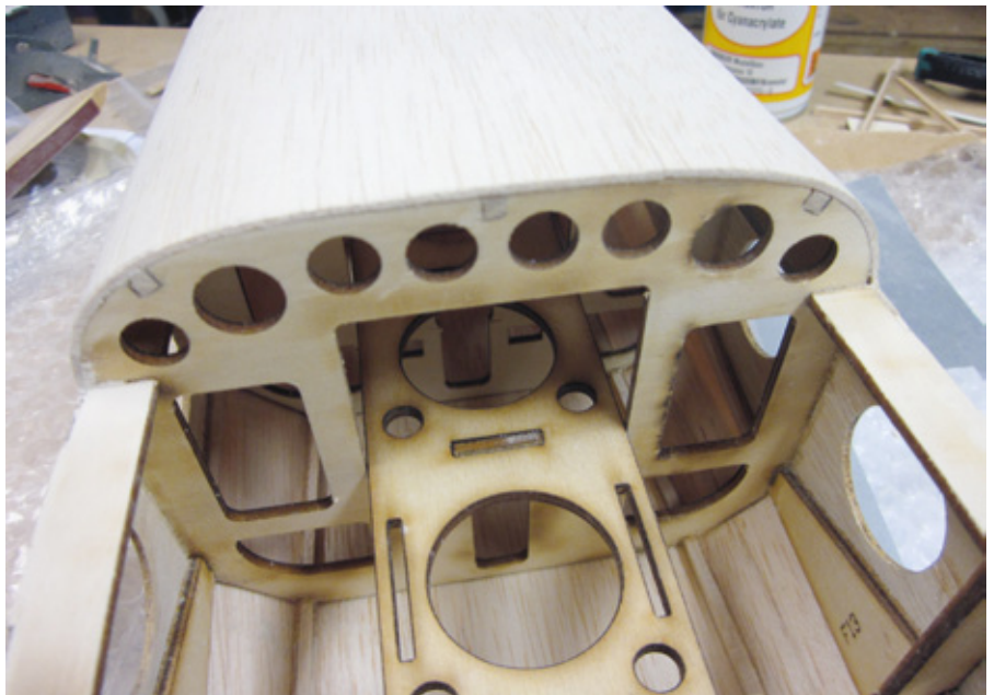
Leichtbauweise im Rumpf sorgt für ein niedriges Abfluggewicht
