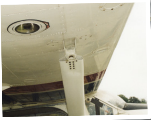
Blick auf den Flächen-Streben-Anschluss und den eingeklappten Landescheinwerfer (Foto: Hans-Jürgen Fischer)
