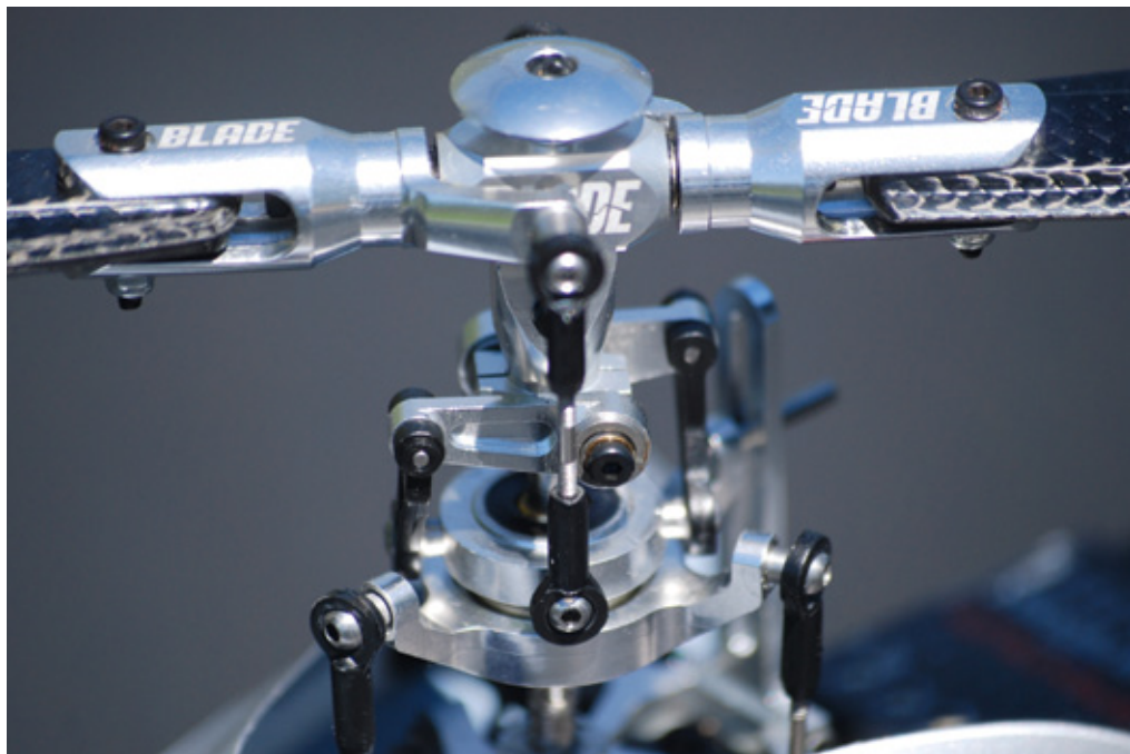
Der neue Voll-Alu-Rotorkopf in seiner vollen Pracht
