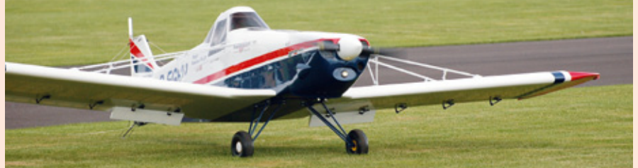
Das Agrarflugzeug Piper Pawnee PA-25 mit genau 5.000 Millimeter Spannweite und einem Abfluggewicht von gut 40 Kilogramm
