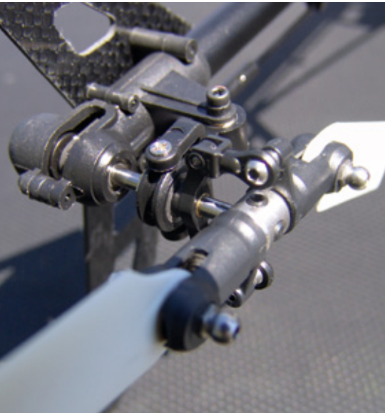
Bewährte Technik am Heck: Antrieb über Riemen. Propeller-Momentgewichte findet man bei viele kleineren Blade-Hubschraubern
