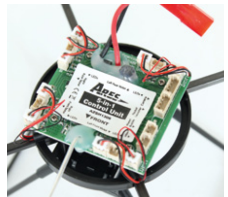
Die kompakte Zentralplatine beinhaltet neben der Leistungs-Elektronik für die Motoren auch noch die Empfangseinheit sowie das Dreiachsen-Stabilisierungssystem
