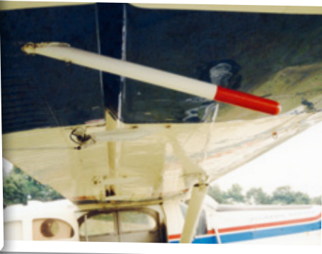
Dieser „Stab“ unter dem Querruder dient als Querruder-Gewichtsausgleich (Foto: Hans-Jürgen Fischer)
