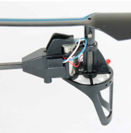
Bewährte Konstruktion: Coreless-Innenläufer mit großer Untersetzung. Alles kugelgelagert und sehr leise
