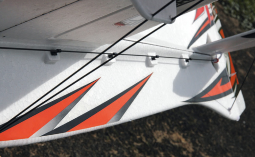
Die Anlenkungsgestänge zu den Leitwerken werden mehrfach an der Rumpfseite gelagert. Dadurch ergibt sich eine direkte Ruderwirkung und eine gute Rückstellgenauigkeit
