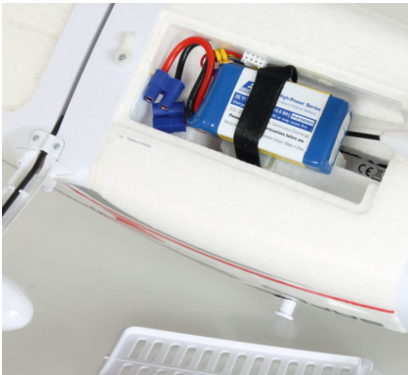
Der 3s-LiPo mit 1.300 Milliamperestunden Kapazität findet unter einer Klappe Platz – damit passt der Schwerpunkt genau
