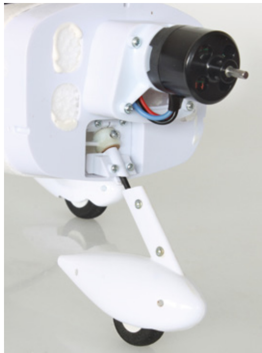
Das Bugrad ist lenkbar und für Stabilität im Frontbereich sorgt eine großzügige Kunststoff-Konstruktion
