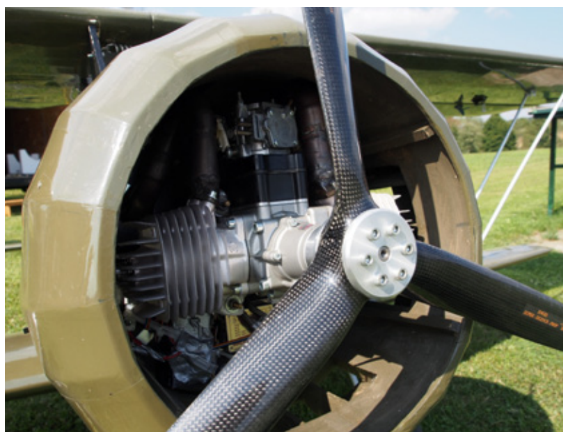
Der 170-Kubikzentimeter-Boxer von 3W dreht die 30 x 12-Zoll-Luftschraube und sorgt für reichlich Vortrieb
