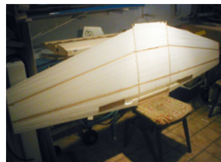
Der Styroporkern des unteren Flügels hat zwar viel Arbeit gespart, bringt jedoch auch mehr Gewicht auf die Waage
