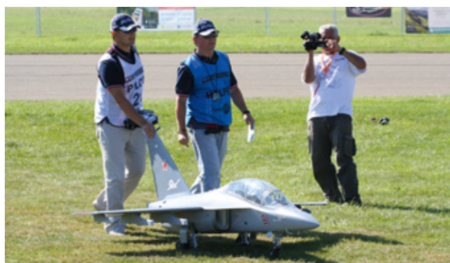
Die Yak130 von Pavel Lapshov aus Russland, mit der er Weltmeister in der 13,5-Kilogramm-Klasse wurde. Das Voll-GFK-Modell wird von zwei Jetcat P100RX-Turbinen angetrieben
