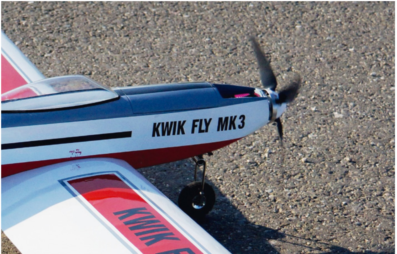
Bild 9: Die Motorsektion der Kwik Fly. Die fehlende Motorabdeckung verschlechtert nicht nur die Gleitzahl, sondern stört auch die Abströmung des Propellers. Dadurch verringert sich der Schub und erhöht sich das Lastmoment. Die Korrekturen der Propellerkennlinien entsprechend Bild 8 sind dadurch zumindest mit verursacht
