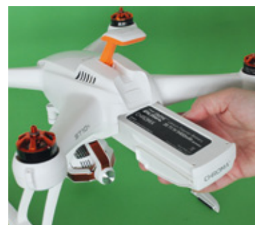
Nach dem Einschieben in den Schacht bekommt der Akku sicheren Stromkontakt und Halt
