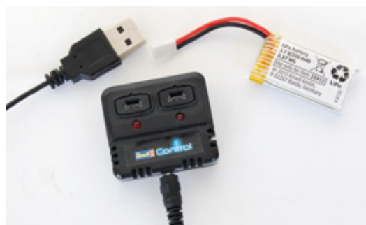
Mit dem beiliegenden USB-Lader ist der 250-Milliamperestunden-LiPo recht schnell befüllt
