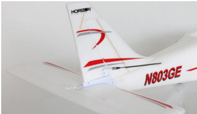
Zur Komplettierung des Modells muss neben der Montage des Fahrwerks nur noch das Höhenleitwerk in Rumpf fixiert werden
