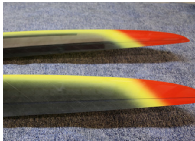
Für den Test wurde noch ein zweiter Satz Voll-CFK-Tragflügel mit massiverem Flächenverbinder und Ballastsystem bestellt
