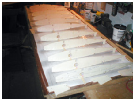
Die obere Tragfläche entstand in klassischer Rippenbauweise
