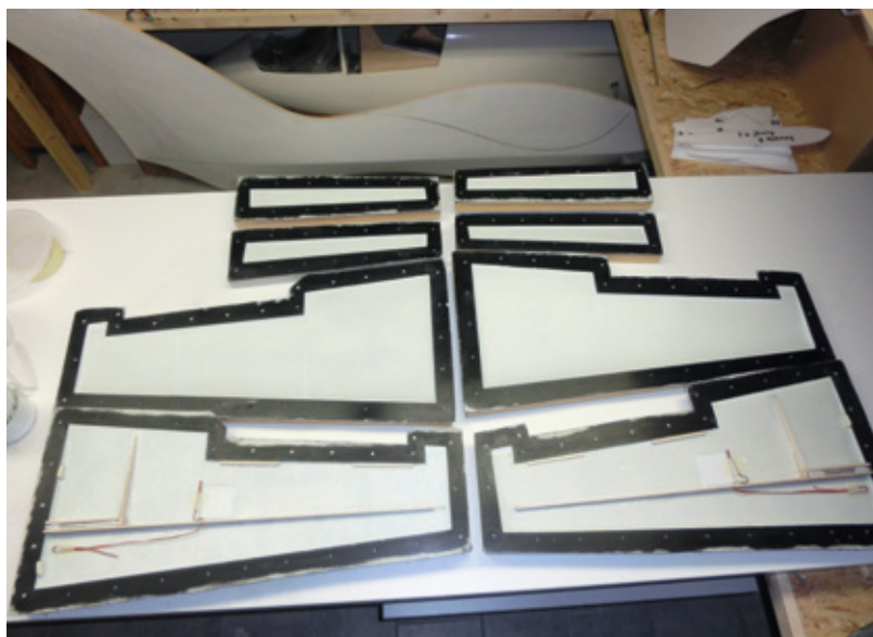
Im Inneren der GFK-Flächen befinden sich diverse Verstärkungen aus Holz
