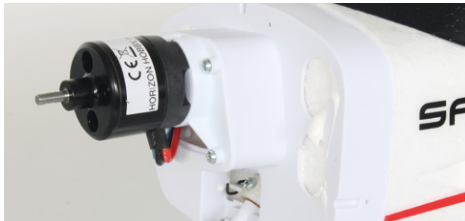
Ein einfacher Brushlessmotor in 480er-Baugröße sorgt für genügend Power in jeder Lebenslage
