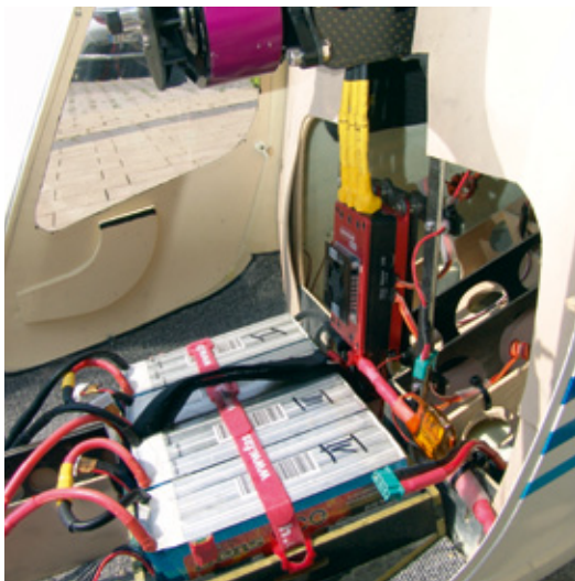
Ein Blick auf das Herz der Modell-Cabri: vier 6s-LiPos versorgen den Schwing-Hacker-Antrieb mit Strom
