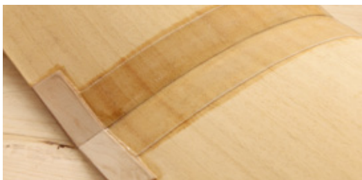
Das Glasfasterband verstärkt die Flügelhälften, die Sperrholzbrettchen stabilisieren die Endleiste, damit die Flächengummis nicht eindrücken
