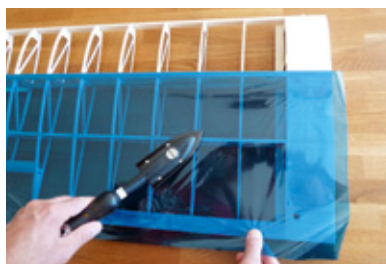
Die Folie wird vom Holm zur Endleiste hin glattgezogen und dabei möglichst faltenfrei angeheftet
