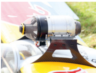
So wird eine Turbine an einer Blanik L-13 montiert. In der Luft sieht man davon nicht mehr viel, wenn Luca Pieroni und Andrea Giombetti aus Italien in perfekter Formation fliegen
