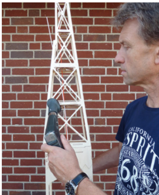
Nach dem Verschleifen wird das zu bespannende Teil vom Staub befreit
