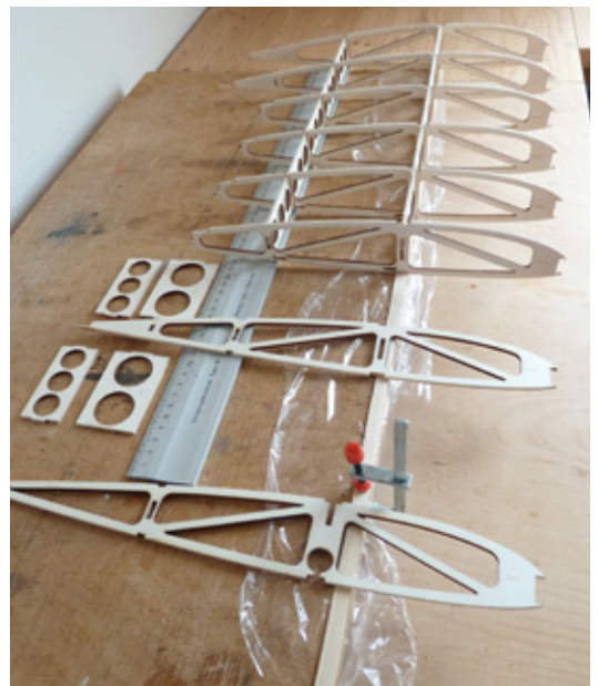
Die ersten Rippen werden auf den vorderen, unteren Holm geklebt, die Verkastung wird gleich mit eingeklebt. Gut zu sehen ist das Metalllineal als Auflage für die Rippen im hinteren Bereich
