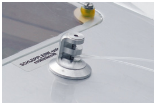
Die robuste Schleppkupplung ist hinter der oberen Klappe angebracht und bietet die Möglichkeit, zwei Seile gleichzeitig einzuklinken
