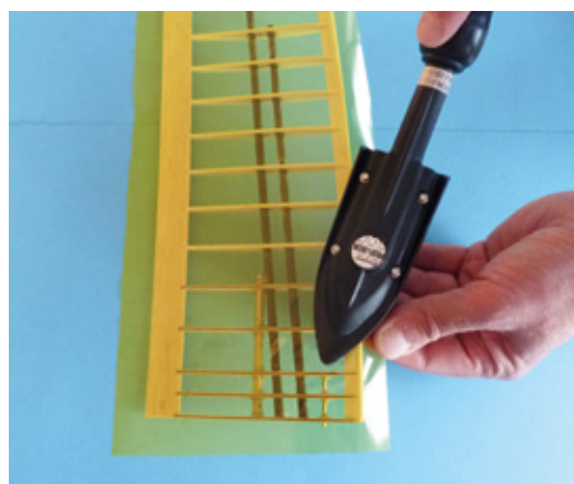
Die Folie wird von der Mitte zur Endleiste beziehungsweise zur Nasenleiste aufgebügelt. Auch hier wird die Folie nach Möglichkeit mit der freien Hand glatt gezogen
