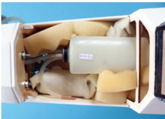
Der Tank hat im Rumpf reichlich Platz, außerdem links unten der Empfängerakku mit darunter liegendem Trimmblei
