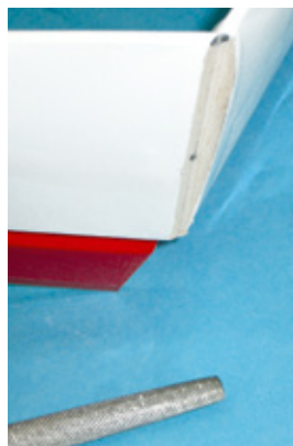
In das zusammengeklebte V-Leitwerk muss man eine halbrunde Nut feilen, bevor das Leitwerk mit dem Leitwerksträger verklebt wird
