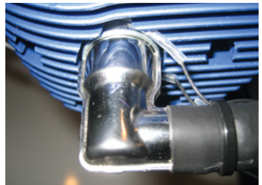
Der Draht für den Temperatursensor ist formschlüssig um die Zündkerze verlegt. So kann die Motortemperatur im Schleppbetrieb überwacht werden
