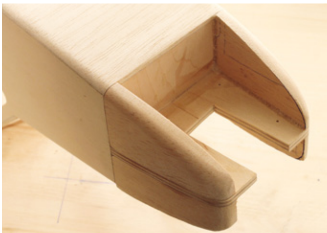
Keine GFK-Motorhaube, sondern massives Holz verkleidet den Methanoler. Beim Schleifen braucht man Geduld
