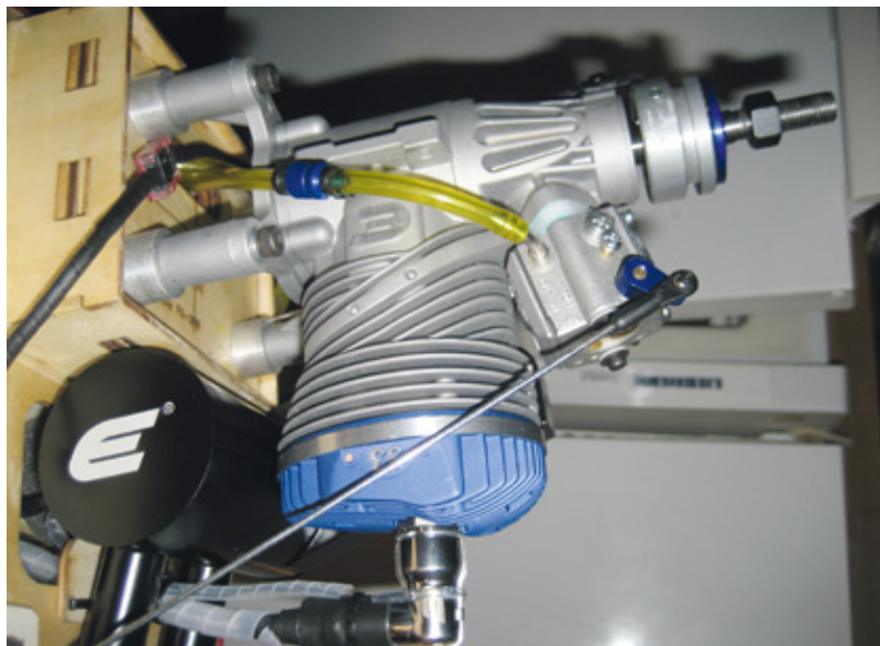
Der Evo 33GX mit 33 Kubikzentimeter Hubraum ist für die Valiant passend. Der Einbau ist vorbereitet und macht keine Probleme. Auch die Motorhaube nimmt den ansprechenden Motor vollständig auf
