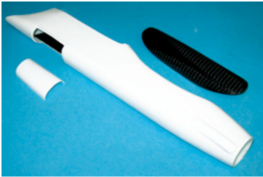
Der vordere Rumpf besitzt eine große Öffnung zum Wechseln des Antriebsakkus, die hintere Rumpfklappe gewährt den Zugang zu den drei eingebauten Servos
