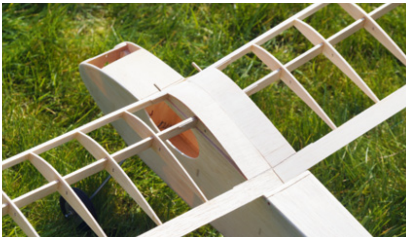
Eine Rippen-Tragfläche aus Holz ist deutlich aufwändiger als ein einfaches Pendant aus Hartschaum
