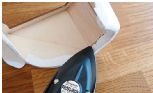
An der Motorhaube wird die Folie um die vordere Rundung herumgezogen
