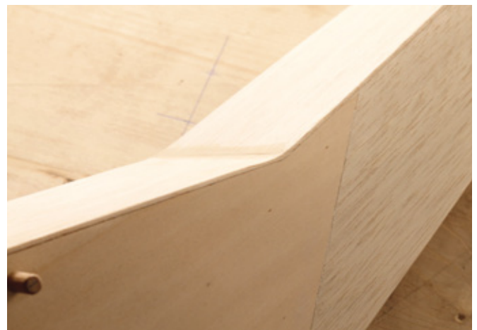
Die Beplankungen sind zugeschnitten und verschliffen. Jetzt kommen die Rundungen
