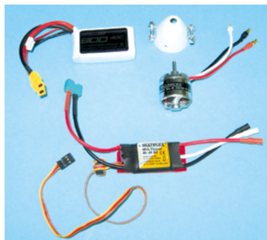
Der verwendete Antrieb besteht aus einem kleinen Permax-BL-Außenläufer mit 28 Millimeter Durchmesser sowie einem MULTiCont BL-20 SD-Regler von Multiplex und hat sich sehr gut bewährt
