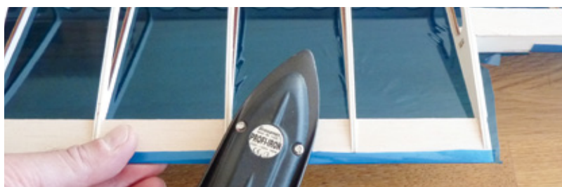
Nachdem die Folie oben auf der Endleiste fest ist, wird sie um die Endleiste herum auf deren Unterseite festgebügelt
