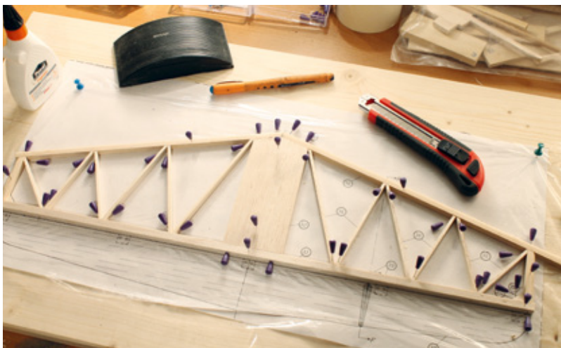
Mit viel Geduld entsteht aus einigen Leisten das Höhenleitwerk
