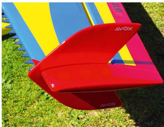
Die beiden Side-Force-Generators leisten einen entscheidenden Beitrag zur Stabilisierung der YAK um die Längsachse. Sie sind demontierbar angebracht
