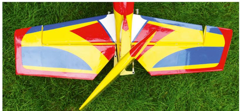
Die beiden im Seitenleitwerk eingeklebten Ruderhörner nehmen das entsprechende Kugelgelenk auf
