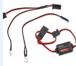
Der **CPS-1** von Ripmax ist ein Schalter mit zwei beiliegenden LED, beispielsweise zur Beleuchtung eines Flugzeugrumpfs. Der Schalter ist an einem freien Kanal anzuschließen, ist 16 x 22 x 7,6 Millimeter groß, wiegt 5,9 Gramm und verbraucht 10 Milliampere Strom bei 6 Volt Ausgangsspannung; der maximale Ausgangsstrom beträgt 200 Milliampere. Im Preis von 36,90 Euro sind zwei LED enthalten.
