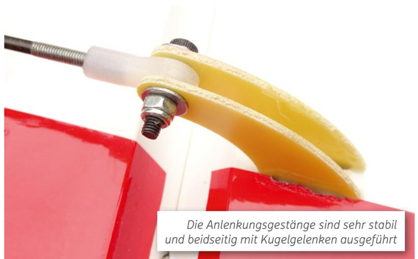
Die Anlenkungsgestänge sind sehr stabil und beidseitig mit Kugelgelenken ausgeführt
