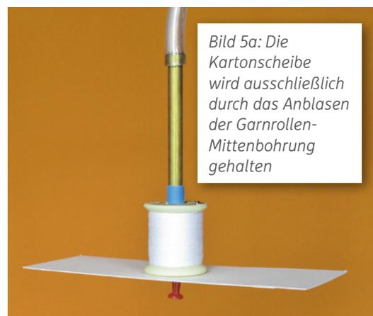
Bild 5a: Die Kartonscheibe wird ausschließlich durch das Anblasen der Garnrollen-Mittenbohrung gehalten
