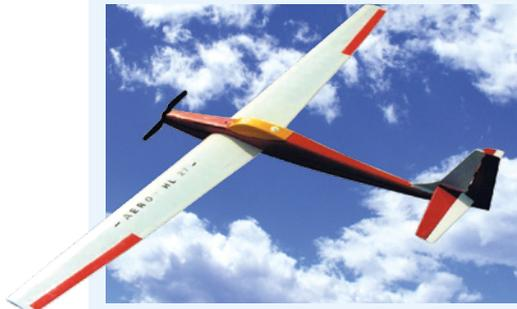
Der **Aero HL-27** ist ein Holzbausatzmodell, der zum Betrieb mit Brushless-Motoren konzipiert wurde. Ihn zeichnet ein geräumiger Rumpf mit einem guten Zugang für die Einbauteile aus. Alle Teile sind soweit wie möglich vorgearbeitet, die Rippen und Spanten werden auf CNC-Anlagen gefräst. Der Bauplan, die Stückliste sowie eine Baubeschreibung liegen dem Bausatz bei. Die Spannweite liegt bei 2.000 und die Länge bei 1.200 Millimeter. Der Preis: 139,- Euro.
