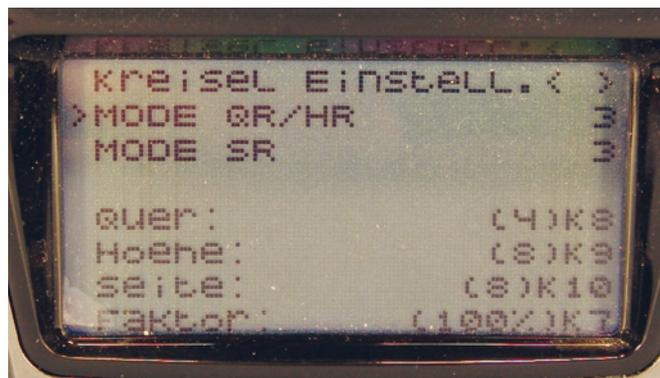
Quer, Höhe und Seite können mit unterschiedlichen Modi geflogen werden. Die Gyro-Empfindlichkeit lässt sich für jede Achse über einen Kanal individuell und flugphasenabhängig einstellen. Der Wert in Klammer gibt die Höhe der Empfindlichkeit an
