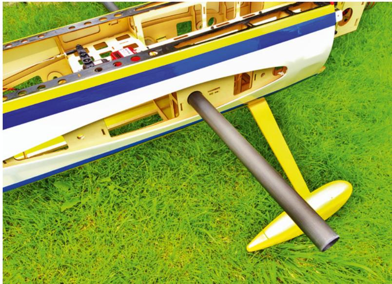
Der CFK-Flächenverbinder bietet stabilen Halt bei gleichzeitig geringem Gewicht
