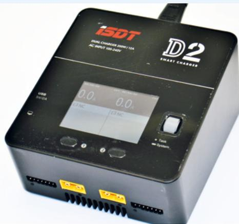
Der **ISDT SC-D2** ist ein 230-Volt-Lader mit zwei Ladeausgängen und 200 Watt Ladeleistung. Über das 2,4 Zoll große LCD-Display können die Ladeparameter und Ladedaten auch bei hellem Licht gut abgelesen werden. Pro Ausgang können 1 bis 6 Li-, 1 bis 18 Ni- und 1 bis 12-Pb-Zellen geladen und entladen werden. Der Balancerstrom liegt bei beachtlichen 1.000 Milliampere, der Ladestrom bei 0,1 bis 12 Ampere und der Entladestrom bei
