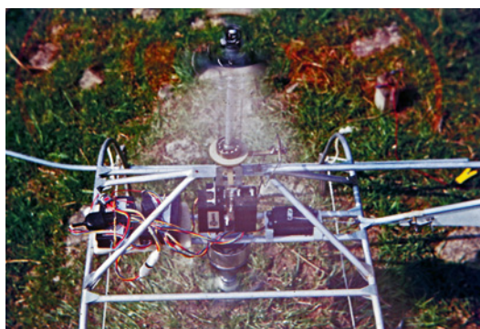
Rückdrehmoment-Rotor mit hängendem Motor, mit Seilen an vier Zeltheringe gefesselt. Tanken, Kerze anglühen und Motor anwerfen: Die Erkenntnis entgegen allen Unkenrufen von Fachleuten: Der 10-Kubikzentimeter-Motor trägt sich selbst und das ganze Gerät. Zum Fliegen reicht 's allemal (Foto: Dieter Störig)
