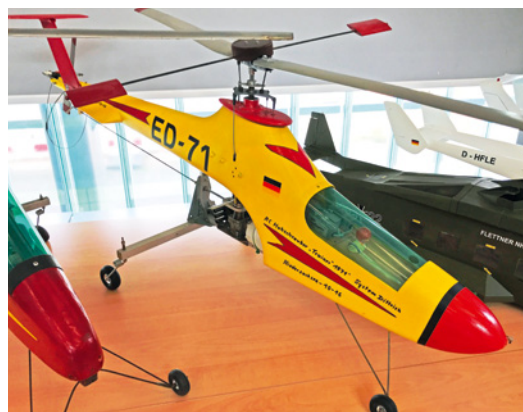
Ein historisch einmaliges Modell von Ewald Dittrich aus dem Jahr 1971, dessen Motor (auf Schlittenführung) per langer Kurbel zurückgezogen wurde, um das Keilriemen-Getriebe weich einzukuppeln (Foto: Roland Oster)
