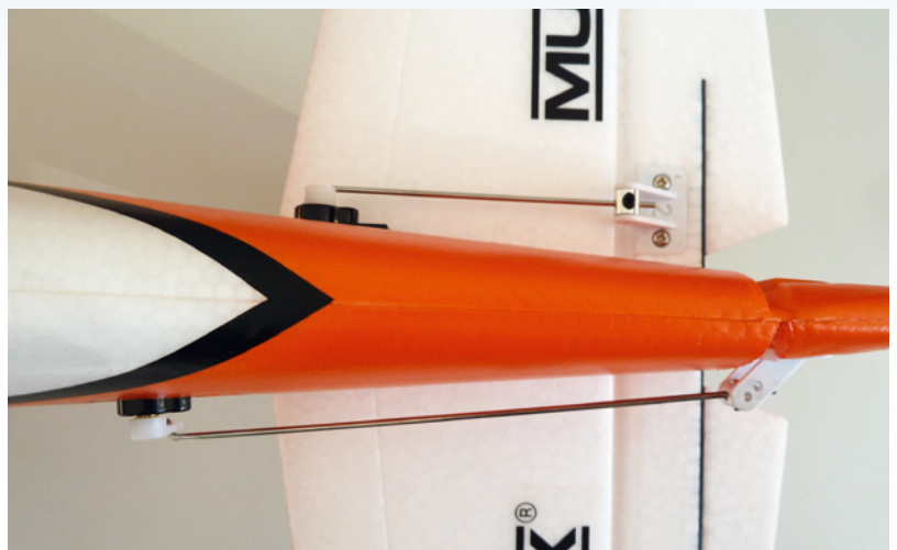
Bei der Anlenkung von Höhen- und Seitenruder ist gut die Verschraubung der Ruderhörner zu sehen
