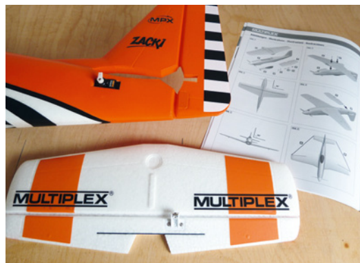
Das Ausrichten und Einkleben des Höhenleitwerks ist ausführlich in der Anleitung beschrieben
