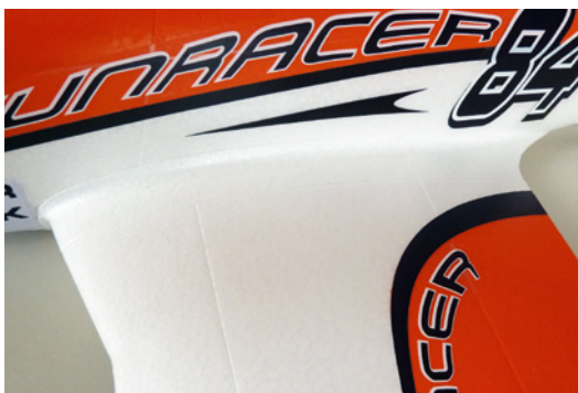
Die Trennstelle von Tragfläche und Rumpf ist kaum zu erkennen, der Übergang wurde sehr sauber gefertigt
