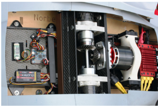
Antriebseinheit und Lagesteuerung der Osprey von Norbert Schürz
