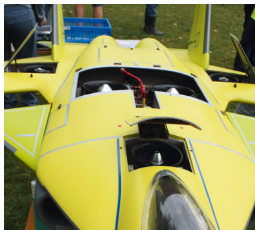
Schwenkbare Haupttriebwerke (in Flug durch Gitterblech verdeckt) ermöglichen vertikales Starten und Landen. Die unter Rumpffklappen arbeitenden Hilfstriebwerke dienen hauptsächlich der Lagestabilisierung
