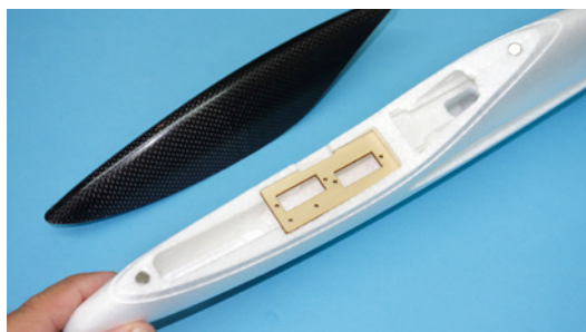
Das Servobrett ist ebenso ab Werk eingebaut, wie die Kabinenhaubenbefestigung mittels Magneten
