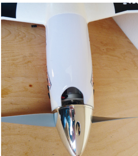
Die Unterseite der Motorhaube besteht aus Kunststoff, sie ist somit sehr widerstandsfähig und lässt sich leicht von Verschmutzungen befreien
