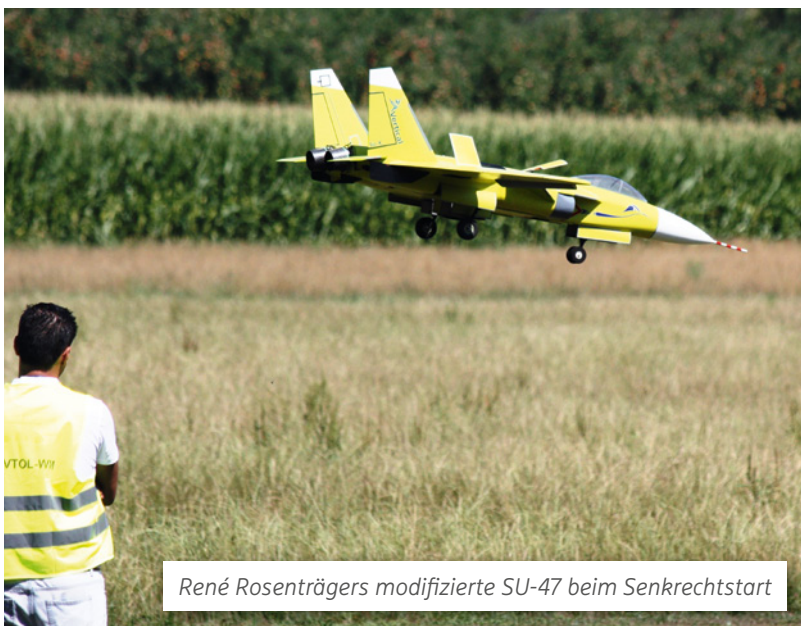
Schwenkbare Haupttriebwerke (in Flug durch Gitterblech verdeckt) ermöglichen vertikales Starten und Landen. Die unter Rumpffklappen arbeitenden Hilfstriebwerke dienen hauptsächlich der Lagestabilisierung
