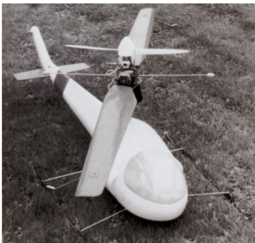
Einen aerodynamischen „Kaulquappen-Rumpf“ hatte Ewald Dittrich aus Bodenfelde designt. Die Flachblech-Taumelscheibe mit Abtast-Schuhen seines Modells mit Rückdrehmoment-Antrieb war weltweit einmalig. Es bewegte sich allerdings auch nicht vom Fleck, sondern blieb beim Start fest und sicher auf dem Boden stehen (Foto: Ferdinand Paul)
