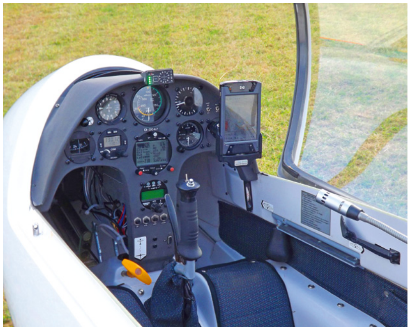
Im manntragenden Segler weiß der Pilot nicht nur die aktuelle Steig- oder Sinkrate (Variometer), sondern kann auch jederzeit den Wert, um den er in einem bestimmten Zeitraum gestiegen oder gesunken ist, nachvollziehen (Höhenmesser)
