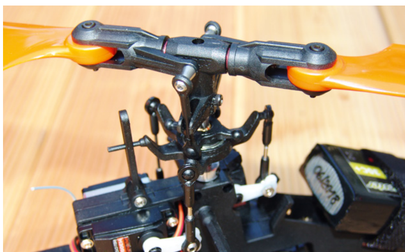
Der Rotorkopf besitzt eine durchgehende Blattlagerwelle aus Stahl. Die Anlenkung der Blattgriffe ist nachteilig, deshalb senkt sich die Taumelscheibe beim Steigen
