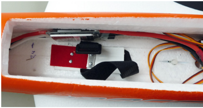
Nach einiger Zeit hatte sich das Befestigungsplättchen des Akkus gelöst und wurde daraufhin verschraubt
