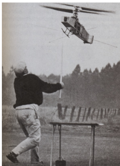
Der Koaxialhubschrauber von Herbert Deu aus Bucholtweimen zeigte, dass die Getriebekonstruktion bestens funktionierte. Ein Sprungstart erfolgte, danach schmierte der Hubschrauber jedoch auch seitlich ab und stürzte ins Gras (Foto: Ferdinand Paul)
