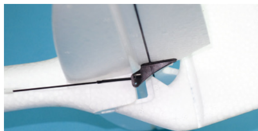
Auch die Anlenkungsdrähte sind einseitig fertig erstellt und müssen nur noch in die Ruderhörner eingehängt werden. Ebenfalls gut zu sehen ist die CFK-Verstärkung im Höhenleitwerk
