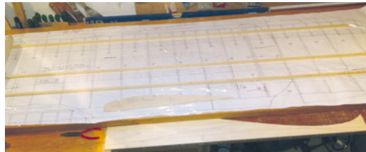
Die 10 x 10-Millimeter-Kiefernleisten in den Tragflächen verbinden die Rippen. Danach wurde alles mit 2-Millimeter-Balsaholz beplankt
