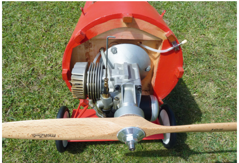
Der in der Fokker verbaute Super Tigre mit 25 Kubikzentimeter und dem großen Akuma-Schalldämpfer
