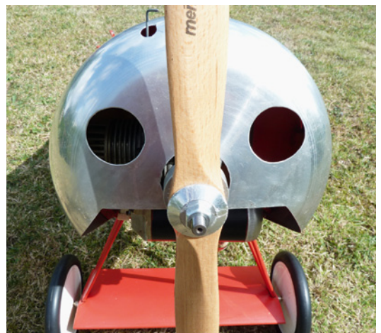
Der Motor verschwindet vollständig unter der großen Haube und wird trotzdem gut gekühlt
