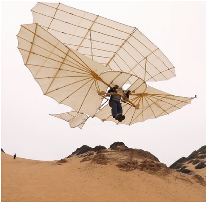
Dieser Doppeldecker ist ein Nachbau eines Fluggeräts von Flugpionier Otto Lilienthal. Er ist aus authentischen Materialien (Weidenruten, Hanfseil, Shirting und Stahldraht) nach erhaltenen Plänen Lilienthals und Stoffanalysen erhalten gebliebener Gleiter gebaut worden
