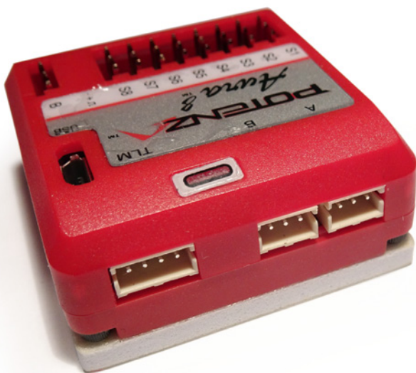
An den Mini Ports A + B können Spektrum-Satelliten angeschlossen werden
