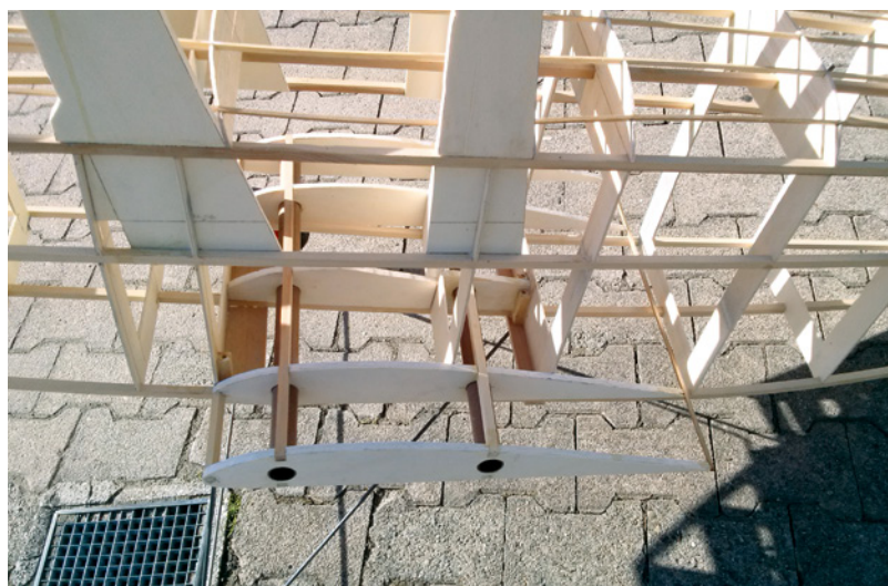
Durch die doppelt ausgeführte Tragflächensteckung sind die Flügel freitragend. Die Abspannung ist nur zur Sicherheit vorhanden
