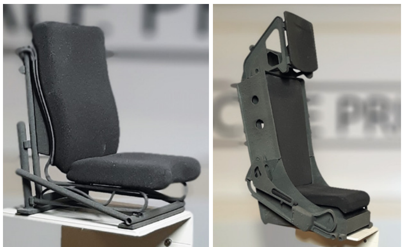
So sehen beispielsweise fertige Pilotensitze aus. Die Polster sind jeweils aus gummiartigem Material ebenfalls 3D-gedruckt
