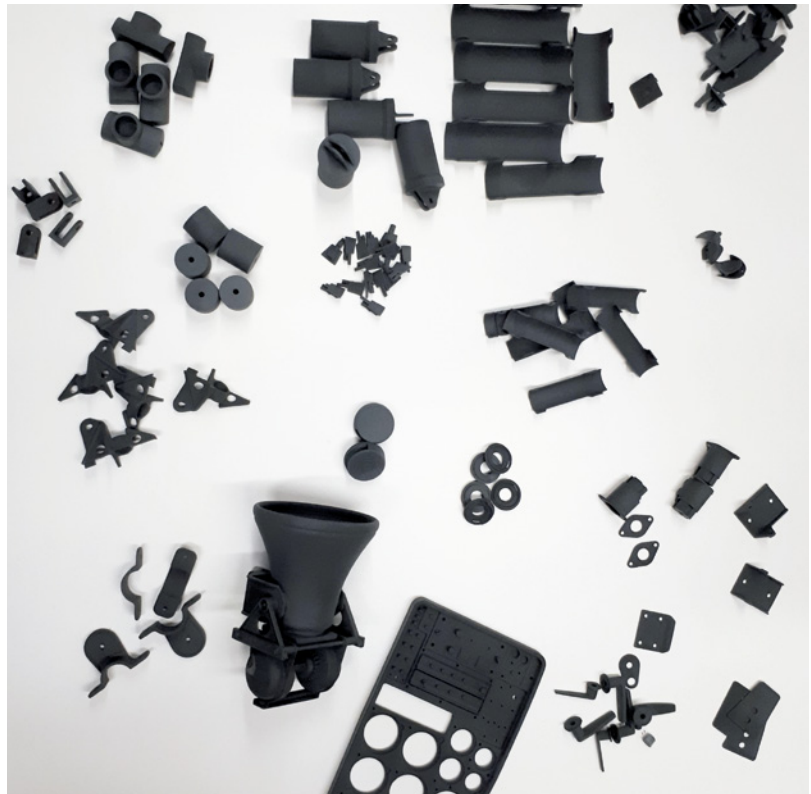
Ein Schritt nach dem Drucken ist das Sandstrahlen, wodurch die Oberfläche deutlich verbessert wird
