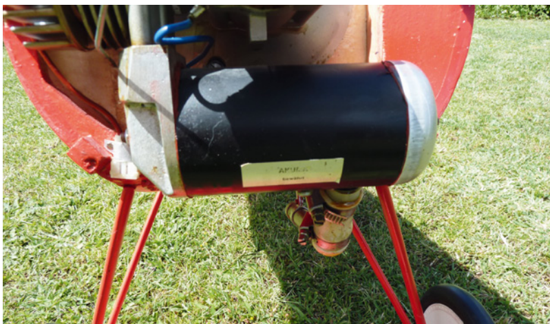
Der große Akuma-Schalldämpfer war seinerzeit ein sehr ausgereiftes Produkt zur wirksamen Schalldämpfung
