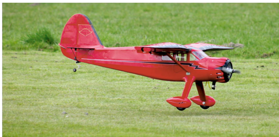
Die Stinson Reliant wurde zu früh zu stark abgefangen. Sie steigt, verliert Fahrt und sackt schließlich durch. Das harte Aufkommen mit dem Hauptfahrwerk zuerst lässt das Modell unkontrolliert springen
