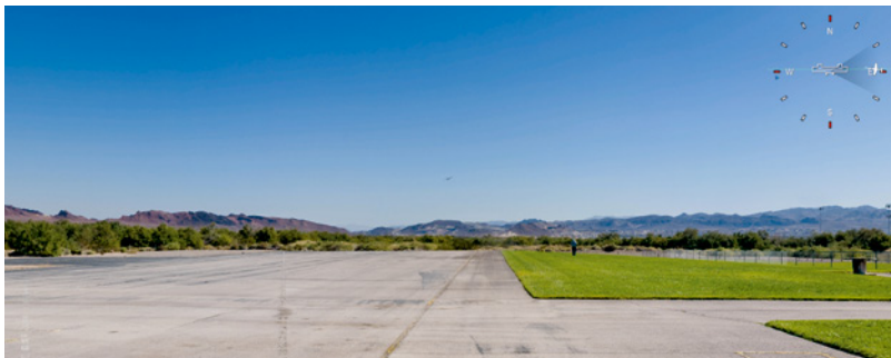
Hilfreich ist die neue Funktion „Platzradar“ (oben rechts). Sie zeigt die Position des Flugzeugs in Relation zur Landebahn an
