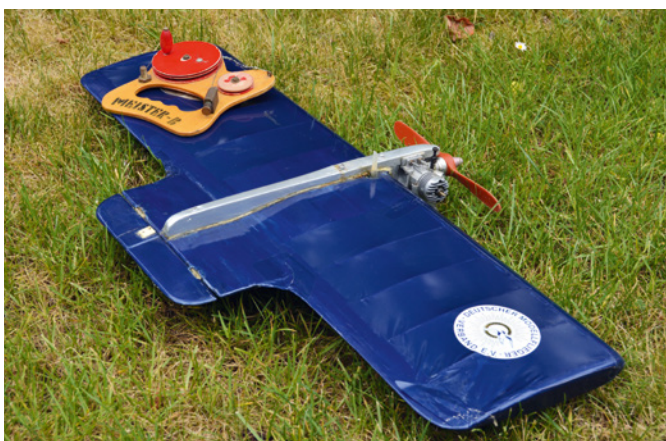
So sah ein einfacher Fesselflieger aus. Auf der linken Tragfläche liegt der Steuergriff
