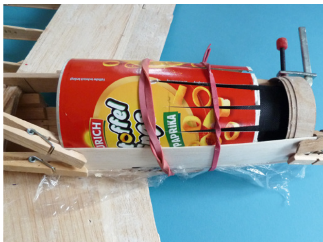
Die Lebensmittelverpackung wird hinten mehrfach eingeschnitten, etwas verjüngt und danach streifenweise mit Balsa verkleidet
