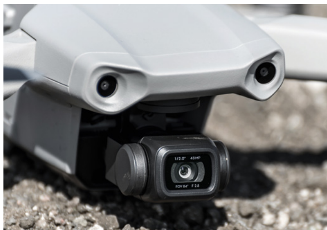
Äußerlich weist nur die Beschriftung auf den 48-Megapixel-Sensor in der Kamera hin
