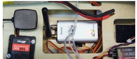
Hier sieht man den Raven im eingebauten Zustand mit seiner Verschlauchung
