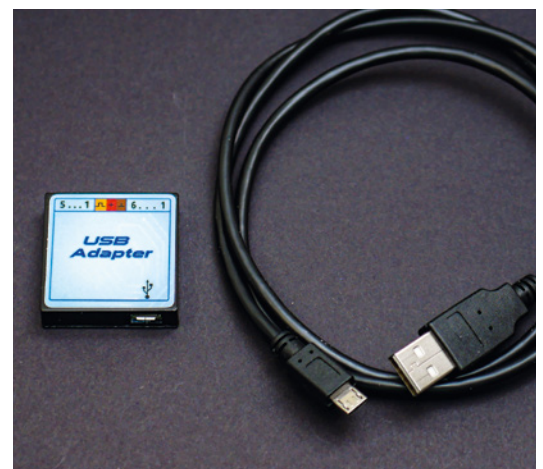
Das USB-Kabel wird nicht direkt an den Regler angeschlossen, sondern über einen Adapter per Telemetrie-Port. Das spart unter anderem zusätzliches Gewicht im Regler
