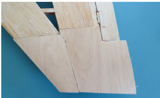
Der neue Randbogen wurde beplankt und muss noch verschliffen werden
