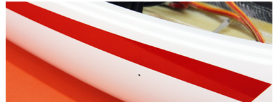
Der statische Druck wird links und rechts in der Rumpfsseitenwand über kleine Bohrungen abgenommen
