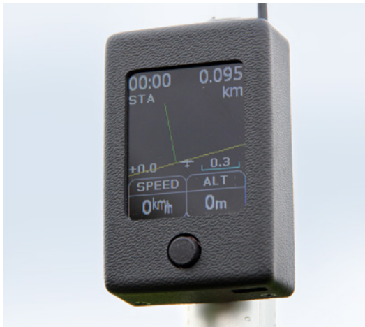
Das T3000 ist quasi das Urgestein beim GPS-Triangle-Fliegen. Das Display ist klein, zeigt aber alle notwendigen Informationen an
