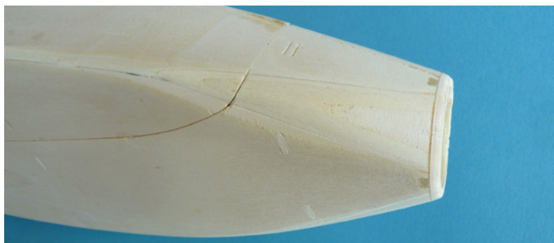
Der verrundete Übergang vom Motorspant zum eckigen Kastenrumpf nach dem Verschleifen
