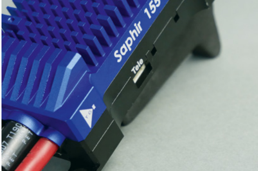
Der Telemetrie-Anschluss findet sich seitlich am Gehäuse des Saphir 155
