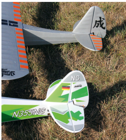
Der Rumpf der neuen Cub (unten) ist deutlich dicker und das Seitenruder etwas größer geworden als bei der Vorgängerin
