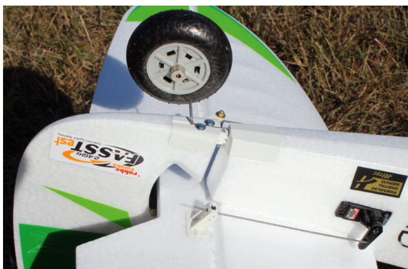
Die Anlenkung der Ruder erfolgt über im Rumpf eingebaute Servos. Die neue Lagerung des Heckfahrwerks ist zweckmäßig und gut gelungen
