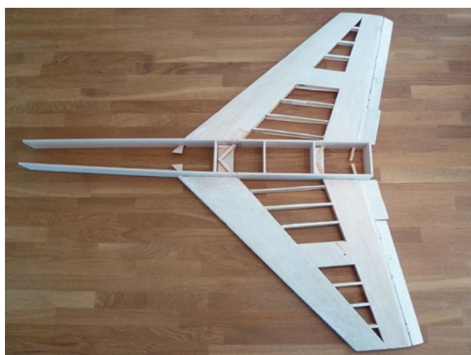
Die Rumpfhälften wurden in die Tragfläche eingeklebt, jetzt kann an dieser Einheit weiter gebaut werden
