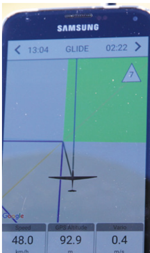
So sieht es aus, während geflogen wird: Der Pilot hat sieben Dreiecke vollendet, befindet sich in gut 90 Meter Höhe und fliegt leicht außerhalb des Kurses auf den Wendepunkt zu. Grün gekennzeichnet ist der Wendesektor, den er auf jeden Fall durchfliegen muss
