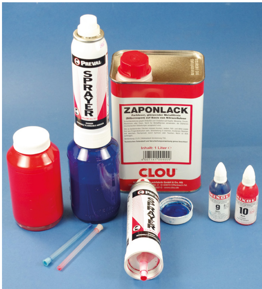
Anders als in Spraydosen sind beim Preval-System Treibgas und Lack nicht vermischt. Die Kartusche mit dem Gas wird auf das Glas geschraubt; der Nebel ist fein und gut dosierbar. Für unsere Zwecke eignet sich mit Farbpaste abgetönter Zaponlack, 50 Prozent verdünnt
