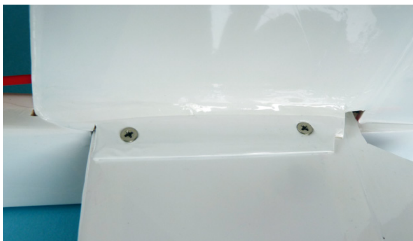
Die Verschraubung des Leitwerks, nachdem es bespannt wurde. Mit vier Schrauben auf beiden Seiten und der breiten Auflage sitzt das Leitwerk sicher
