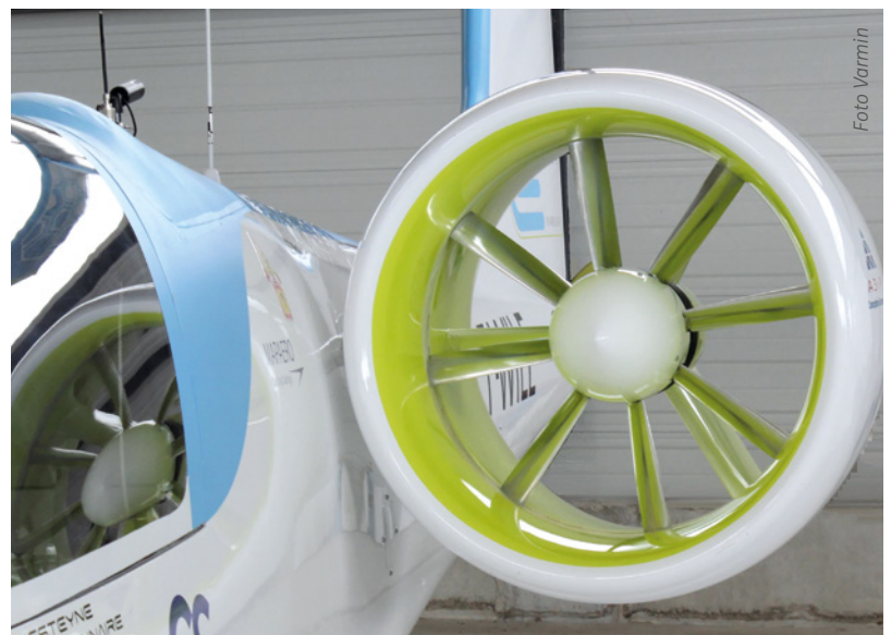
Bild 2: Das kleine Fan-Triebwerk der E-Fan von Airbus
