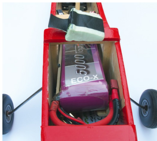
Die Akkus werden in allen Modellen auf Holz-Rutschen montiert und sitzen so sicher in den Modellen
