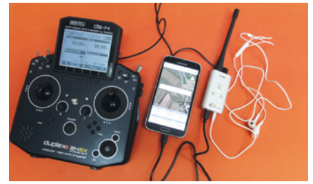
Mittels eingebautem Audio-Mischer im Snipe lassen sich sowohl die Ansagen vom Sender als auch direkt vom Snipe auf die Ohrhörer übertragen
