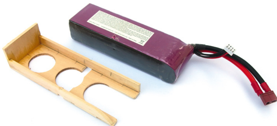
Die Akkus werden in allen Modellen auf Holz-Rutschen montiert und sitzen so sicher in den Modellen
