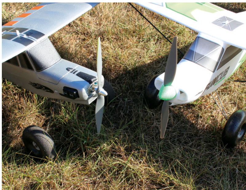
Die Optik und der Motoreinbau haben sich schon sehr verändert und lassen die alte FunCub (links) etwas schlanker erscheinen
