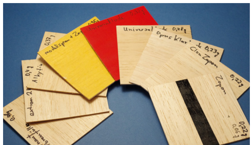
Versuchsreihe Klarlack auf Balsaholz: Um die Gewichte der Imprägnierung von Holzflügeln zu vergleichen, wurde ein 2-Millimeter-Balsabrettchen in Stücke von 1 Quadratdezimeter geteilt und vor sowie nach dem Lackieren mit einer Feinwaage gewogen. Lackauftrag mit Borstenpinsel, Zwischenschliff mit 800er-Schleifpapier.
