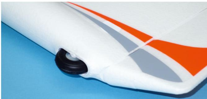
Beim Lentus Thermik kommt nicht nur ein einfacher Sporn zum Einsatz, sondern ein funktionsfähiges Spornrad. Ebenfalls sehr gut sichtbar ist das Seitenruder, das in einer Hohlkehle gelagert ist
