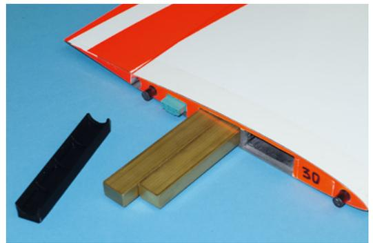
Zwei Messingstangen zu je 100 Gramm lassen sich pro Tragflächenhälfte einschieben. Das Distanzstück, falls nur eine Stange zum Einsatz kommt, stammt aus dem 3D-Drucker
