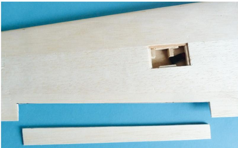
Die Querruder werden mit Balsamesser und Feinsäge aus der Endleiste herausgeschnitten
