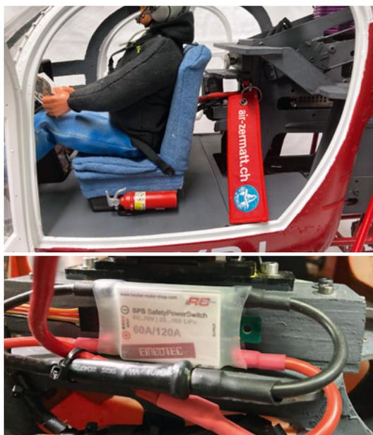
Versteckter Einbau des Stiftgebers in der Vario Lama. Der eigentliche Schalter kann im Modell an beliebiger Stelle platziert werden
