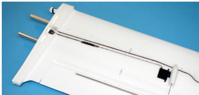
Das Modell glänzt mit einer sauberen Bauausführung, egal ob beim Kabelsatz und dessen Einbau, beim Servoeinbau mitsamt der Anlenkungen oder den diversen, eingebrachten Verstärkungen
