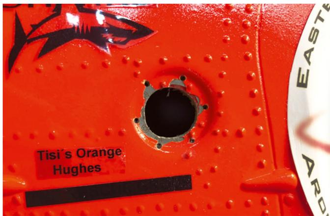
In der MD-500 werden Löcher gebohrt und die Öffnung für den Schalter angepasst. Montiert wird der Schalter mittels sechs Schrauben und einer ebenfalls im Lieferumfang enthaltenen Dichtung
