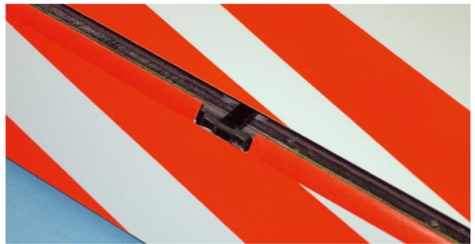
Die IDS-Ruderhörner sind in der korrekten Position und Ausrichtung im Flügel positioniert und satt eingeklebt
