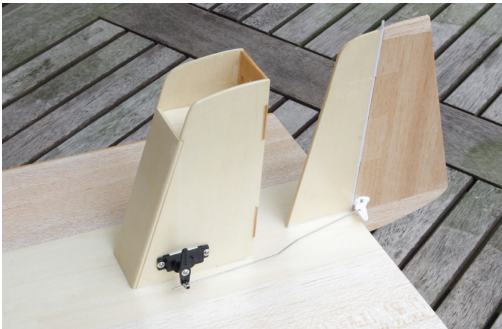
Pylon für den schnell drehenden Car-Motor – inzwischen abgesägt und ersetzt. Scharnier fürs Ruder des Seitenleitwerks aus Bowdenzug-Innen- und Außenrohr
