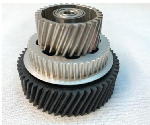
Es sieht aus wie eine futuristische Torte, ist aber tatsächlich das Zahnradpaket, das die Motorkraft aufnimmt und an den Riemen des Heckrotors sowie das Hauptzahnrad weitergibt
