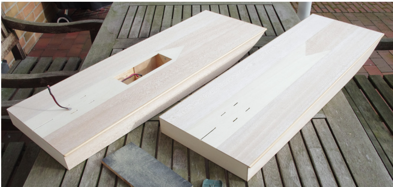
Beim Bau der 90-Zentimeter-Boote gab's viel Schleifstaub. Links das eigene; das Kabel für die Stromversorgung ist mit Heißkleber abgedichtet. Die Schüler (Modell rechts) wollten Motoraufbau und Stromversorgung selbst übernehmen
