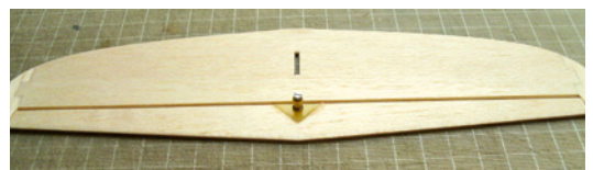
Der Aufnahmepunkt des Ruderhorns im Höhenruder ist mit einer GFK-Platte verstärkt, um den enormen Belastungen bei über 250 Kilometer pro Stunde standhalten zu können
