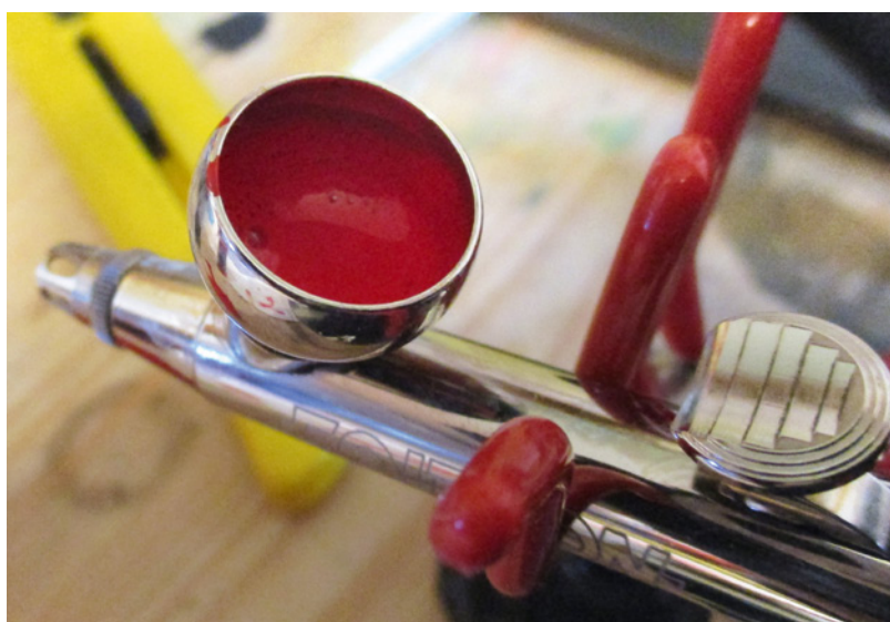
Die Farbe wird einfach in den Behälter der Pistole eingefüllt. Dabei muss sie in der Regel etwas verdünnt werden
