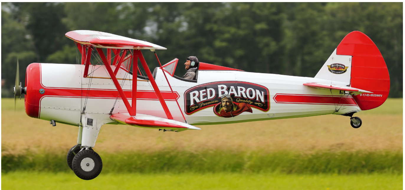
Das Original der Boeing PT-17 Super Stearman „Red Baron“ wurde berühmt als Akrobatik-Star bei vielen Flugshows. Der imposante Doppeldecker von Heike und Kai Ohrt mit 4.100 Millimeter Spannweite und Moki S 400 Fünfzylinder-Sternmotor mit 23 PS wurde gekonnt in Szene gesetzt
