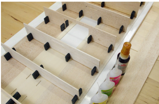
Spanten werden auf der Unterseite des Decks ausgerichtet. Ist der Leim hart, folgen die vorgeschrittenen Seiten
