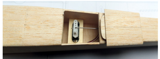
Das Höhenruderservo ist über eine separate Klappe zugänglich
