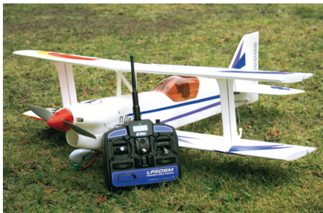
Die 2,4-Gigahertz-RC-Technik sorgt dafür, dass Frequenzabsprachen mit bunten Klammern an den meterlangen 35-Megahertz-Antennen zum Auslaufmodell werden
