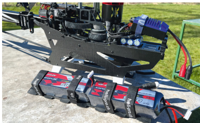
Der Test-Heli wurde mit zwei 6s-LiPos geflogen
