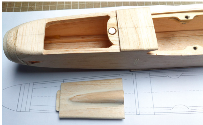
Im vorderen Rumpfbereich befindet sich eine abnehmbare Klappe, die magnetisch gehalten wird
