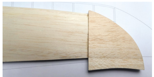
Die Randbögen entstehen aus einem massiven Balsastück, das in Form gebracht wird
