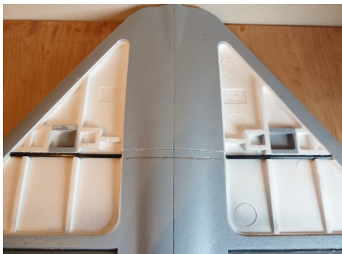
Nachdem das CFK-Rohr eingebaut ist, gilt es, den Ausschnitt auf der Flächenunterseite wieder zu verschließen
