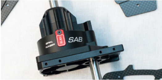
Eine Besonderheit des SAB RAW 580 ist die gekapselte Hauptgetriebeinheit
