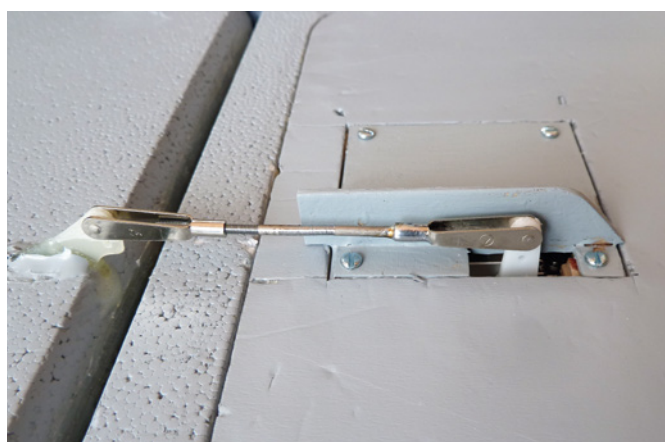
Kurz und direkt ist die Verbindung vom Servo zum Ruderhorn
