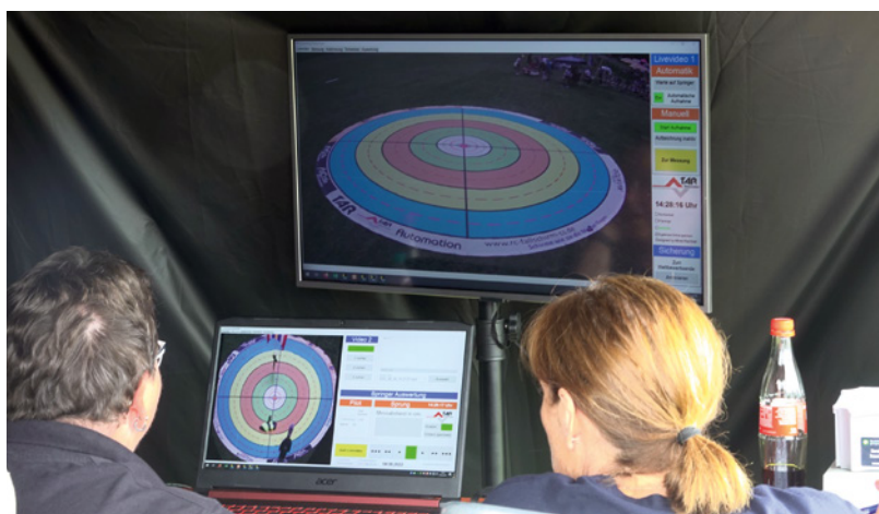
Zum ersten Mal kam die neue Zielkreis-Messanlage auf einer EM zum Einsatz. So konnte bei minimalem Personalaufwand zentimetergenau der Landepunkt bestimmt werden
