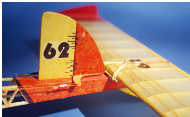
Seitenruder mit Faden-Scharnier – auf der anderen Seite zieht eine Spiralfeder. Ein Gummiring vorn will das Höhenleitwerk hinten hochziehen, doch die Steuerleine zum Servo bremst
