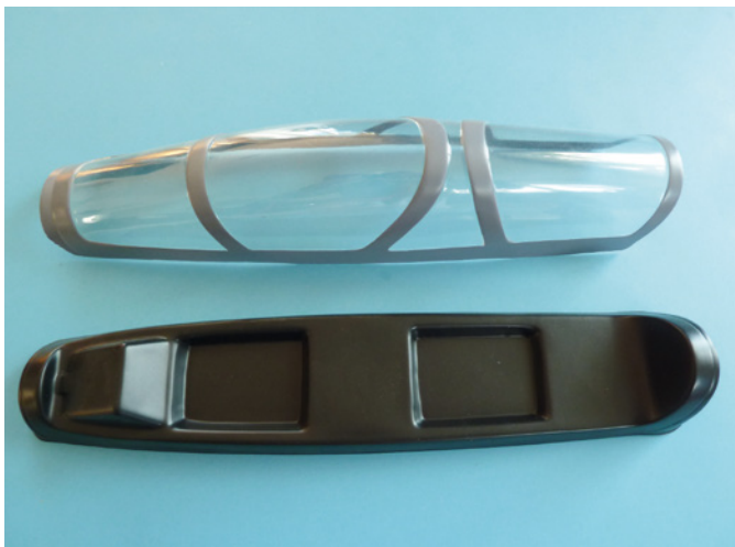
Der Haubenrahmen muss noch beschnitten werden, bevor die Haube darauf geklebt wird
