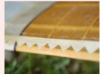
Die Größe der Zacken aus 0,6-Millimeter-Balsa spielt keine Rolle – ob mit Hilfe einer Schablone geschnitten oder mit der Zackenschere
