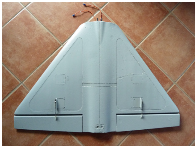
Die fertige Tragfläche von unten – die nachlackierten Bereiche fallen kaum auf
