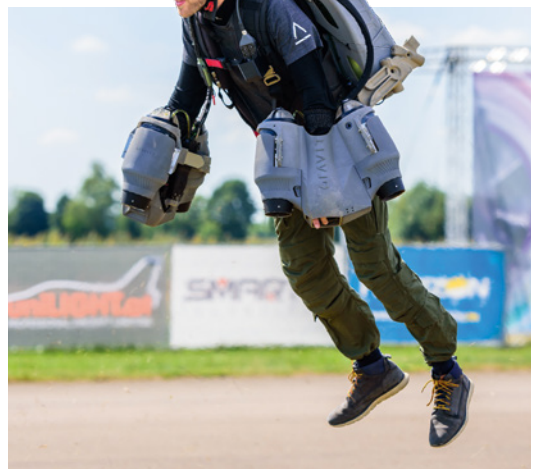
Kein alltäglicher Anblick: Sam Rogers von Gravity Industries präsentierte den rund 1.000 PS starken Jet-Anzug. Mit Hilfe von fünf Turbinen hebt die Konstruktion einen Menschen mühelos in den Himmel
