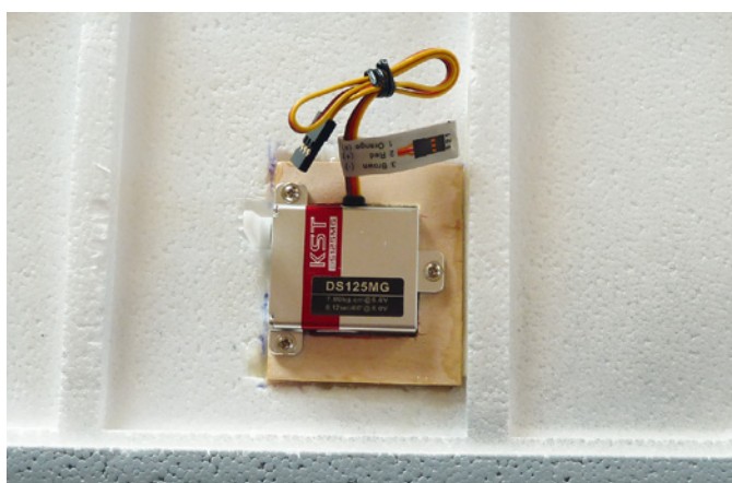
Das Flächenservo wurde mitsamt dem Einbaurahmen in die Fläche geklebt
