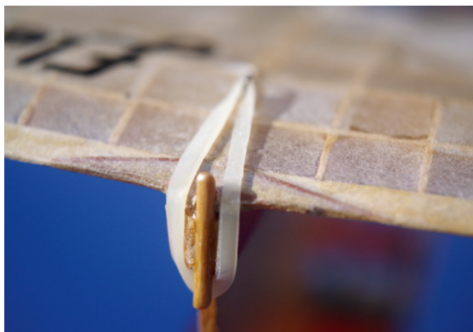
Für den Flügel genügen eine kleine Auflage und zwei kleine Gummiringe
