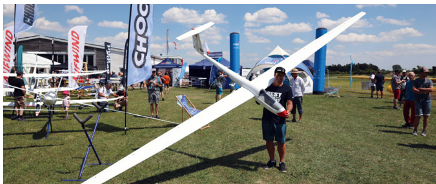
Daniel Aeberli von Chocofly präsentierte in Schwabmünchen die neue „GPS-Scale-Maschine“ Nimbus 2c in 1:3: 6.800 Millimeter Spannweite, ab etwa 15 Kilogramm Abfluggewicht
