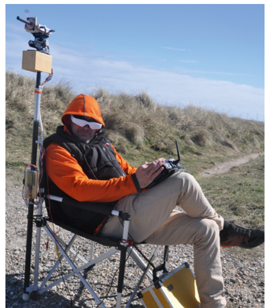
Ein FPV-Flieger in Aktion. Die Zeiss-Video-Brille war gut, leider nicht sehr lange in Produktion. Es gab aber inzwischen andere. Mit dem Antennen-Tracker – links im Bild – wurde die Reichweite um ein Vielfaches erhöht. Ein Gerät, das sehr aufwändig und in seiner Funktionsweise faszinierend war
