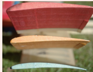
Die Profile von oben nach unten: Schwartzbach 68, Qinfel und Gö 495
