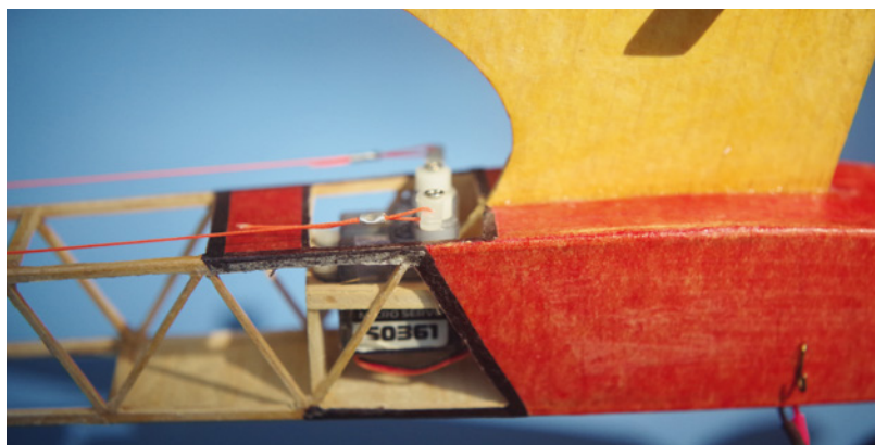
Servos stehen frei hinter dem Pylonen – wenig Platz im Rumpf
