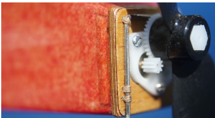
Motoren samt Getriebe auf den Frontspant geschraubt
