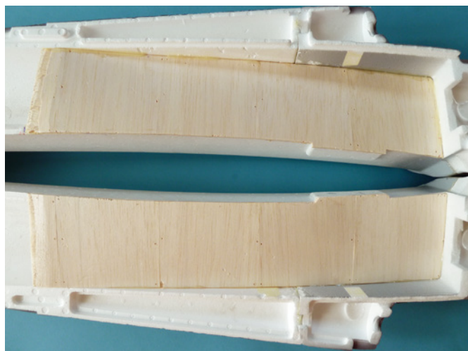
Die ergänzte Luftführung aus Balsa wurde in beide Rumpfhälften eingeklebt
