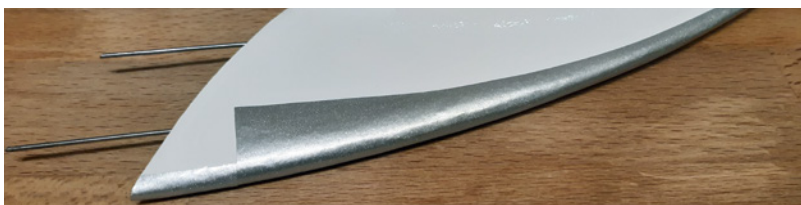
Die Winglets werden einfach mit Hilfe von zwei Metalldrähten an den Flügel gesteckt
