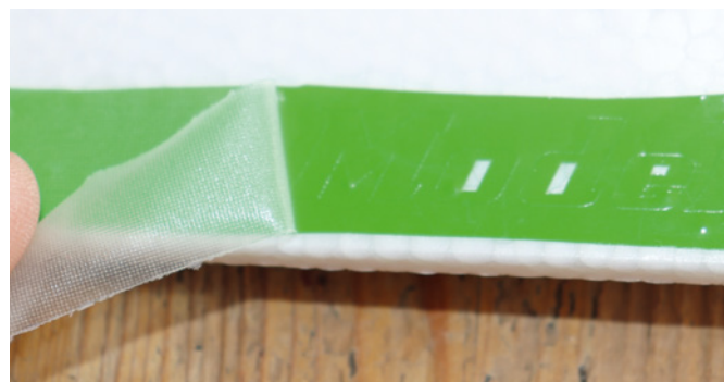
Der teilentgitterte Schriftzug ist nun aufgebracht und die Transferfolie wird langsam und in flachem Winkel abgezogen
