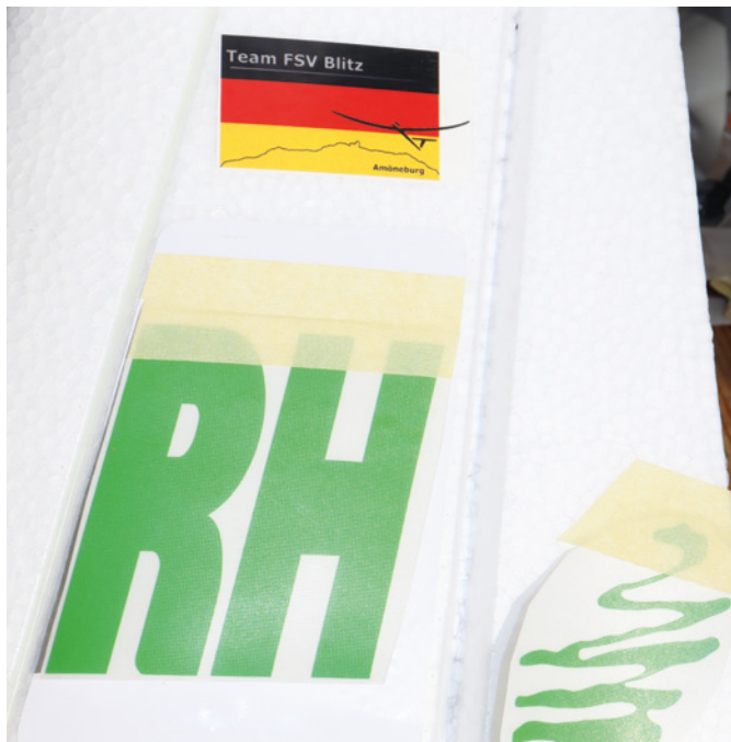
Die fertigen Aufkleber werden zunächst mit der Transferfolie und Kreppklebeband an ihrer gewünschten Position fixiert
