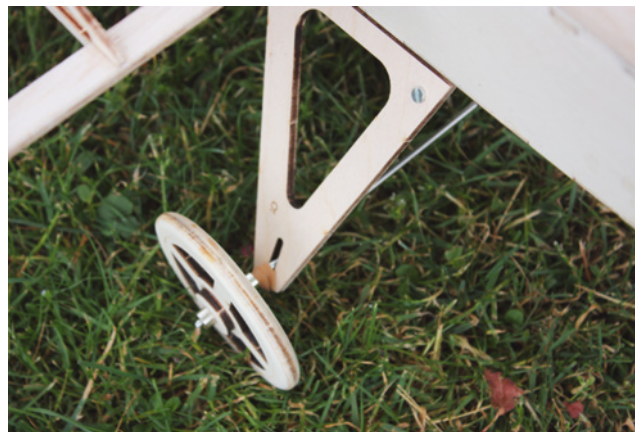
Die Gummifederung ist einfach und funktioniert klaglos
