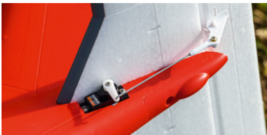
Es kommen durchweg Multiplex-Servos zum Einsatz. Die Ruderanlenkungen sind einwandfrei
