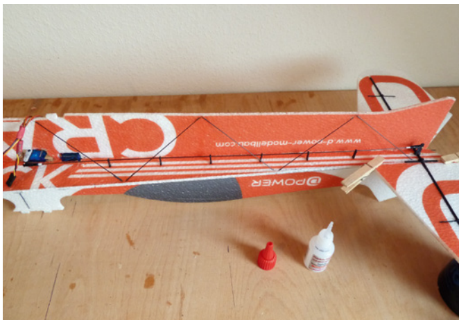
Die fertige Anlenkung des Höhenruders
