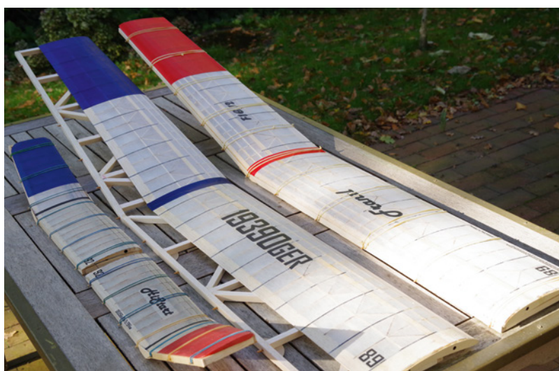
Verzugsfreie Flügel in Holzbauweise, ob für 900 oder 2.900 Millimeter Spannweite
