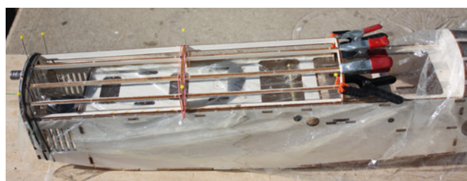
In Stäbchenbauweise entsteht der runde Rumpfrücken
