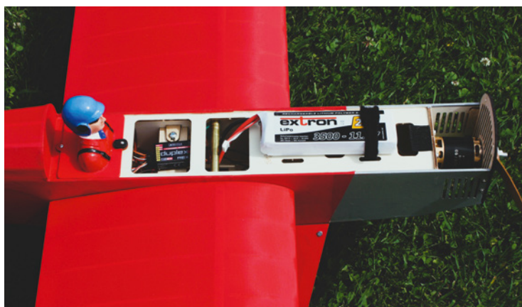
Der Schwerpunkt lässt sich leicht durch Verschieben des Akkus einstellen
