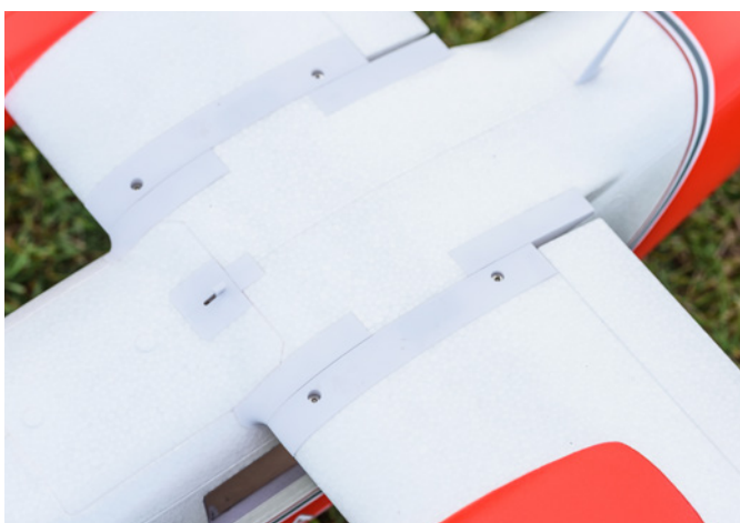
Vier Schrauben halten die Flügel sicher am Rumpf. Man sollte sie nur nicht verlieren
