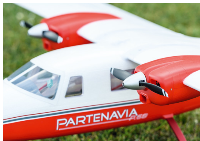
Die beiden gegenläufigen 8 x 5-Zoll-Propeller mit Spinnern unterstreichen den Semi-Scale-Charakter des Modells
