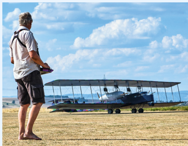
In 3 Jahren Bauzeit wurde diese über 10 Meter spannende Zeppelin Staaken RV 6 gebaut. Als Antrieb dienen vier Motoren à 116 Kubikzentimeter Hubraum. Das Gewicht beträgt maximal 147 Kilogramm
