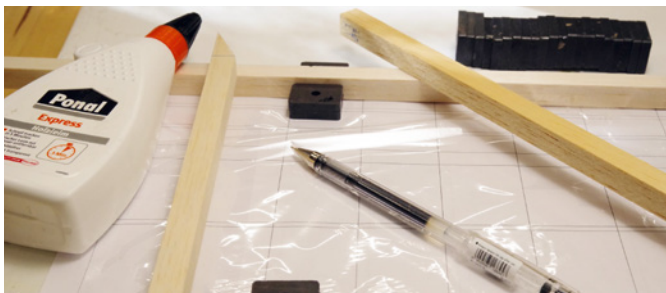
Je nach Modellgröße sind Balsaleisten von 5 × 10 bis 12 × 12 Millimeter richtig. Gebaut wird auf dem Plan
