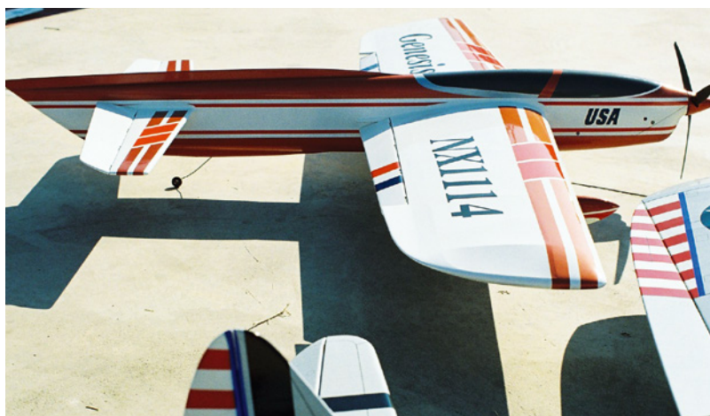
Das Profil des berühmten F2B-Kunstflugmodells „Genesis“ von Bob Hunt ist 17 Prozent dick
