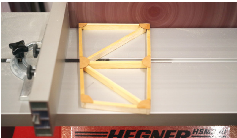
Mit dem Tellerschleifer lassen sich auch V-Form-Winkel vorbereiten
