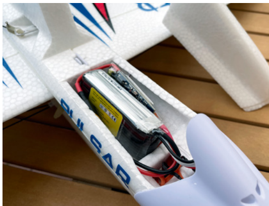
Unter der Haube finden ein 20-Ampere-Pulsar-Regler und ein Lemon RC-LiPo-Akku mit einer Kapazität von 850 Milliamperestunden Platz
