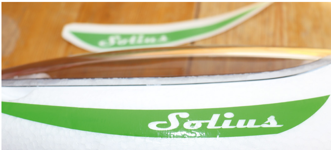
Die sehr dünne Folie legt sich gut an die Vertiefungen des Schaumes an und klebt dauerhaft fest
