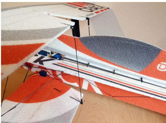
Oberes und unteres Querruder werden mit einer CFK-Stange und 2 Gabelköpfen miteinander verbunden
