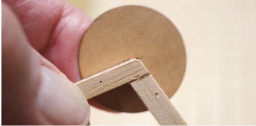
Eckverbindungen aus Kraftplex oder aus dünnem Sperrholz schneidet der Lasercutter Mr Beam
