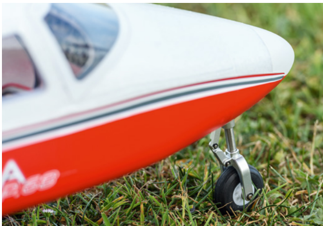
Eine Besonderheit ist das eigens entwickelte Metall-Bugfahrwerk – natürlich gefedert
