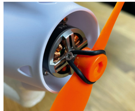
Die Befestigung des Propellers ist sehr fummelig. Ein Umstieg auf eine Klemmbefestigung könnte Abhilfe schaffen
