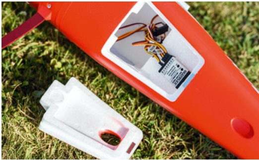
Eine magnetisch gehaltene Klappe auf der Rumpfunterseite bietet genügend Platz für den Empfänger. Alle Kabel sind sauber beschriftet
