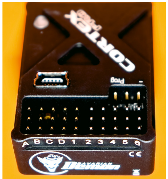
Über den USB-Anschluss kann der Kريسell via PC oder Smartphone programmiert werden
