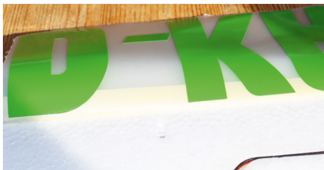
Ist das Dekor an der vorgesehenen Stelle positioniert, wird es umgeklappt und die Schutzfolie abgezogen
