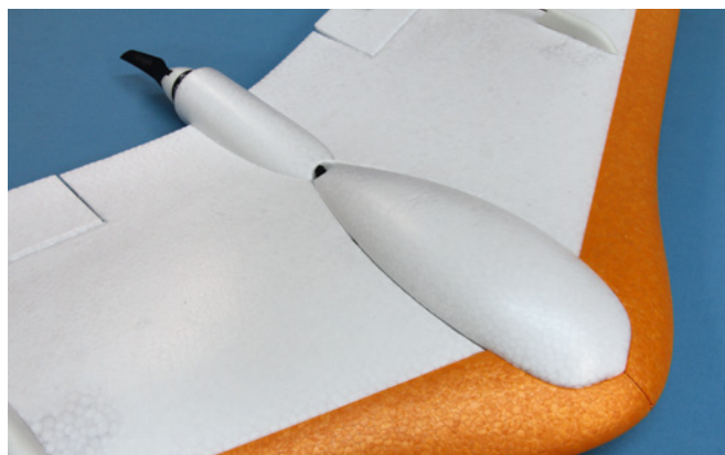
Der Antriebssatz wird einfach von hinten nach vorne auf den Rumpf aufgeschoben und Magnete halten ihn in Position
