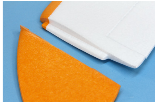
Die beiden Tiplets werden nicht nur stumpf an den Flügel angeklebt, sondern besitzen einen Steg und die entsprechende Vertiefung im Gegenstück
