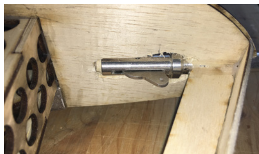
Schleppkupplung in der Zentralrippe vor dem Einharzen
