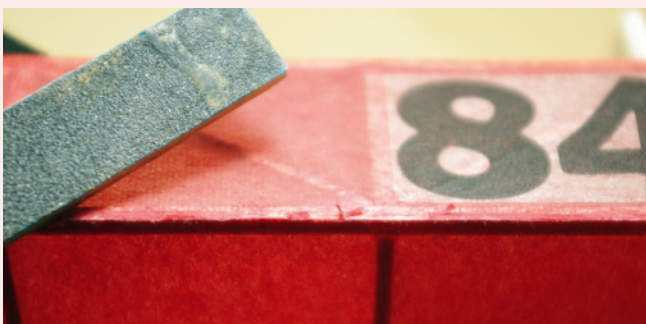
Abschleifen des Überstands der Bespannung
