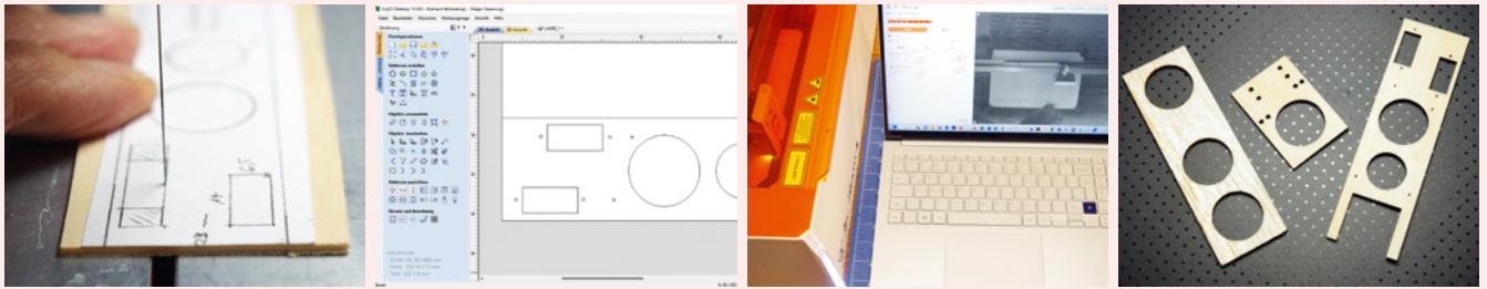
Das Sägen des Servo- und Empfängerhalters ist langwierig. Schneller geht es mit dem Zeichenprogramm Cut2D und dem Lasercutter Mr Beam
