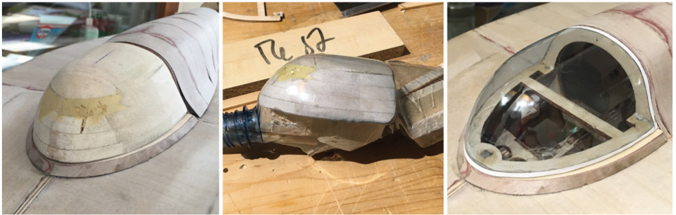
Die Kabinenhaube entstand aus einer PET-Flasche mit Positivform im Backofen
