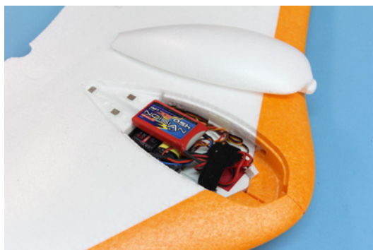
In der Seglerkonfiguration sitzt der Empfängerakku aus Schwerpunktgründen direkt über dem Empfänger
