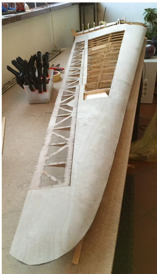
Eine Tragflächenhälfte ist fertig gebaut. Nach der Feinarbeit kann es theoretisch schon ans Bespannen gehen
