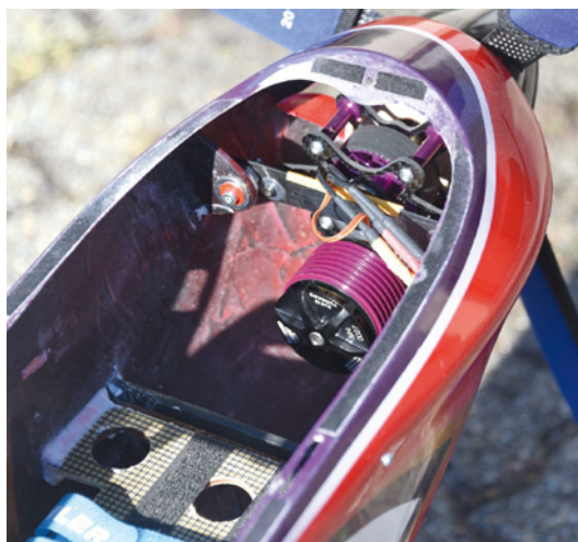
Der Einbau in den Rumpf erfolgt über schwingungs-dämpfende Gummielemente – Laufruhe ist alles
