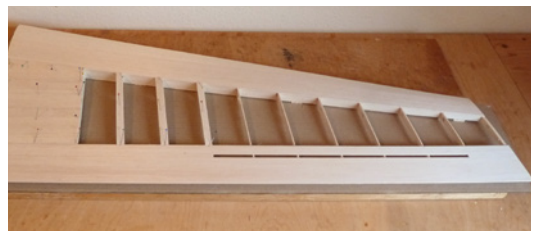
Nachdem Nase und Endleiste beplankt sind, werden die Zwischenräume beplankt beziehungsweise die Rippen mit Aufleimern versehen
