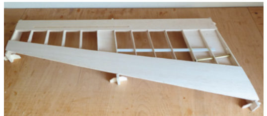
Durch die Lagerung der Fläche auf den Flächenschablonen ergibt sich nach dem Aufbringen der unteren Beplankung eine verzugsfreie Tragfläche
