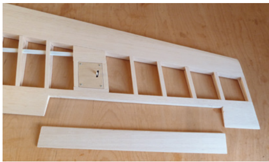
Das verkastete und verschliffene Ruder liegt bereit für die Montage des Ruderhorns und der Anlenkung
