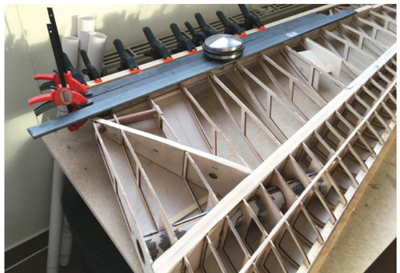
Solange die Beplankung noch nicht fertig ist, sollte man die Flügelkonstruktionen immer durch Gewichte auf der Helling halten, damit sich nichts verzieht
