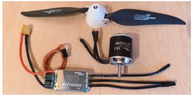
Die Antriebskomponenten: Motor actro-n 35-4-1100, Regler actrocon 60A, Luftschraube Cam Carbon 11 x 8 Zoll mit Z-Spinner
