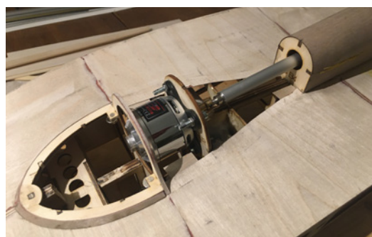
Motor mit Wellenkupplung. Welle und Stevenrohr stammen aus dem Schiffsmodellbau
