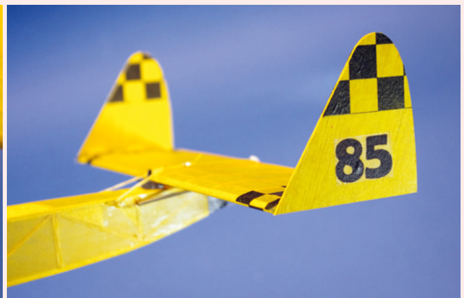
Die Nase des Höhenleitwerks fasst in einen kleinen Dübel, um den es sich drehen kann
