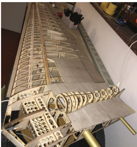
Die rechte Fläche im Rohbau mit Rumpf. Nun geht es an die Beplankung
