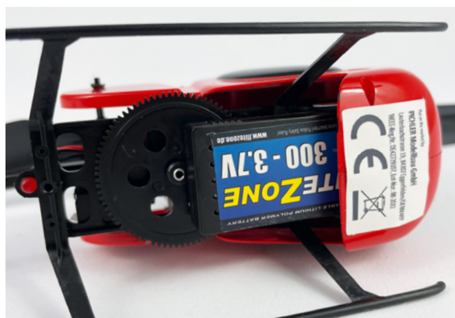
Der 1s-LiPo sitzt in einem Hardcase und wird unten in das Chassis eingeschoben. Kabel oder Stecker entfallen dadurch
