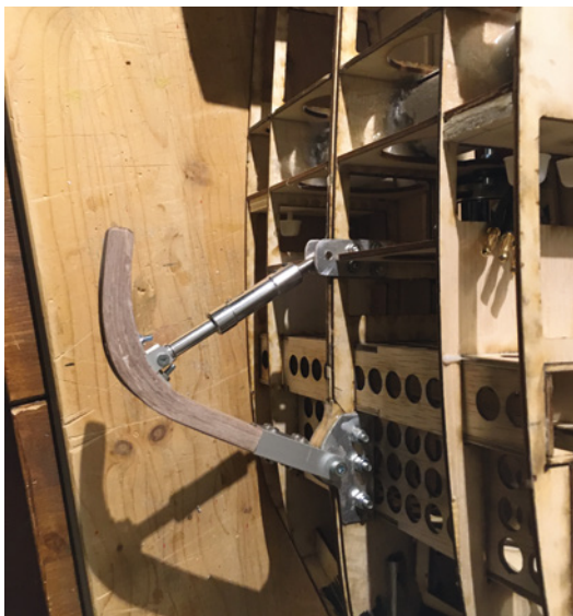
Landekufe ist an der Zentralrippe montiert
