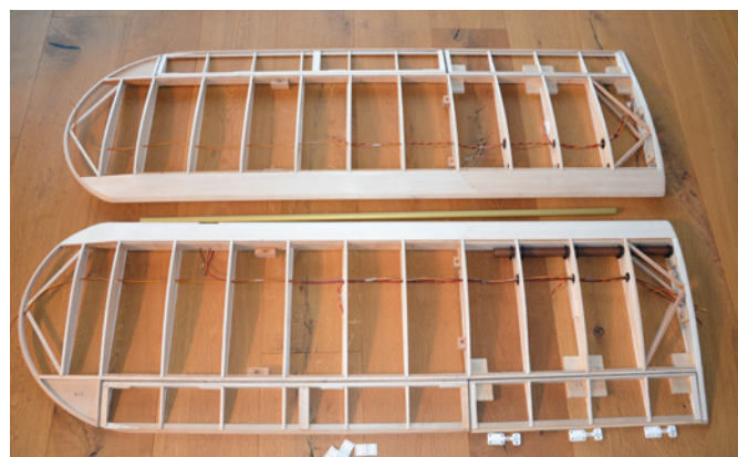
Die Tragflächen sind im Rohbau fertig. Man sieht gut die Leichtbauweise
