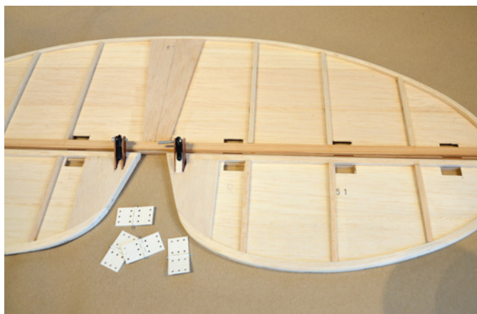
Höhenruder und Höhenleitwerk sind bereit für die Hochzeit. Zuvor muss aber noch die Bespannung drauf
