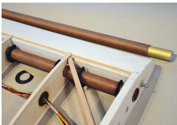
Die Rohre zur Aufnahme des Flächenverbinders werden mithilfe von passenden Hülsen in den Tragflächen verklebt. So ist sichergestellt, dass alles spannungsfrei sitzt
