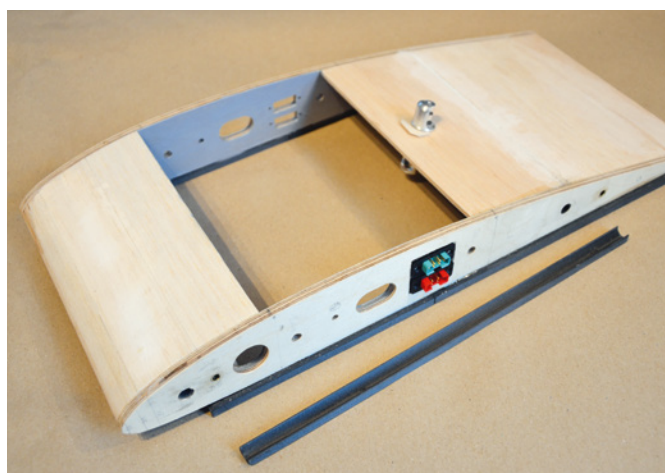
Das Flächenmittelstück wird mit dem Rumpf verbunden. Schleppkupplung und die ersten Steckverbinder zur Tragfläche sind schon montiert
