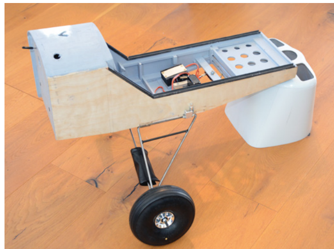
Mehr ist vom ursprünglichen Piper-Rumpf nicht über. Der Rest der Zelle entsteht in Gitterrohr-Bauweise
