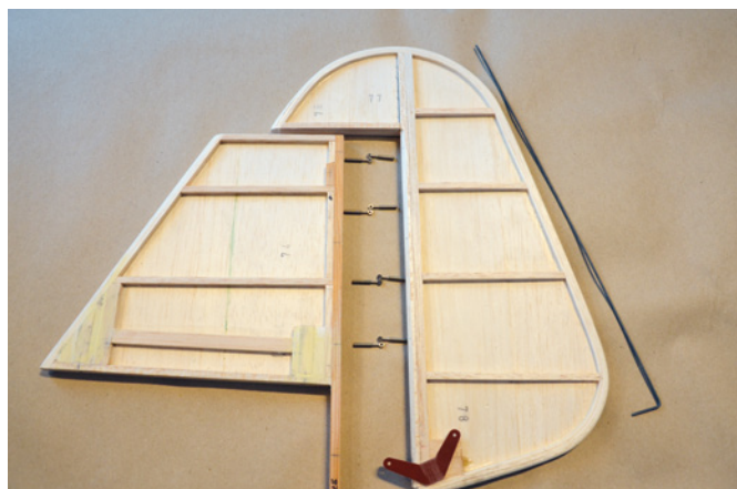
Das Seitenruder wird mit Augschrauben gehalten. Ein durchgängiger Draht sorgt für eine sichere, aber lösbare Verbindung
