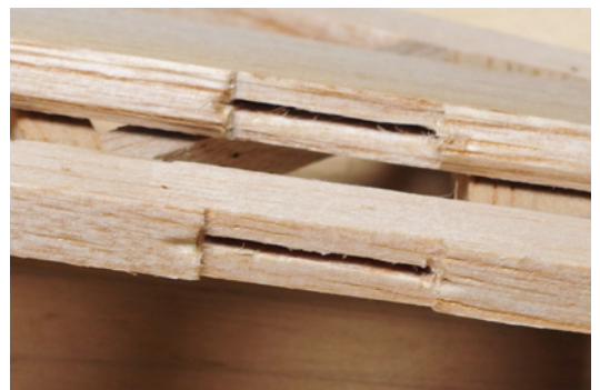
Mit etwas Übung entstehen so Aussparungen, welche die Scharniere exakt aufnehmen. Bei der hier angewandten Vergrößerung erscheinen schon kleine Toleranzen allerdings recht dramatisch
