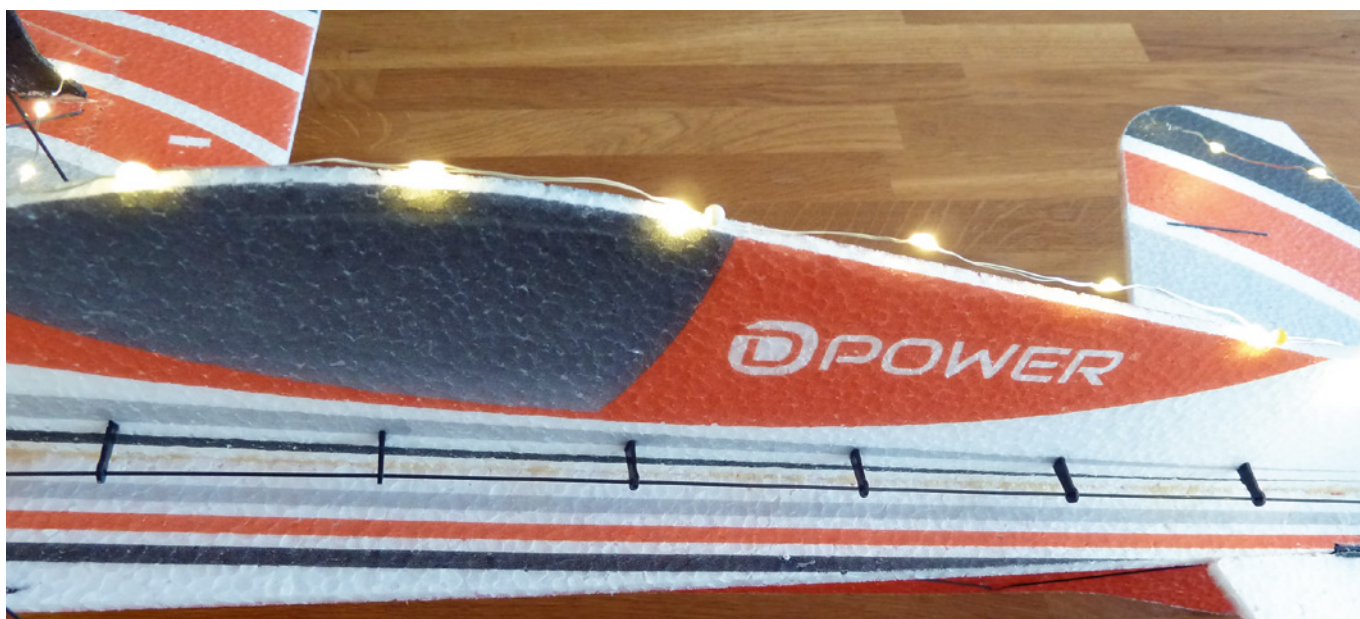
Oben am Rumpfrücken wird die Lichterkette nach vorne geführt und dabei mit Stecknadeln befestigt
