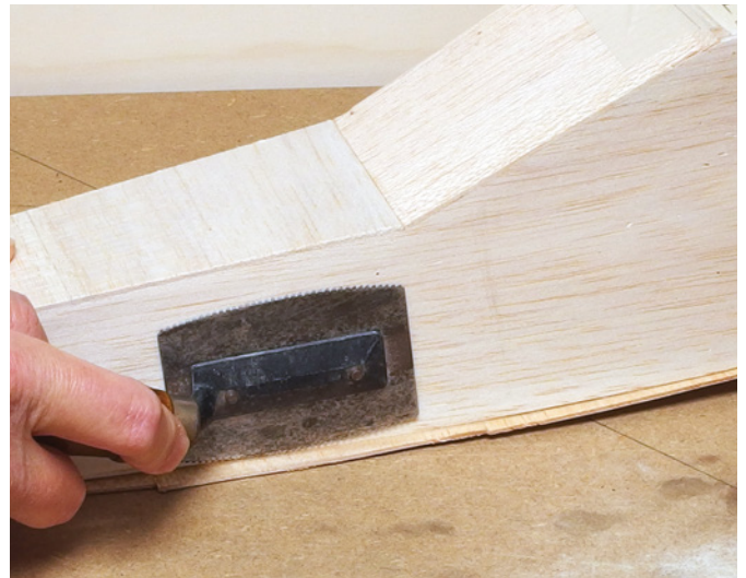
Diese Anwendung kommt dem ursprünglich gedachten Zweck der Furniersäge am nächsten: Abtrennen des überstehenden Materials längs einer Fläche
