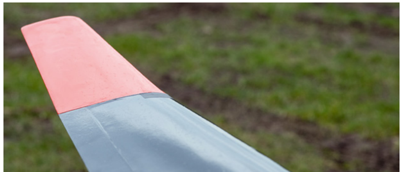
Der Autor hat bei seiner Cyclone XT zusätzliche Flächenverlängerungen angebracht, die die ohnehin schon gigantische Spannweite nochmals um etwa 600 Millimeter vergrößern
