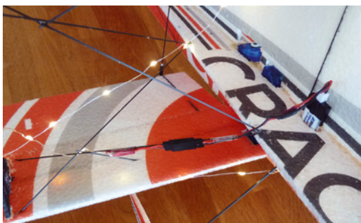
Das Anschlusskabel wird mit Tesa an einer CFK-Strebe festgeklebt, der Beleuchtungsakku in das EPP des Rumpfs gesteckt
