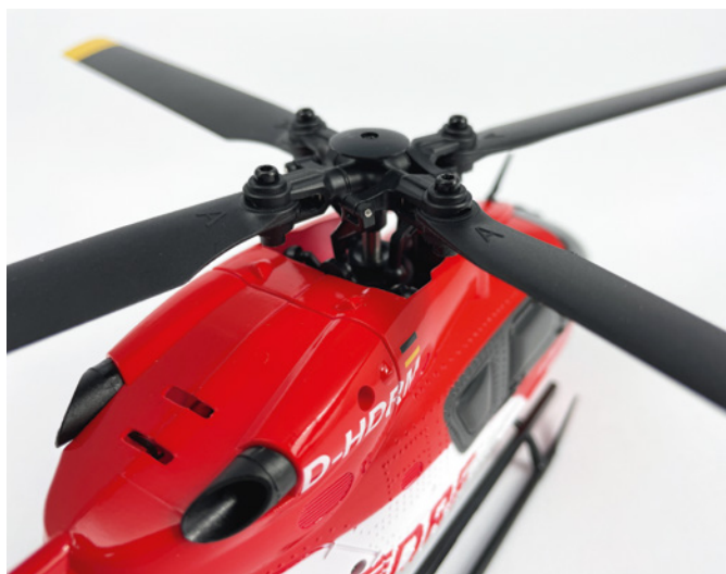
Wie beim großen Original: der Vierblatt-Hauptrotor
