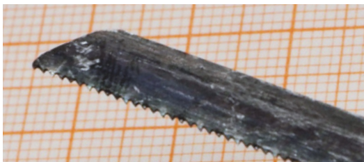
Das Ende des Sägeblattes wird angeschrägt, man beachte die Zahnung
