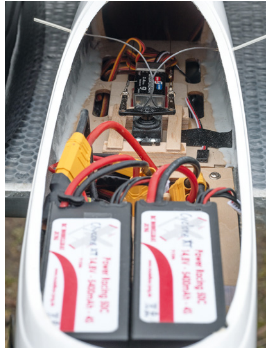
Die beiden 4s-LiPos haben im geräumigen Rumpf ausreichend Platz
