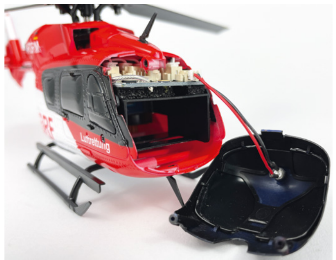
Hinter der Cockpitscheibe ist Platz für den Akku
