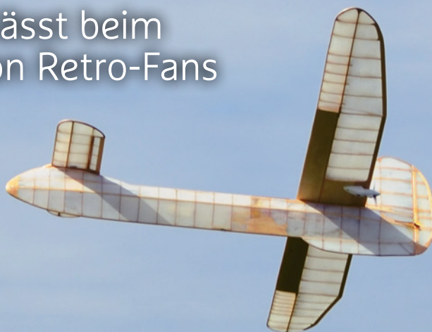
Die Ruder sind direkt mit dem Bespannvlies anscharniert
