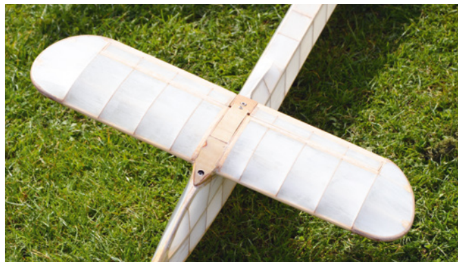
Die Ruder sind direkt mit dem Bespannvlies anscharniert
