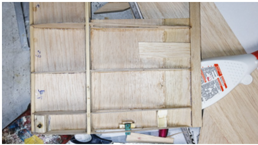
Die Tragflächenhälften wurden um jeweils zwei Rippenfelder erweitert, sodass sich die Spannweite um 200 Millimeter vergrößert
