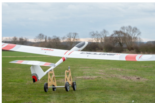
Mit dem Startwagen ist die Cyclone XT nach wenigen Metern sicher in der Luft
