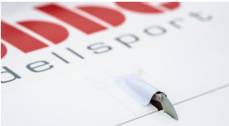
Aerodynamische Verkleidungen der Wölbklappenanlenkungen optimieren die Flugleistungen
