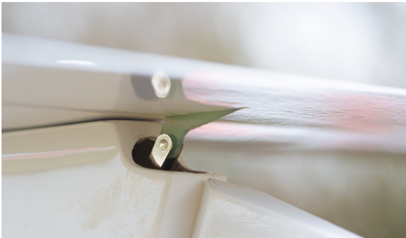
Das Höhenruder des T-Leitwerks wird zentral und fast unsichtbar angelenkt
