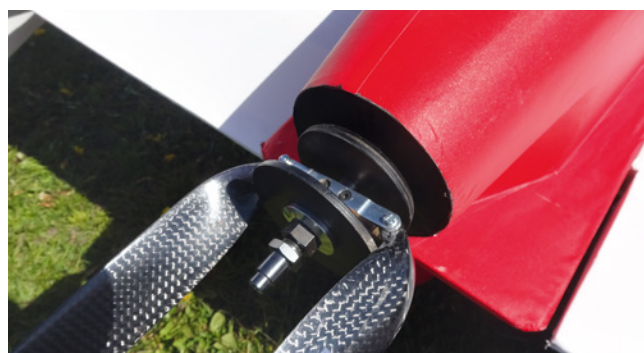
Zwei Holzscheiben – eine vor und eine hinter dem Propeller – sorgen dafür, dass die Luftschraubenblätter weder nach vorne noch nach hinten zu weit umschlagen können
