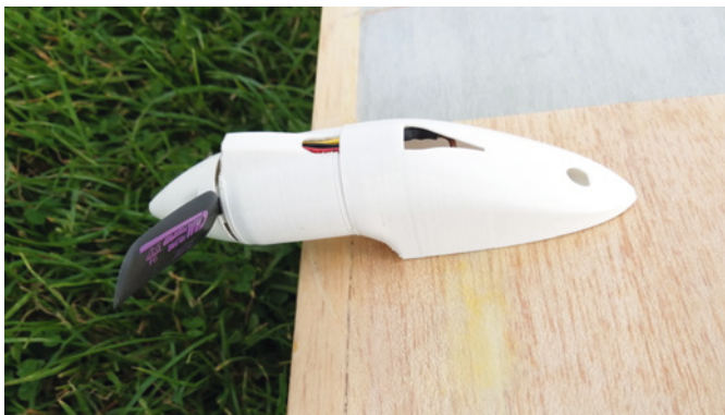
Die Motorgondeln stammen aus dem 3D-Drucker
