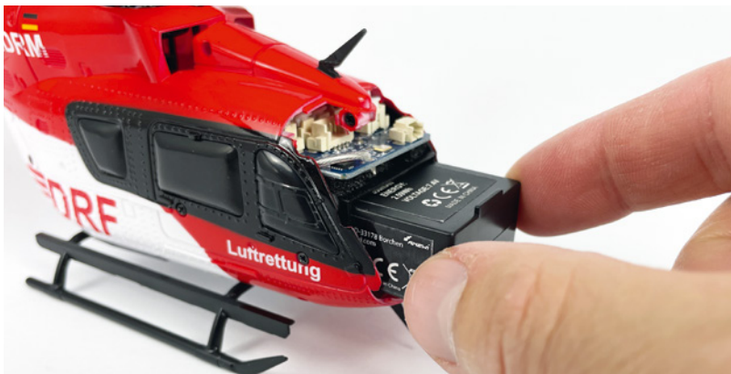
Der Akku wird nur eingeschoben und ist dann automatisch mit der Elektronik des Helis verbunden
