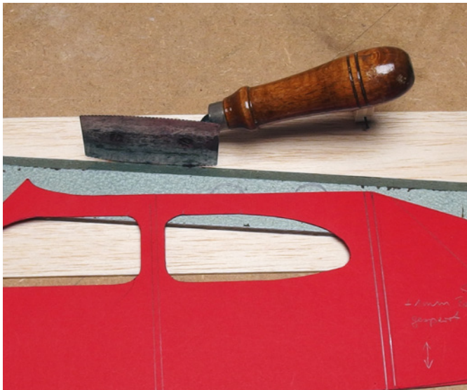
Bei Schnitten schräg zur Faserrichtung besteht die Gefahr, dass das Holz ungewollt einreißt
