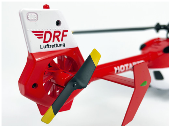
Der Fenestron ist zwar angedeutet, jedoch ist ein konventioneller Heckrotor verbaut
