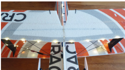
An der Nasenleiste wird die Lichterkette mit Stecknadeln befestigt
