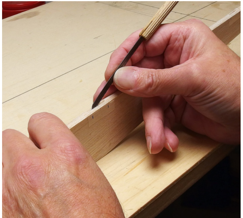
Die Schlitze werden durch sägende Bewegungen hergestellt
