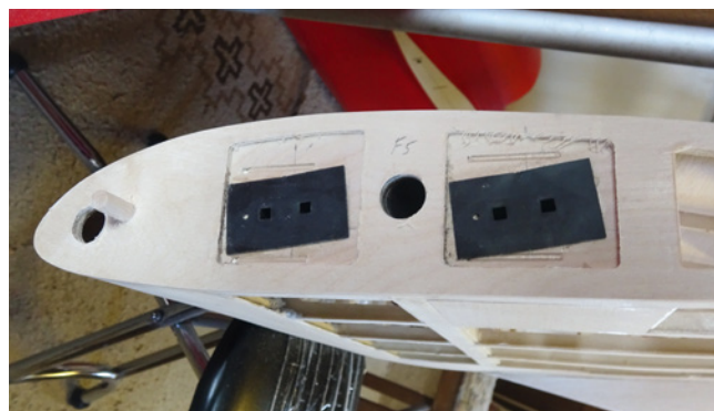
Leichtes Handling war oberstes Gebot beim Bau der Fauvel. Daher kommen die Wireless-Servo II-Verbinders zur Übertragung der Steuersignale an die Tragflächenservos zum Einsatz
