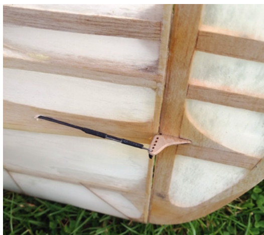
Das Seitenruder wird über ein CFK-Gestänge betätigt. Für die reine Seglervariante wäre es jedoch günstiger, das Servo vorne im Rumpf zu platzieren und Seile zur Anlenkung zu verwenden
