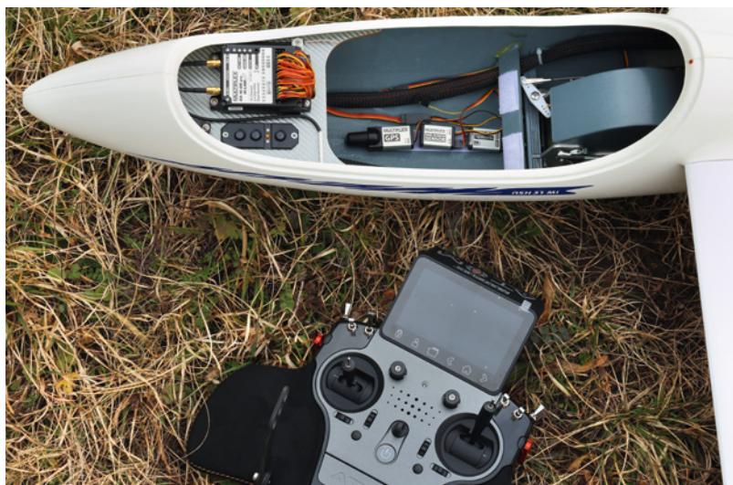
Mit der M-Link-Variante der Atom lassen sich die bestehenden Modelle mitsamt ihrem Empfänger und der eingebauten Sensoren einfach weiternutzen
