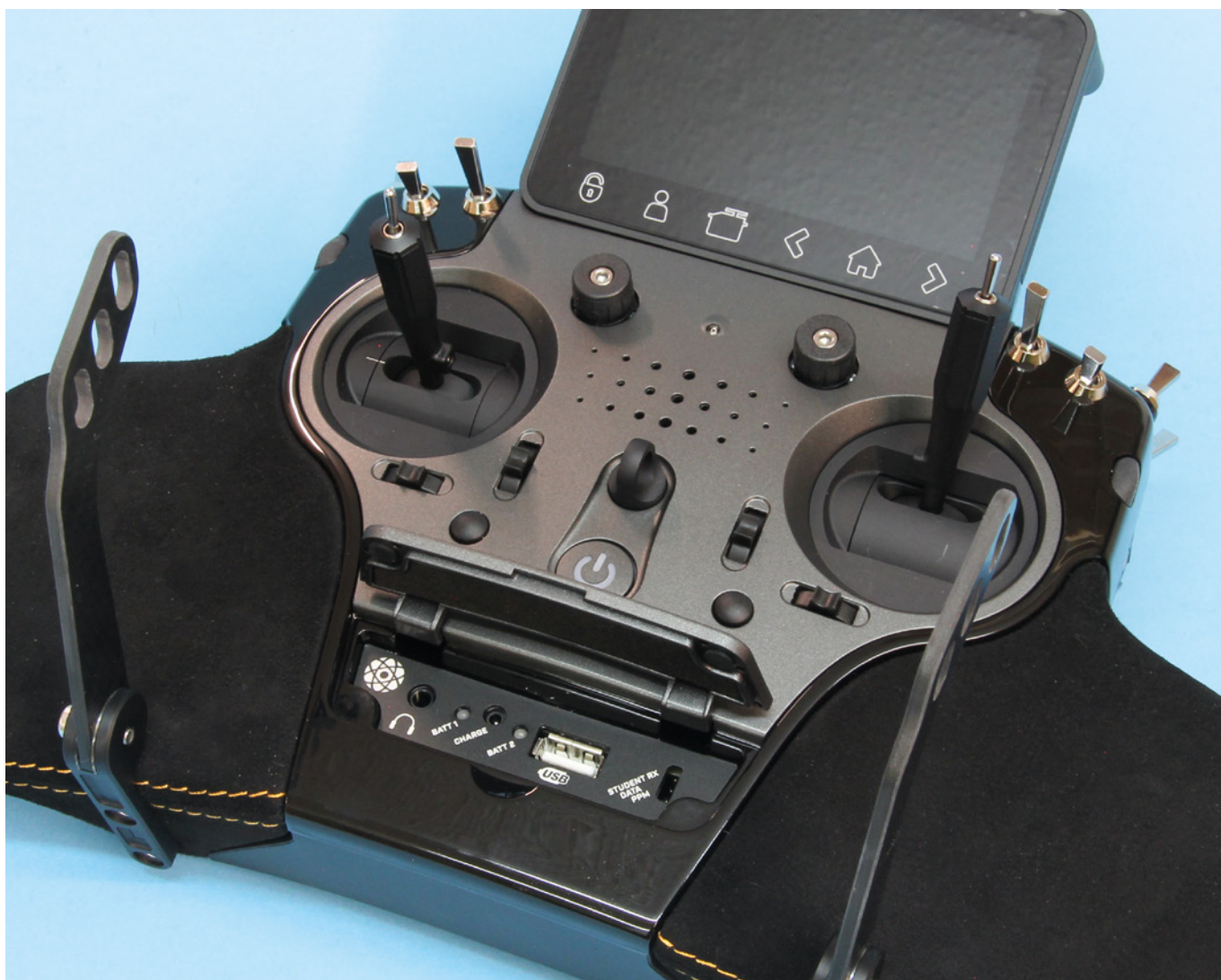
Hinter der Klappe befinden sich die Anschlüsse, um die Senderakkus zu laden, eine USB-Schnittstelle und ein Kopfhörerausgang. Am Servoanschluss lassen sich Telemetriedaten abgreifen oder ein Empfänger für den Lehrer-Schüler-Betrieb anschließen
