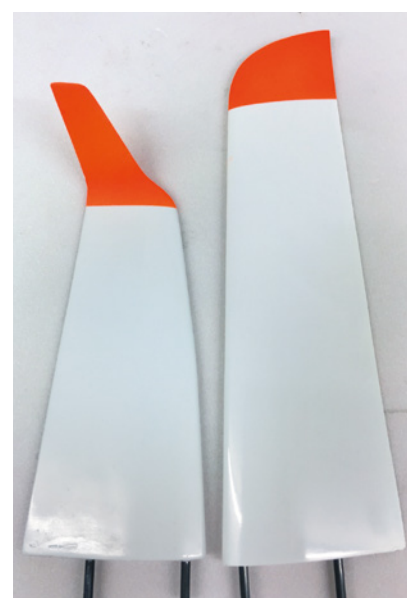
Die Flügelenden gibt es wahlweise mit leichtem und stark gebogenem Ende
