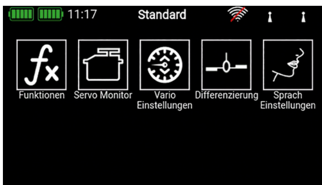
Über die Schnellauswahltasten kann man sich selbst ein Menü mit den wichtigsten Funktionen zusammenstellen
