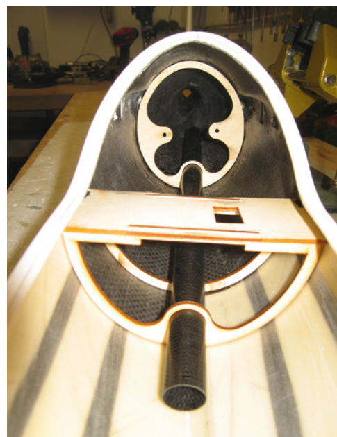
Die vorgefertigten Spanten passen sehr gut. Die Positionierung des Ballastrohres sowie dessen Verwendung bleibt leider dem Erbauer überlassen
