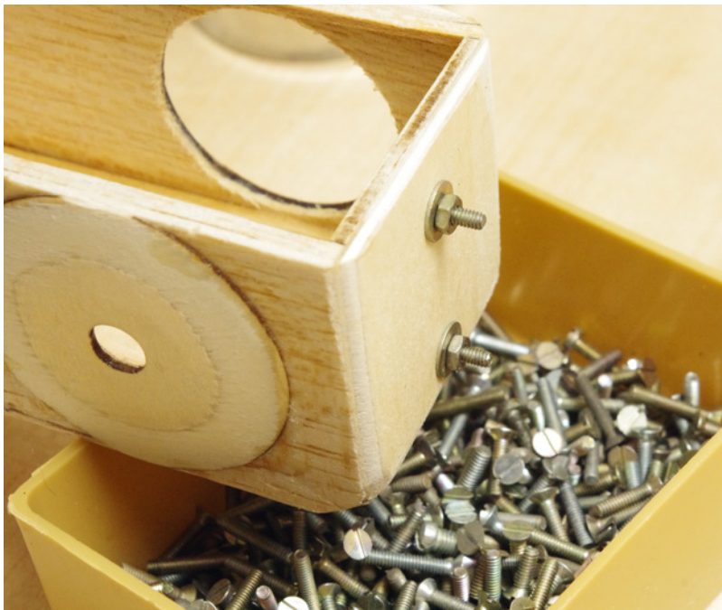
Epoxy fixiert das Gewinde der Schrauben für die Motorbefestigung im Spant
