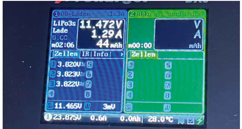
Während der Ladevorgangs können alle wichtigen Parameter überwacht werden
