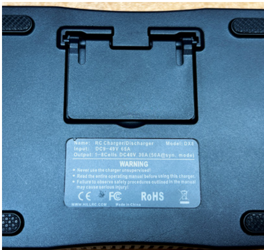
Ein Standfuß neigt das Gerät, sodass es auch bei Sonneneinstrahlung gut ablesbar bleibt
