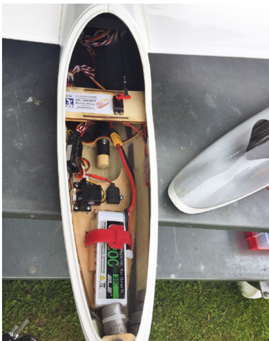
Das fertige Innenleben der DG-600. Das Servobrett für die Aufnahme des Flugakkus und des Servos für die Schleppkupplung sowie des Varios bleiben dem Erbauer überlassen. Beachtlich ist, dass etwa 320 Gramm Blei benötigt werden, um den angegebenen Schwerpunkt von 61 Millimeter zu erreichen
