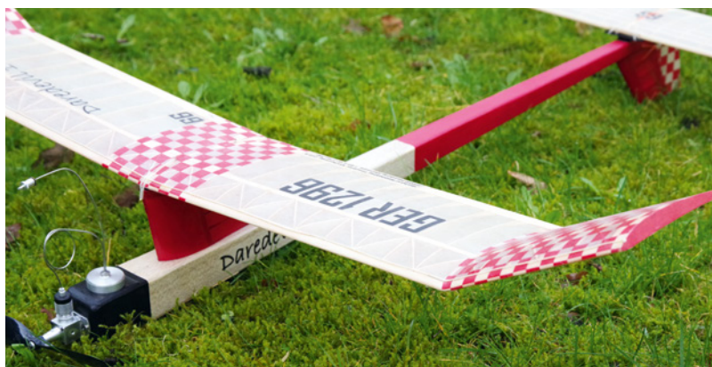
Das RC-Modell hat 900 Millimeter Spannweite, wiegt 155 Gramm und hat trotz seines schweren Motors eine Gesamtflächenbelastung von nur 10 Gramm pro Quadratdezimeter
