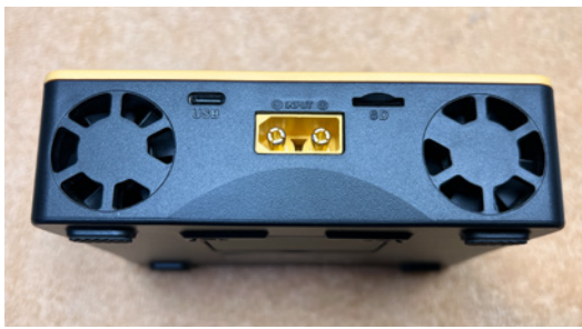
Über einen XT-90-Stecker lässt sich eine 9- bis 49-Volt-Gleichstromquelle anschließen
