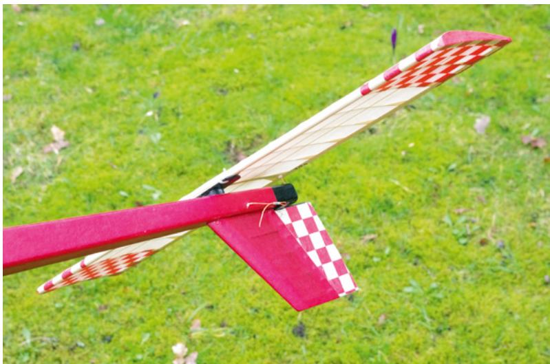
Das Seitenleitwerk liegt außerhalb der Wirbelschleppen von Flügel und Pylon
