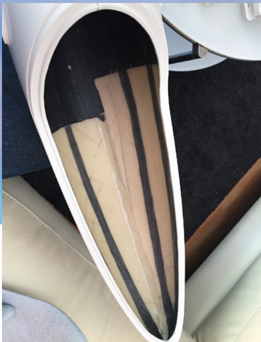
Die Kohlefaserverstärkung bis zur Rumpfspitze erhöht die Festigkeit in diesem Rumpfbereich deutlich
