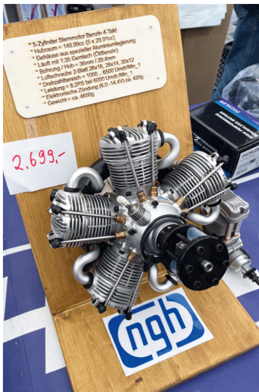
Pichler präsentierte einen neuen 150-Kubikzentimeter-Viertaktmotor mit fünf Zylindern
