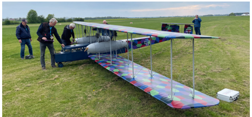
Das mit Abstand größte Modell der ProWing war die Zeppelin Staaken R.VI von Helmut Müller mit einer Spannweite von über 10 Metern und rund 130 Kilogramm Abfluggewicht
