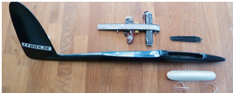
Der Rumpf, im Vordergrund die beschnittene Haube, im Hintergrund das aus dem Kabinenbereich herausgeschnittene Material, außerdem die Mittelrippe mit Akku und Empfänger
