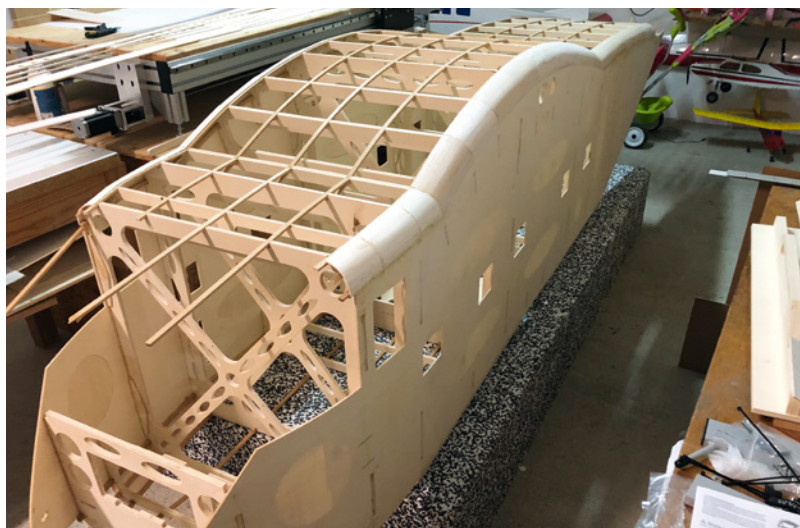
Eine Mischbauweise aus Pappelsper Holz, Hartholzleisten und Balsa sorgt für Stabilität
