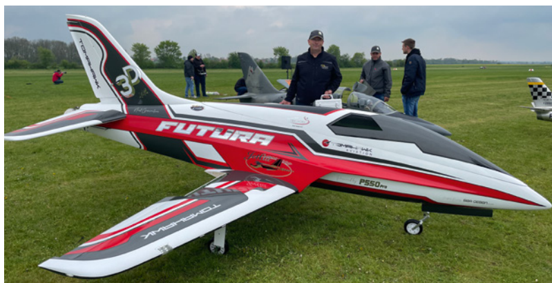
Marc Petrak flog diese Futura 3D XXL von Tomahawk Aviation vor. Der Jet hat eine Spannweite von 2.500 Millimeter und ein Abfluggewicht von nur 20 Kilogramm
