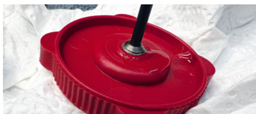
Wichtig beim Schneiden ist der Einsatz von Schneidöl. Das verlängert die Haltbarkeit des Werkzeugs erheblich
