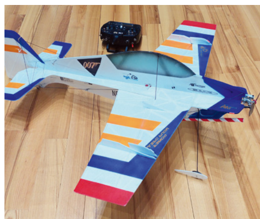
James Bond lässt grüßen beim neuen Modell von Derk van der Vecht (Niederlande). Das Rohr unter dem Rumpf wird mit farbigem Pulver gefüllt und sorgt bei Schubumkehr für „Pulverrauch“
