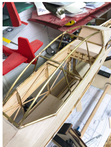
Der Rahmen der Kabinenhaube entstand auf einer Helling aus Messingrohren
