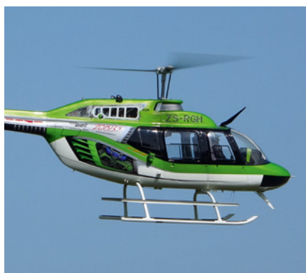
Roland Kaufmann aus der Schweiz zeigte unter anderem schöne Scaleflüge mit seinem großen Bell 206 Jet-Ranger. Das turbinengetriebene Modell hat einen Rotorkreis von 3.400 Millimeter und ein Abfluggewicht von 24,2 Kilogramm
