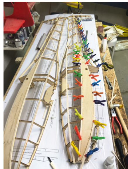
Die beiden Rumpfhälbschalen sind bald bereit zum Verkleben
