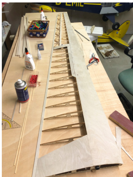
Ein Mix aus verschiedenen Holzarten sorgt für einen leichten und stabilen Aufbau
