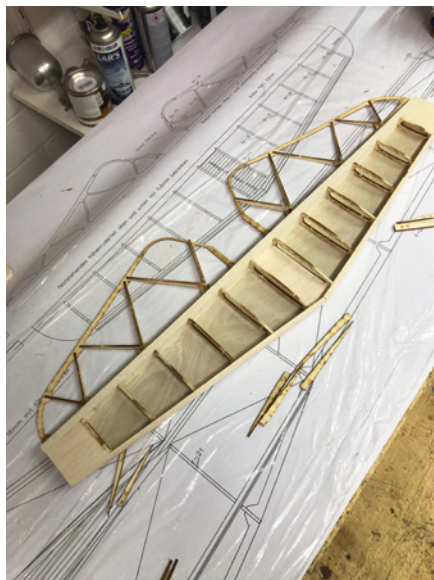
Die gelaserten Holzteile des Bausatzes passen saugend ohne Nacharbeit zueinander
