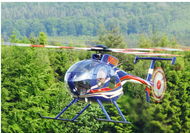
Die Hughes 500E von Witte-Helicopter ist komplett aus Kohlefaser gefertigt. Dadurch ist sie sehr leicht und stabil. Somit ist mit dieser Maschine auch Kunstflug möglich, was Heiko Fischer an diesem Wochenende eindrucksvoll unter Beweis stellte
