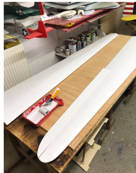
Der Lackauftrag erfolgte mit der Rolle. Das Ergebnis passt gut zum Retrolook des Seglers und ist erstaunlich leicht
