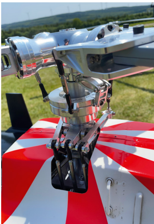
Detailbild des Scale-Rotorkopfes der Bo-105 von Helifactory. Der Rotorkopf und die Anlenkung sind vom Original kaum zu unterscheiden
