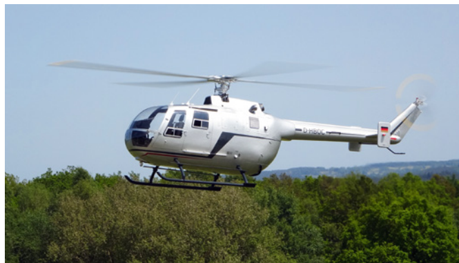
Aus dem Hause Helifactory kommt die Bo-105 von Matthias Tranziska. Das 24,8 Kilogramm schwere, turbinengetriebene Modell ist nicht nur optisch vorbildgetreu gebaut, sondern hat auch einen dem Original nachempfundenen Rotorkopf
