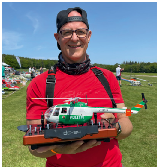
Das kleinste Modell bei den Helidays war die Bo-105 von Detlef Hoffmann. Der Rumpf der Bo ist im 3D-Druck entstanden und hat einen Maßstab von 1:28. Damit kommt das Modell auf eine Länge von 320 Millimeter. Die eingebaute Mechanik ist eine OMP1-Mechanik, der Vierblatt-Rotorkopf ist von Rakonheli. Mit einem Rotorkreis von 280 Millimeter wiegt der kleine gerade einmal 160 Gramm
