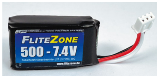
Ein kleiner 2s-LiPo versorgt das Modell mit Strom
