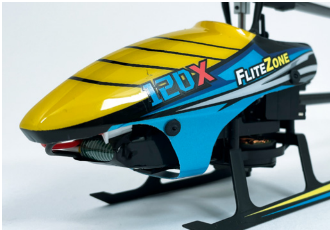
Dank des mauartigen Ausschnitts in der Kabinenhaube lässt sich der Akku ganz einfach wechseln
