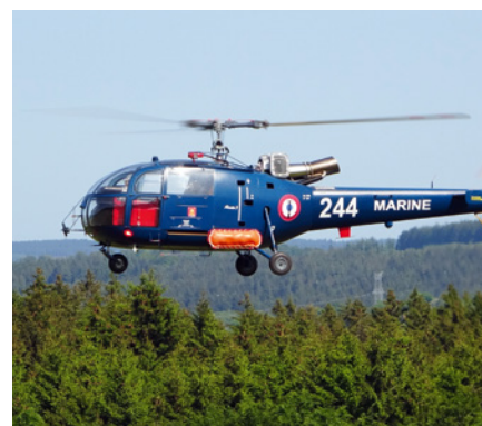
Hier zu sehen ist die Aérospatiale SA 319B Alouette III der französischen Marine von Thierry Waymel aus Frankreich mit einem Rotorkreis von 2.450 Millimeter und einem Gewicht von 24 Kilogramm. Angetrieben wird das Modell von einer Jakadofsky-Pro-5000-Turbine
