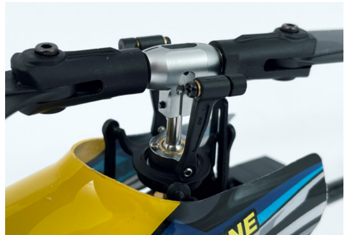
Der Flybarless-Rotorkopf verfügt über ein Alu-Zentralstück
