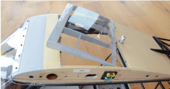
Das Flächenmittelstück inklusive Frontscheibe und herausnehmbarem Deckel für den Zugang zur Flächenarretierung
