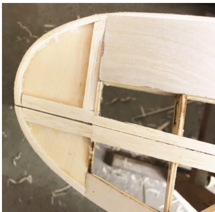
Weiches Balsaholz am Randbogen erlaubt sauberes Verschleifen
