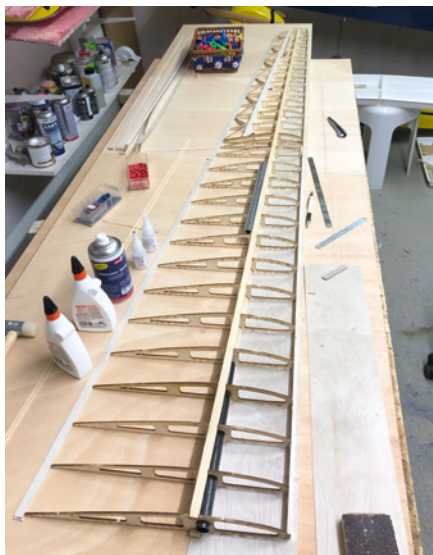
Im Holmbereich kommen geschäftete Kiefernleisten zum Einsatz
