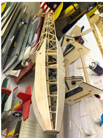
Der Rumpf in Gitterbauweise ist in einigen Bereichen beplankt
