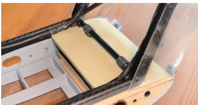
Übergang vom CFK-Rahmen auf das Flächenmittelstück. Viele Klebestellen helfen, eine gute und sichere Kraftübertragung zu erhalten
