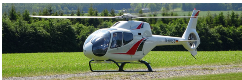
Matthias Tranziska zeigte neben der Bo-105 auch seine Airbus H120. Ausgestattet mit einer Jakadofsky Pro 5000 hat der Heli einen Rotorkreis von 2.500 Millimeter und ein Gewicht von 23,2 Kilogramm
