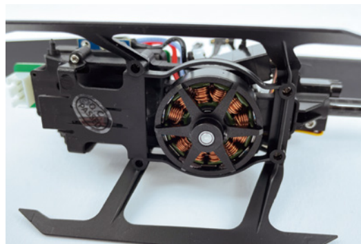
Die Besonderheit am 120X ist der direkt angetriebene Hauptrotor
