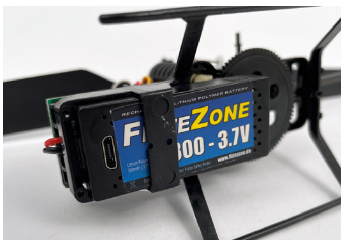
Der kleine LiPo-Akku reicht für bis zu 15 Minuten Flugzeit
