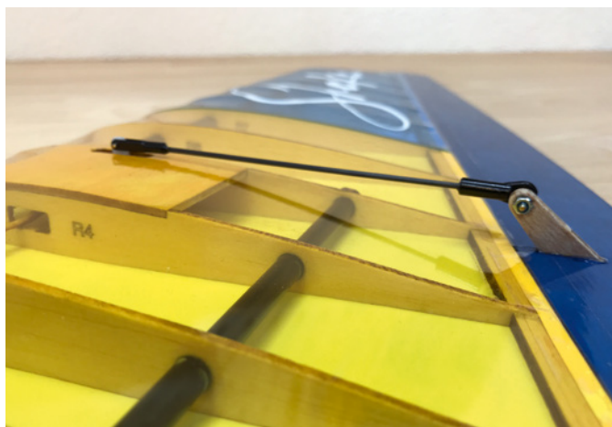
Viel Bewegungsfreiheit hat der Servohebel nicht, aber angesichts der benötigten, kleinen Ausschläge passt das
