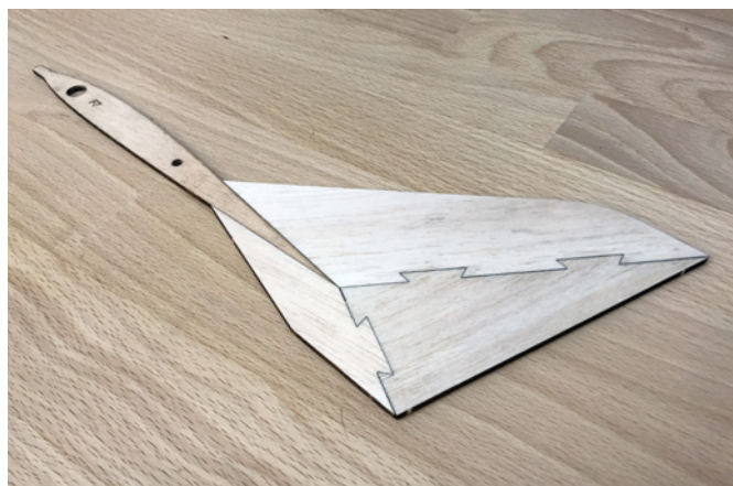
Wie ein kleines Puzzle setzt sich das Seitenleitwerk mit Mittelrippe zusammen
