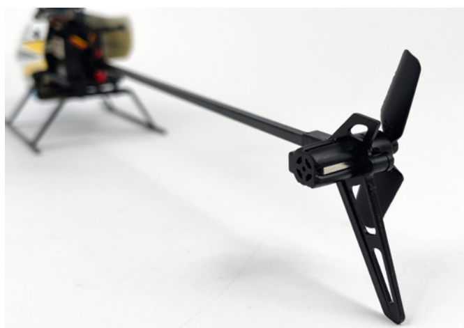
Der Heckrotor wird von einem eigenen Bürstenmotor angetrieben
