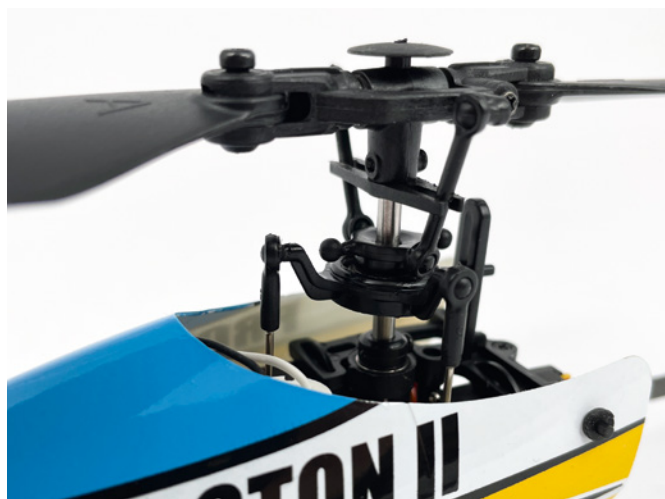
Die Taumelscheibe wird von zwei Servos mit 90-Grad-Versatz angesteuert
