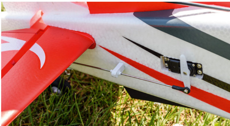
Eine kurze Balsaleiste, in die ein Stück Bowdenzugrohr geklebt ist, das Ganze weiß lackiert und fertig ist die Stütze für das Höhenrudergestänge. So kann sich der Steuerdraht bei Belastung nicht mehr durchbiegen
