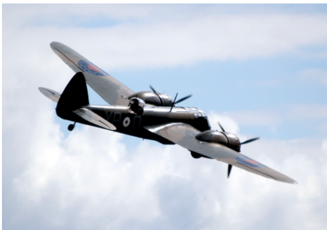
Dieser Bristol Blenheim Bomber verfügt über zwei wuchtige 840-PS-Mercury-Motoren
