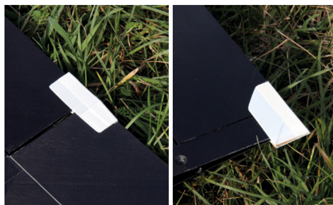
Kleine Plättchen aus ABS, die von hinten über die Endleisten aufgeschoben werden, schützen die Ecken bei Transport und Handling
