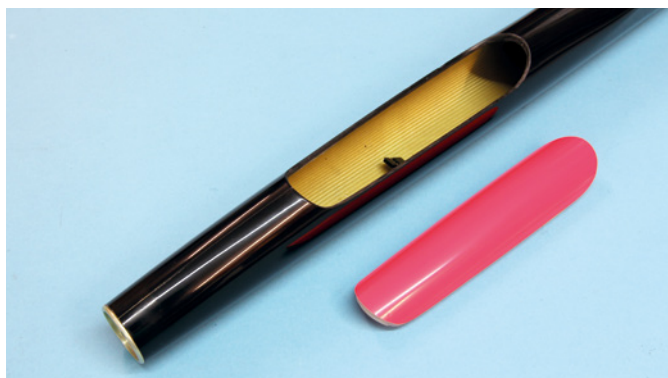
Der Rumpf besteht im vorderen Bereich aus Kevlar, daher dürfen die Empfangsantennen im Rumpffinnern verbleiben. Die Haubenöffnung ist recht großzügig, was den RC-Einbau vereinfacht
