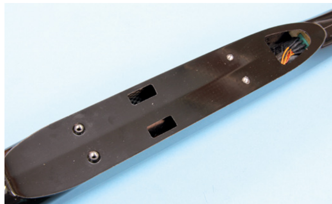
Der Flügel zentriert sich über kleine Erhöhungen im Bereich der Schraubengewinde. Ebenfalls gut zu sehen sind die Durchbrüche für die Servosteckverbinder zum Hauptflügel. Im hinteren Ausschnitt zeigt sich der Kabelschwanz für die Leitwerksservos
