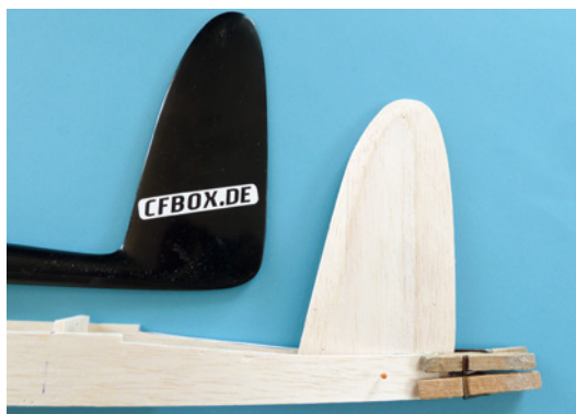
Das Seitenleitwerk wird ins Heck geklebt
