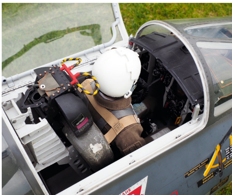
Ein echtes Highlight war dieser F-104 G Starfighter im Maßstab 1:4 von Heiko Höft. Das Modell wiegt knapp unter 25 Kilogramm und wird von einer Frank-Turbine FT-250 mit 25 Kilogramm Schub angetrieben
