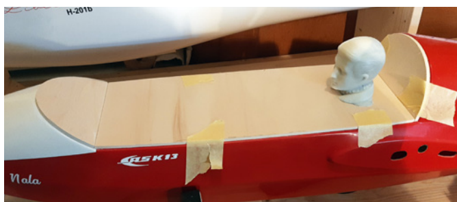
Das Cockpit besteht aus drei Sperrholzteilen, welche passend auf dem Rumpf zusammengeklebt werden
