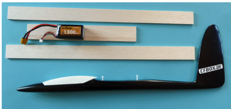
Der Original-Rumpf mit den Seitenteilen und dem Boden des neuen Rumpfs. Die Maße des Akkus sind für die Größe des neuen Rumpfs maßgebend
