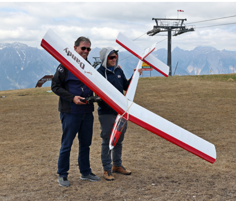
Ein „Traum vom Dandy“ mit 2.600 Millimeter Spannweite und rund 2.200 Gramm Gewicht zeigten Walter Grupp (links) und Jeremias Hartmann. Das ARF-Modell wird über Seiten- und Höhenruder, zwei Bremsklappen und Motor gesteuert
