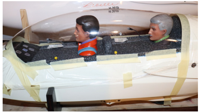
In einem der letzten Arbeitsschritte wurde die Haube genau angepasst und mit Uhu Por mit dem Haubenrahmen verklebt
