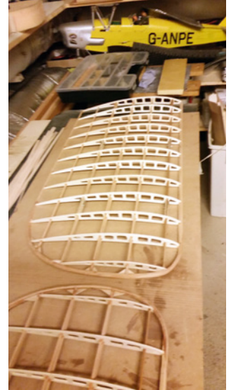
Die Tragflächen entstanden in klassischer Rippenbauweise
