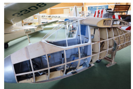
Der modifizierte Rumpf der Lo 100 erlaubt einen Einblick in das Innenleben der Konstruktion
