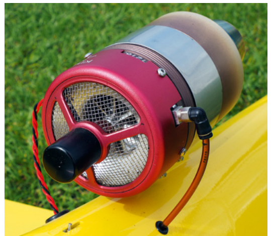
Marco Conde präsentierte seinen Fox mit einer Spannweite von 4.250 Millimetern, angetrieben von einer KingTech-Turbine K-85 mit 9 Kilogramm Schub
