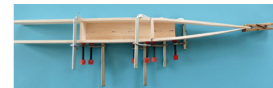
Die Seitenteile werden an einen Abschnitt des Rumpfbodens geklebt
