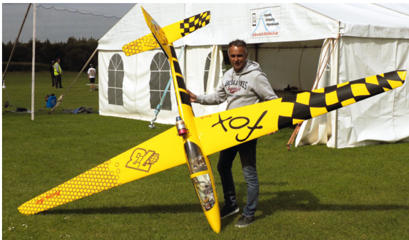
Marco Conde präsentierte seinen Fox mit einer Spannweite von 4.250 Millimetern, angetrieben von einer KingTech-Turbine K-85 mit 9 Kilogramm Schub
