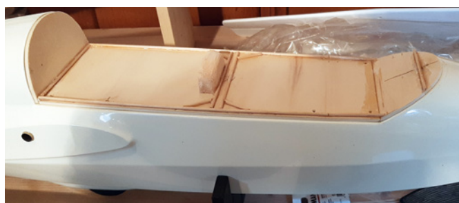
Aus dünnen Rundhölzchen ist der Gitterrahmen der ASK-13 nachempfunden. Die Hölzchen werden einfach mit Sekundenkleber befestigt
