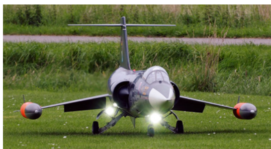
Ein echtes Highlight war dieser F-104 G Starfighter im Maßstab 1:4 von Heiko Höft. Das Modell wiegt knapp unter 25 Kilogramm und wird von einer Frank-Turbine FT-250 mit 25 Kilogramm Schub angetrieben
