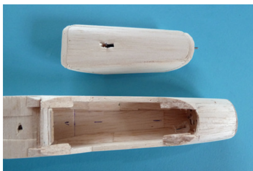
Die fertige Kabinenhaube neben dem Ausschnitt im Rumpf
