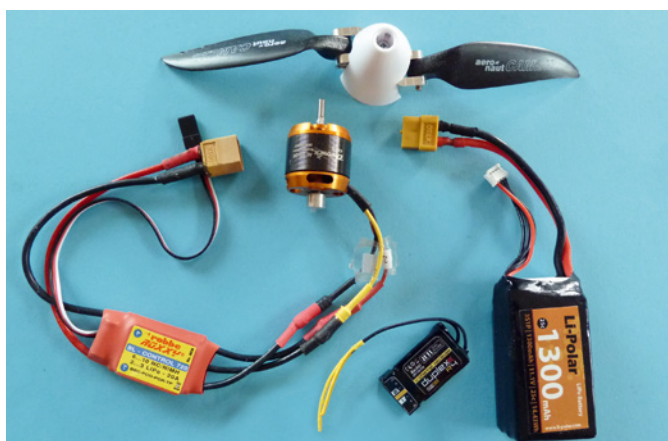
Der Antrieb des E-Kaskara: Motor D-Power AL 28/09, Turbospinner und 8 x 7-Zoll-Klappluftschaube von aero-naut, Regler robbe Roxy 720 und Empfänger Jeti R4
