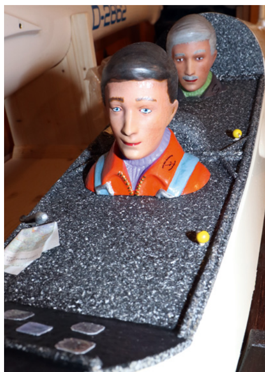
Alle Teile wurden mit Uhu Por oder mit 5-Minuten-Epoxy befestigt. Die Pilotenköpfe mussten zusätzlich mit einer Schraube gesichert werden
