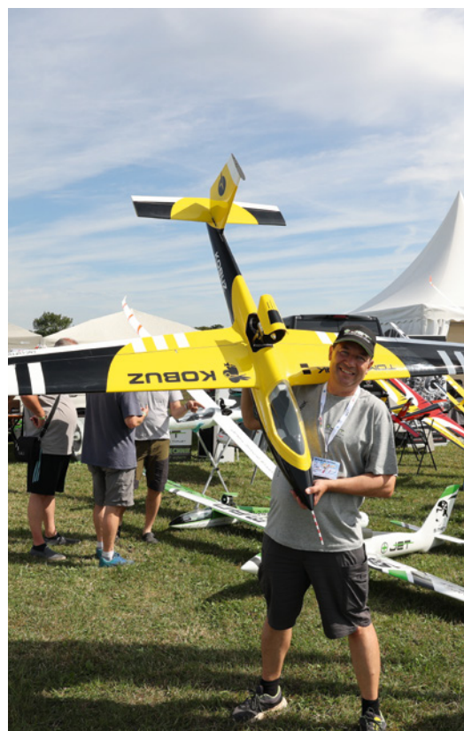
CNC-Luftsporttechnik – hier Teampilot Steve Streff mit seinem Tomahawk Kobuz 3.2 +JET 90 an 12s – Fluggewicht zirka 8 Kilogramm, Schub 6,5 Kilogramm. Neu im Programm bei CNC-Luftsporttechnik sind die Modelle Duo Discus – 4.440 Millimeter Spannweite (mit Winglets 4.620 Millimeter), ab 6,7 Kilogramm Gewicht – von Tomahawk und die Foka 4 – 3.750 Millimeter Spannweite, ab rund 5,5 Kilogramm – von Airworld, beide mit +JET 90 Antrieb für 6s- bis 12s-LiPos geeignet
