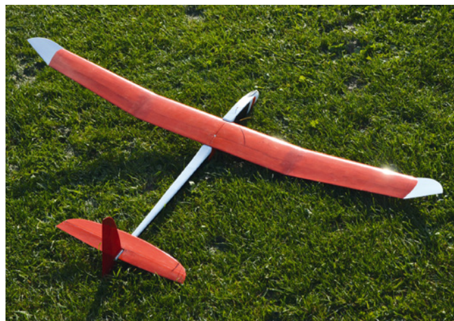
Serienmäßig hat der Innovation einen kürzeren Flügel mit doppelter V-Form und ohne Querruder
