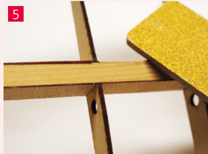
Abschleifen der Steg-Kanten
