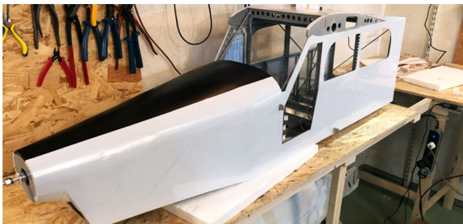
Der Rumpf erhält sein äußeres Aussehen durch Oracover-Folie
