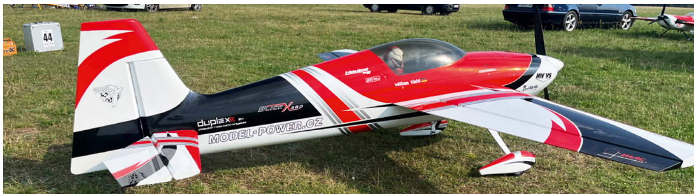
Ein klassisches IMAC-Modell: Nachbildung eines manntragenden Flugzeugs mit Pilotenpuppe und einer Spannweite von 3.000 Millimeter
