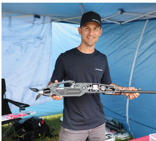
Gustavo Becker von Innovos zeigte den Flügelverwinder EXO 250 – Spannweite 2.500 Millimeter und Fluggewicht ab rund 2,6 Kilogramm. Gegenüber der Erstvorstellung im letzten Jahr auf der Segelflugmesse sind einige Details weiter verbessert worden. Es ist immer noch ein sehr innovatives Konzept in revolutionärer Bauweise. Ein „Versprechen“ ist es, dass der EXO 250 in weniger als 2 Minuten auf dem Flugplatz einsatzbereit sein soll
