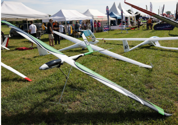
Die kürzlich vorgestellte Streamline V400 macht einen imposanten Eindruck: ARF+, 4.000 Millimeter Spannweite, ab rund 5.300 Gramm Gewicht, für 6s-LiPos mit verbautem 310-kv-Motor
