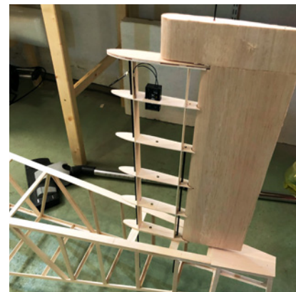
Im Seitenleitwerk ist einer von zwei Satellitenempfängern untergebracht, um einen optimalen Empfang sicherzustellen
