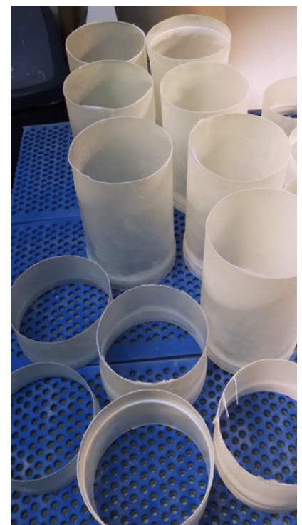
Die Triebwerks-Einlaufrohre und die Schubdüsen nach dem Entformen
