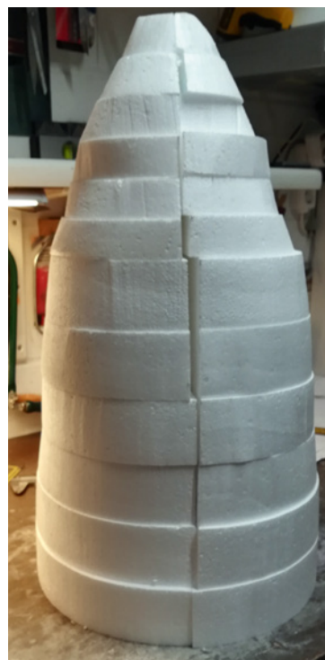
Das Urmodell vom Rumpfbug entsteht aus 24 Scheiben
