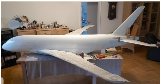
EWD-Vermessung am rohbaufertigen Modell. Hier werden die Dimensionen deutlich
