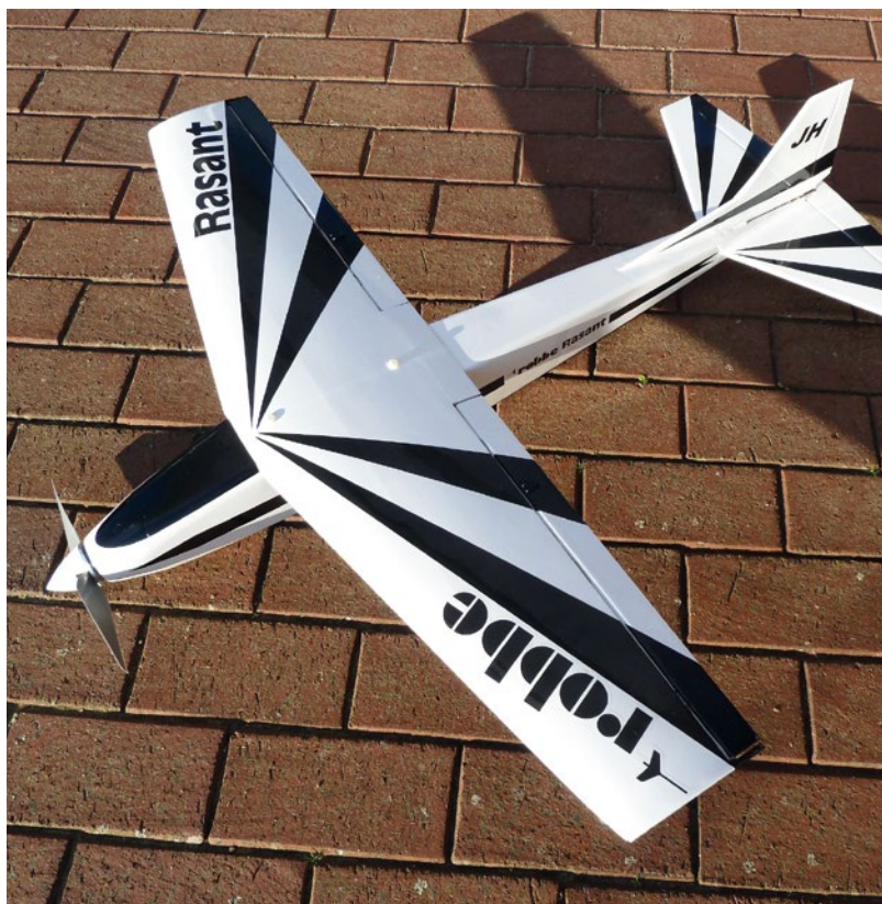
Der fertige Rasant ist bereit für den Erstflug. Das Blockstreifenmuster auf der Unterseite sorgt für eine gute Lageerkennung im Flug
