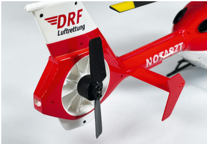
Der Heckrotor verfügt über einen eigenen Brushlessmotor
