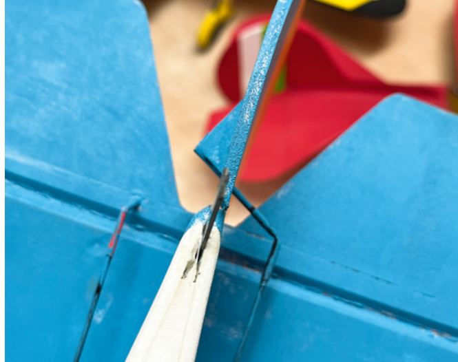
Die Ruderanlenkungen bestehen aus CFK-Stäben und Schrumpfschlauch
