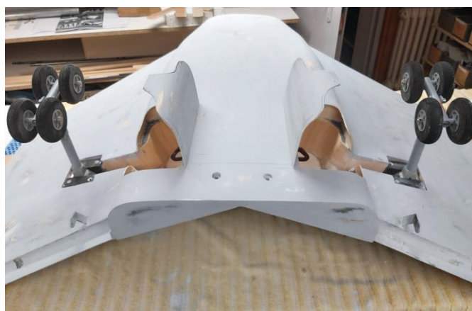
Das Flächenmittelteil mit Fahrwerk vor dem Lackieren
