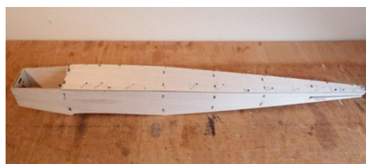
Die Unterseite des Rumpfs wird beplankt
