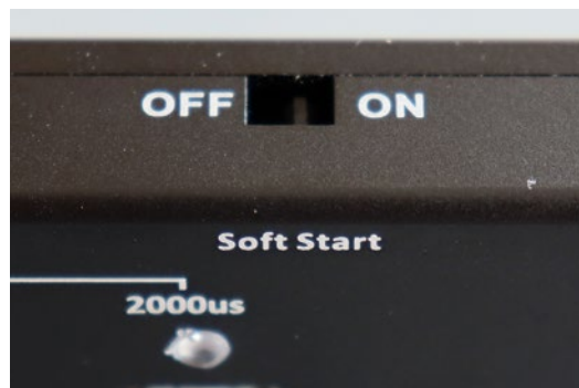
Mit dem On-Off-Schalter kann der Softanlauf am Servo aktiviert oder deaktiviert werden
