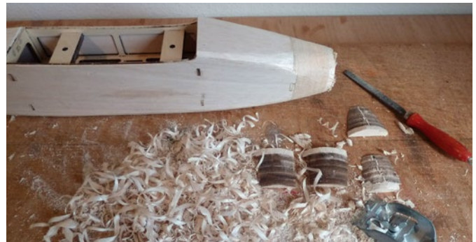
Balsahobel und Raspel treten in Aktion und formen den Rumpf sowie die Motorverkleidung
