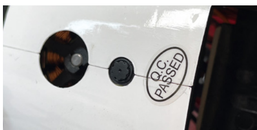
Der optische Höhensensor erlaubt ein präzises Halten der Höhe
