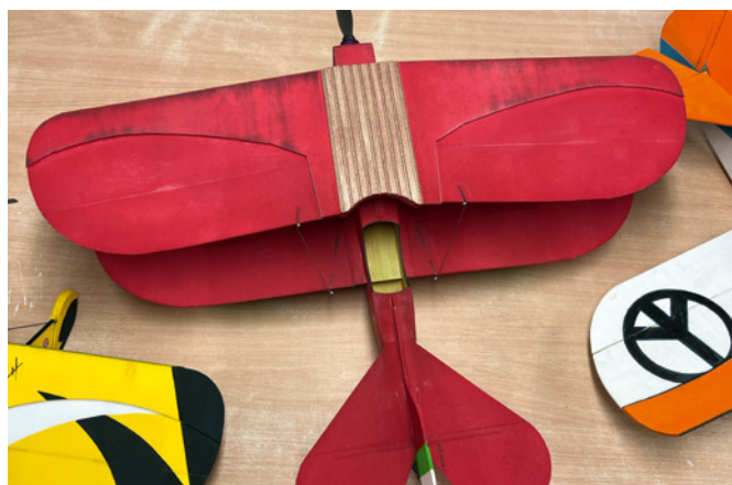
Wer den JUMP-Racer als Doppeldecker baut, erhält aufgrund der geringeren Flächenbelastung ein noch gutmütigeres Modell
