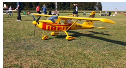
Die Symphony von RC-Flight-Academy in 1:3,2 mit 3.400 Millimeter Spannweite. Angetrieben von einem Hacker Q100I mit 14s2p-LiPo mit 10.000 Milliamperestunden Kapazität
