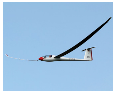
Theo Arnold mit FW-Modells zeigte die Nimbus 4 mit 8.800 Millimeter Spannweite im Fluglot. Hier ist schön die Flexibilität der Tragflächen zu sehen
