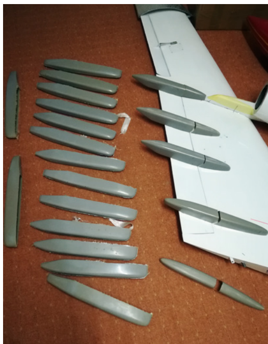
Flap-Track-Fearings zur Abdeckung der Landeklappen-Scharniere
