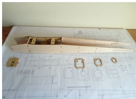
Nachdem die ersten Bauteile verklebt sind, werden die noch fehlenden Spanten eingeklebt
