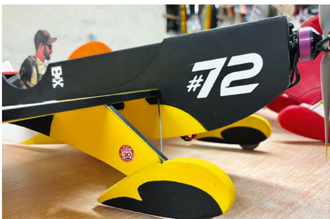
Wird der JUMP-Racer aus Flexifoam gebaut, lässt er sich mit praktisch allen gängigen Farben und Lacken gestalten
