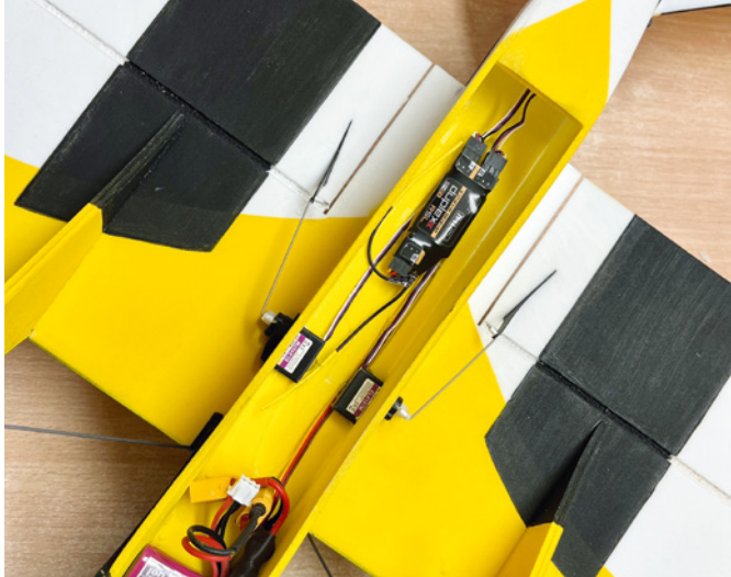
Die Servos können einfach an passender Stelle in entsprechende Öffnungen in den Rumpf gesteckt werden
