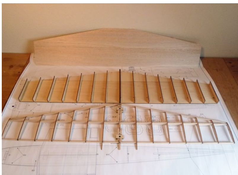
Die Helling, das Rippen-Holmgerüst und die untere Beplankung liegen bereit
