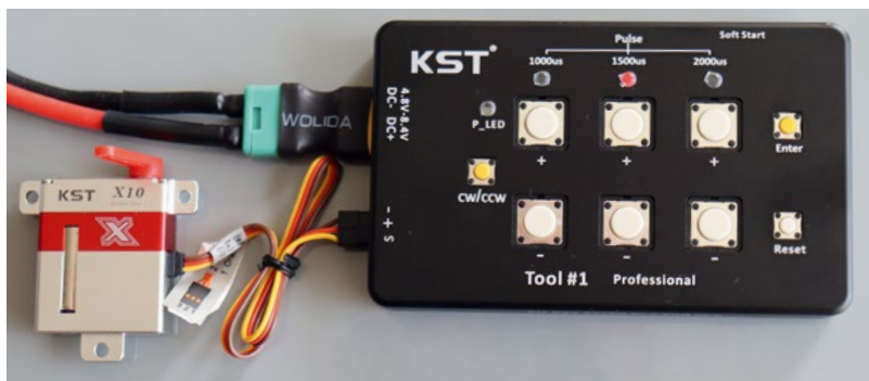
An der linken Seite des KST-Tool 1 finden sich der T60-Stecker für die Stromversorgung und zwei Anschlüsse für die zu programmierenden Servos
