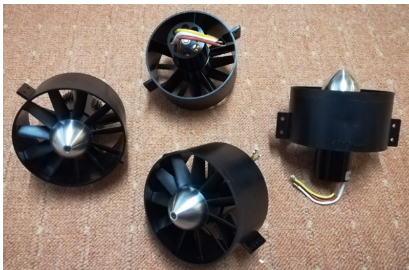
So werden die Midi Fan 100 evo mit eingebauten Motoren und ausgewuchteten Fans von WeMoTec geliefert
