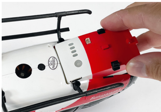
Der Akku wird von unten in den Heli eingesetzt
