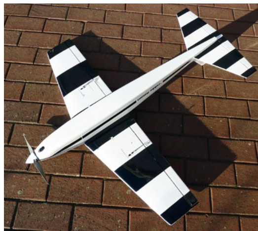
Der fertige Rasant ist bereit für den Erstflug. Das Blockstreifenmuster auf der Unterseite sorgt für eine gute Lageerkennung im Flug
