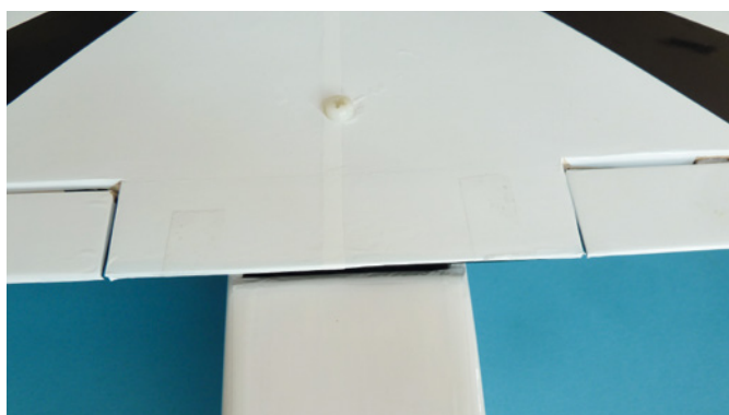
Aufgrund der Korrektur der EWD steht die Endleiste der Tragfläche ein wenig über
