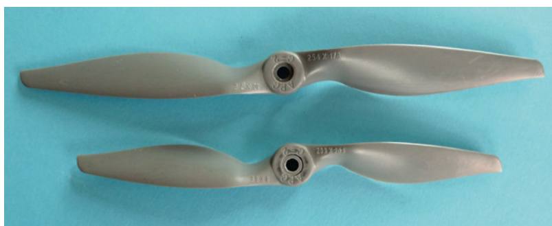
Bei Verwendung des 4s-Akkus wurde die 10 x 7-Zoll-Luftschraube durch eine 8 x 8-Zoll-Variante ersetzt
