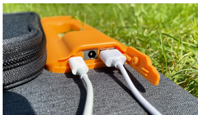
Das Wonder Solarpanel hat drei Ausgänge: einen Hohlsteckeranschluss zum Laden der Powerstation und zwei USB-Ports
