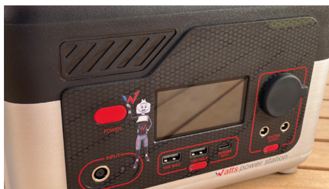
Die Powerstation verfügt über zahlreiche Anschlüsse auf der Vorderseite, mit denen sich Smartphones, Kameras aber natürlich auch Modellbau-Ladegeräte betreiben lassen
