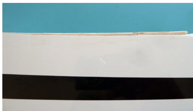
Zur Verringerung der EWD wurde die Flächenauflage mit Balsa etwas erhöht, hier zunächst 3 Millimeter
