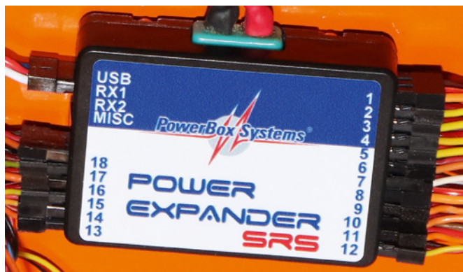
Der Power Expander SRS bietet Anschlüsse für 18 Servos und zwei Empfänger
