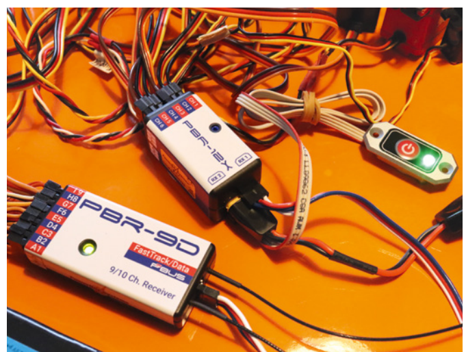
Der Anschluss des PBR-12X erfolgt über den P 2 Bus und eine separate Stromversorgung (Akku oder Akkuweiche). Der Ein-aus-Schalter gehört mit zum Lieferumfang
