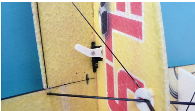
Das Querruderservo wurde an seinem Arbeitsplatz im Rumpf befestigt
