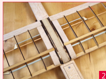
18 Millimeter Paulownia als Kern ist mit den Seiten aus 2 Millimeter Lindensperrholz und den Anschlussrippen verleimt. Das Sandwich wird am Tellerschleifer vorbereitet, bis es passt
