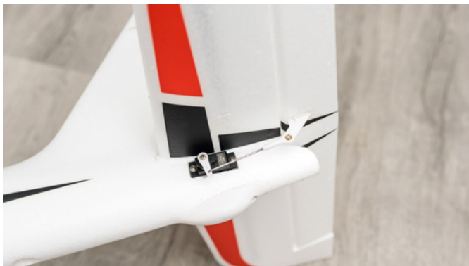
Die Servos verfügen alle über einstellbare Kugelkopf-Gestänge
