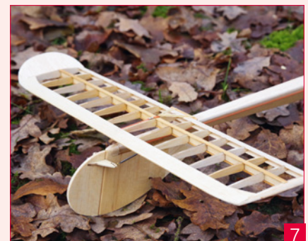
Das Pendelleitwerk dreht sich frei um den Anschlag an der Nasenleiste
