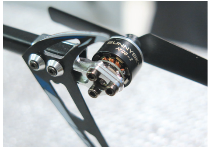
Am Heck arbeitet ein eigener kleiner Brushlessmotor. OMPHOBBY nennt das System Dual-Brushless-Direkt-Antrieb
