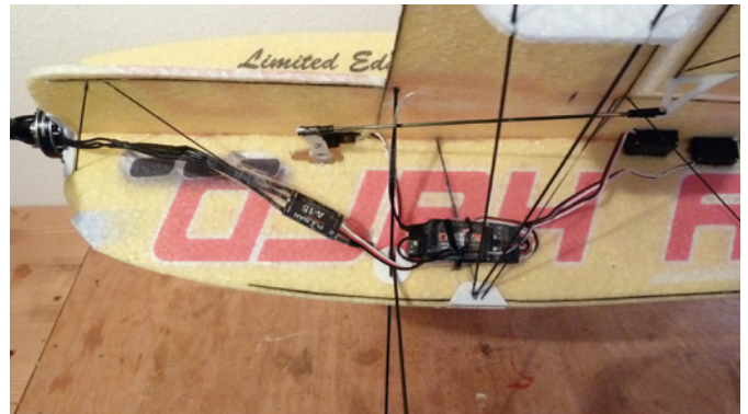
Regler und Empfänger wurden mit Tesa beziehungsweise einer Drahtschlinge seitlich am Rumpf befestigt
