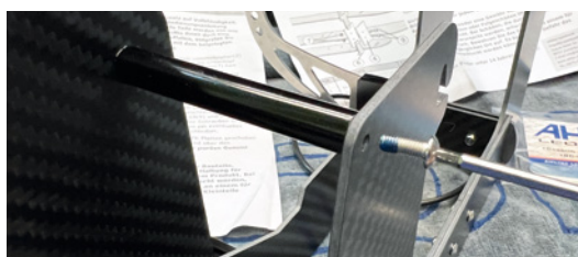
Empfehlenswert ist der Einsatz von Schraubensicherung, damit sich im Betrieb nichts lösen kann
