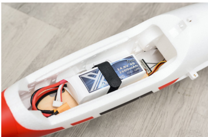
Mittig auf dem Akkubrett fixiert, passt der Schwerpunkt optimal
