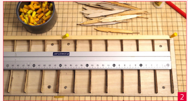
Die Helling ist mit einer zusätzlichen Kiefernleiste vor der Profilhase besser zu nutzen
