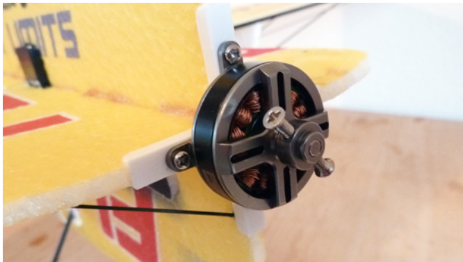
Mit vier Schrauben wird der Motor am Motorträger angeschraubt
