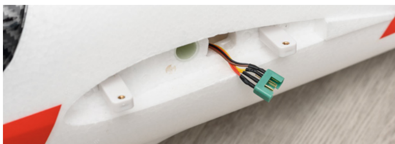
Ein grüner Multiplex-Stecker pro Tragfläche erleichtert das Auf- und Abrüsten auf dem Flugplatz. Aber vorsicht: Die Buchse rutscht gerne in den Rumpf
