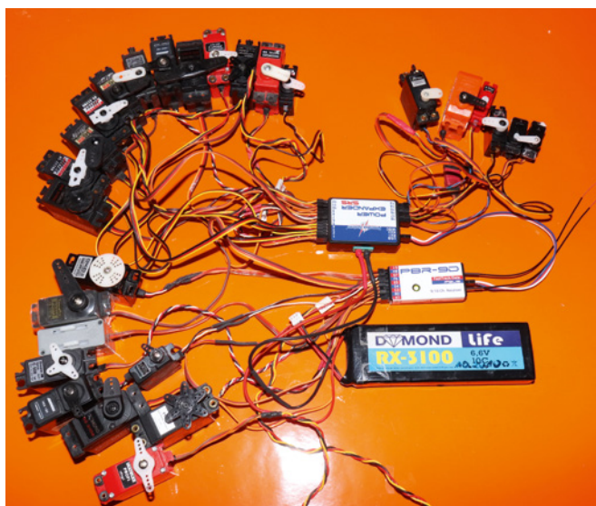
Der Power Expander SRS ist ein Kraftprotz, welcher einen Strom von 30 Ampere verträgt. Mit einem PBR-9D im Schleptau können 21 Servos angesteuert werden
