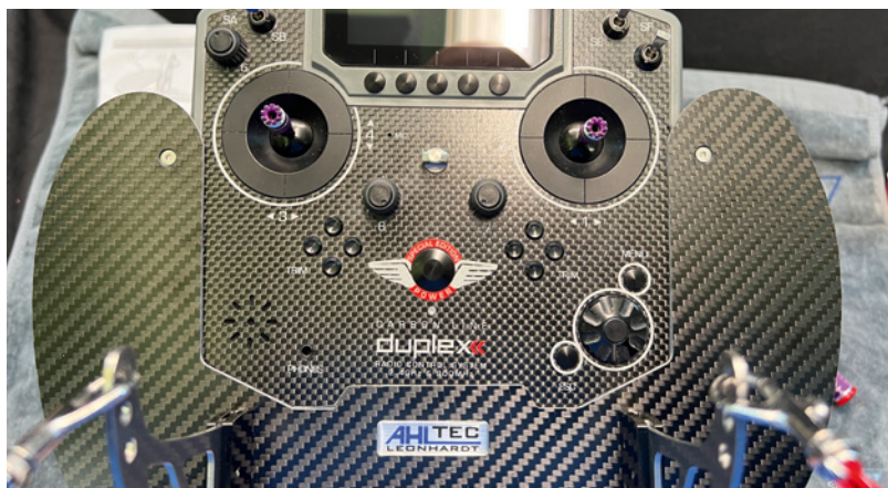
Einfach wie genial: Die Fernsteuerung wird einfach über einen Gummiring mit im Pult fixiert, was eine schnelle und einfache Demontage ermöglicht
