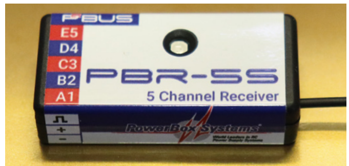
Klein und voll telemetriefähig zeigt sich der PBR-5S. Er kann tatsächlich 26 Kanäle über den P 2 Bus ansteuern
