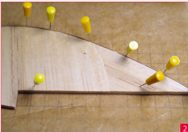
Dünnes Sperrholz schützt vor Kerben
