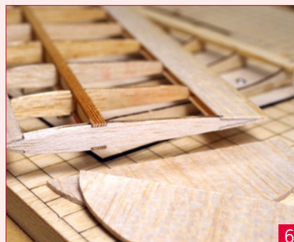
Randbögen aus 2 Millimeter Balsa werden angeschliffen und stumpf angeleimt
