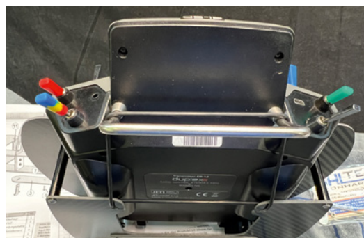
Einfach wie genial: Die Fernsteuerung wird einfach über einen Gummiring mit im Pult fixiert, was eine schnelle und einfache Demontage ermöglicht
