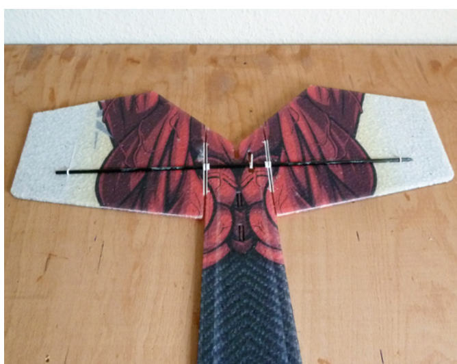
Das Höhenleitwerk wurde nun in den Rumpf eingebaut
