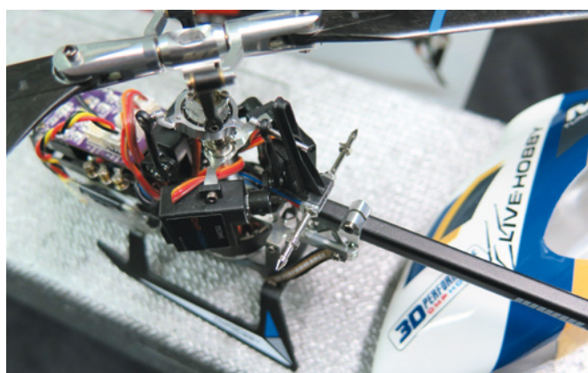
Die Aluminium-Taumelscheibe ist mit dem Aluminium-Flybarlesskopf verbunden. Die Steuerpräzision lässt keine Wünsche offen
