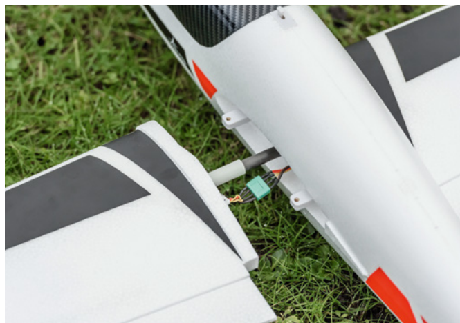
Die Tragflächenhälften werden auf den CFK-Verbinder geschoben, die elektrische Steckverbindung hergestellt und alles mit zwei Schrauben pro Seite von unten gesichert
