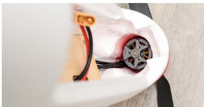
Der bürstenlose Außenläufer ist sauber verbaut und hat reichlich Kraft
