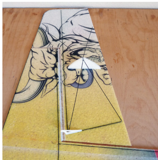
Die CFK-Stäbe zur Versteifung der Querruder wurden eingeklebt
