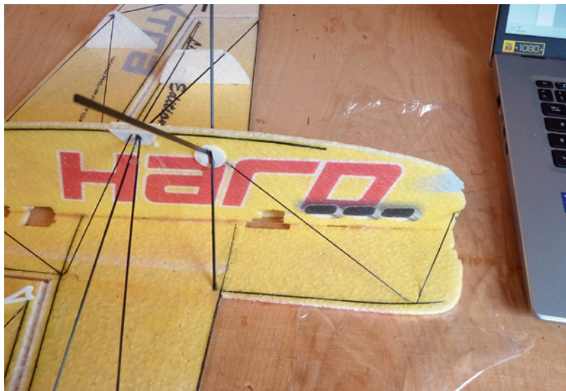
Die Halterung für das Fahrwerk und die Fahrwerksstreben wurden eingeklebt
