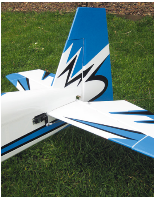
Kurze Anlenkungen und solide Stiftscharniere sorgen für präzise und langlebige Rudermechaniken
