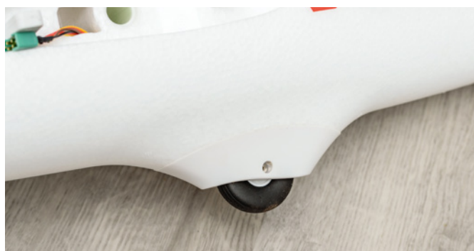
Praktisch ist das Rad, wodurch der Rumpf beim Landen kaum Gebrauchsspuren bekommt
