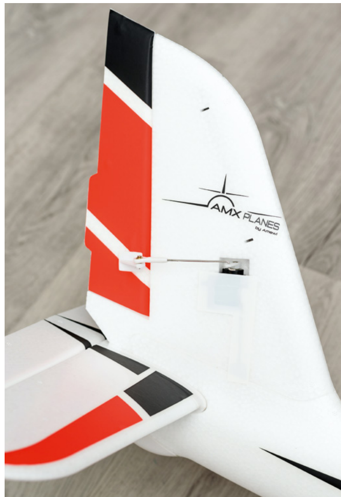
Die Leitwerksservos sind direkt im Rumpfheck platziert
