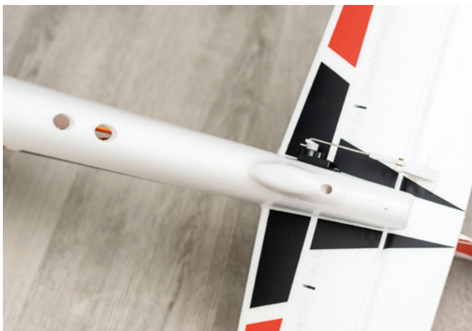
Der Swift ist eine ausgereifte Konstruktion. Das zeigen zum Beispiel Kühlluftaustritte im Heck und ein Kunststoff-Sporn, der das Hartschaummaterial schützt
