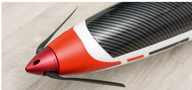
Die Propellerblätter klappen leider nicht ganz an. Das sieht etwas unschön aus, ist aber kein Beinbruch
