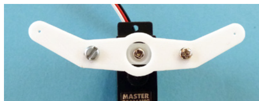
Die Verlängerung des Servoarms beim Querruder habe ich aufgeschraubt, anstatt zu kleben
