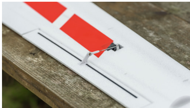
Die Querruder sind mit CFK-Profilen verstärkt
