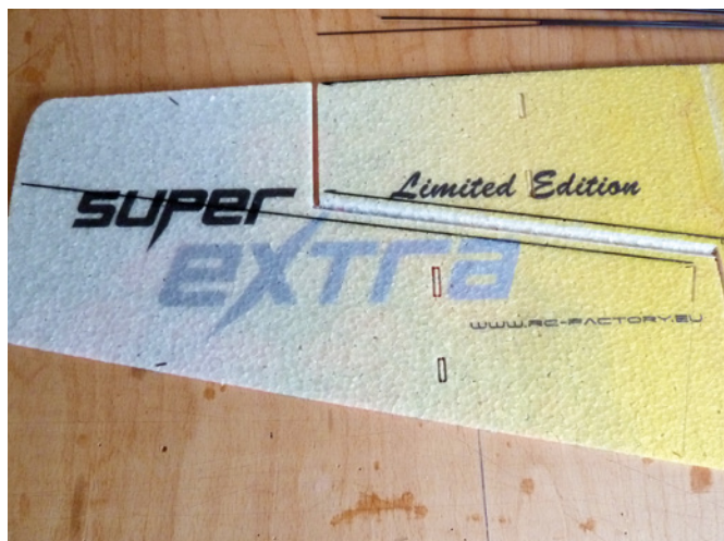
Auch die Querruder werden mit CFK-Flachprofilen versteift
