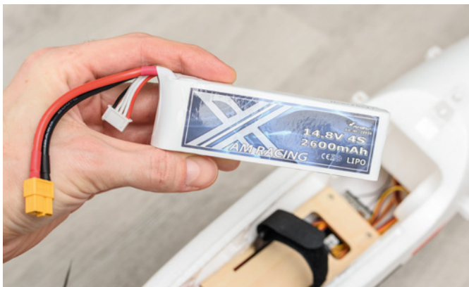
Der von Amewi empfohlene 4s-LiPo mit 2.600 Milliamperestunden Kapazität reicht für rund 10 Minuten Flugzeit, wenn man es richtig krachen lässt
