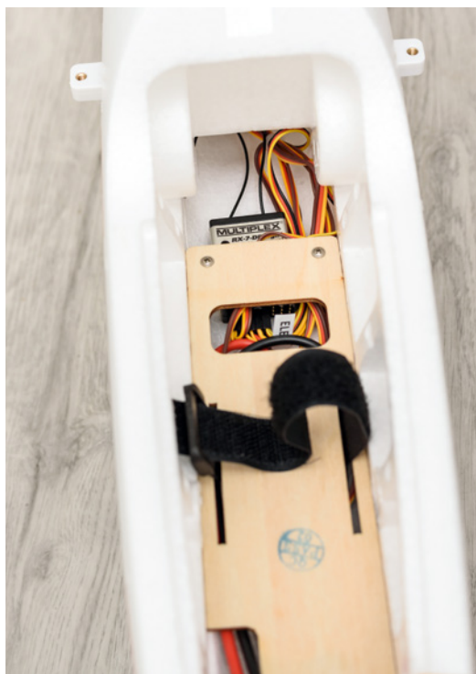
Unter der Kabinenhaube ist reichlich Platz, um den Akku unterzubringen. Der Empfänger lässt sich gut unter dem Akkubrett verstauen
