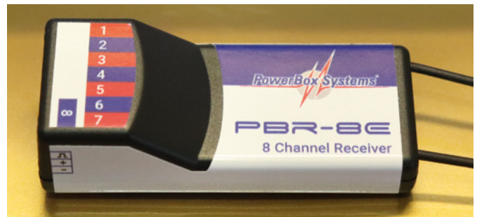
Der PBR-8E ist ein Achtkanal-Empfänger ohne Telemetriefunktion, aber mit zwei Sende- und Empfangseinheiten
