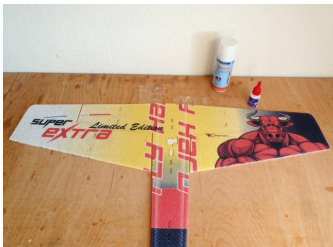
Die Flächen wurden an das Rumpf-Mittelstück geklebt
