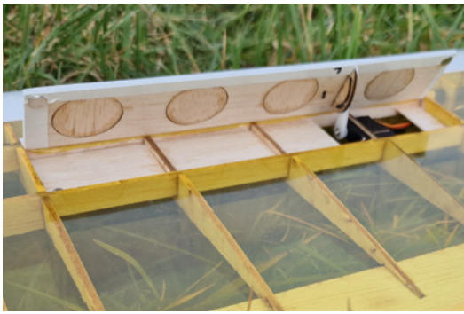
Auch bei der Anlenkung der Spoiler passen die DS06 von CHAServo perfekt
