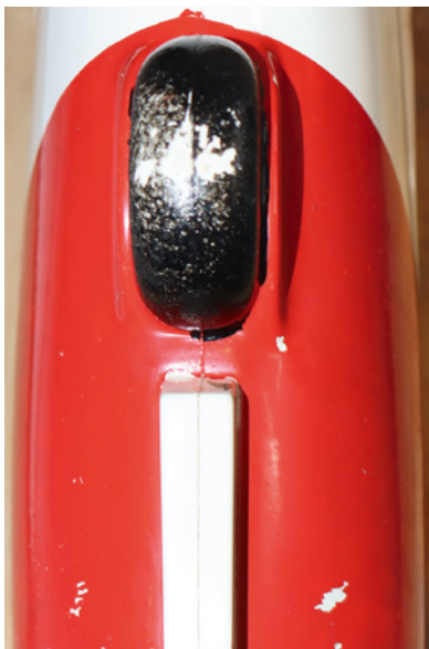
Der Rumpf war in der Form weiß lackiert und anschließend vom Ersterbauer mit roter Farbe überpinselt
