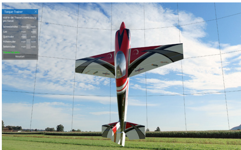
Der Torque-Trainer unterstützt einen beim Erlernen der Torque-Rolle. Hier wurde das Querruder manuell gesteuert, den Rest übernahm die Automatik. So können Schritt für Schritt weitere Steuerfunktionen hinzugenommen werden
