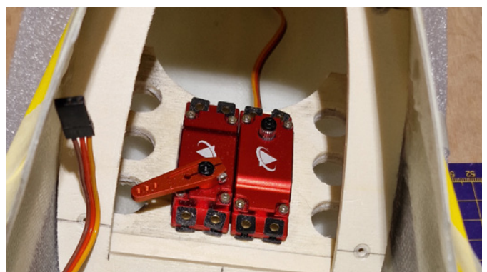
Die Servos im Kobuz-Rumpf finden hinter dem Klappimpeller Platz. Dank des vergleichsweise geringen Gewichts gibt es später keine Schwerpunktprobleme
