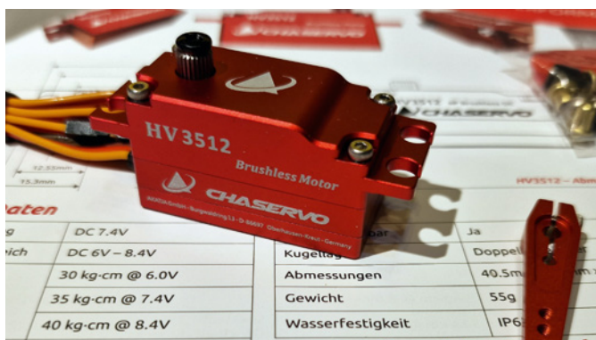
Beim CHAServo HV3512 handelt es sich um ein Low-Profile-Servo, was das Einsatzfeld deutlich erweitert
