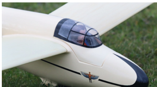
Die weibliche Pilotenbüste wurde aus Resinharz gegossen und mit Airbrush und Pinsel bemalt
