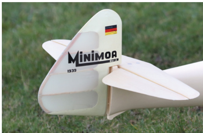
Das Dekor wurde mit einer Plottersoftware konstruiert und geplottet. Die Bespannung besteht aus Oratex Antikfolie
