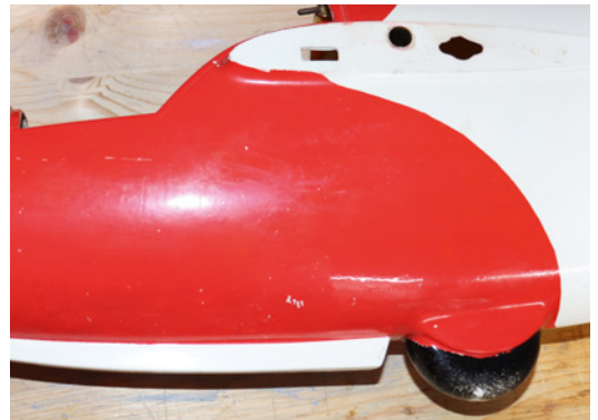
Die Originallackierung wurde entfernt und der Rumpf nass überschliffen. Die Landeradtrappe wurde durch ein Vollgummirad der Firma KPO-Modellbau ersetzt
