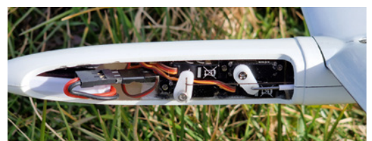
Die CHAServos LV06 mit Anlenkungen für Querruder und Seilzug für Höhen- und Seitenruder
