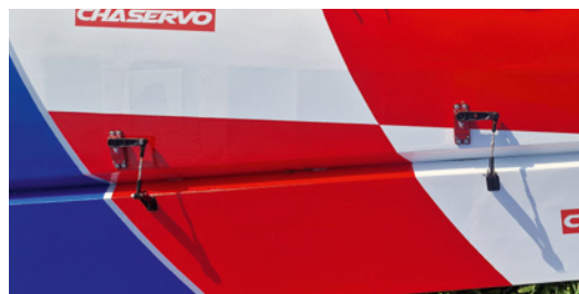
Die Querruder-Anlenkung der Yak-54 mit jeweils zwei HV3512-Servos, was zusammen rund 80 Kilogramm Stellkraft ergibt
