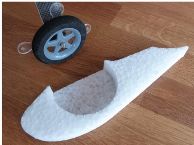
Ein Rad wurde am Fahrwerk befestigt, die Radverkleidung wird danach an dem durchsichtigen Halter an 3 Klebepunkten befestigt
