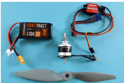
Das Hacker Antriebsset, der Kraftpaket 3s 1300mAh Antriebsakku und ein Propeller 9 x 4,5 Zoll. Am Motor wurden schon das Befestigungskreuz und der Propellermitnehmer montiert, die Anschlussbuchse am Regler wird noch gegen eine XT 60 Version ausgetauscht
