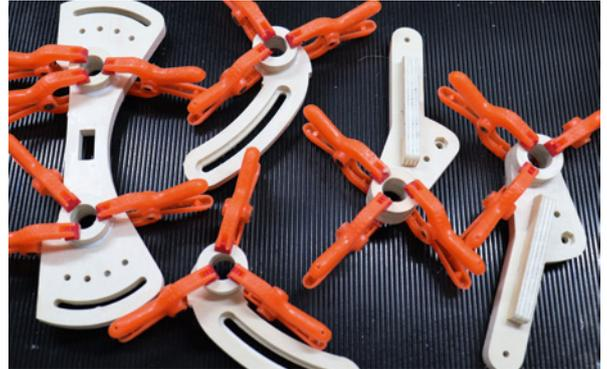
Die mitgelieferten Ringe müssen auf die entsprechenden Bauteile aufgeleimt werden. Anschließend sollten die Passungen nochmals überarbeitet werden
