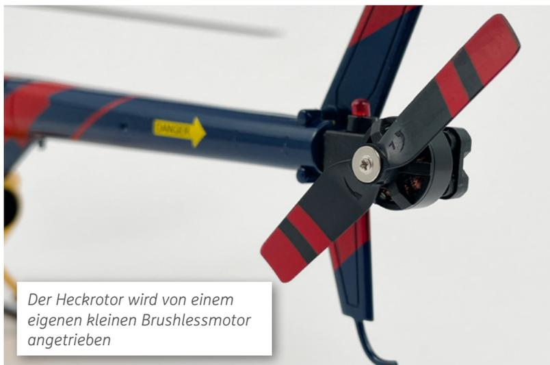
Der Heckrotor wird von einem eigenen kleinen Brushlessmotor angetrieben
