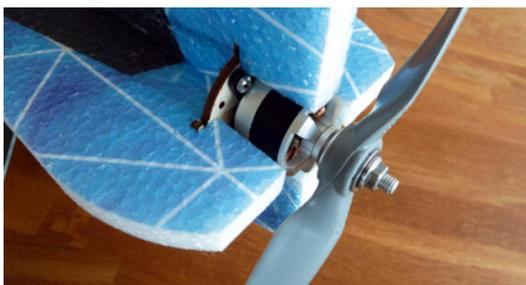
Der Motor wurde an den Sperrholz-Motorträger geschraubt
