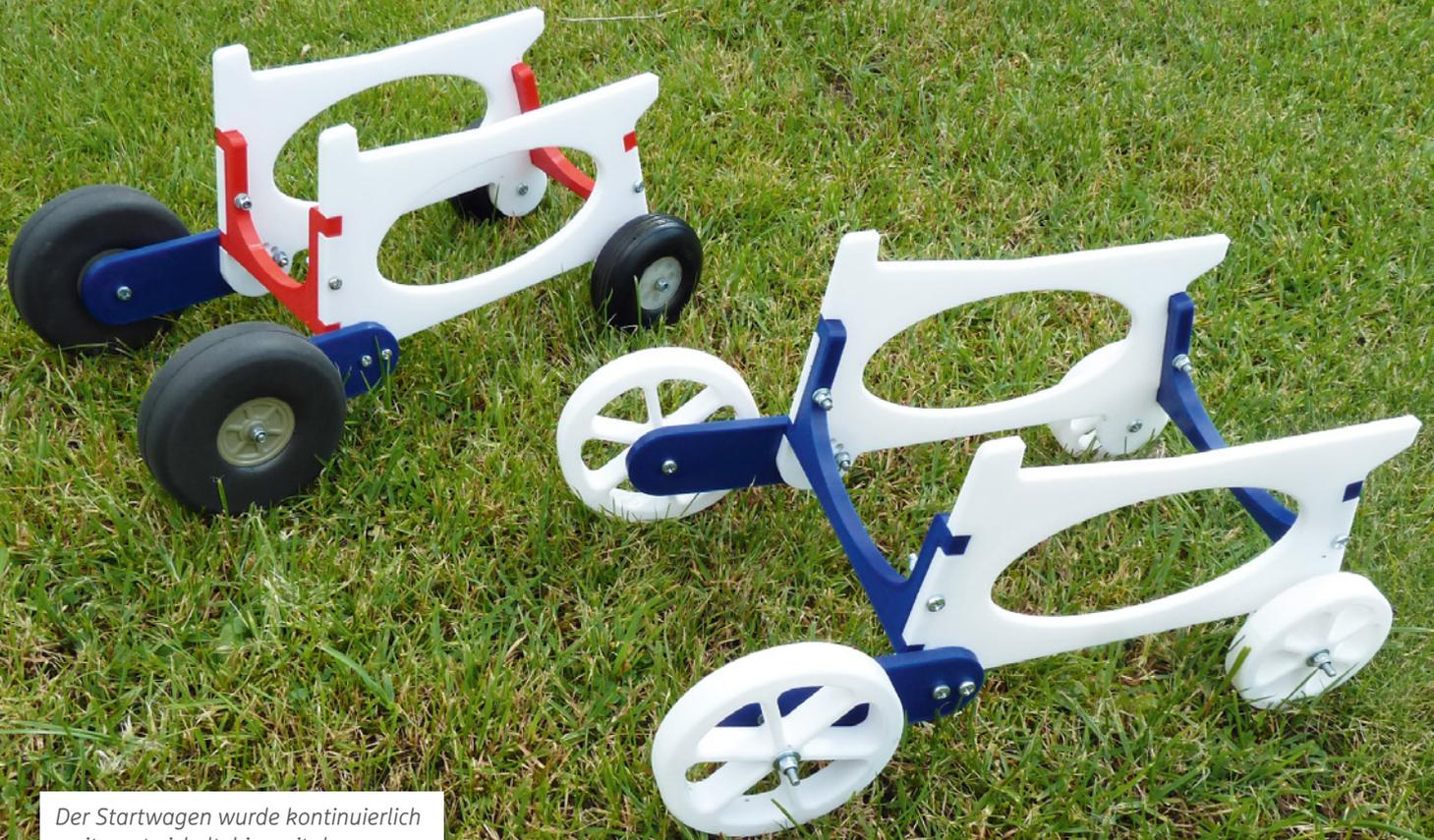
Der Startwagen wurde kontinuierlich weiterentwickelt, hier mit den Versionen 2.0 sowie 3.0, bei dem auch die Räder gedruckt wurden
