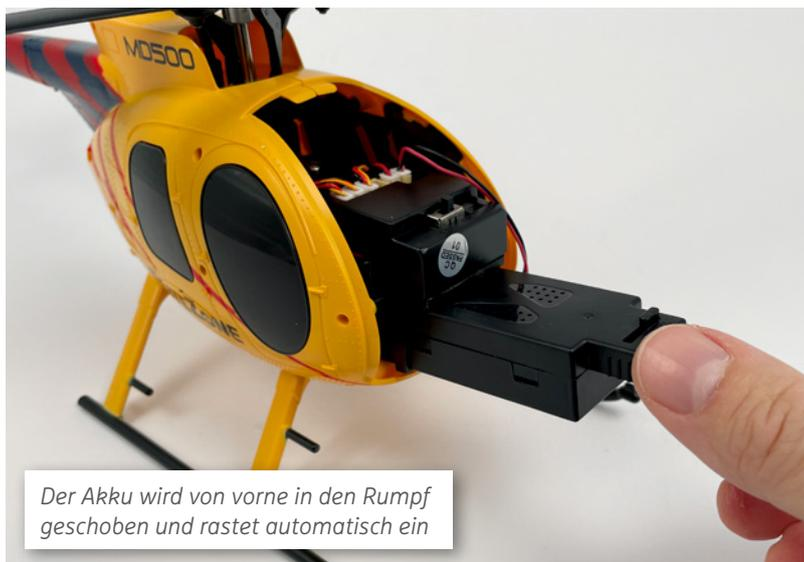
Der Akku wird von vorne in den Rumpf geschoben und rastet automatisch ein
