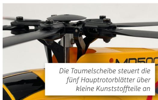
Die Taumelscheibe steuert die fünf Hauptrotorblätter über kleine Kunststoffteile an
