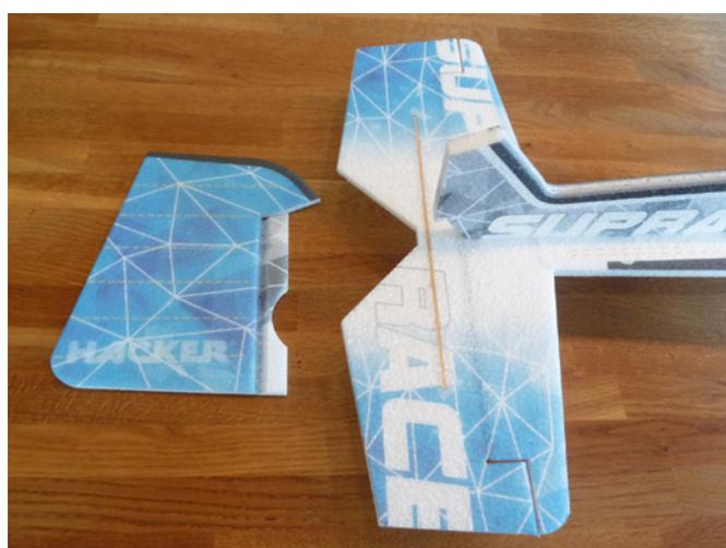
Das Seitenleitwerk wird oben und unten am Rumpheck angeklebt
