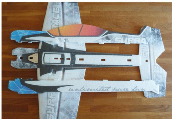
Die untere und obere Hälfte des Rumpfes liegen zum Einbau bereit, begonnen wird unten
