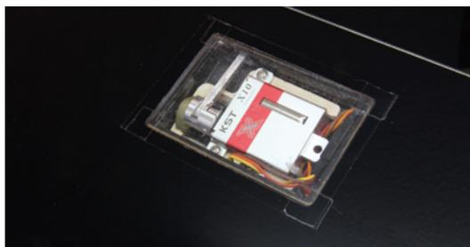
Die Servos wurden bereits bei Samba eingebaut. Zum Einsatz kommen hochwertige KST-Servos in Rahmen mit Gegenlagern und das firmeneigene IDS-System
