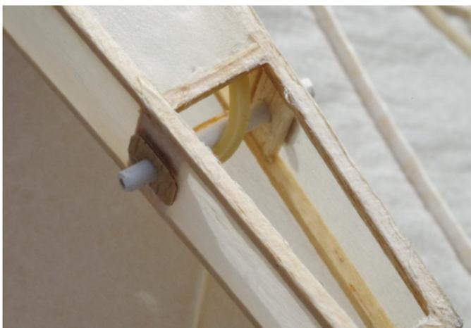
Das hintere Lager des Gummimotors, ein Kunststoffrohr
