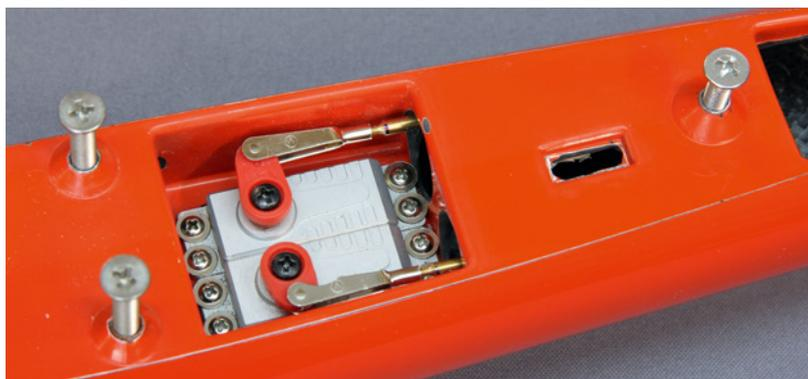
Direkt unterhalb der Tragfläche sitzen die beiden Rumpfservos für Höhen- und Seitenruder. Die KST X15 passen perfekt in die Aussparung und die Anlenkungsgestänge bedürfen lediglich noch der Feinjustierung und späteren Sicherung
