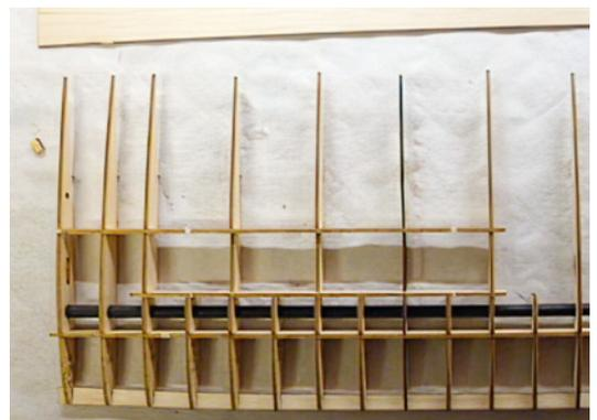
*Die Einzelteile der verschiedenen Baugruppen werden zunächst zusammengesteckt, ausgerichtet und danach verklebt*
