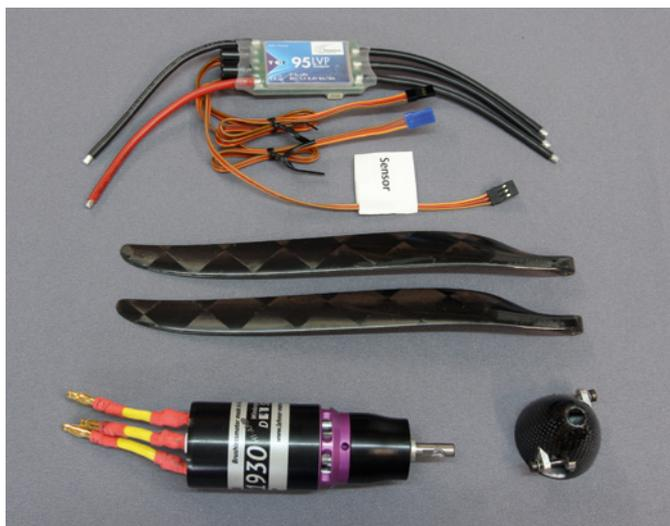
Der Antrieb stammt von Schambeck und ist extra für die GPS-Triangle-Sportklasse ausgelegt. Der kräftige Powerline-Motor besitzt eine integrierte Kühlung, daher ist es kein Problem, das ballastierte Modell mehrmals auf 400 Meter Ausgangshöhe zu bringen
