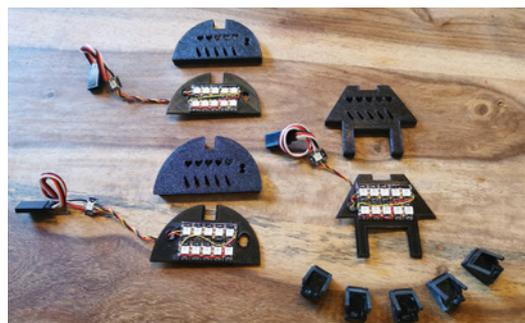
Einige selbstgebaute Cockpits mit RGB-LEDs für verschiedene Modelltypen
