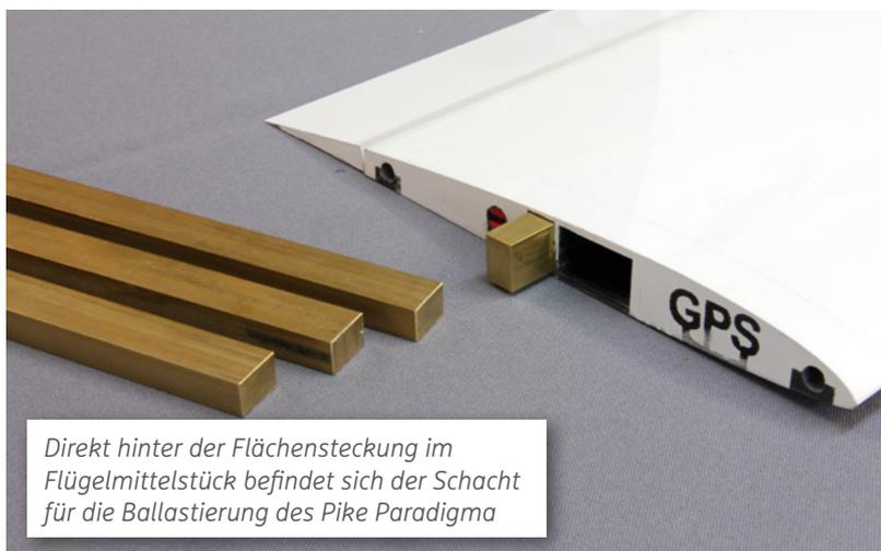
Direkt hinter der Flächensteckung im Flügelmittelstück befindet sich der Schacht für die Ballastierung des Pike Paradigma
