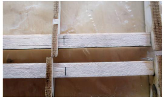
*Gelaserte Markierungen helfen beim sauberen Ausrichten der Bauteile*
