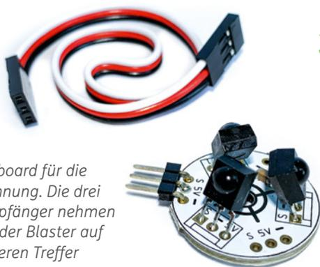
Das Sensorboard für die Treffererkennung. Die drei Infrarot-Empfänger nehmen die Signale der Blaster auf und registrieren Treffer
