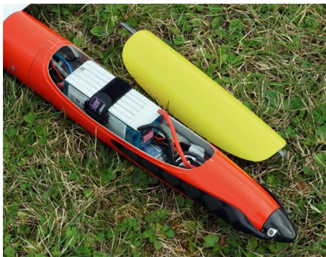
Wer mit GPS-Triangle-Equipment fliegt, der platziert den Akku direkt unter der Kabinenhaube. Freizeitflieger können einen größeren Akku verwenden und diesen dann bis nach hinten kurz vor die Flügelauflage schieben
