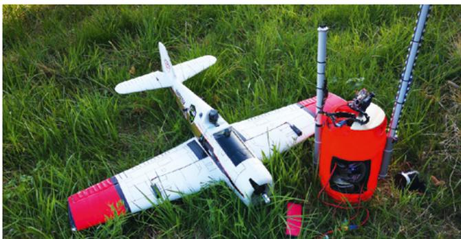
RTF Hellcat mit FPV-Combat-System. Daneben ein Bodenziel mit RGB-LEDs zur Trefferanzeige und verbautem SFX-Board für Pyro-Effekte
