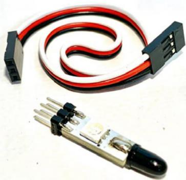
Der Blaster des FPV-Combat-Systems. Die schwarze Infrarot-Diode sendet das Signal aus, die weiße RGB-LED dient zur Kontrolle, ob der Blaster im Low- oder High-Power-Modus läuft
