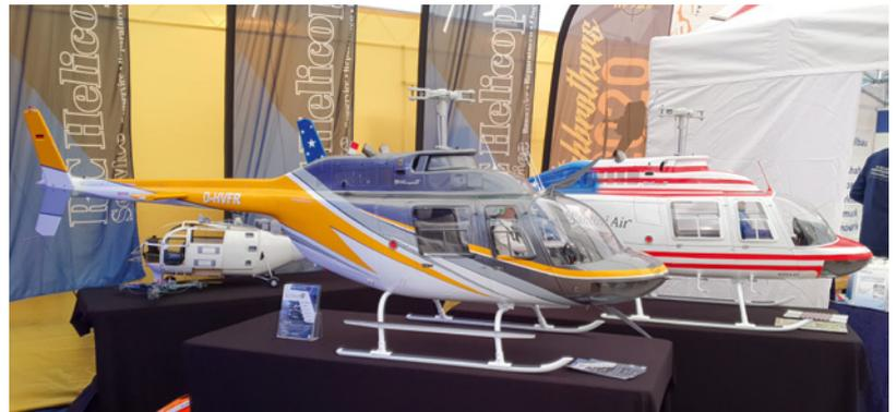
Das Full-Scale-Modell des Bell Jet Ranger III wird so exklusiv bei Heiko Fischer hergestellt. Das Modell hat einen Rotordurchmesser von 3.200 Millimeter und wiegt 24,9 Kilogramm. Der Antrieb erfolgt über eine Jakadofsky pro 7000-Turbine
