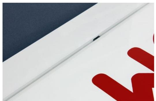
Mit dem beiliegenden Spaltabdeckband werden die Ruderspalt eliminiert
