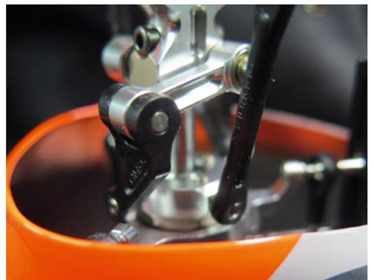
*Der Rotorkopf besteht größtenteils aus Aluminium. Die Anlenkgestänge sind aus Kunststoff, damit sie im Ernstfall nachgeben können*
