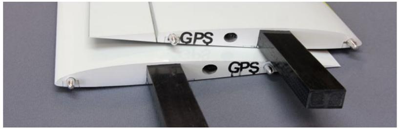
Die beiden Außenohren werden über CFK-Verbinder mit eingebauter V-Form an das Mittelstück angesteckt
