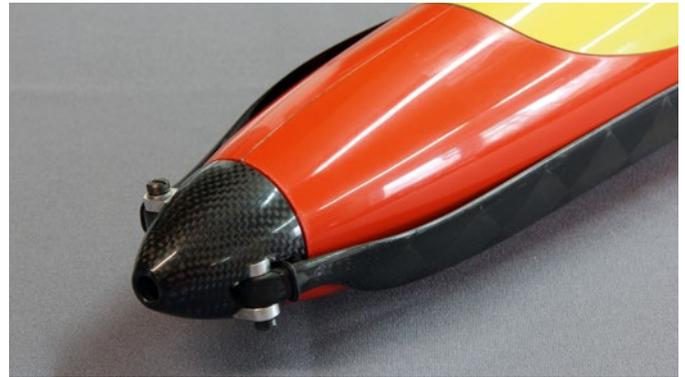
Der RFM-Spinner fügt sich gut in die Rumpfkontur ein. Die Propellerpositionierung sorgt dafür, dass die Luftschrauben seitlich am Rumpf anliegen. Dies verhindert Beschädigungen bei der Landung
