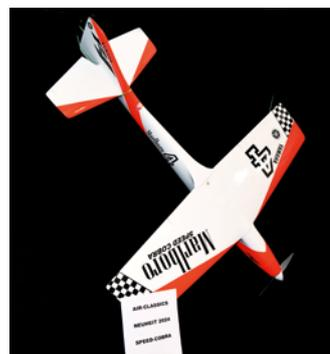
Speed Cobra wurde ein Voll-GFK-Modell vorgestellt, das speziell fürs Speed-Fliegen konzipiert wurde. Mit 1.120 Millimeter Spannweite bei 1.200 Millimeter Länge wird es in verschiedenen Farben (im Laminat gefärbt) ab Mitte 2024 für rund 400,- Euro zu haben sein.
