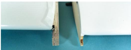
Links die reparierte und verstärkte Nase der Flächenbefestigung, rechts das Original
