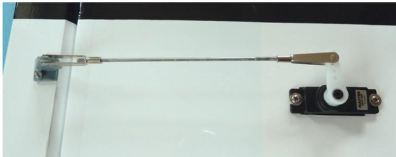
Die Anlenkung der Querruder erfolgt mittels einer 2-Millimeter-Gewindestange, auf der zwei Gabelköpfe sitzen
