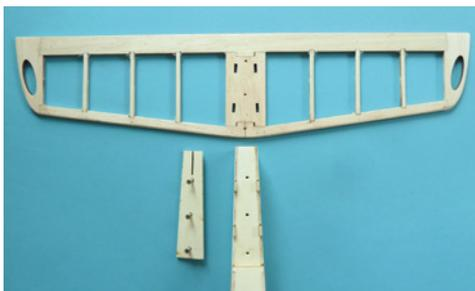
Das Höhenleitwerk wird mit drei Schrauben und einem Sperrholzbrettchen festgeklemmt
