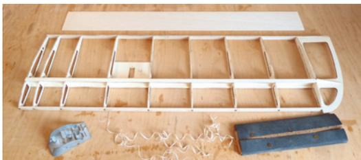
Die Hilfsnasenleiste wurde zuerst mit dem Balsahobel und dann mit der Schleiflatte an die Profilkontur angepasst und ist nun zum Beplanken bereit
