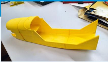
Die Teile aus dem 3D-Drucker müssen teilweise noch nachbearbeitet werden, damit alles passt
