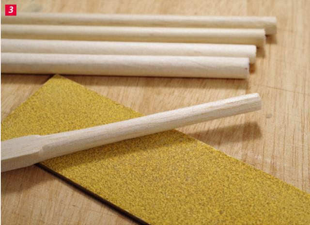
3 Stöpsel“ vorn und hinten von einem passend geschliffenen Balsastab
