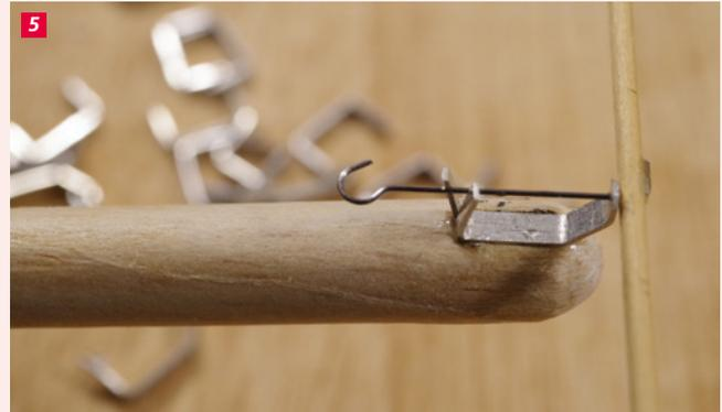
4 Propellerlager aus Stahldraht in einem gesägten Schlitz oder aus Duralu in einer Aussparung. Fehlt noch die Zwirnwicklung
