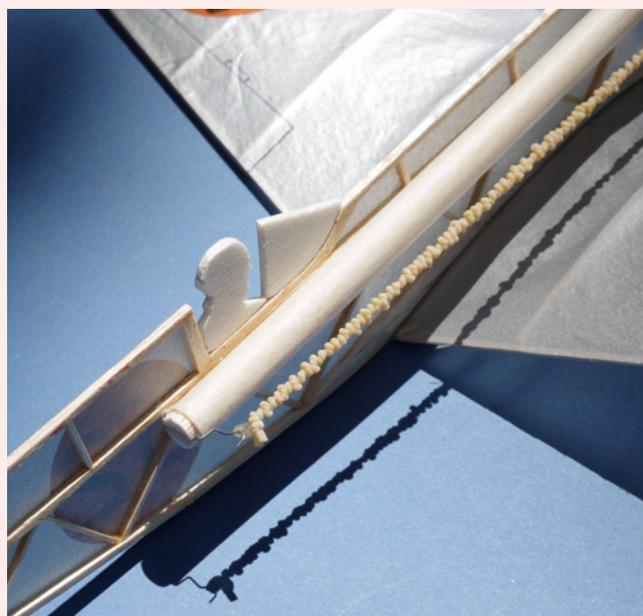
Das hintere Motorlager aus 0,5-Millimeter-Stahldraht
