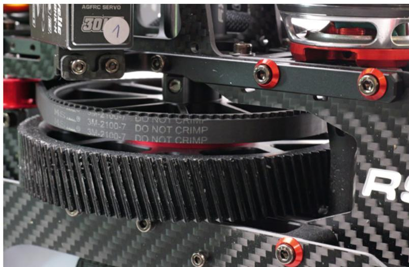
Der Antrieb ist mit einstufigem Getriebe ausgelegt. Hier ist das schrägverzahnte Hauptzahnrad abgebildet
