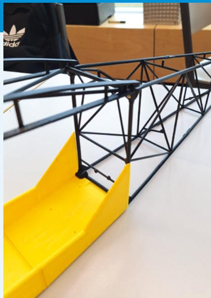
Der Cockpit-Bereich wird über einen Gitterrohrrahmen mit dem Leitwerk verbunden
