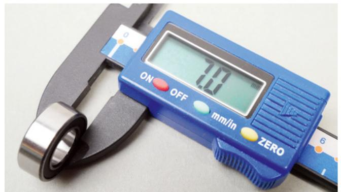
Die zweireihigen Schräglauflager im Blatthalter sind mit 7 Millimeter etwas breiter als normale einreihige Standardkugellager
