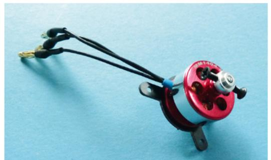
Der kleine Motor, an dem bereits die Motorhalterung und der Propsaver montiert wurden
