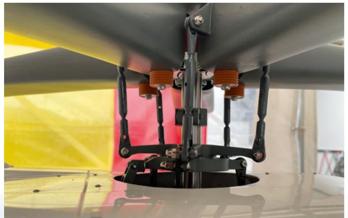
Der Flexbeam Fünfblatt-Rotorkopf an der H145-D3 von Francis Paduwat kommt komplett ohne Kugel- und Drucklager aus – genau wie das Original
