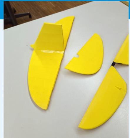
Auch das Leitwerk ist bereit für die Montage am Modell
