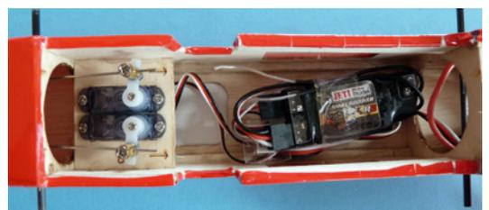
Im Bereich unter der Tragfläche sitzen die Servos für Seite und Höhe sowie der Empfänger
