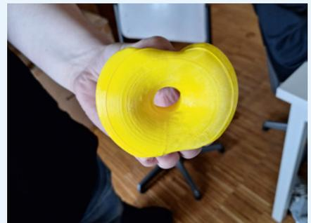
Einige Teile, wie die Reifen, werden aus besonders flexiblem Material gedruckt
