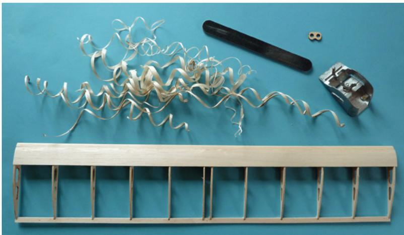
Die Nasenleiste wird zunächst mit dem Balsahobel bearbeitet, dann mit der Schleifplatte. Die kleine Schablone oben rechts dient der Kontrolle des Profils
