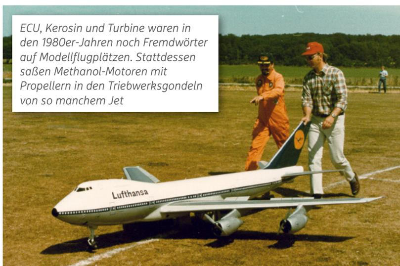
ECU, Kerosin und Turbine waren in den 1980er-Jahren noch Fremdwörter auf Modellflugplätzen. Stattdessen saßen Methanol-Motoren mit Propellern in den Triebwerks gondeln von so manchem Jet
