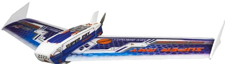
Der neue **FPV Super Ray** von arkai ist eine EPP- und Sperrholzkonstruktion mit Kohlefaserverstärkungen. Seine Spannweite beträgt 1.100 Millimeter, seine Länge 380 Millimeter und sein Abfluggewicht ab 650 bis maximal 900 Gramm – je nach Akku und Ausstattung. Preislich liegt das Flugzeug bei 65,90 Euro.
