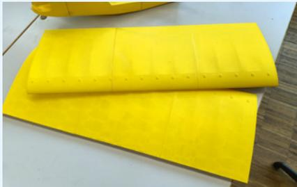
Die einzelnen Tragflächensegmente werden mit Sekundenkleber verbunden
