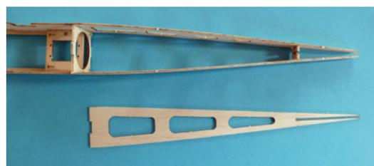
Nachdem der kleine, hintere Spant eingeleimt wurde, kommt als nächstes die hintere Rumpfbeplankung drauf
