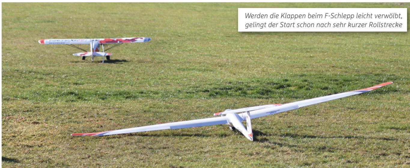
Werden die Klappen beim F-Schlepp leicht verwölbt, gelingt der Start schon nach sehr kurzer Rollstrecke
