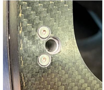
Drei Löcher sind zu bohren, dann kann der Magnetverschluss montiert werden
