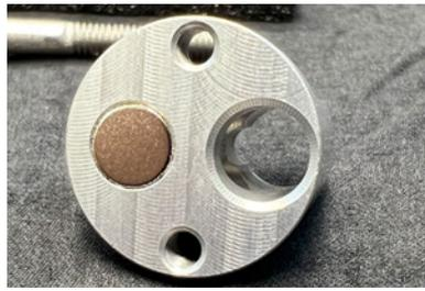
Die beiden kleinen Löcher verfügen über Gewinde und dienen zur Befestigung des Verschlusses. In das große Loch wird der Verschlussbolzen eingeführt
