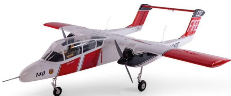
bei 2.160 Millimeter Länge auf 2.128 Millimeter Spannweite. Das Abfluggewicht der Benzinversion beträgt 13,1 Kilogramm, die Elektroversion mit Akkus wiegt flugfertig 12,4 Kilogramm. Das Modell verfügt über Landeklappen sowie ein Einziehfahrwerk. Der Preis: 1.699,99 Euro.
