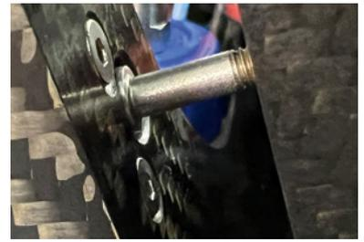
Wenn der Magnetic-Connect-Verschluss sauber eingebaut wurde, rutscht alles sauber ineinander und wird danach mit einem Magneten gesichert
