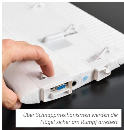
Über Schnappmechanismen werden die Flügel sicher am Rumpf arretiert
