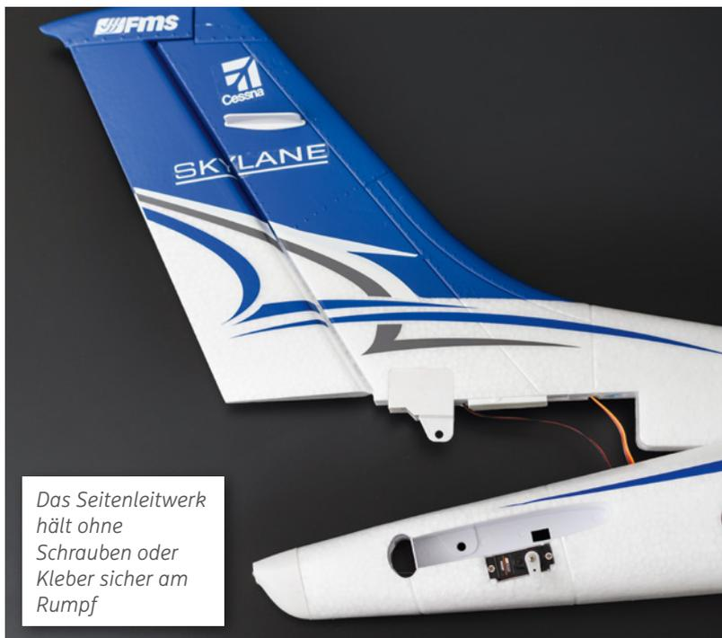
Das Seitenleitwerk hält ohne Schrauben oder Kleber sicher am Rumpf
