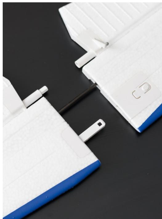
Die Höhenleitwerkshälften werden einfach zusammengesteckt und rasten ein
