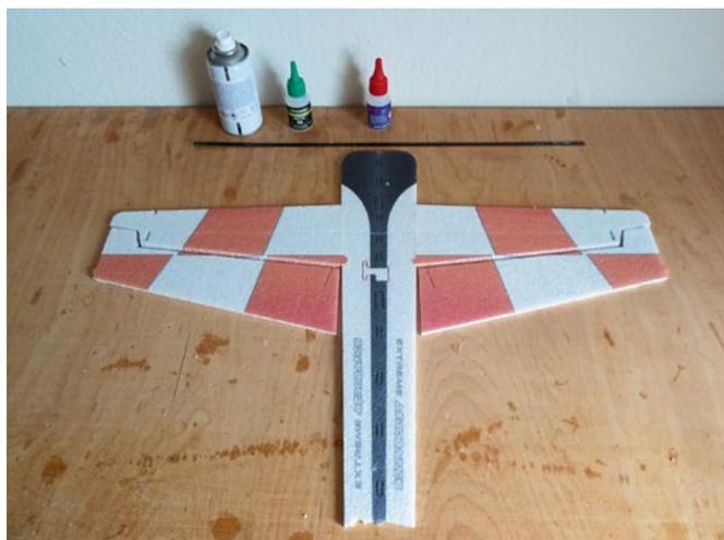
Die Flächen wurden an den Rumpf geklebt, oben liegt eine 6 x 0,5-Millimeter-CFK-Leiste bereit, die als Versteifung eingeklebt wird
