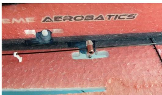
Die Schubstangen zum Leitwerk werden am Servo festgeklemmt. Führungsösen zentrieren die Stange und verhindern ein Durchbiegen auf Schub
