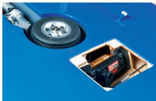
Das Klappenservo ist leicht schräg eingebaut, was die Montage erheblich vereinfacht
