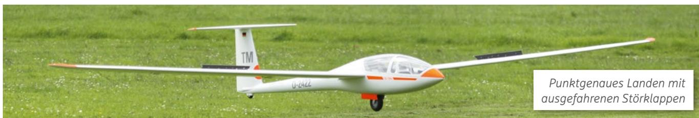
*Punktgenaues Landen mit ausgefahrenen Störklappen*
