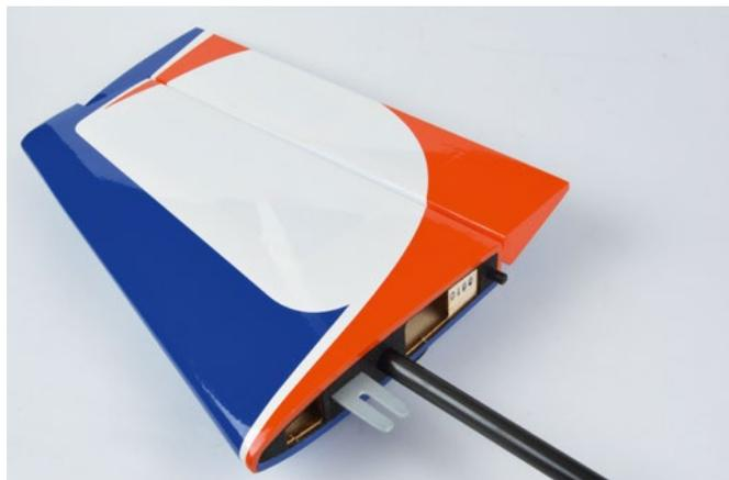
Rechtes Höhenleitwerk mit Steckungsrohr und Befestigungslasche
