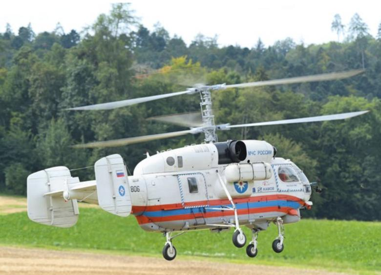
Der russische Hubschrauber Kamov KA ist mit einem gegenläufigen Doppelrotor ausgestattet. Das beim Hubschrauber typischerweise auftretende Drehmoment entfällt, sodass kein Heckrotor erforderlich ist
