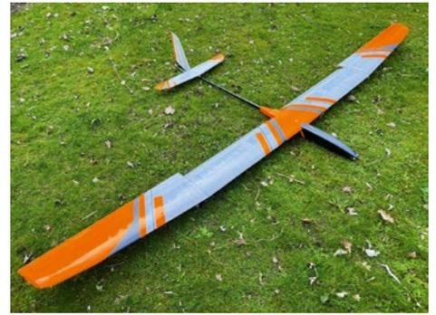
Mit dem **madMAXX** verspricht rs-aero einen flotten Segler mit Vierklappenflügel und Elektroantrieb. 1.430 Millimeter Spannweite hat das stabile Flugzeug, das mit einer Länge von 835 Millimeter mindestens 800 Gramm auf die Waage bringt. Das Profil mit 1,5 Prozent Wölbung hat eine Dicke von 8 Prozent. Der Preis: 244,- Euro.
