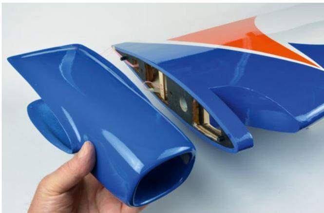
Die aus GFK erstellten Lufteintrittskanäle werden auf der Tragfläche verschraubt
