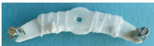
Der Servohebel des Querruders wird mit einem Zubehörteil aus dem Bausatz deutlich vergrößert
