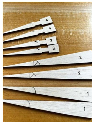
Um so filigrane Bauteile exakt zu produzieren, ist Lasertechnik nötig
