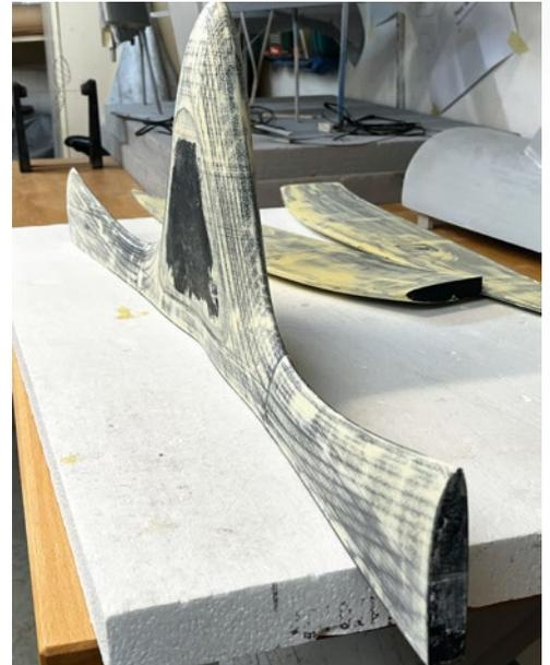
Einige Urmodelle entstanden mit Hilfe eines 3D-Druckers. Hier war spachteln zum Abformen erforderlich
