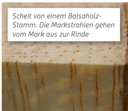
Scheit von einem Balsaholz-Stamm. Die Markstrahlen gehen vom Mark aus zur Rinde
