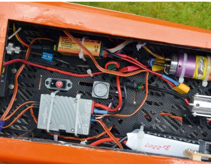
Pioneer mit angeschlossenem iGyro-Sat, ECU, Kraftstoffpumpe und Turbinen-Akku
