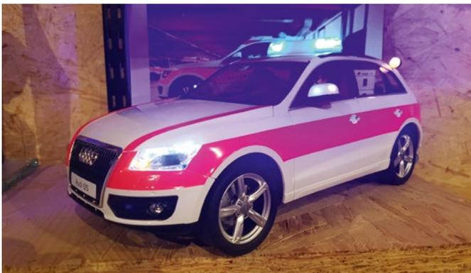
Die LED-Beleuchtung wurde durch Lichtwellenleiter mit 0,5 mm und 0,7 mm Durchmesser realisiert
