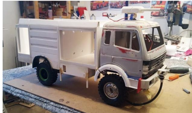
Da der Platz im eigentlichen Löschmonitor begrenzt ist, müssen Steuerungselemente häufig unter den Aufbaukomponenten versteckt werden
