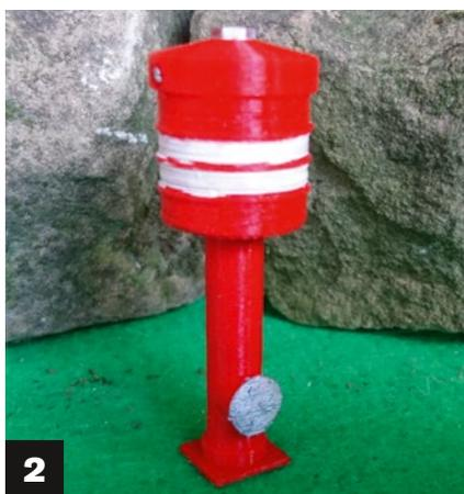
1) Vom CAD-Teil zum gedruckten Hydranten bedarf es manchmal mehrerer Anläufe. 2) Durch einen Wechsel des Filaments während des Druckvorgangs sind mehrfarbige Teile wie bei diesem Hydranten möglich
