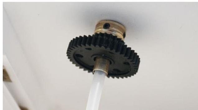
Wird der Schlauch in einer Messinghülse fixiert, lässt sich dieser per Zahnrad bewegen, sodass der Löschmonitor der horizontalen Bewegung folgt
