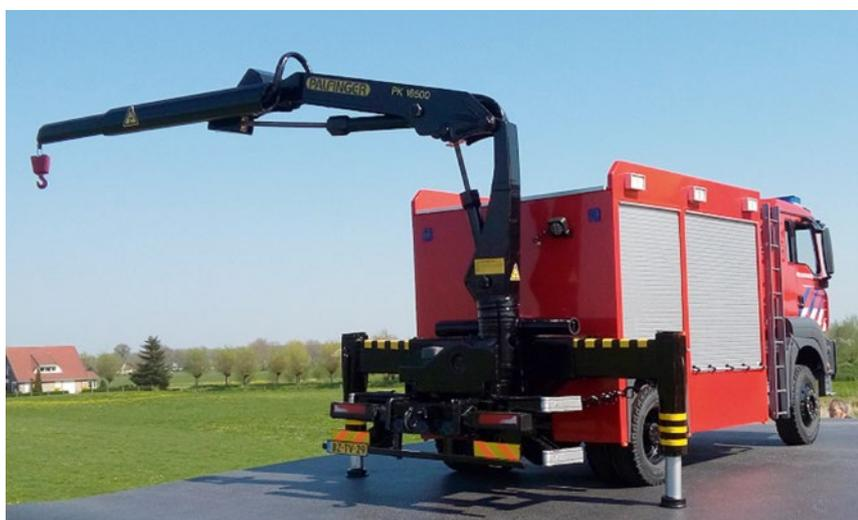
Das Einsatzfahrzeug mit funktionierendem Kran ist etwas Besonderes. Sein Klappkran ist komplett in 3D gedruckt und mit Spindelmotoren ausgestattet
