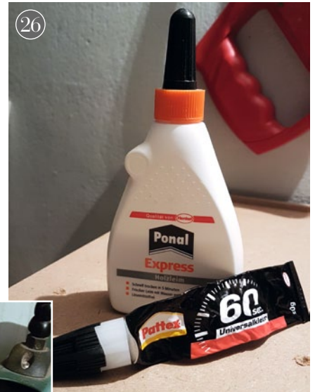
26 Neben Holzleim – Ponal Express – wurden einige Verklebungen mit Pattex 60 Sekunden Alleskleber vorgenommen. Mit Letzterem halten auch die Ziegel auf der Scheibe
