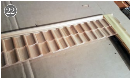
22 Nun erhält die Front noch eine Abschlussleiste. Diese wird exakt über die letzte Ziegelreihe geleimt und dort fixiert
