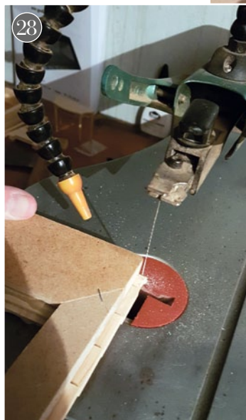
28 Nun werden die Ziegel, die an einer Seite des Daches überstehen, sauber aufgekürzt. Man kann hier auf eine Feinsäge zurückgreifen oder sich elektrisch unterstützen lassen
