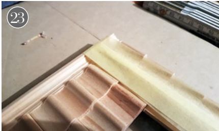
23 Klebeband oder Malerkrepp hält die Leiste bis zum vollständigen Trocknen des Leims an Ort und Stelle
