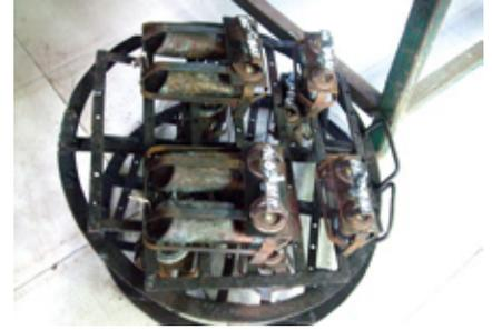
Mit Kupferformen lassen sich viele Vinylteile fertigen, die anschließend von Hand zu Puppen zusammengefügt werden
