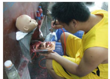
Mit Hilfe einer Schablone wird der Mund mittels Airbrush eingefärbt und später von Hand noch einmal nachgearbeitet
