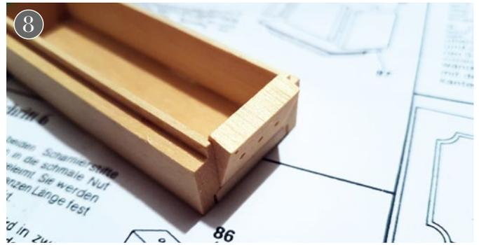
Der obere Abschluss des Uhrenkastens mit den vorbereiteten Löchern für Pendel und Uhrenkette, darf noch nicht verleimt werden. Das Bauteil wird später zusammen mit der Tür der Uhr eingepasst. Wird es dennoch vorher verleimt, kann man die Tür nicht wie im Manual beschrieben einbauen
