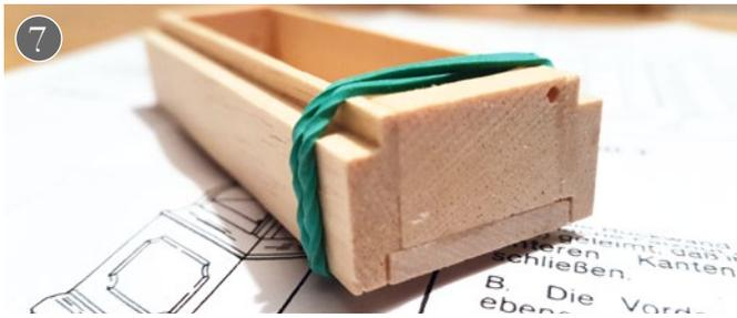
Weiter geht es mit dem Uhrenkasten. Dieser besteht aus fünf Teilen, von denen vier miteinander verleimt werden. Zunächst die Außenwände mit der Rückwand, dann wird der untere Abschluss gesetzt. Unbedingt auf die Position des kleinen Loches achten und gemäß Anleitung vorgehen. Fixiert wird das Ganze mit Gummibändern. Sie ersetzen Miniatur-Schraubzwingen hervorragend
