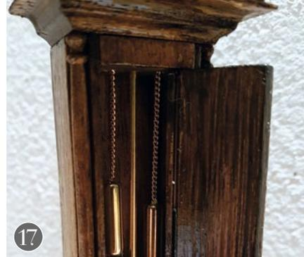
17 Nach dem finalen Verschleifen geht es ans Lackieren von Uhrenkorpus, Tür und des oberen Abschlussstückes des Uhrenkastens. Wir haben eine Palisander-Lasur verwendet, die anschließend mit einer Klarlackschicht versehen wurde. Nach dem Trocknen wird das noch fehlende Stück des Kastens – versehen mit Pendel und Uhrenkette – samt Tür eingesetzt
