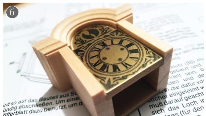
Um einen Eindruck von der späteren Optik zu gewinnen, nimmt das aus Messing gefertigte Zifferblatt schon einmal probeweise Platz – muss seinen Platz jedoch wieder räumen, da die fertig zusammengebaute Uhr ja noch lackiert werden muss
