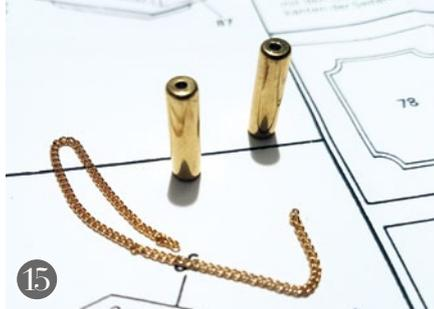
15 Jede Uhr bedarf einer Antriebskraft. Die einfachste Methode ist der Antrieb mittels hängender Gewichte. Der Nachteil dieser Konstruktion ist, dass sie nur für fest stehende oder hängende Großuhren geeignet sind. Diese Art des Antriebs wird auch bei der Miniaturuhr angedeutet
