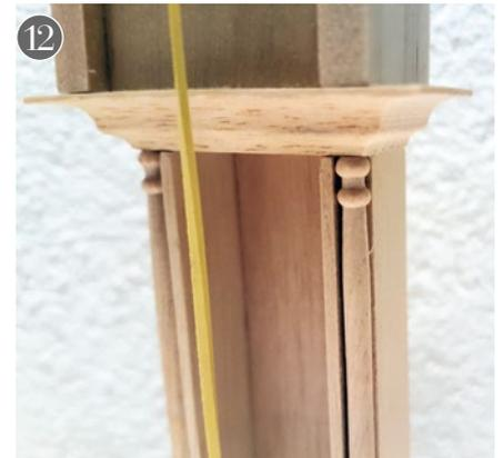
Die gedrehten Elemente passen perfekt in die vorgesehenen Aussparungen. Es bietet sich an, sie nicht sofort zu verleimen, sondern zunächst zu lackieren. Auf diese Weise kann man einen gleichmäßigen Farbauftrag sicherstellen
