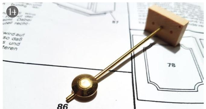
Bevor die Uhr nun lackiert wird, müssen noch das Pendel sowie die Uhrketten samt Gewichten vorbereitet werden. Begonnen wird mit dem Pendel. An dessen Stange wird zunächst mittels Alleskleber die Pendelscheibe geklebt
