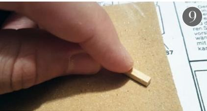
Als Nächstes werden die kleinen Klötzchen vorbereitet, auf denen die gedrehten Elemente des Uhrenkastens Platz finden. Diese müssen etwas nachgeschliffen werden, da sie – platziert in den entsprechenden Aussparungen – über die Seitenwand der Uhr hinausragen
